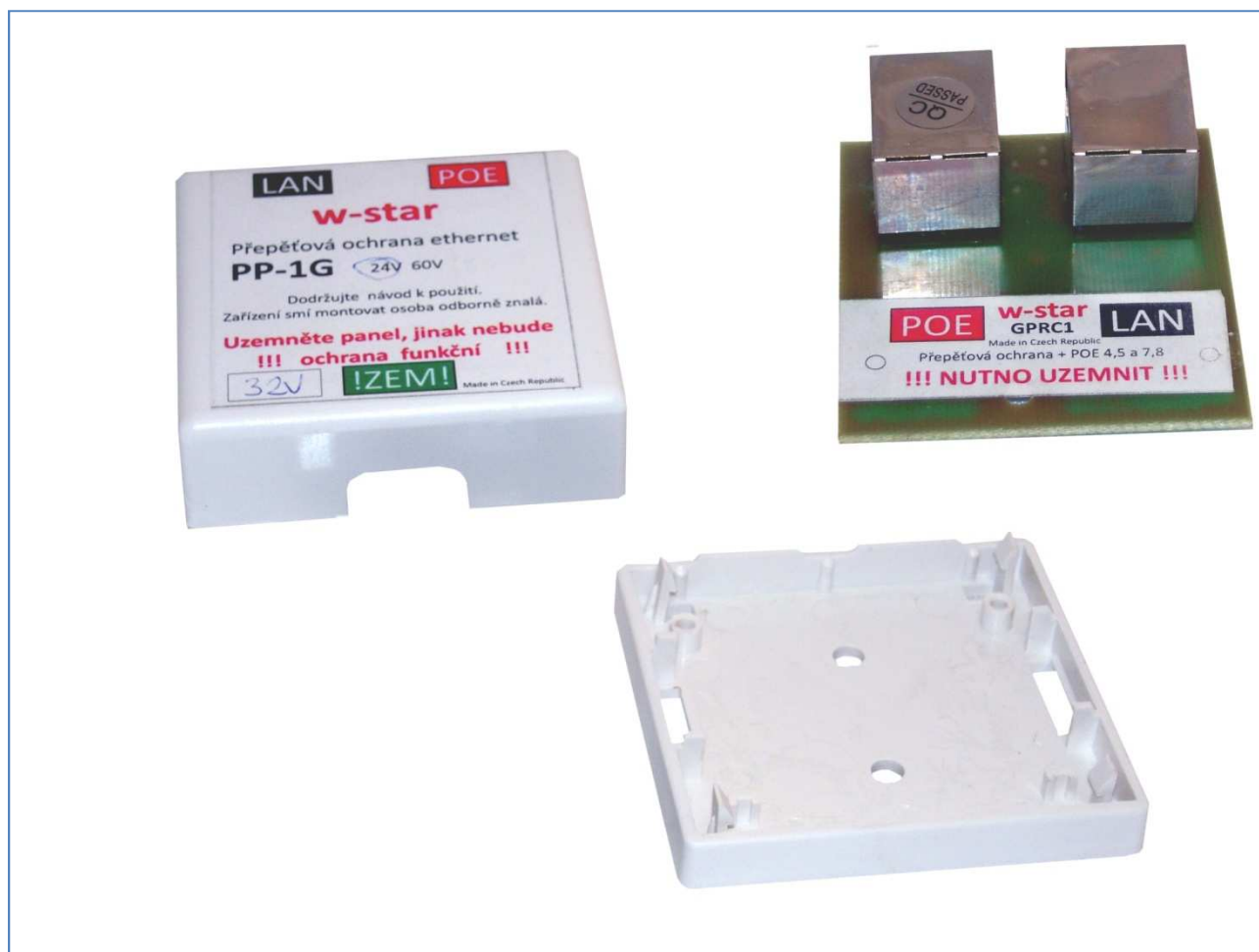
Obr. 2, detail rozebrané ochrany.
