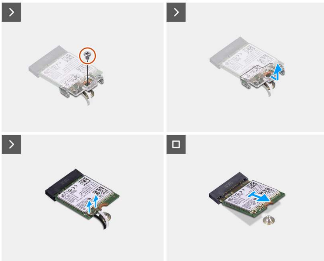
Obrázek 24. Demontáž bezdrátové karty
