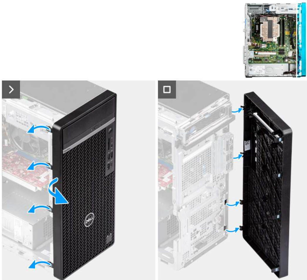
Obrázek 14. Demontáž čelního krytu
