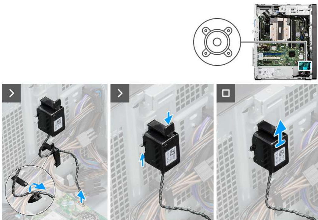
Obrázek 50. Demontáž interního reproduktoru
