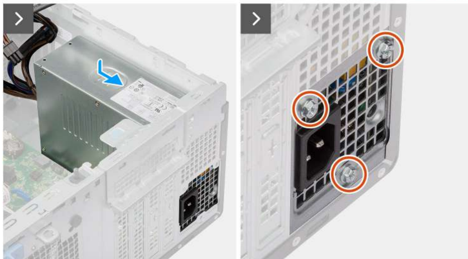
Obrázek 76. Montáž napájecí jednotky
