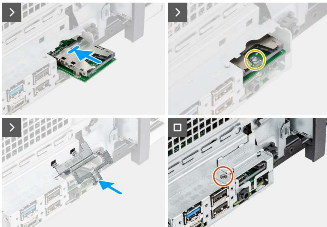
Obrázek 33. Montáž čtečky paměťových karet
