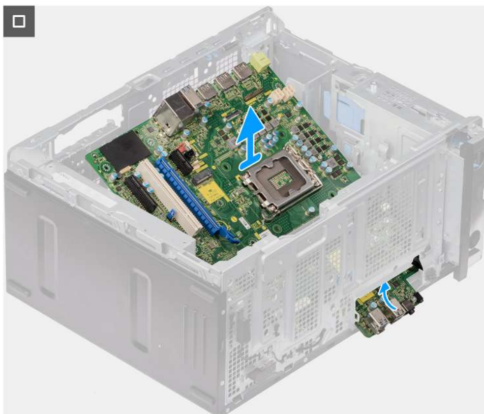
Obrázek 100. Demontáž základní desky
