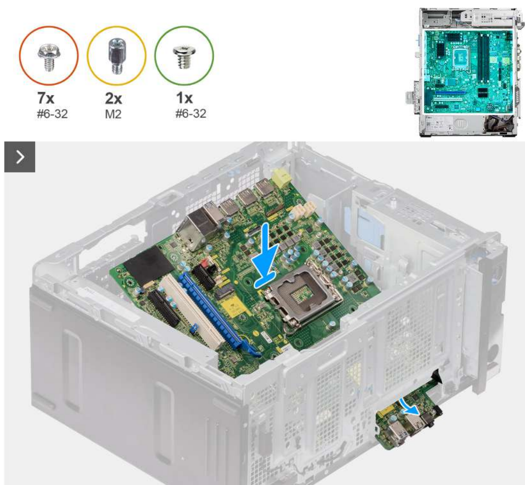
Obrázek 102. Montáž základní desky
