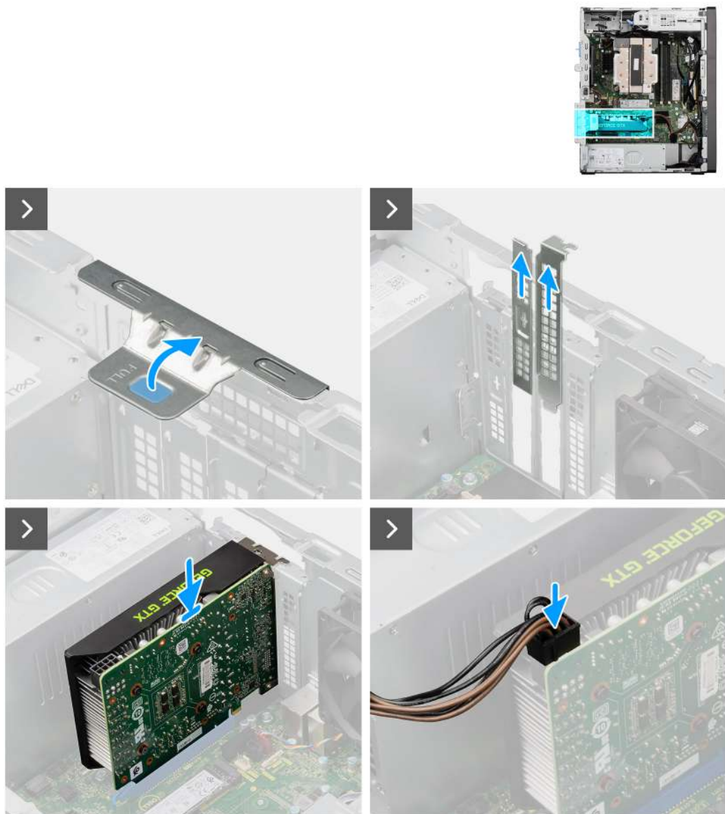
Obrázek 30. Montáž napájené grafické karty
