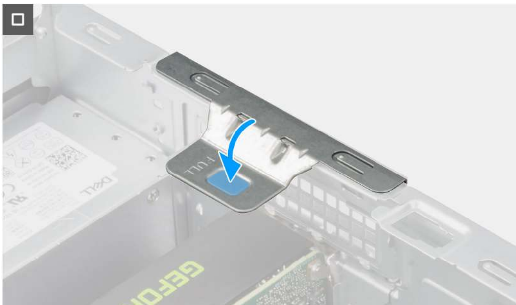
Obrázek 31. Montáž napájené grafické karty
