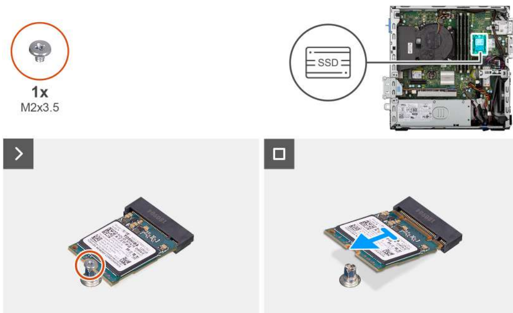
Obrázek 19. Demontáž disku SSD M.2 2230
