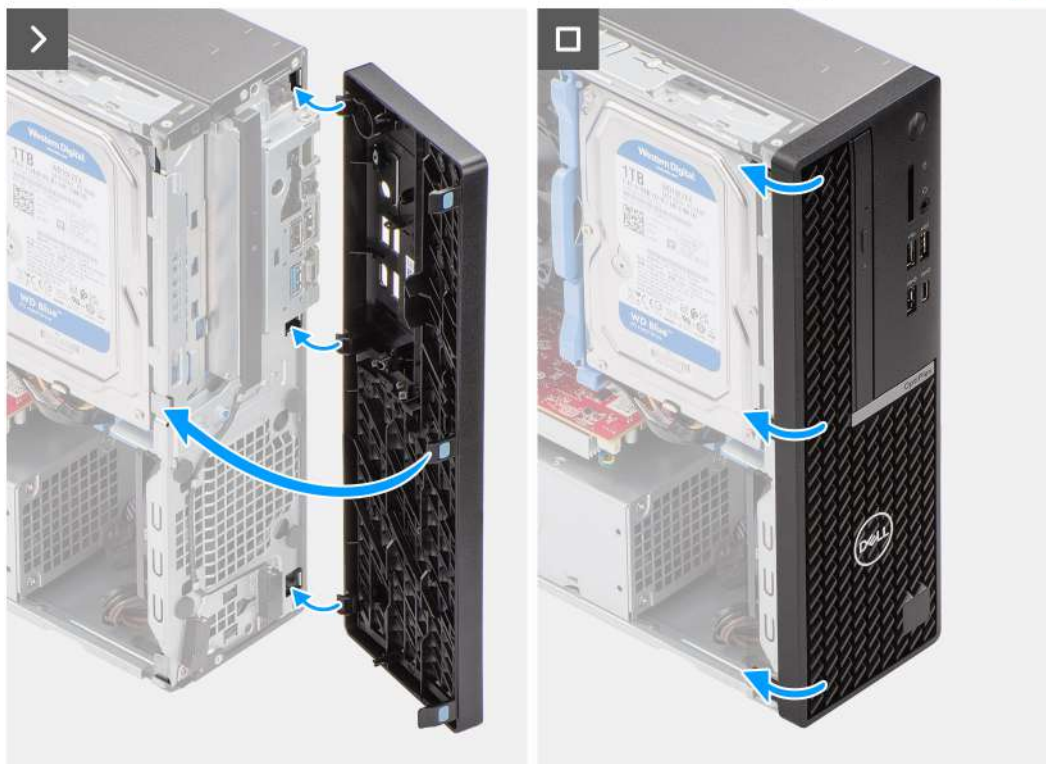
Obrázek 8. Montáž čelního krytu
