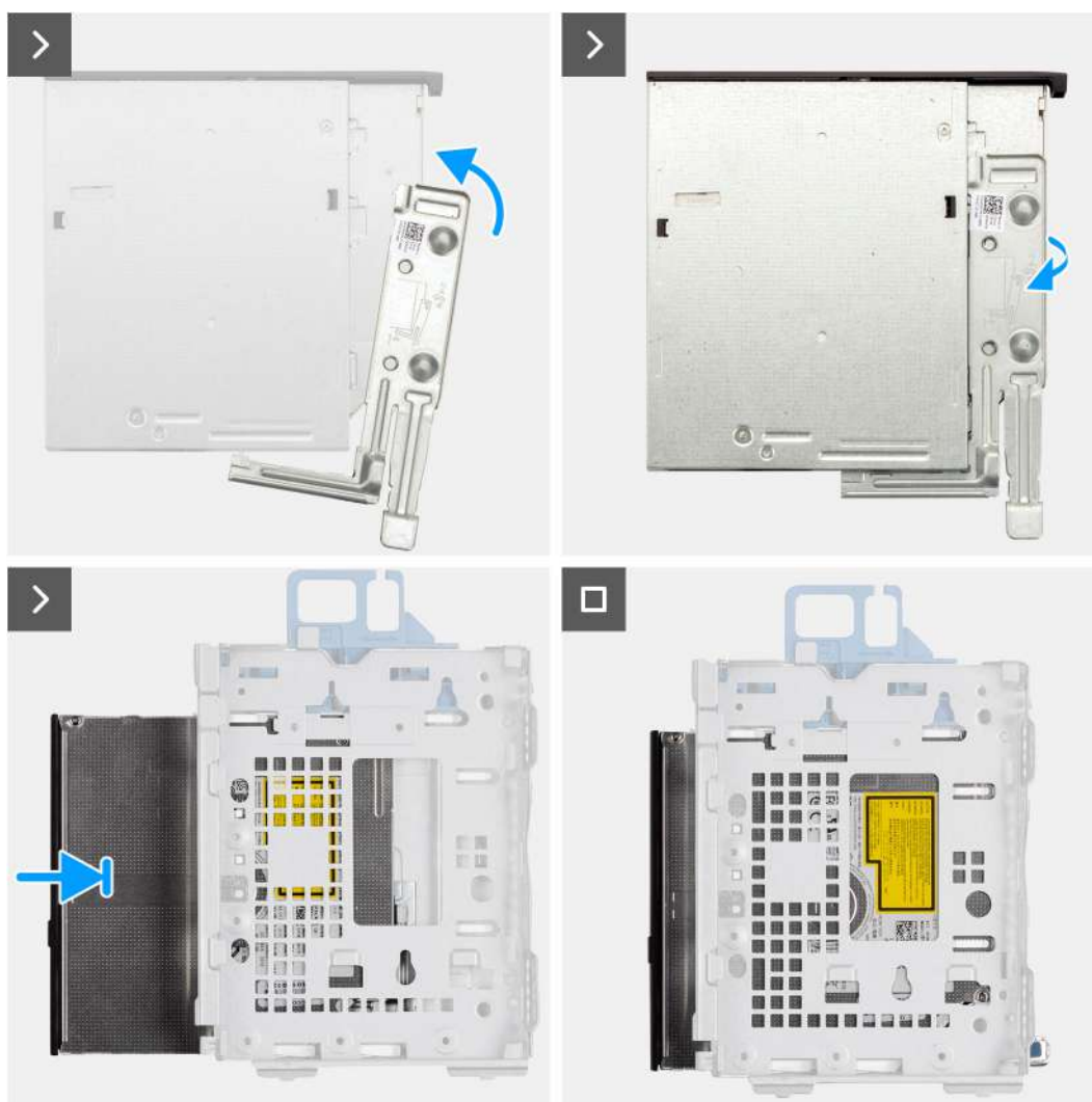
Obrázek 14. Montáž optické jednotky
