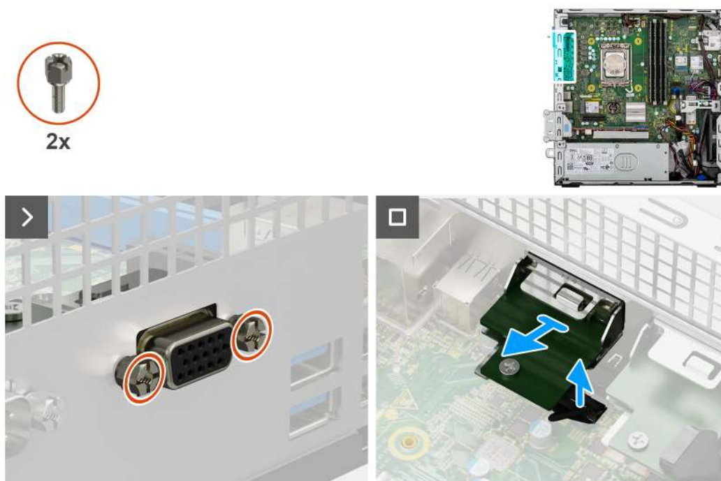
Obrázek 60. Demontáž modulu VGA
