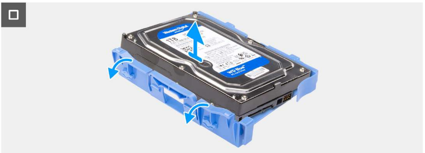
Obrázek 9. Vymutí 3,5palcového pevného disku
