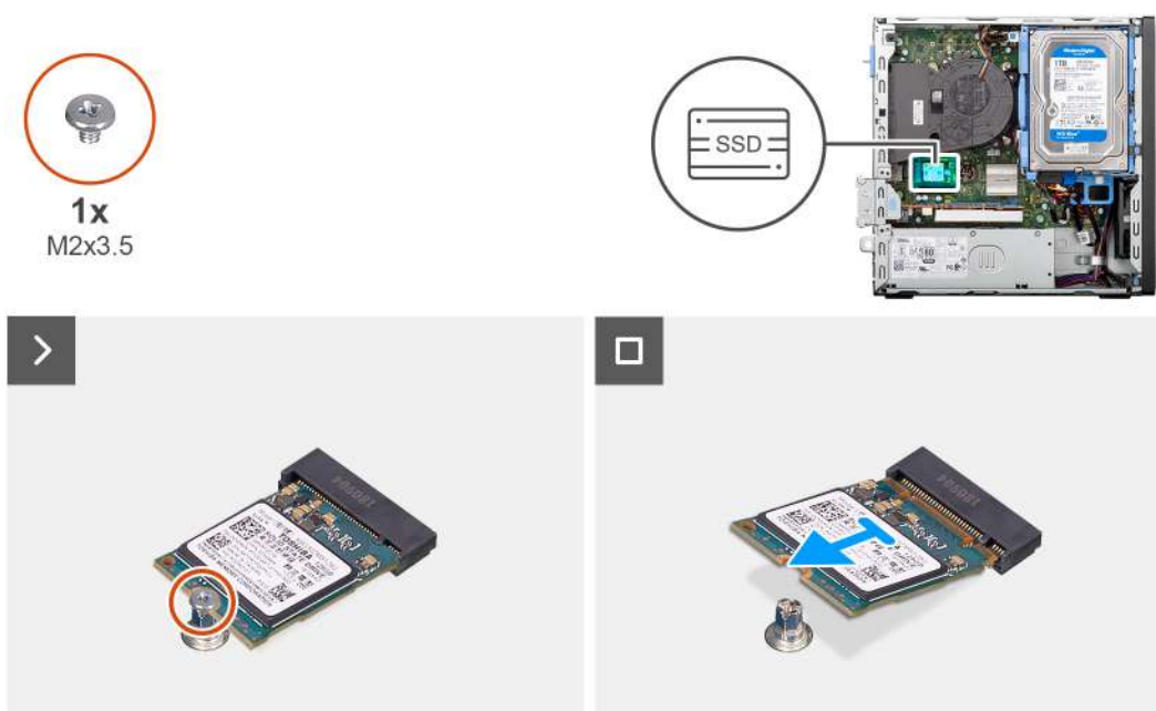
Obrázek 17. Demontáž disku SSD M.2 2230
