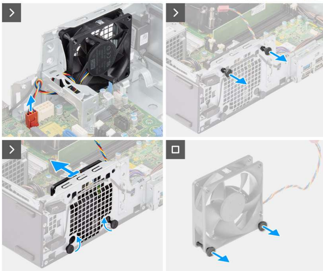
Obrázek 41. Demontáž systémového ventilátoru
