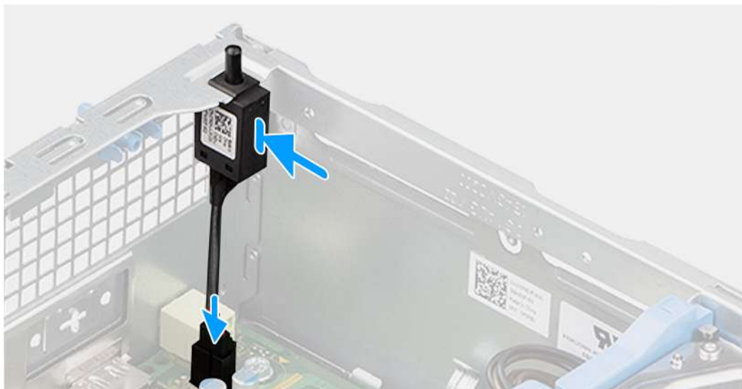
Obrázek 38. Montáž spínače proti neoprávněnému vniknutí do šasi
