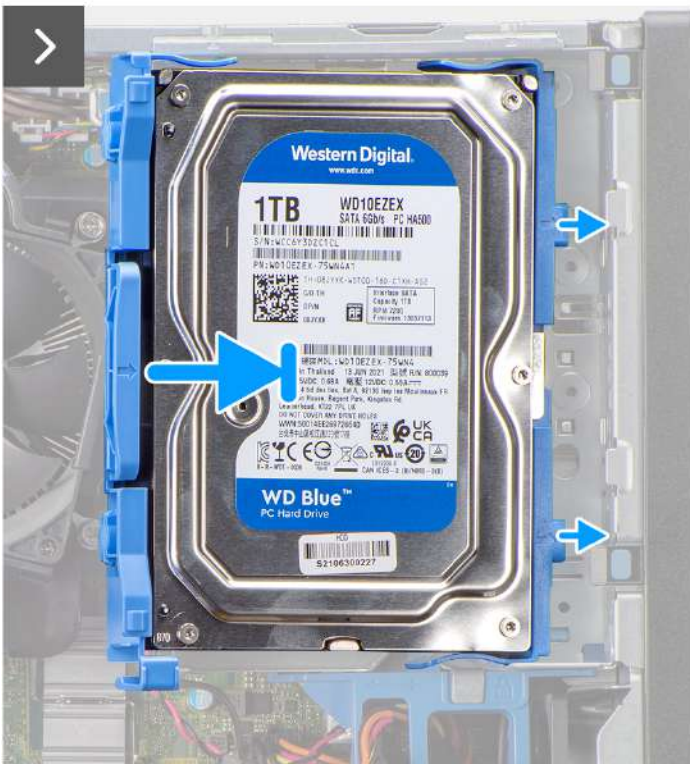
Obrázek 10. Montáž 3,5palcového pevného disku
