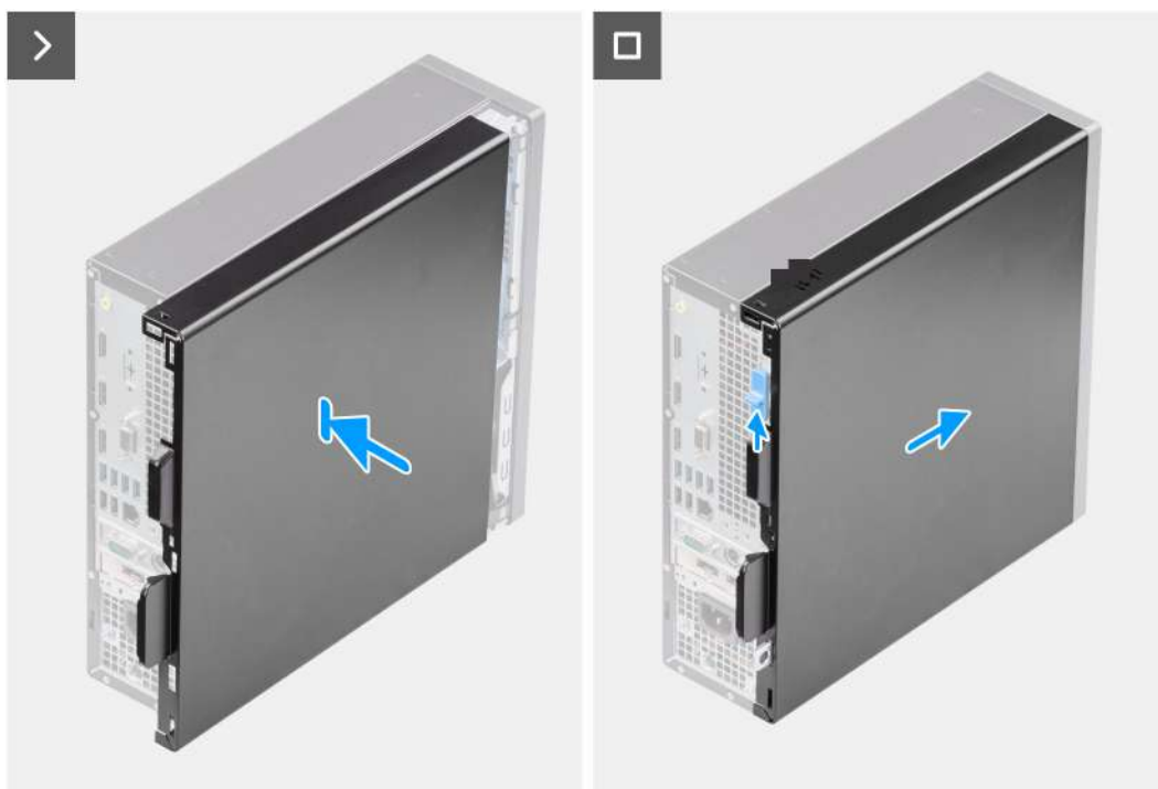
Obrázek 4. Montáž bočního krytu
