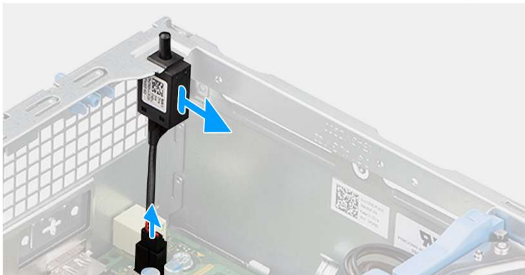
Obrázek 37. Demontáž spínače detekce vniknutí do šasi
