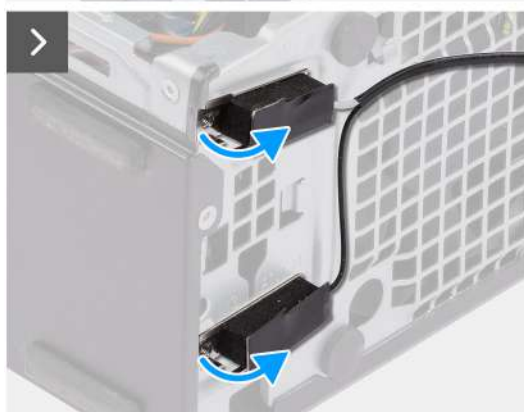
Obrázek 43. Demontáž modulu interní antény
