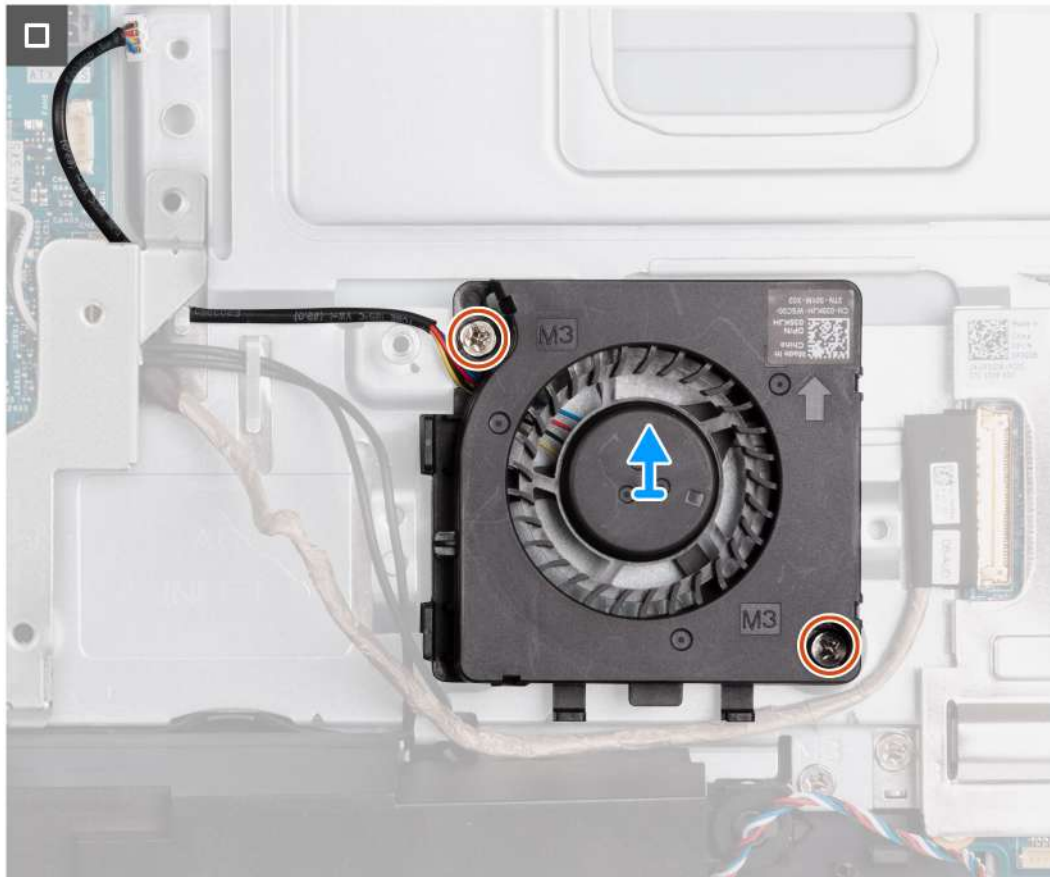
Obrázek 54. Demontáž jednotky ventilátoru napájecího zdroje
