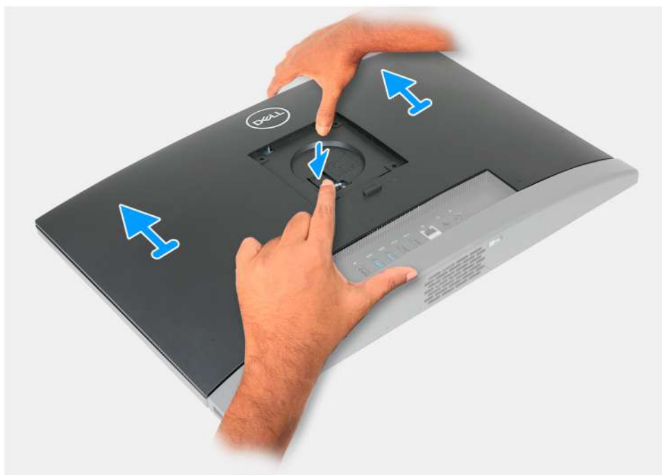
Obrázek 82. Demontáž zadního krytu
