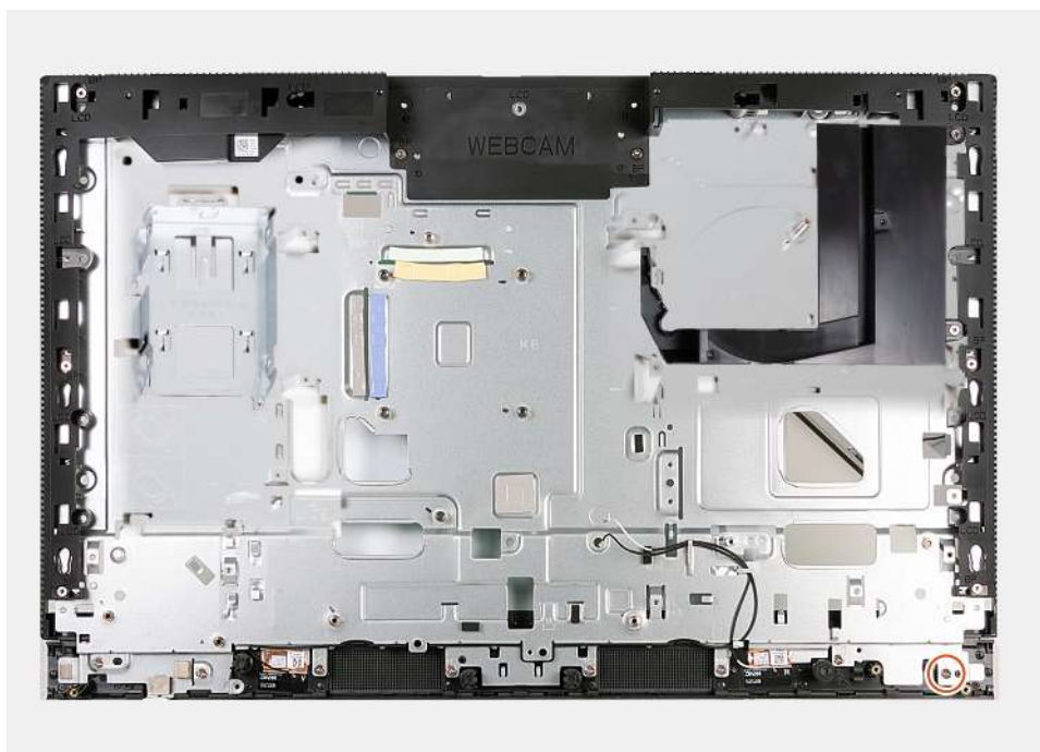
Obrázek 123. Demontáž základny sestavy displeje
