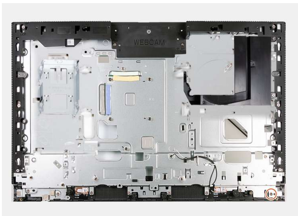
Obrázek 124. Montáž základny sestavy displeje
