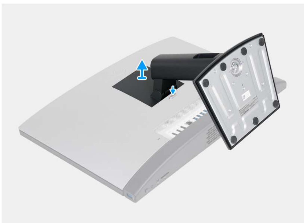
Obrázek 19. Demontáž pevného stojanu
