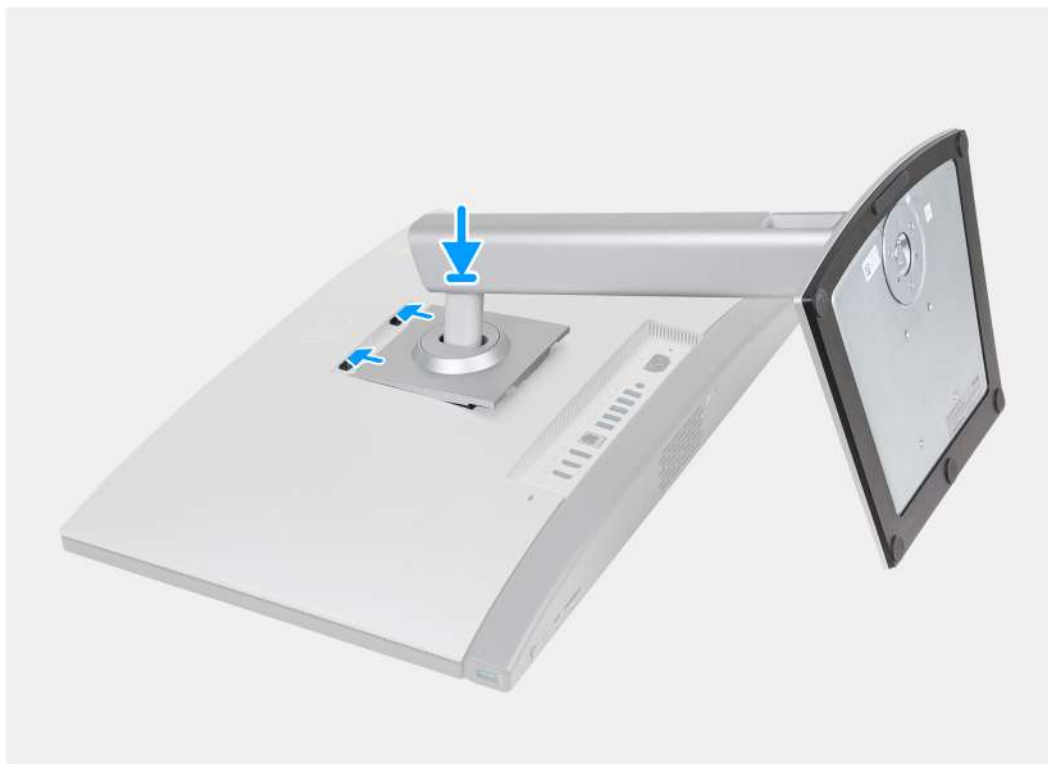
Obrázek 20. Instalace výškově nastavitelného stojanu (HAS)
