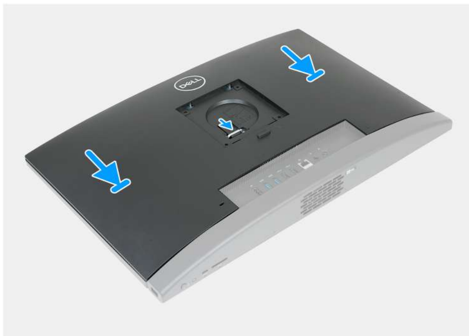
Obrázek 83. Montáž zadního krytu
