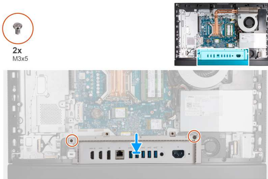
Obrázek 43. Montáž krytu I/O
