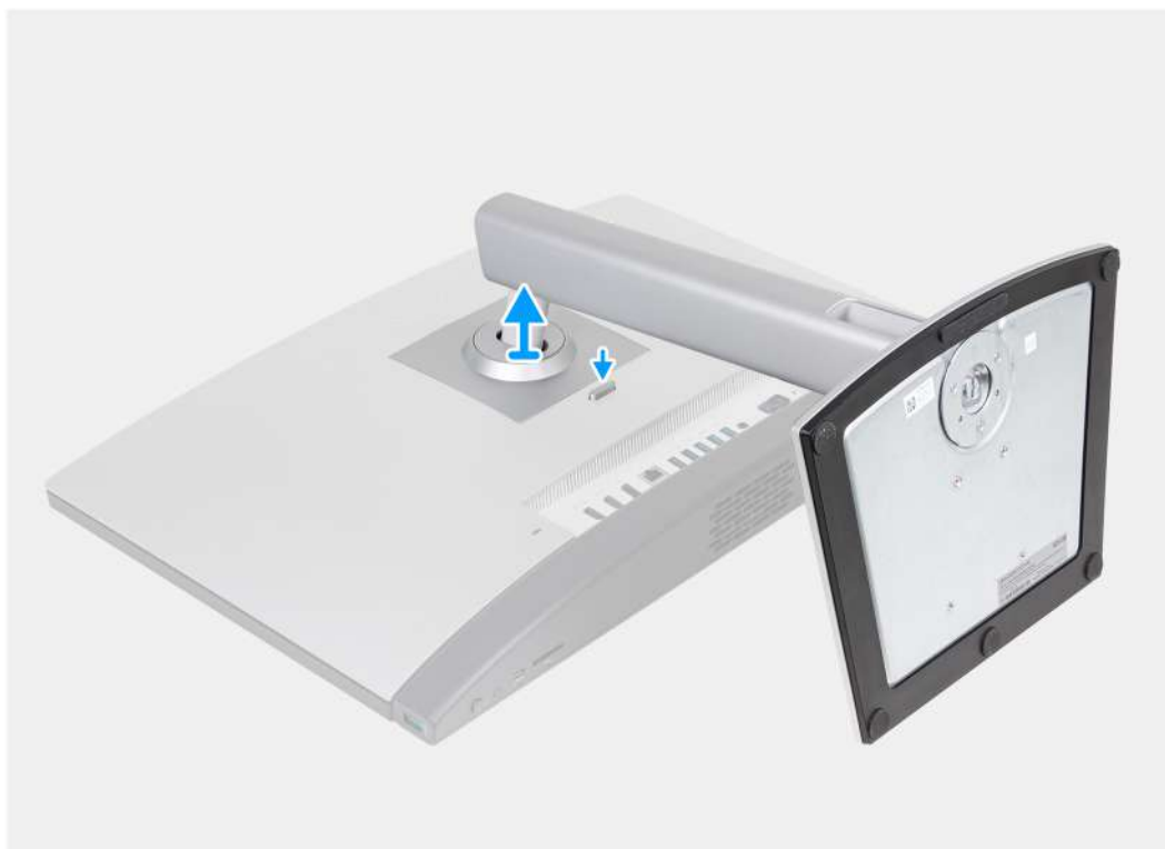
Obrázek 18. Demontáž výškově nastavitelného stojanu (HAS)
