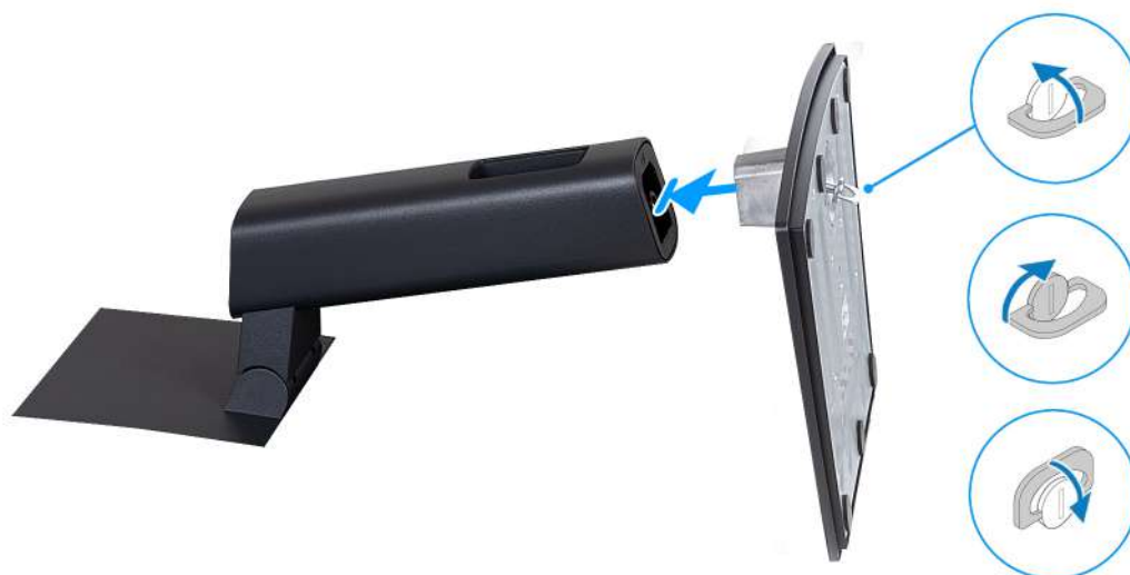
Obrázek 10. Montáž podstavce stojanu
