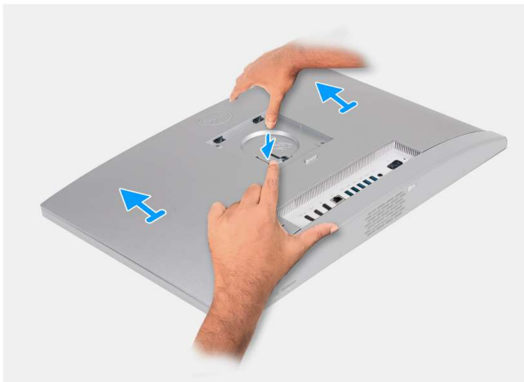
Obrázek 22. Demontáž zadního krytu
