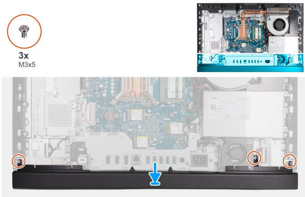
Obrázek 45. Montáž spodního krytu
