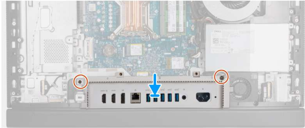
Obrázek 42. Montáž krytu I/O
