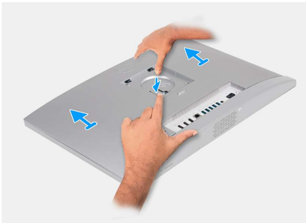
Obrázek 19. Demontáž zadního krytu
