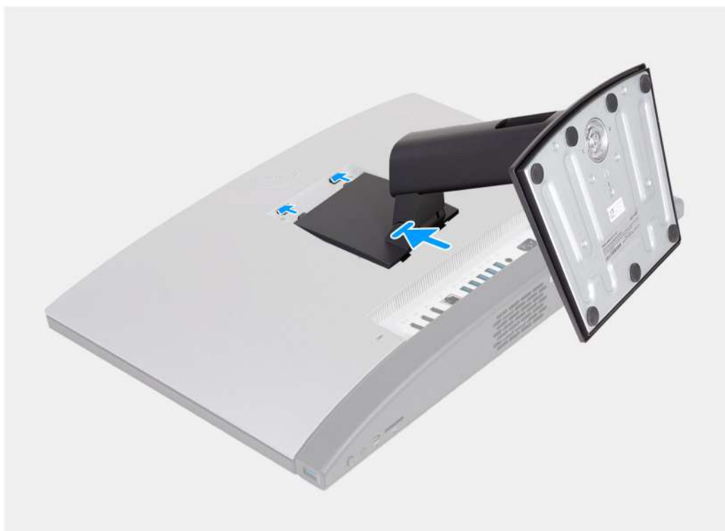
Obrázek 18. Montáž pevného stojanu
