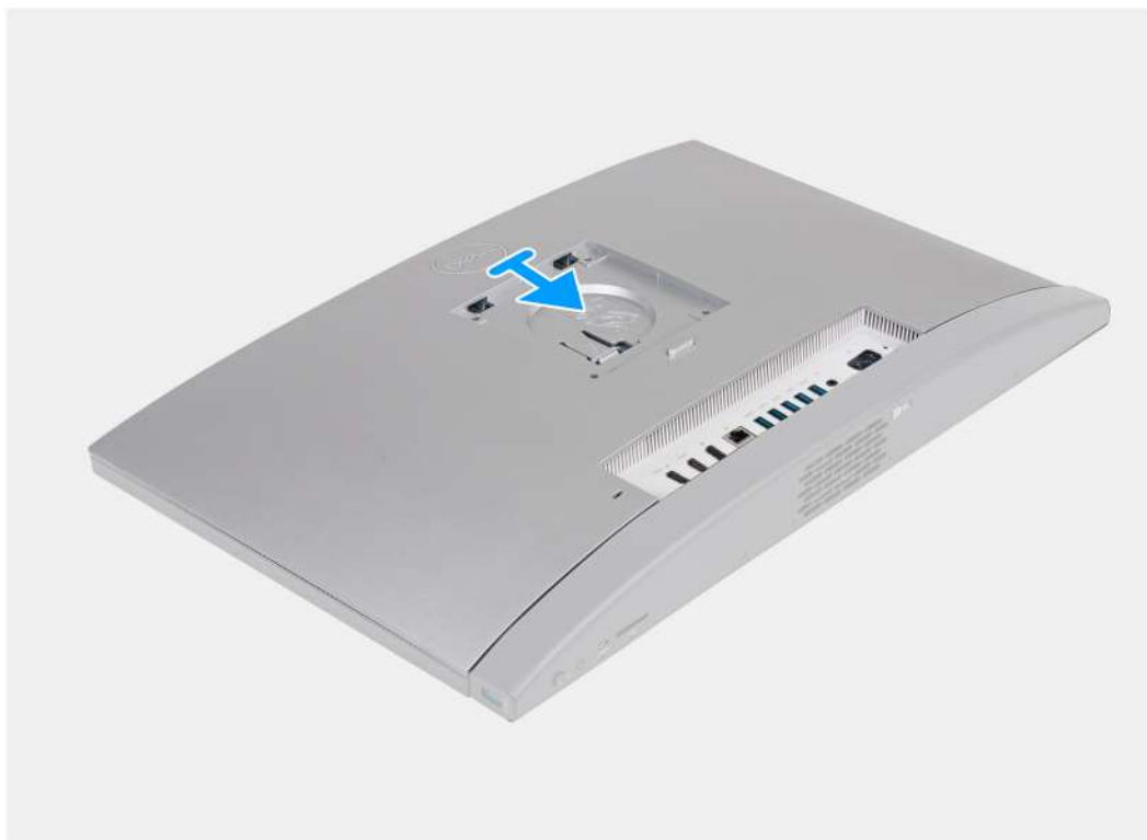
Obrázek 20. Montáž zadního krytu
