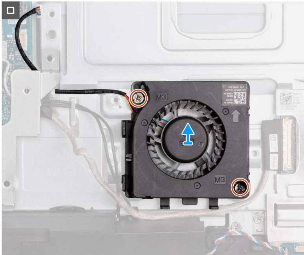
Obrázek 53. Demontáž jednotky ventilátoru napájecího zdroje
