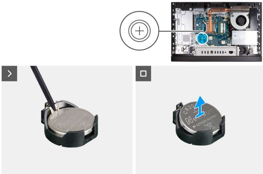
Obrázek 39. Vymutí knoflíkové baterie
