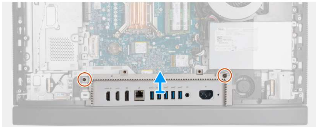
Obrázek 41. Demontáž krytu I/O
