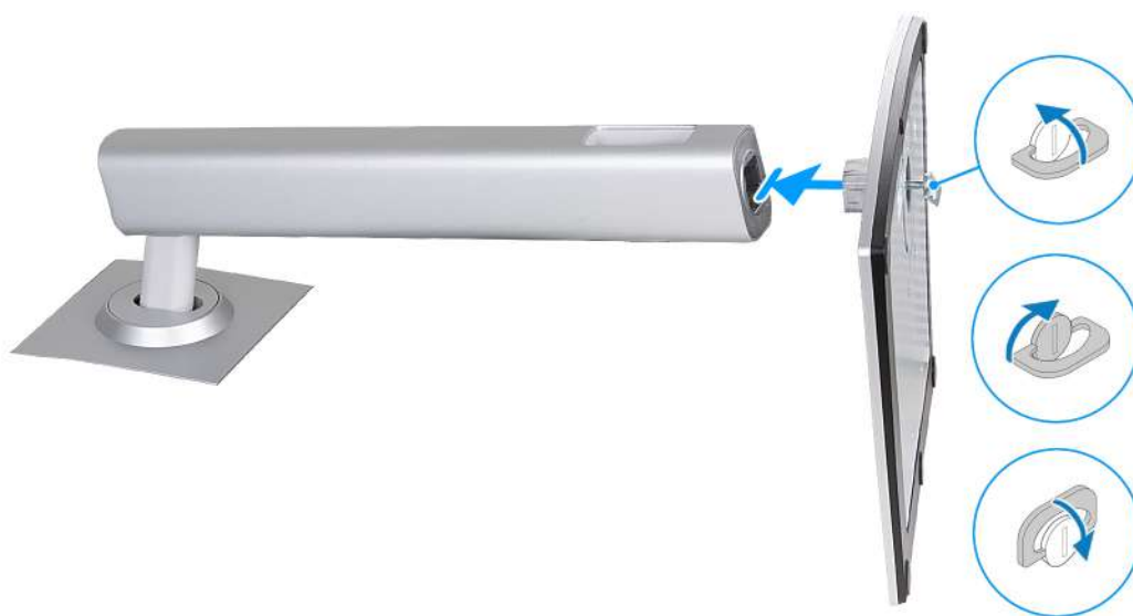
Obrázek 10. Montáž podstavce stojanu
