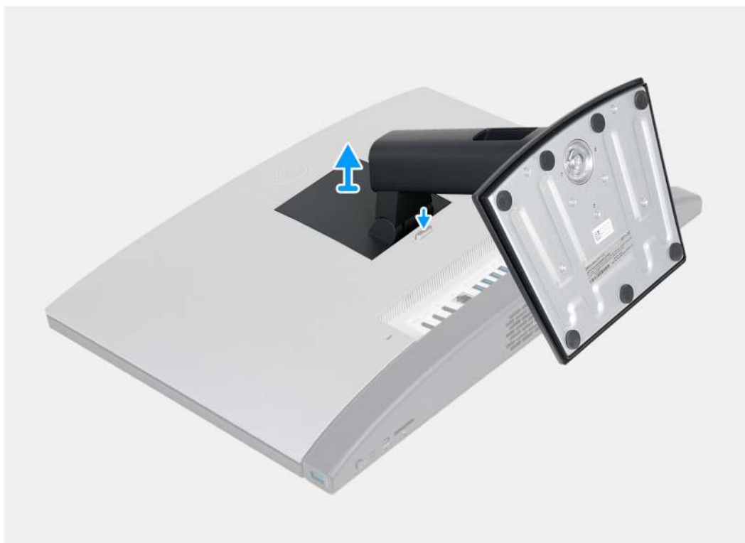
Obrázek 16. Demontáž pevného stojanu
