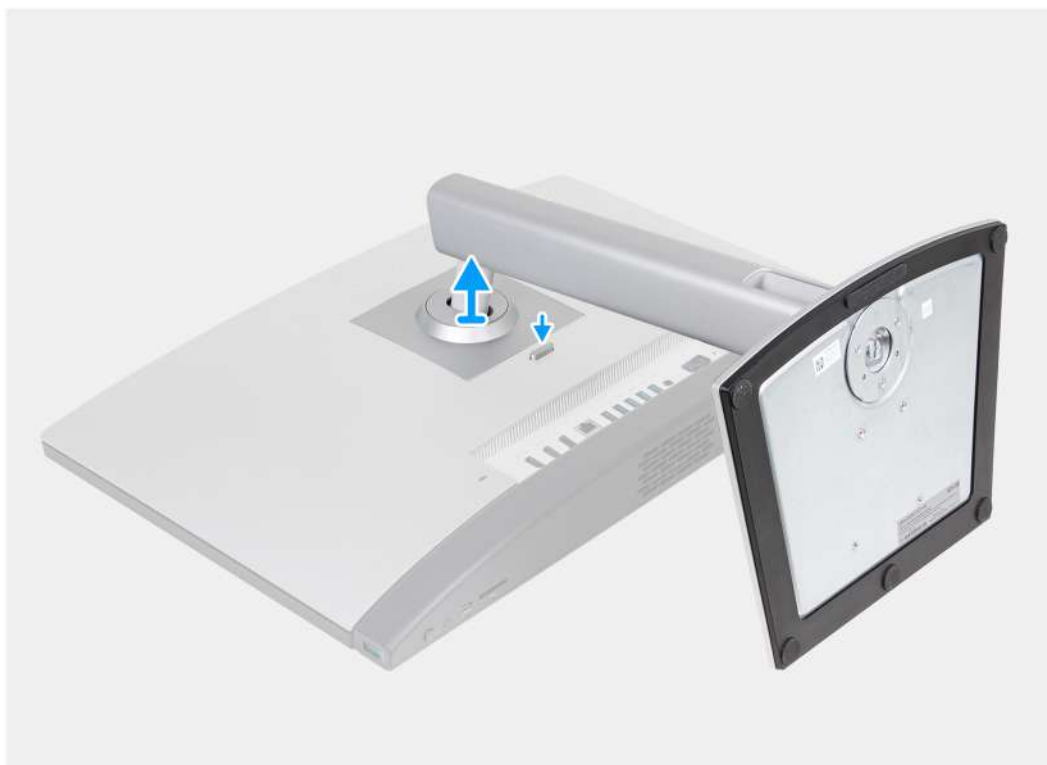
Obrázek 15. Demontáž výškově nastavitelného stojanu (HAS)
