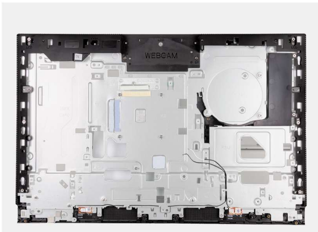
Obrázek 75. Demontáž základny sestavy displeje
