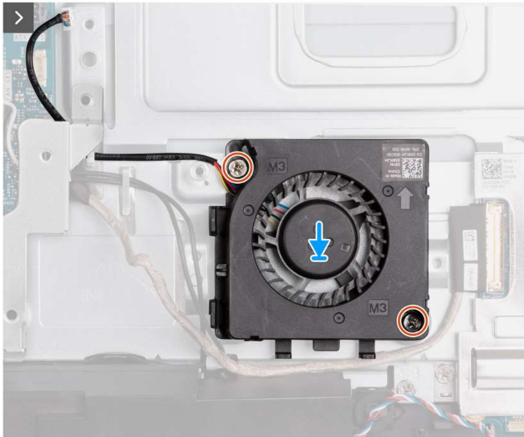
Obrázek 54. Montáž ventilátoru napájecího zdroje
