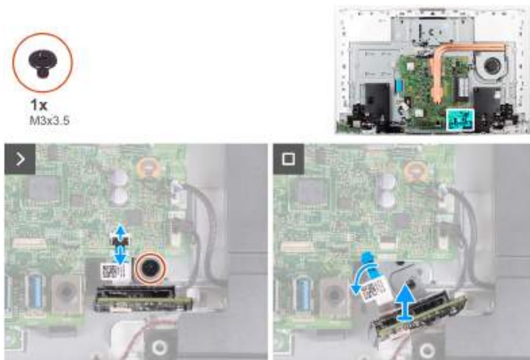
Obrázek 47. Demontáž čtečky paměťových karet
