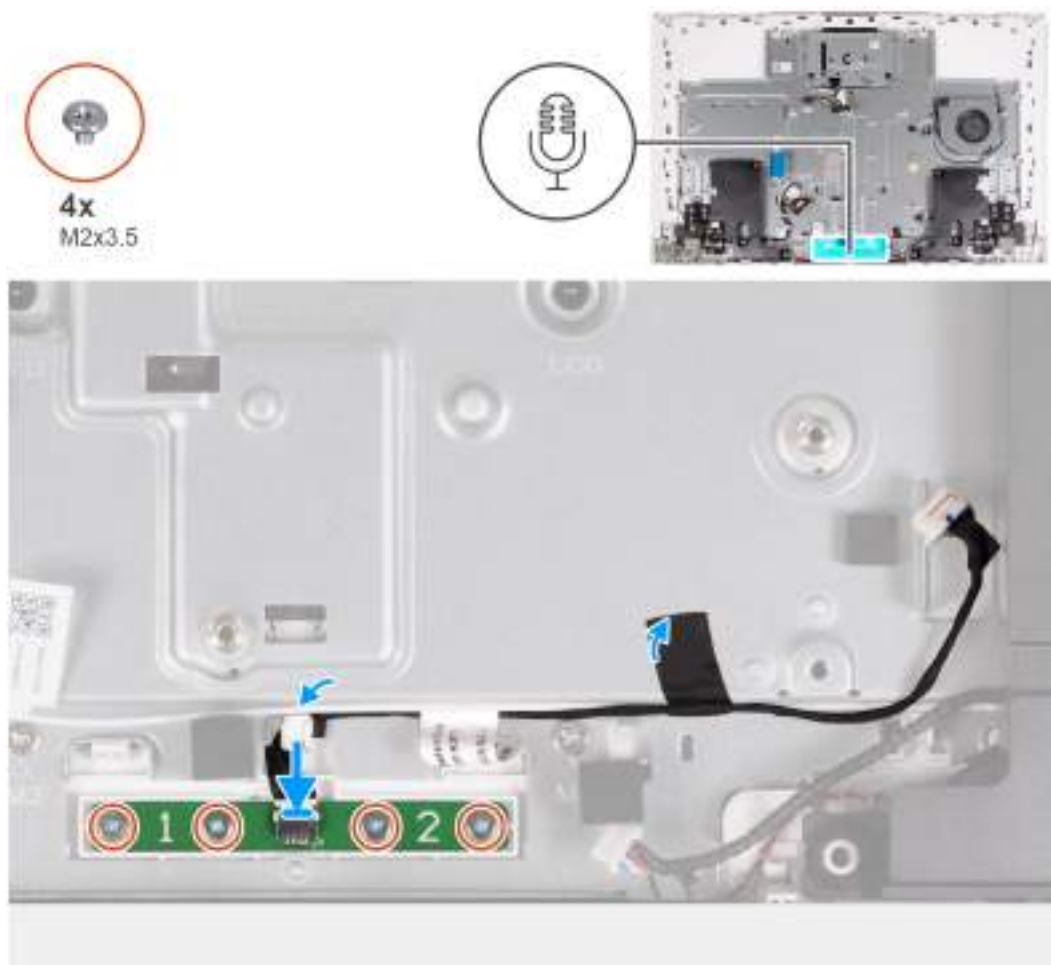
Obrázek 58. Montáž mikrofonního modulu
