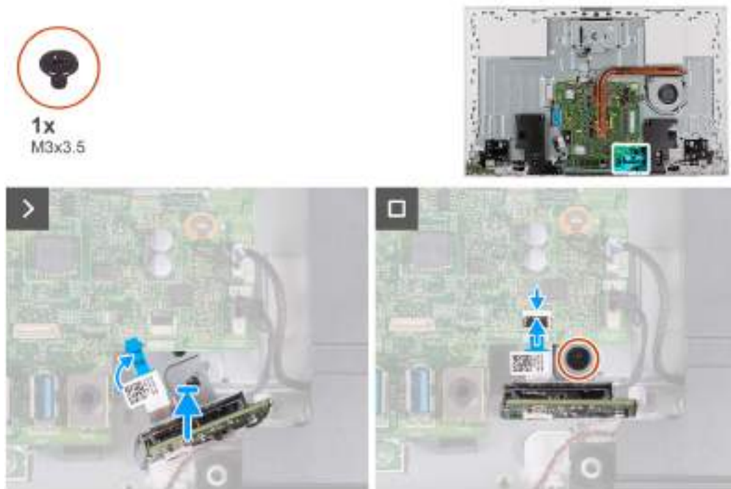
Obrázek 47. Montáž čtečky paměťových karet
