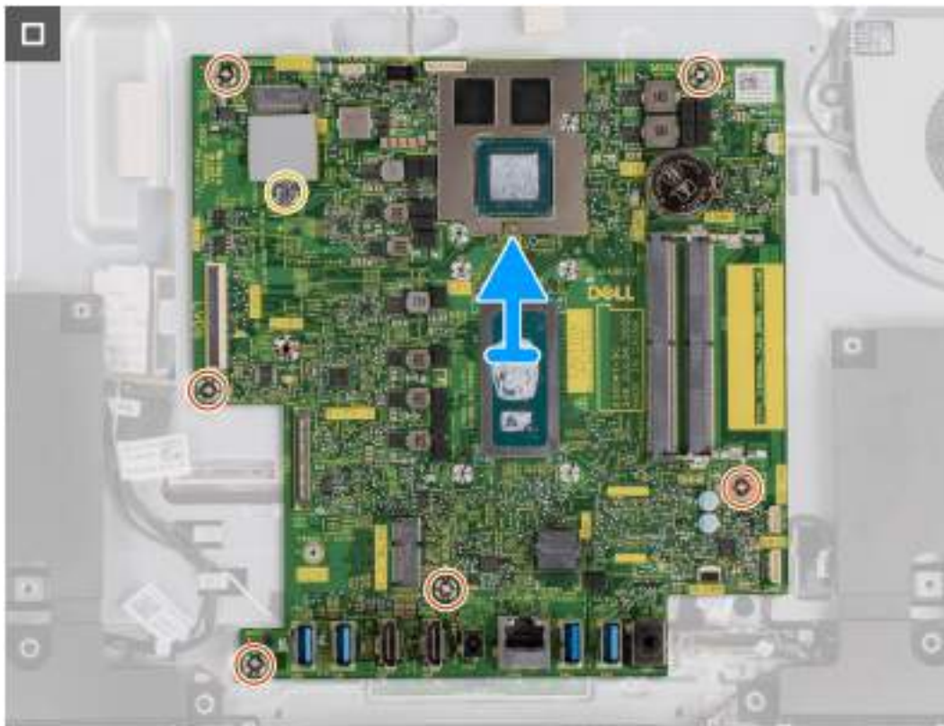
Obrázek 52. Demontáž základní desky ze šasi
