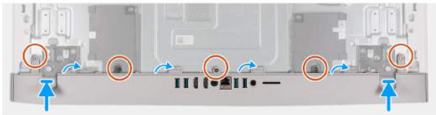
Obrázek 23. Montáž spodního krytu
