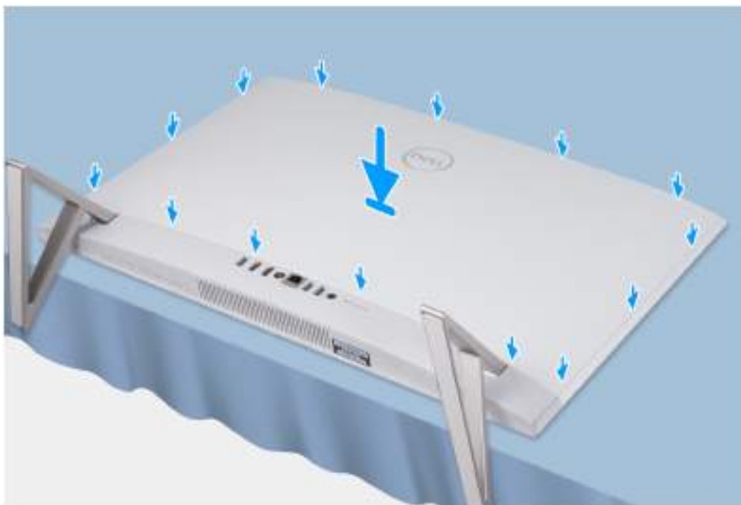
Obrázek 21. Montáž zadního krytu
