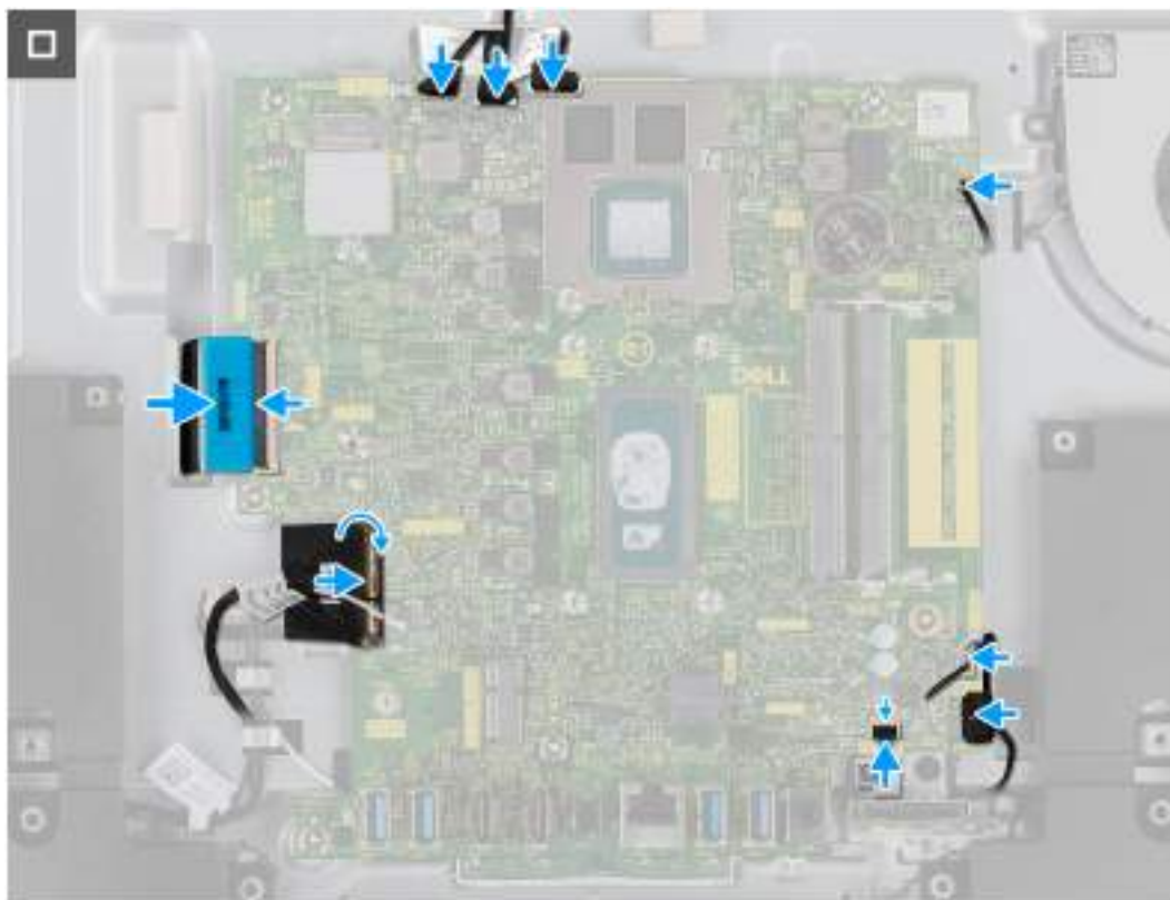
Obrázek 55. Montáž základní desky
