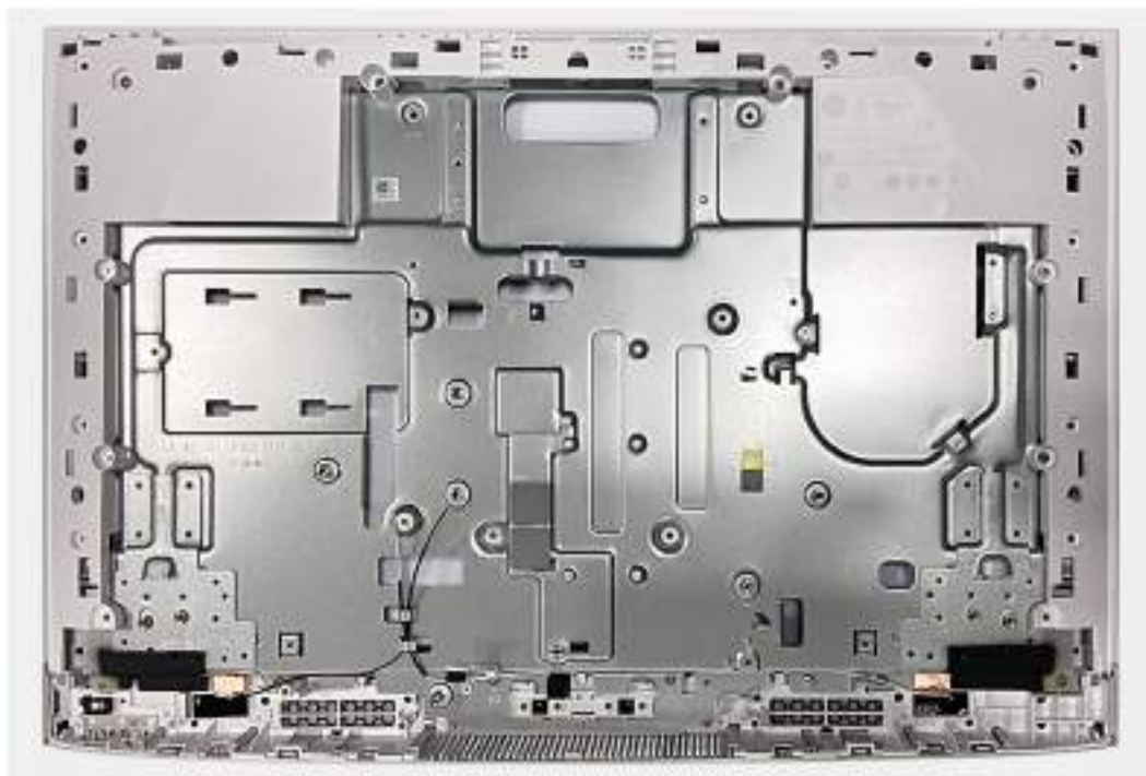
Obrázek 64. Demontáž sestavy středního rámu
