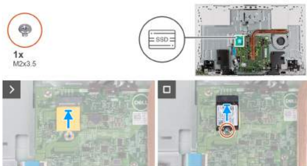
Obrázek 29. Montáž disku SSD M.2 2230
