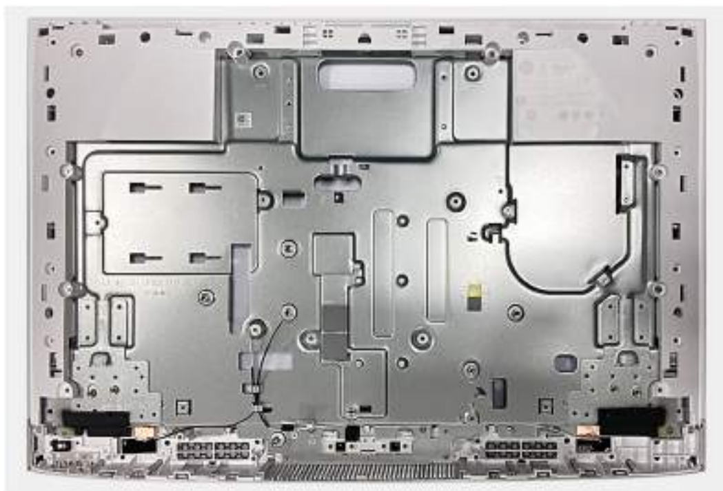
Obrázek 65. Montáž sestavy středního rámu
