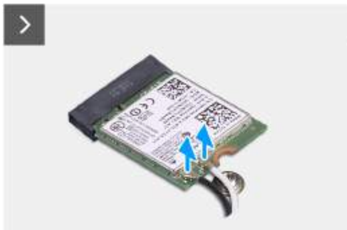
Obrázek 32. Demontáž bezdrátové karty
