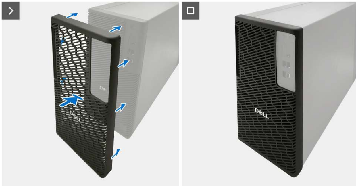
Obrázek 22. Montáž prachového filtru
