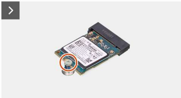
Obrázek 34. Demontáž disku SSD M.2 2230 ze slotu č. 1
