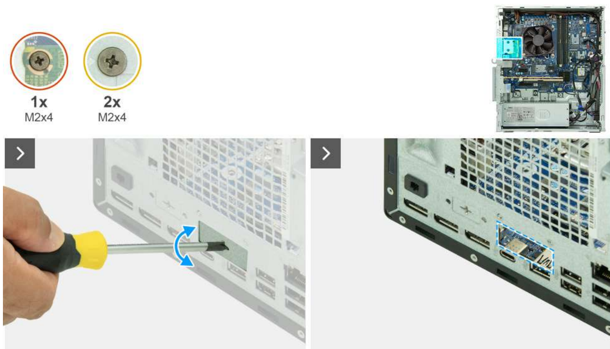
Obrázek 79. Montáž modulu portu optického vlákna
