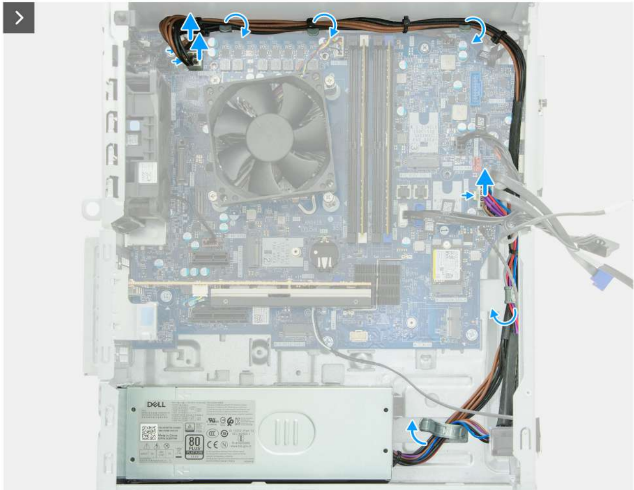
Obrázek 88. Demontáž napájecího zdroje
