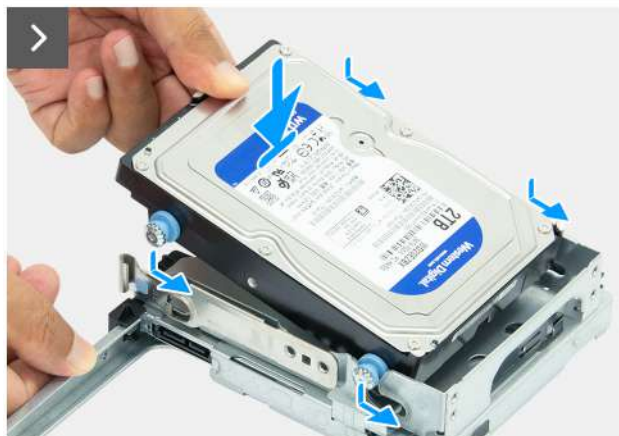
Obrázek 64. Montáž pevného disku
