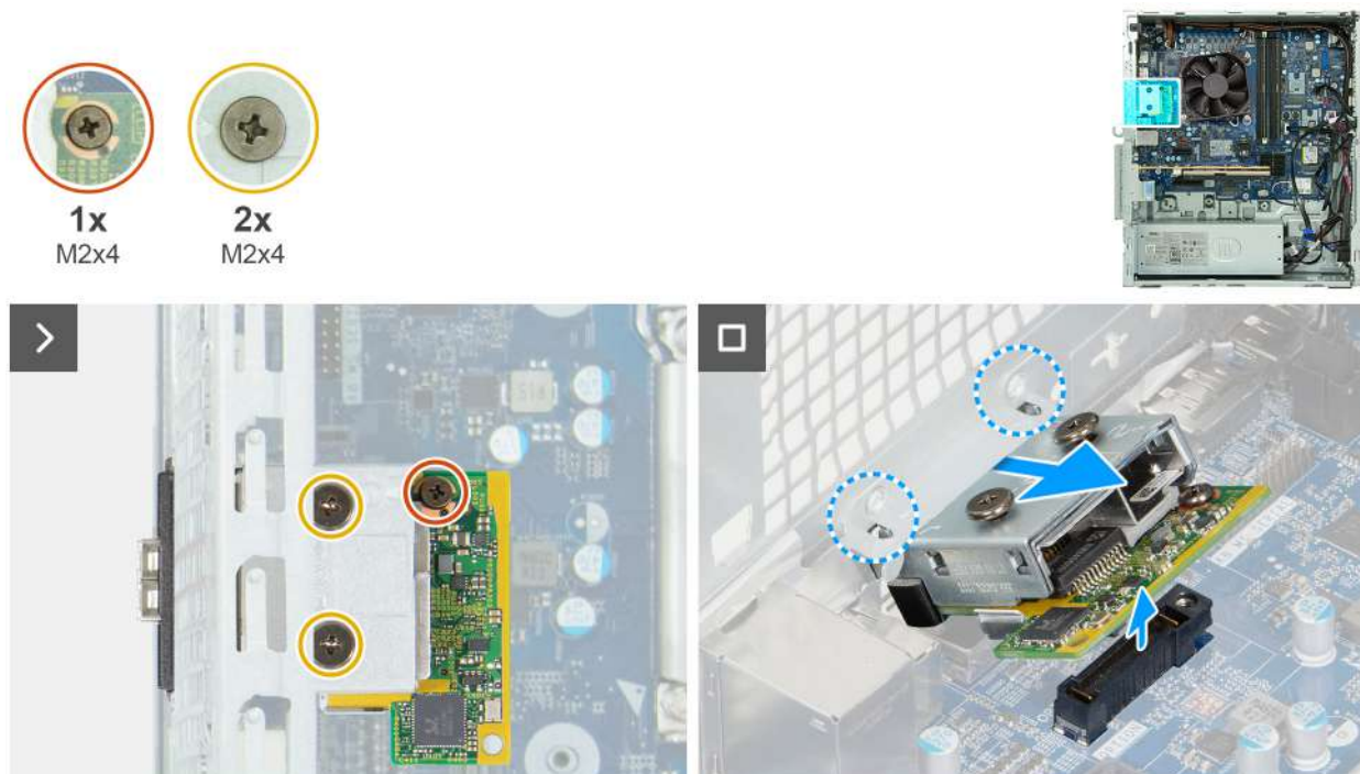
Obrázek 78. Demontáž modulu portu z optických vláken
