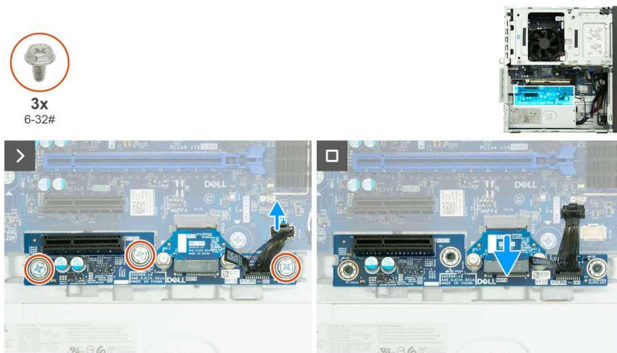
Obrázek 44. Vyjmutí rozšiřující desky PCIe
