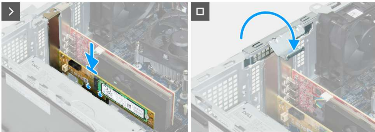
Obrázek 49. Montáž rozšiřující karty SSD
