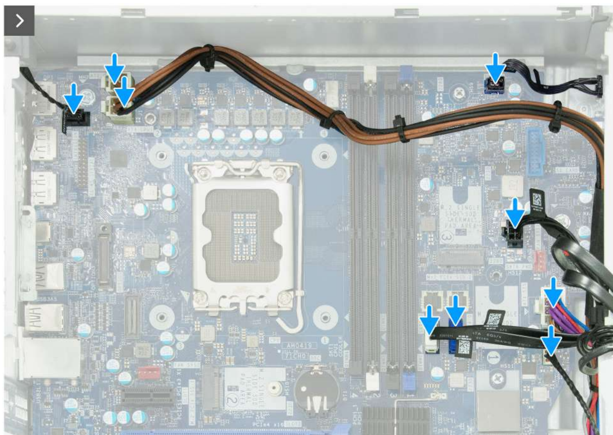
Obrázek 104. Montáž základní desky
