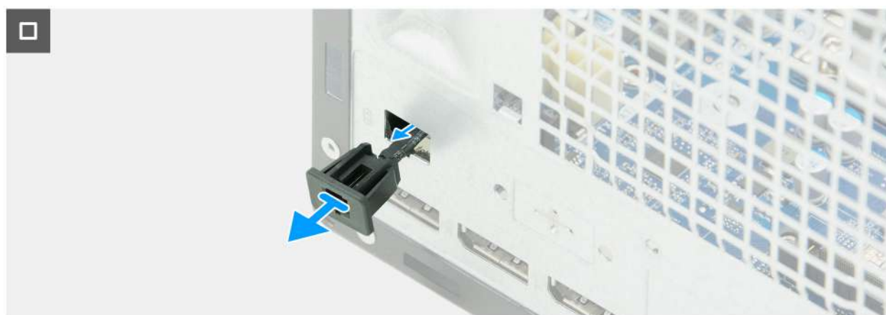
Obrázek 70. Demontáž kabelu dálkového vypínače napájení
