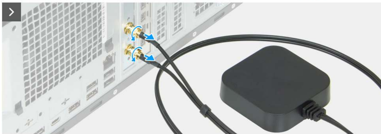
Obrázek 50. Vyjmutí rozšiřující karty externí antény
