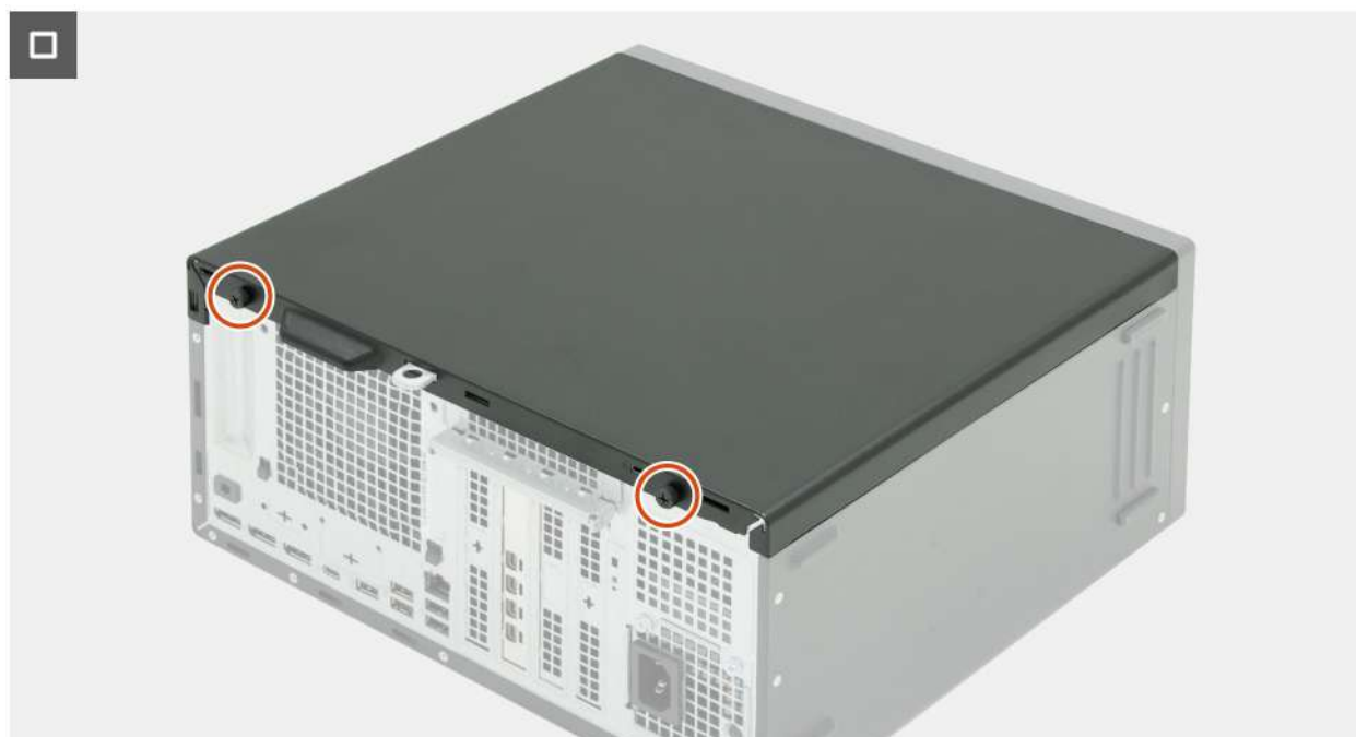
Obrázek 16. Montáž levého bočního krytu
