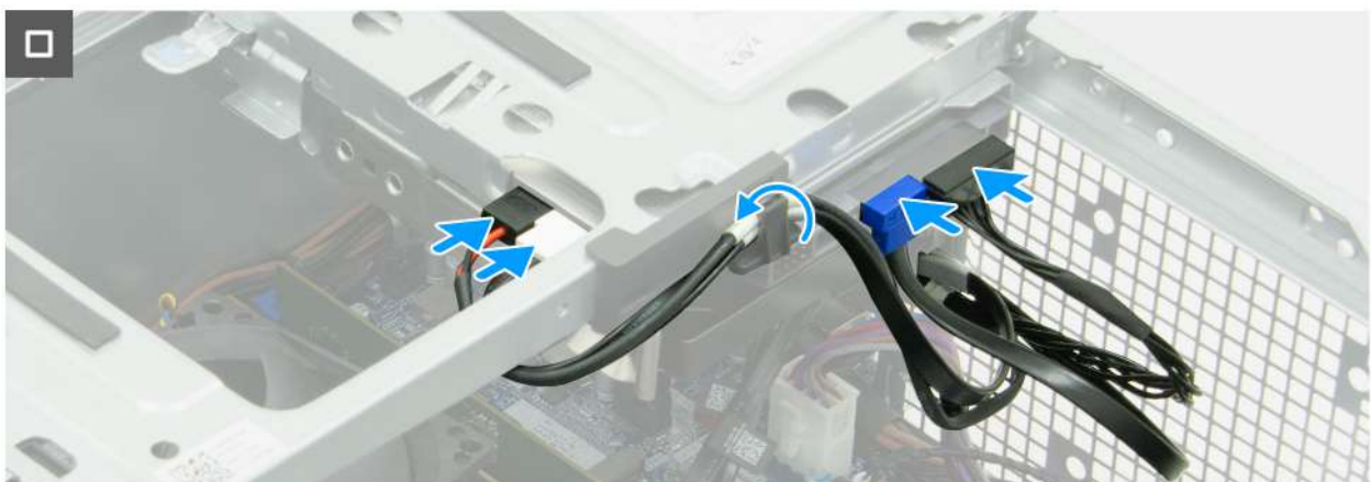
Obrázek 62. Montáž diskové pozice
