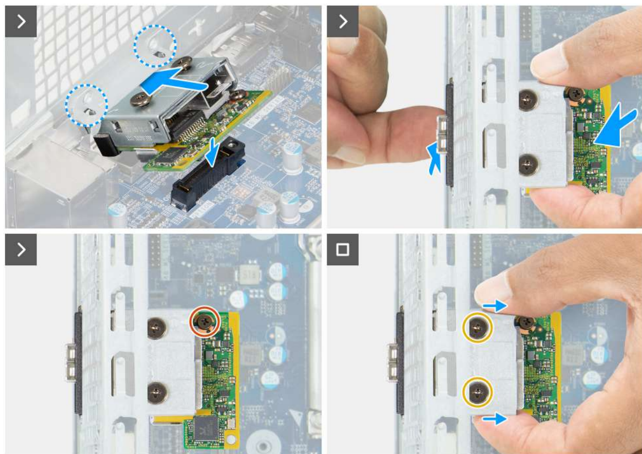
Obrázek 80. Montáž modulu portu optického vlákna
