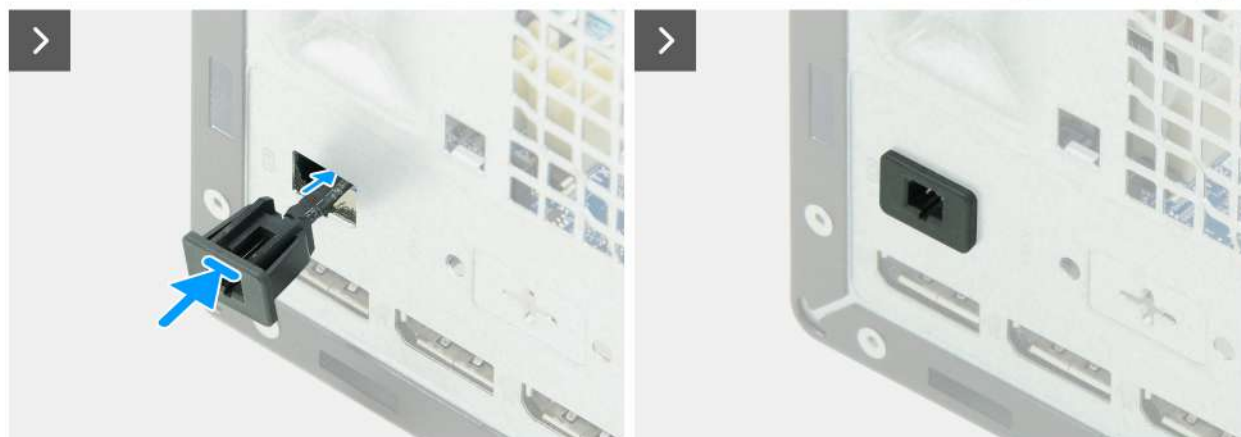
Obrázek 71. Montáž kabelu dálkového vypínače napájení
