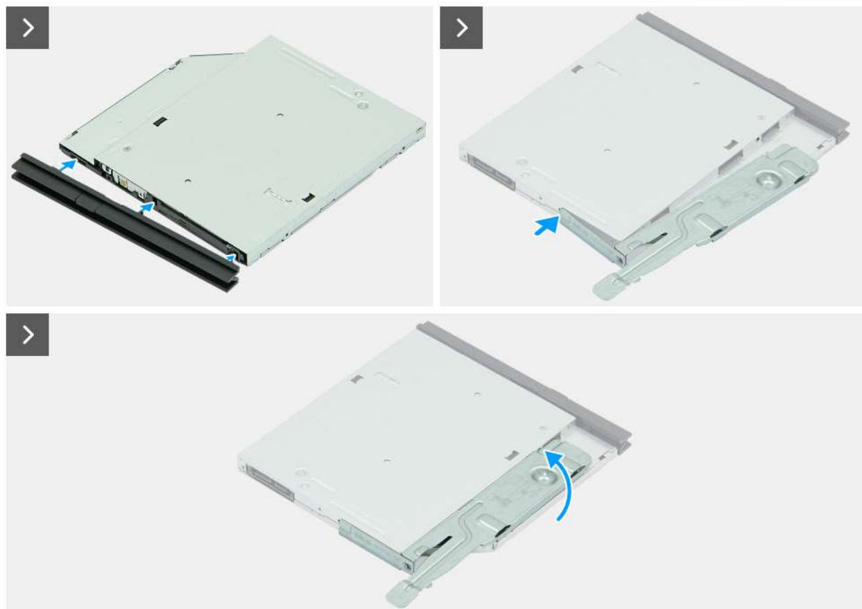
Obrázek 56. Montáž optické jednotky
