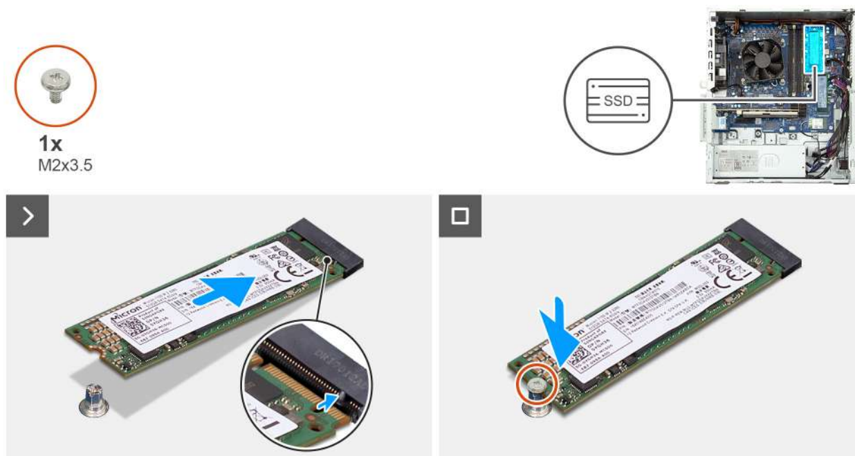
Obrázek 39. Montáž disku SSD M.2 2280 do slotu č. 2
