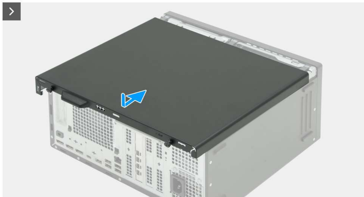
Obrázek 15. Montáž levého bočního krytu
