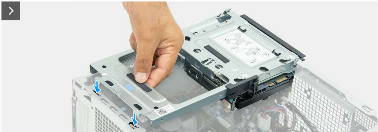
Obrázek 61. Montáž diskové pozice
