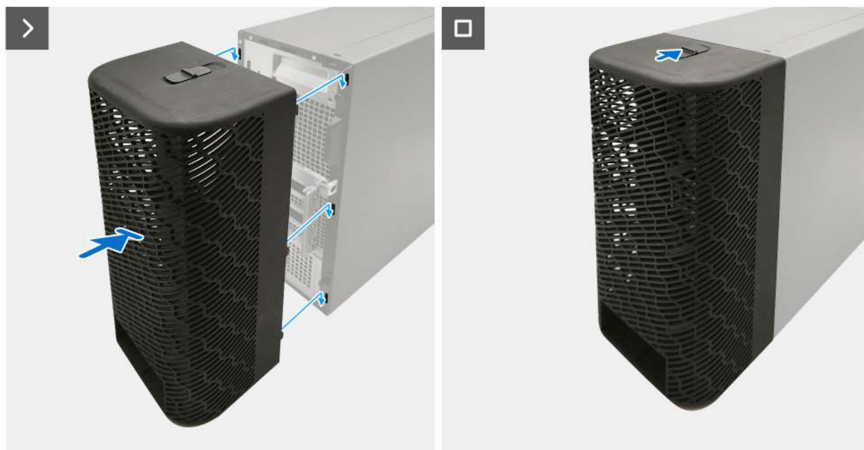
Obrázek 12. Montáž krytu kabeláže
