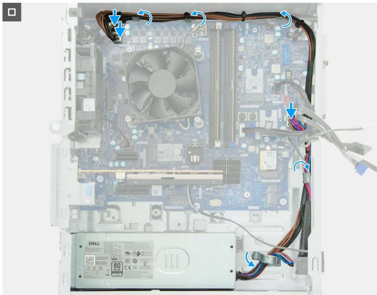
Obrázek 91. Montáž napájecího zdroje
