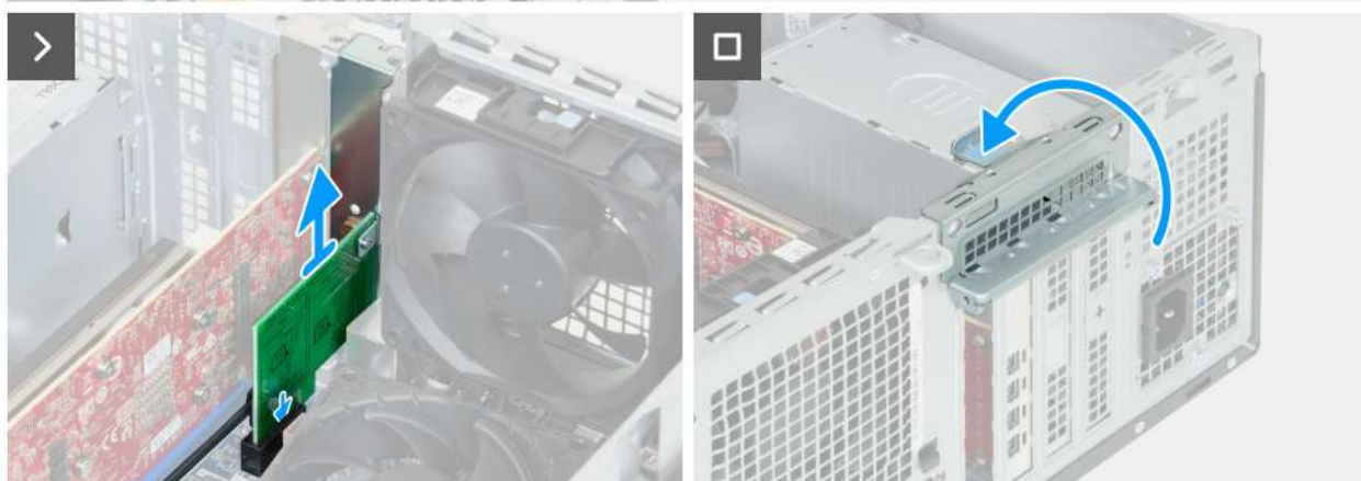
Obrázek 51. Vyjmutí rozšiřující karty externí antény
