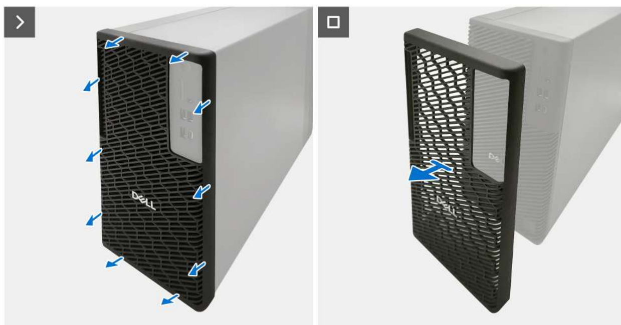
Obrázek 21. Demontáž prachového filtru
