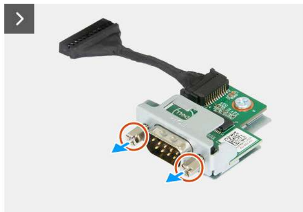
Obrázek 82. Montáž modulu sériového portu
