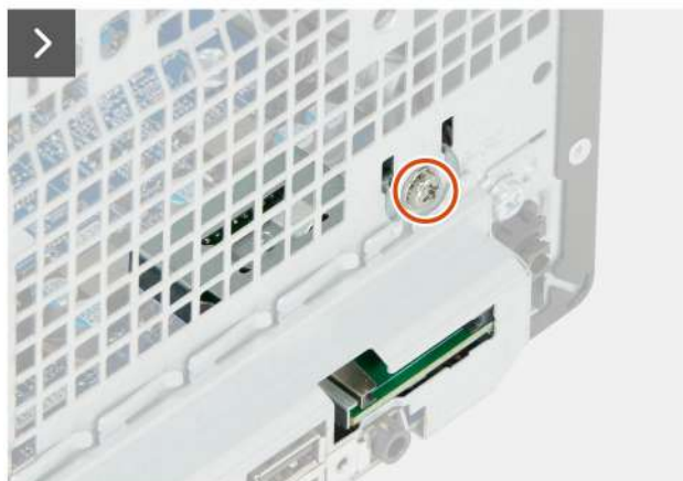
Obrázek 84. Demontáž čtečky paměťových karet
