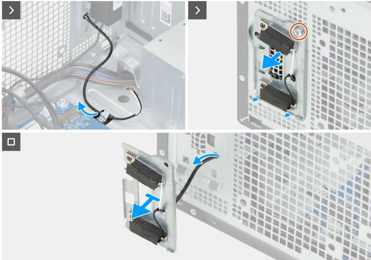
Obrázek 86. Demontáž anténních modulů
