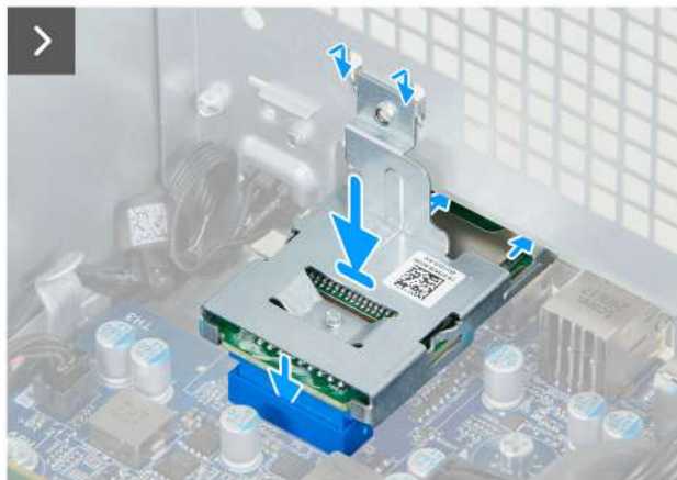
Obrázek 85. Montáž čtečky paměťových karet
