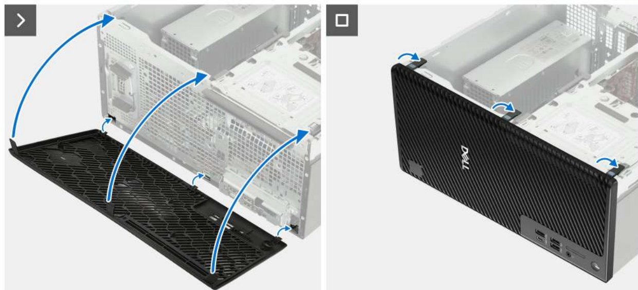
Obrázek 24. Montáž předního krytu
