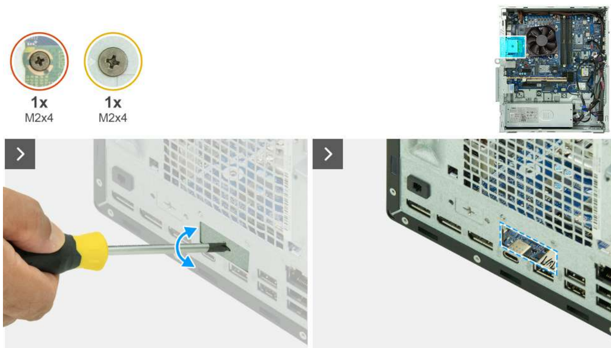
Obrázek 76. Montáž modulu volitelného portu
