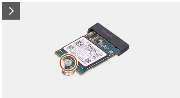
Obrázek 29. Demontáž disku SSD M.2 2230 ze slotu č. 0
