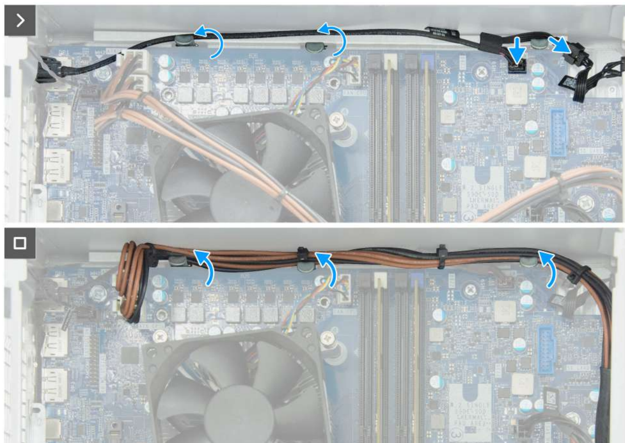
Obrázek 72. Montáž kabelu dálkového vypínače napájení
