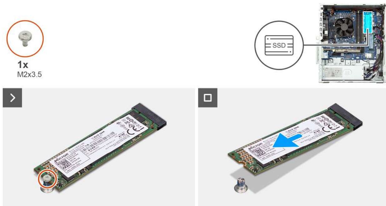
Obrázek 38. Demontáž disku SSD M.2 2280 ze slotu č. 2
