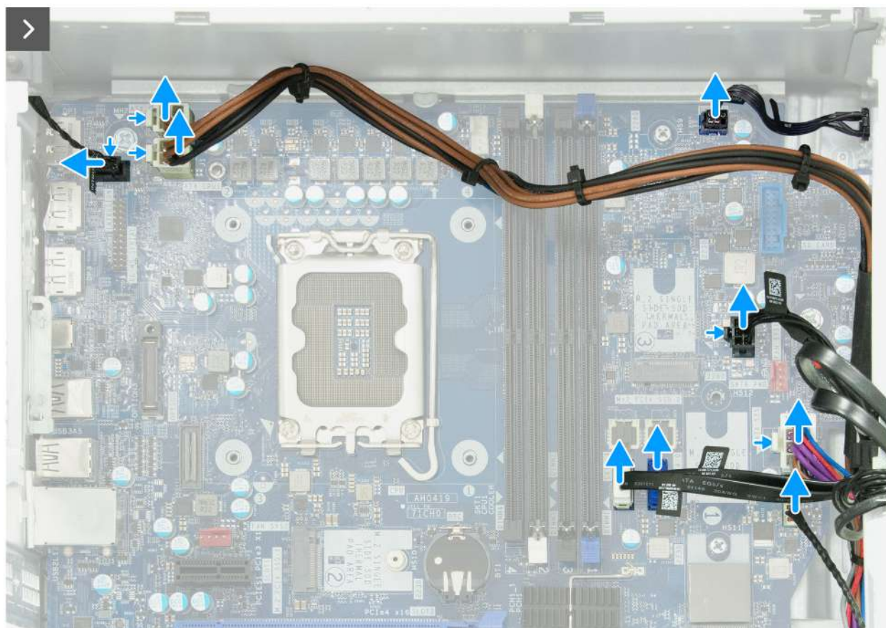
Obrázek 98. Demontáž základní desky
