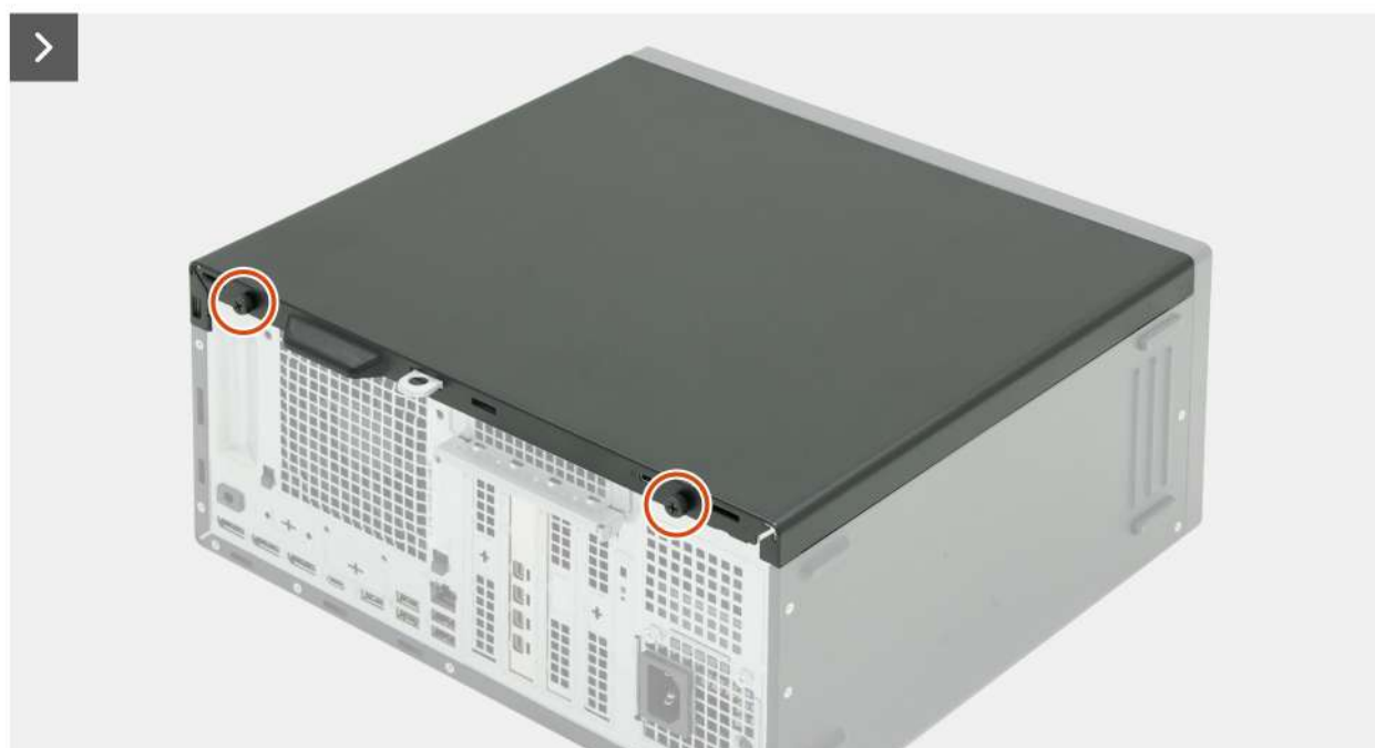
Obrázek 13. Demontáž levého bočního krytu
