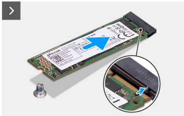
Obrázek 32. Montáž disku SSD M.2 2280 do slotu č. 0
