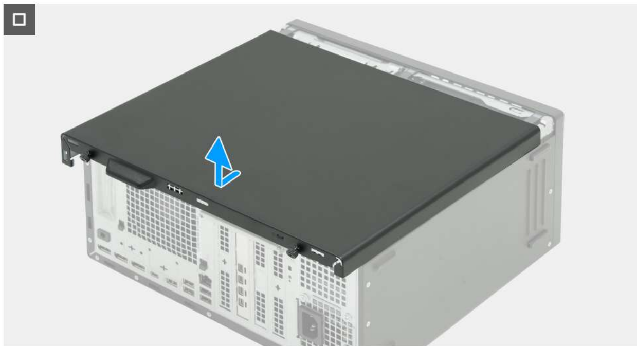
Obrázek 14. Demontáž levého bočního krytu
