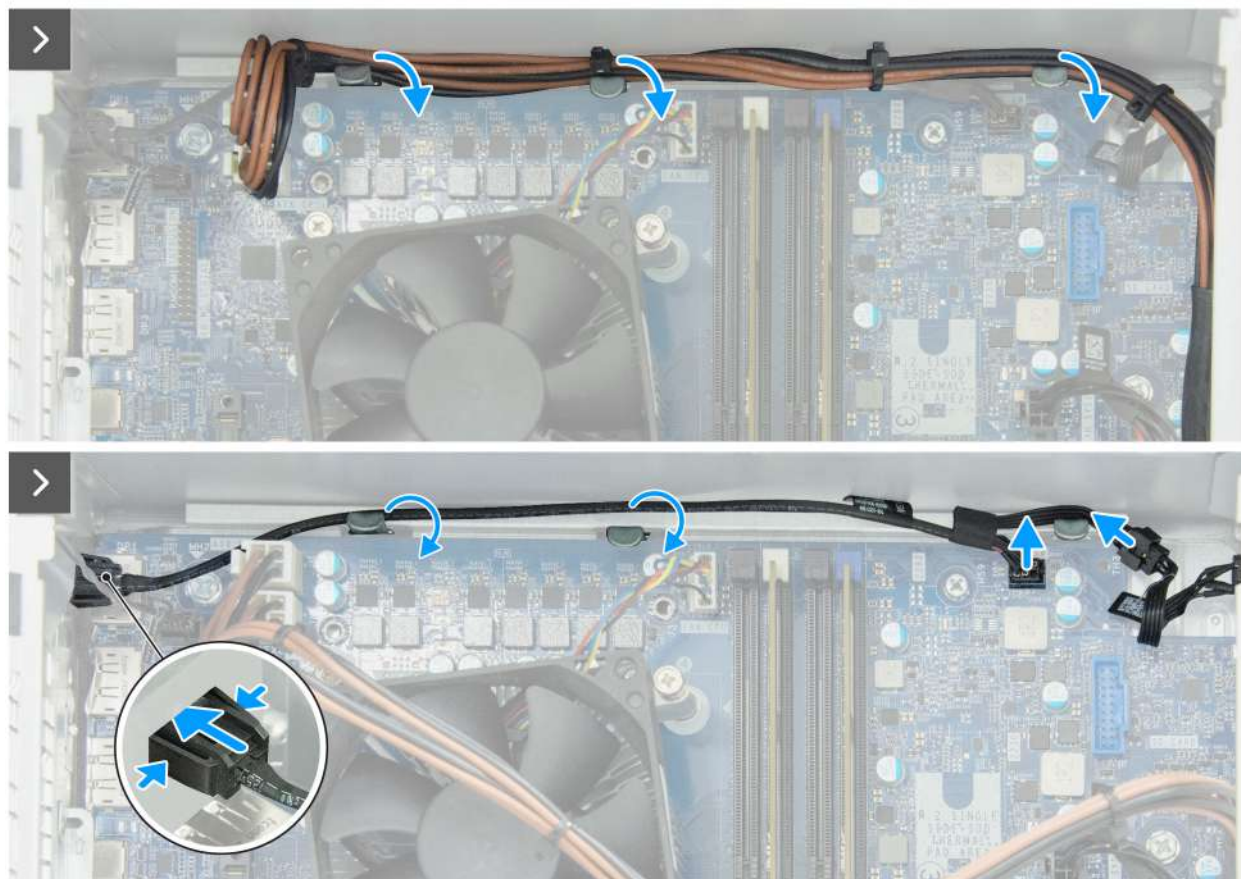
Obrázek 69. Demontáž kabelu dálkového vypínače napájení
