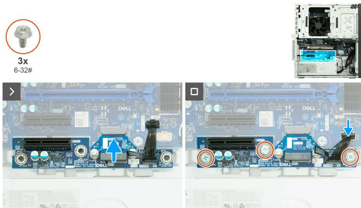
Obrázek 45. Montáž rozšiřující desky PCIe
