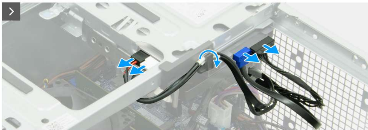
Obrázek 58. Demontáž diskové pozice
