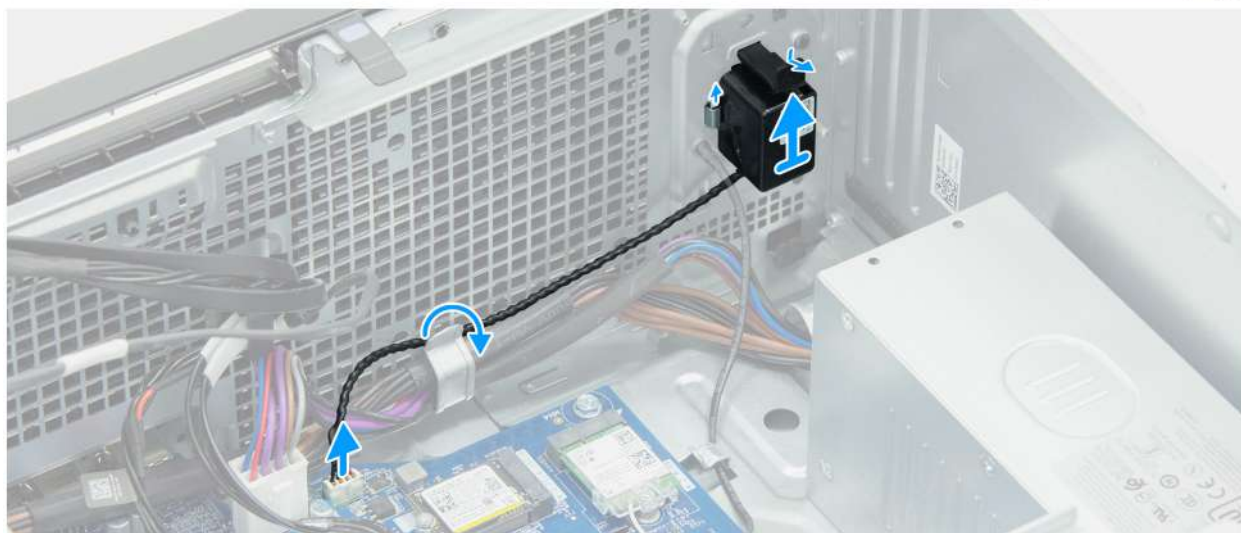
Obrázek 25. Demontáž interního reproduktoru
