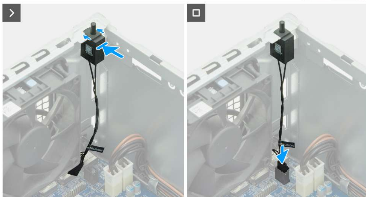
Obrázek 66. Montáž spínače detekce vniknutí do šasi
