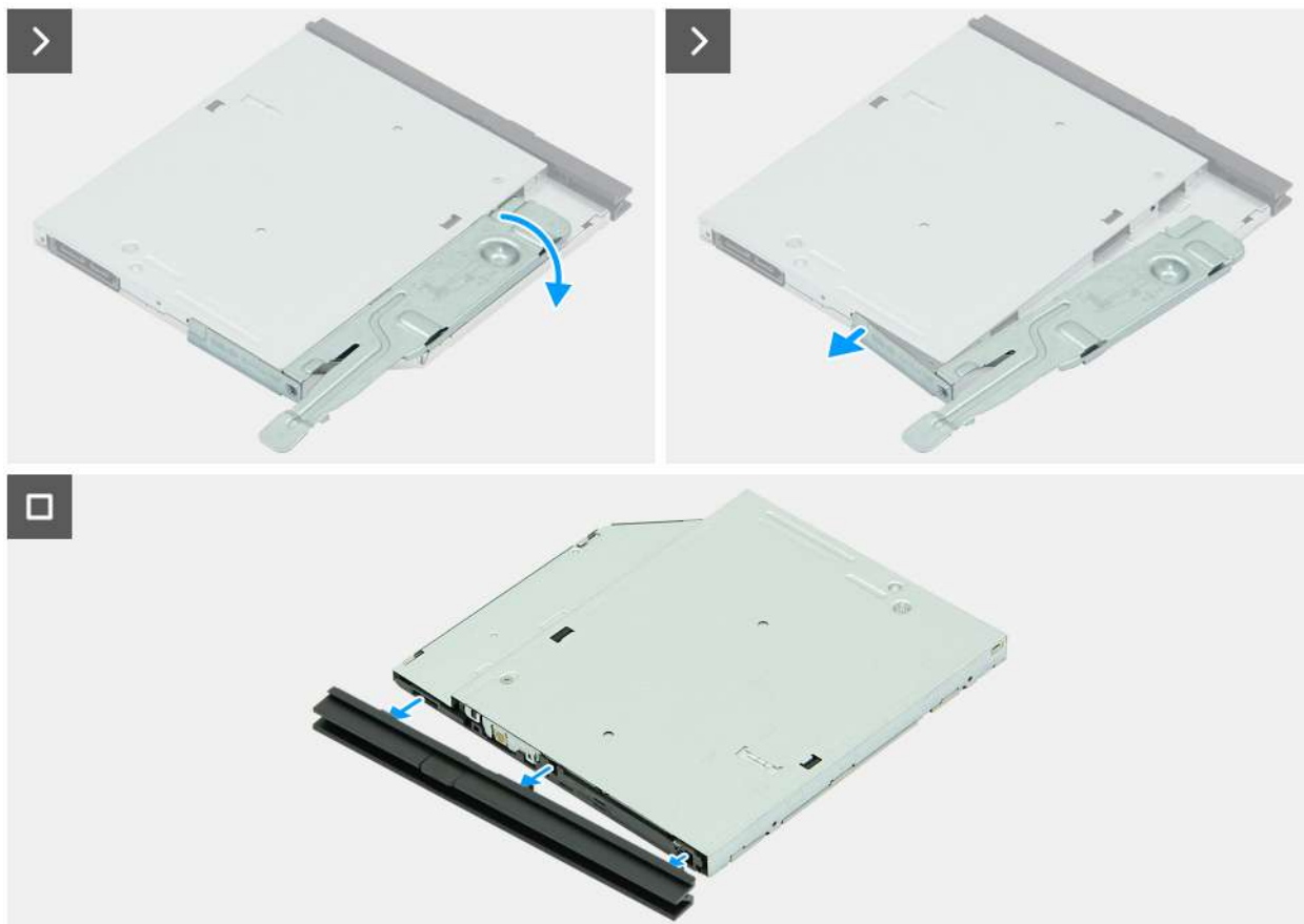
Obrázek 55. Vymutí optické jednotky
