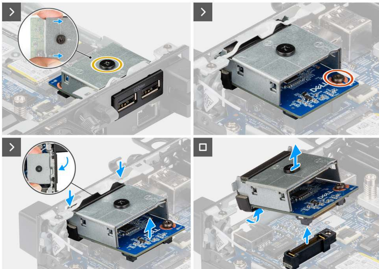
Obrázek 38. Demontáž modulu se dvěma porty USB 3.2 2. generace
