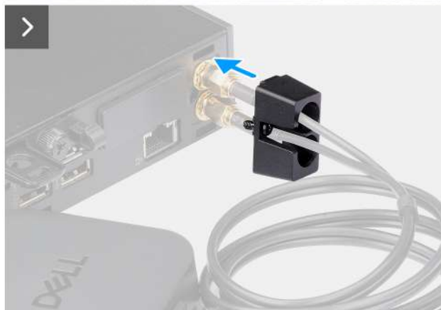
Obrázek 35. Montáž externí antény
