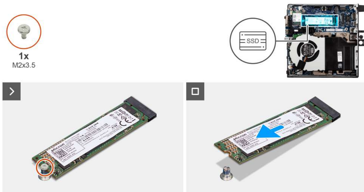
Obrázek 19. Demontáž disku SSD M.2 2280
