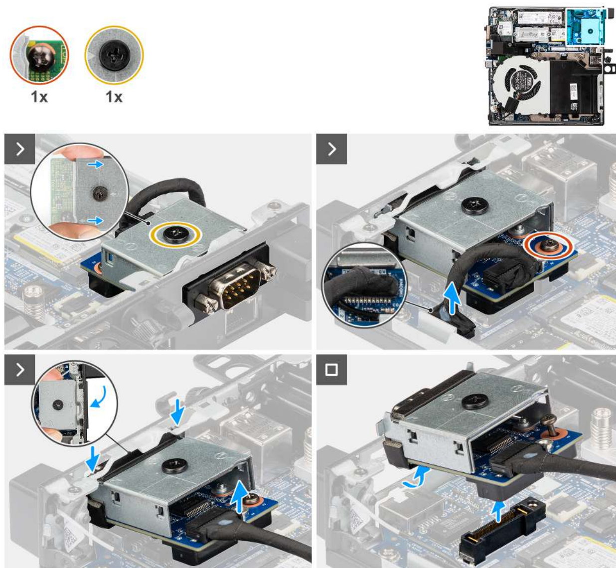
Obrázek 59. Demontáž modulu sériového portu
