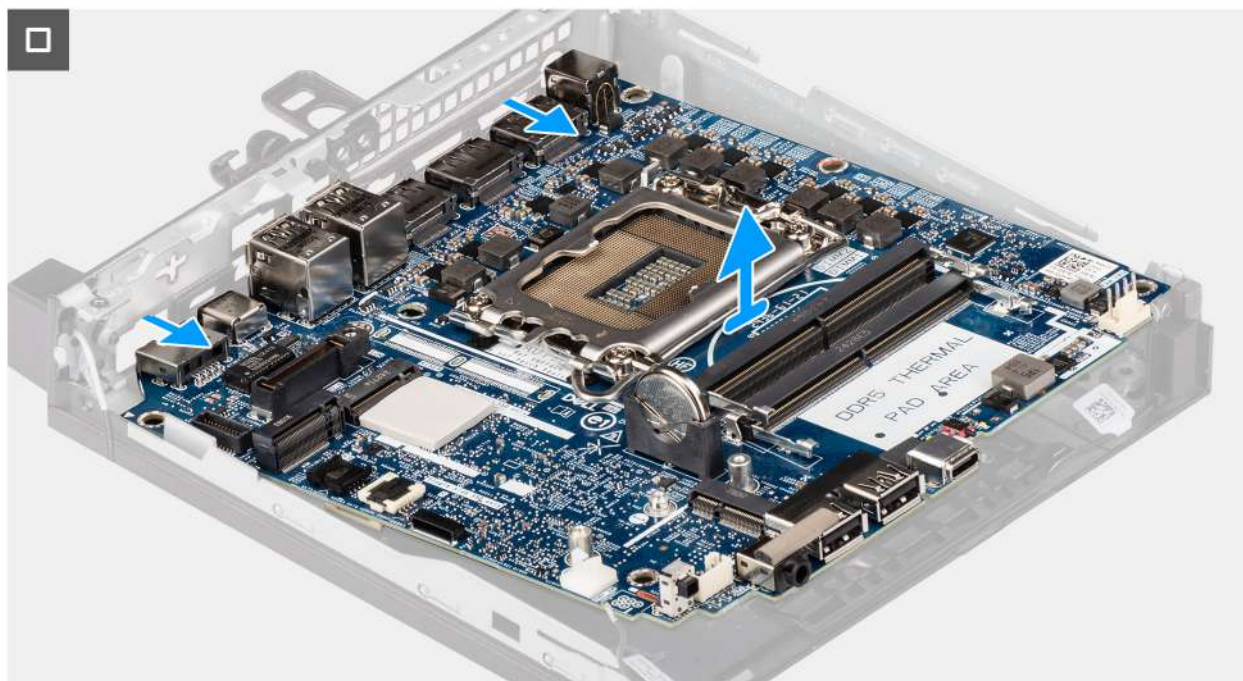
Obrázek 82. Demontáž základní desky
