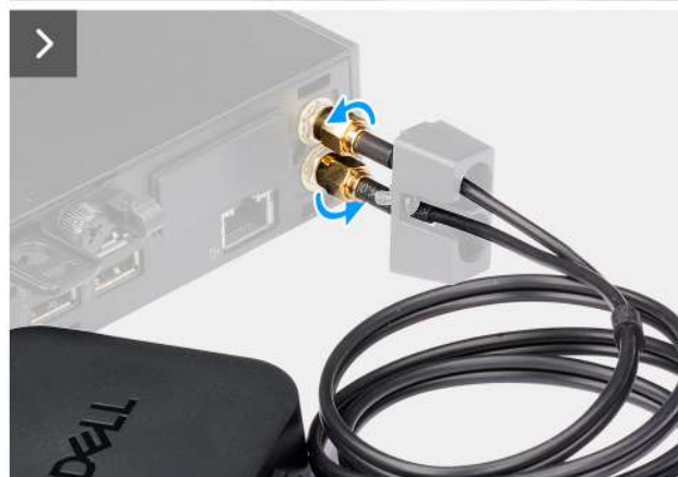
Obrázek 34. Demontáž externí antény
