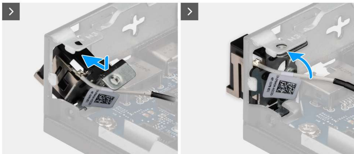
Obrázek 74. Montáž anténního modulu (bílý kabel)
