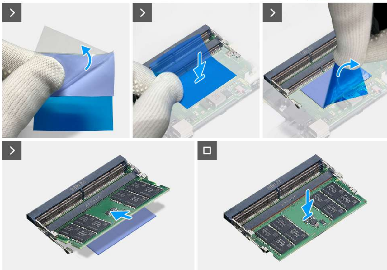
Obrázek 33. Vložení paměťového modulu
