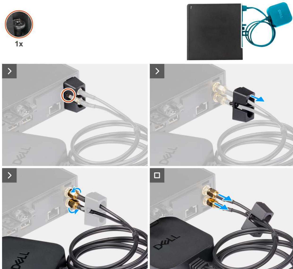
Obrázek 34. Demontáž externí antény
