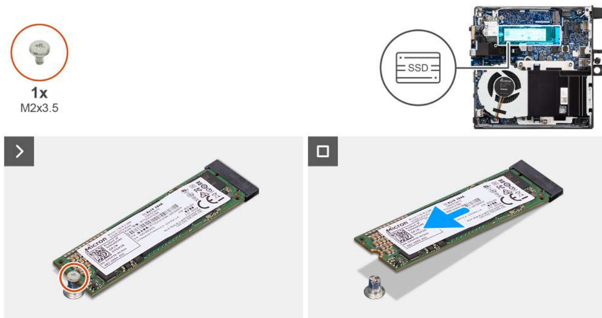
Obrázek 19. Demontáž disku SSD M.2 2280
