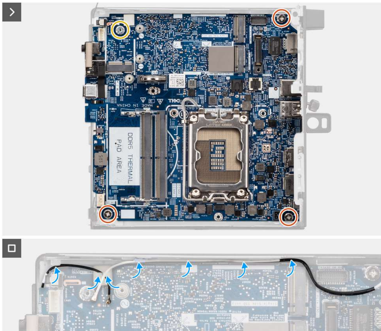
Obrázek 79. Montáž základní desky
