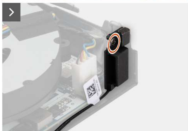
Obrázek 66. Demontáž anténního modulu (černý kabel)
