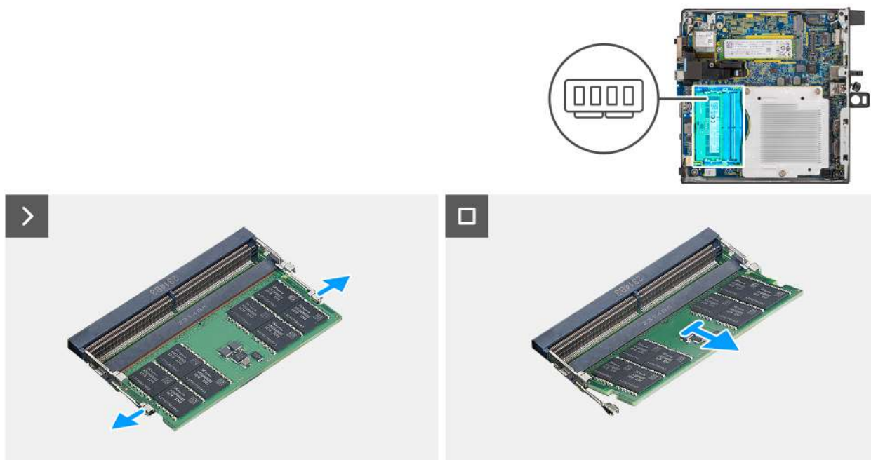
Obrázek 32. Vyjmutí paměťového modulu
