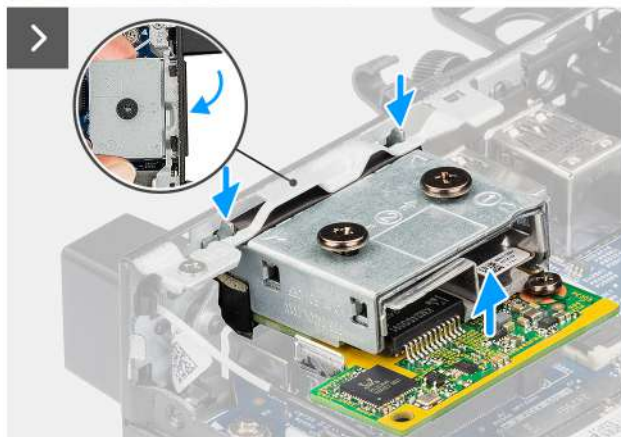
Obrázek 57. Demontáž modulu optického portu
