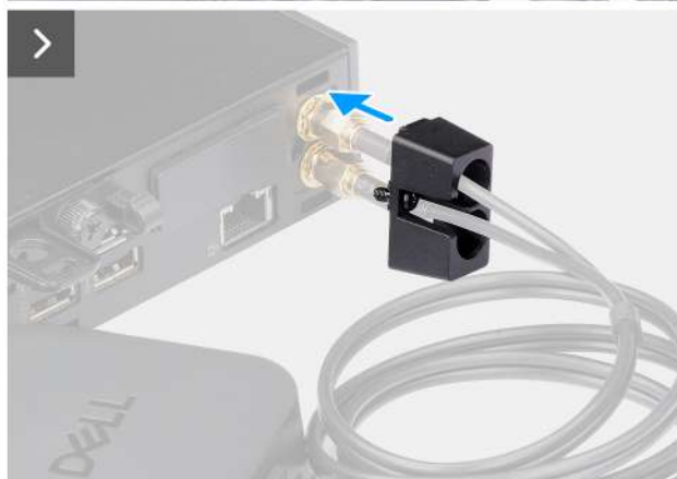
Obrázek 35. Montáž externí antény
