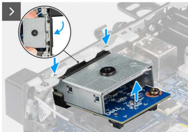
Obrázek 48. Demontáž modulu VGA
