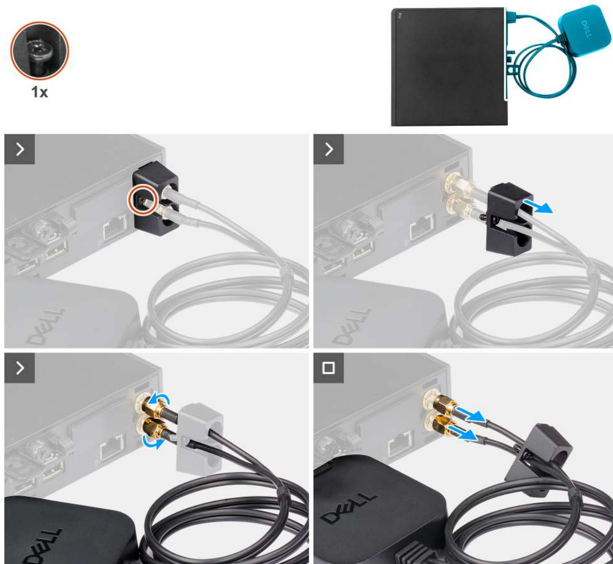
Obrázek 34. Demontáž externí antény
