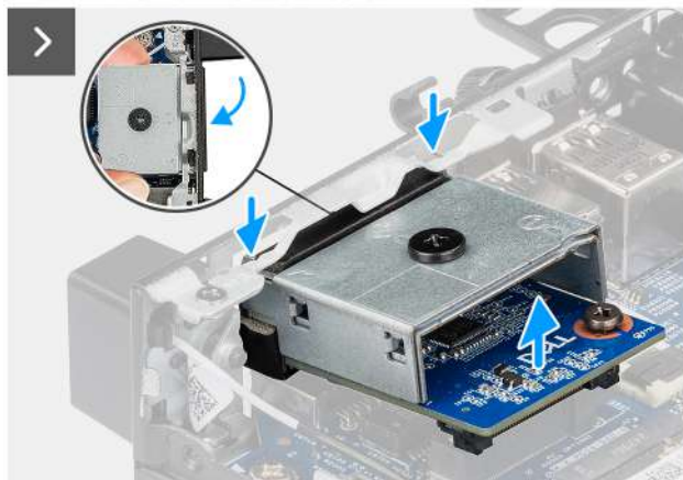
Obrázek 45. Demontáž modulu HDMI
