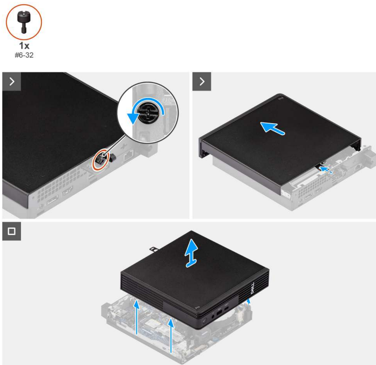
Obrázek 10. Demontáž bočního krytu
