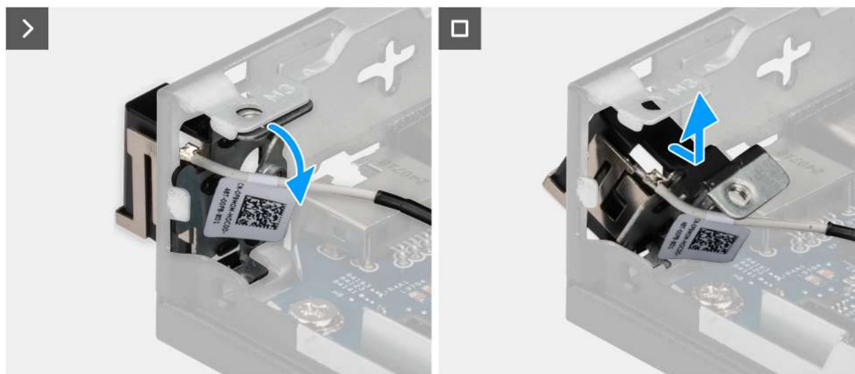
Obrázek 63. Demontáž anténního modulu (bílý kabel)
