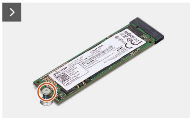
Obrázek 19. Demontáž disku SSD M.2 2280
