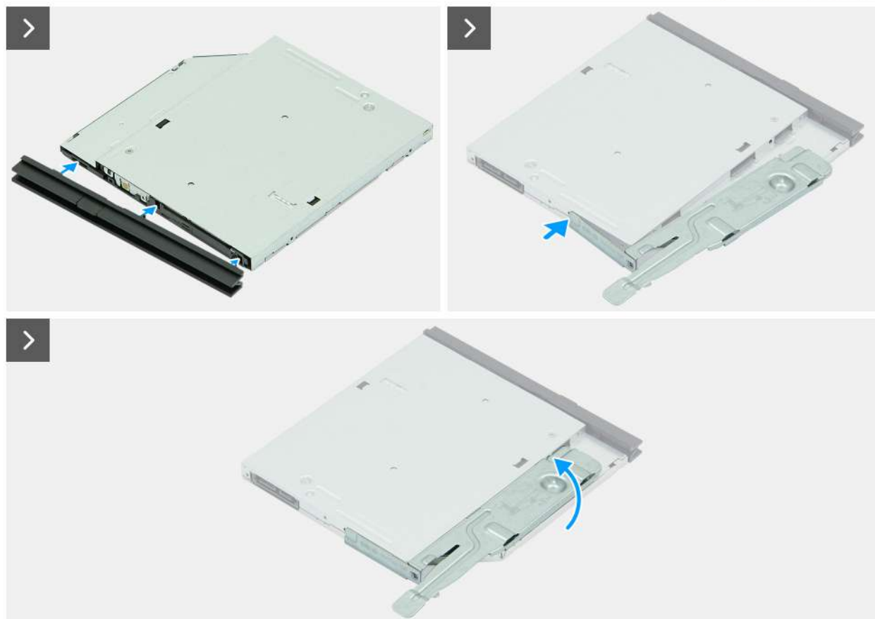
Obrázek 36. Montáž optické jednotky
