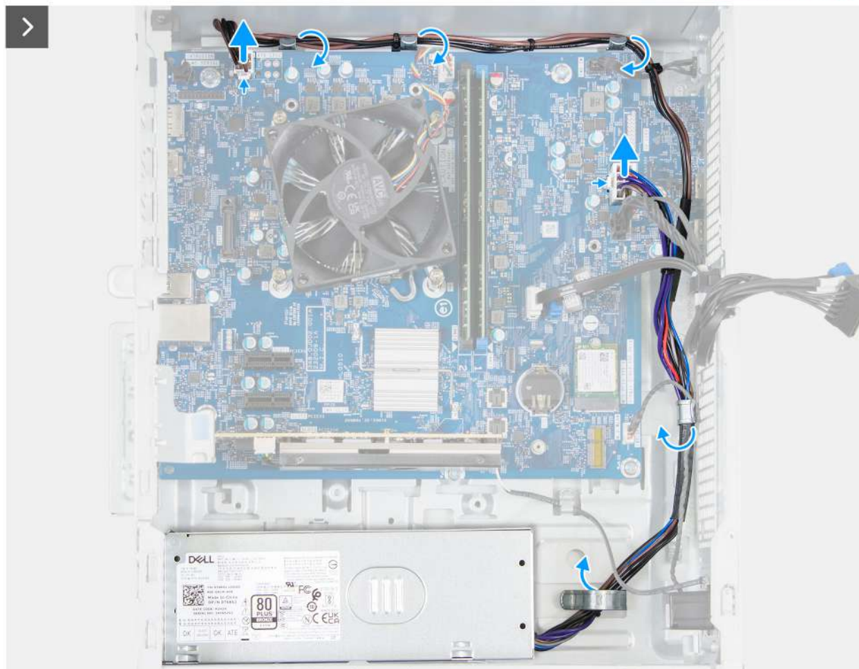
Obrázek 58. Demontáž napájecího zdroje
