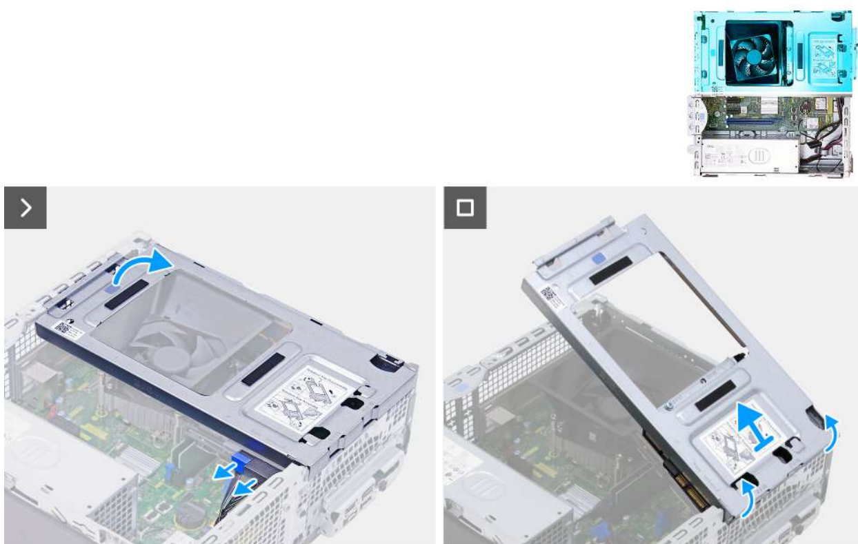
Obrázek 18. Demontáž diskové pozice
