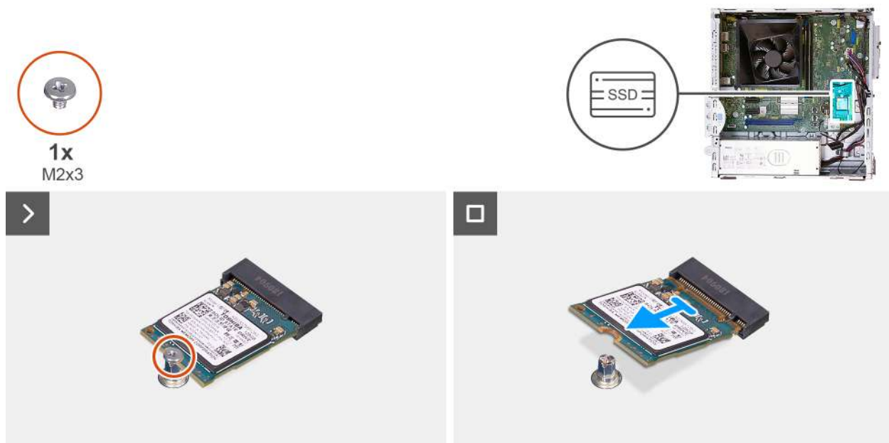
Obrázek 25. Demontáž disku SSD M.2 2230
