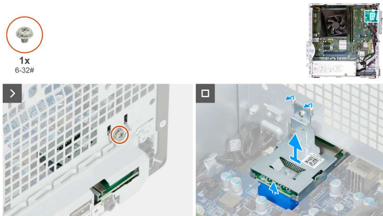
Obrázek 29. Demontáž čtečky paměťových karet
