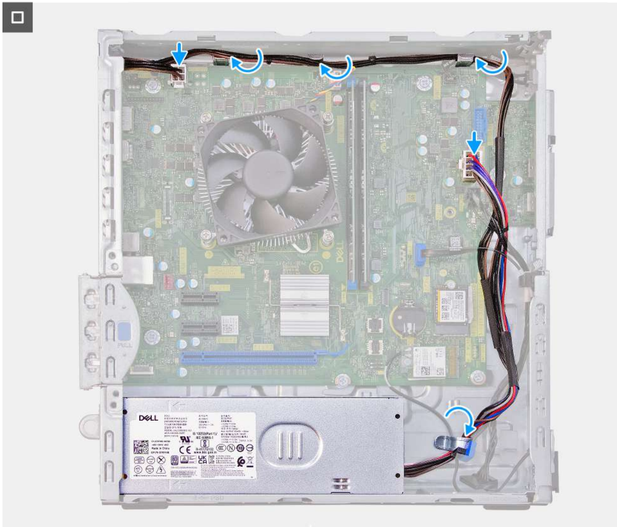
Obrázek 36. Montáž napájecího zdroje
