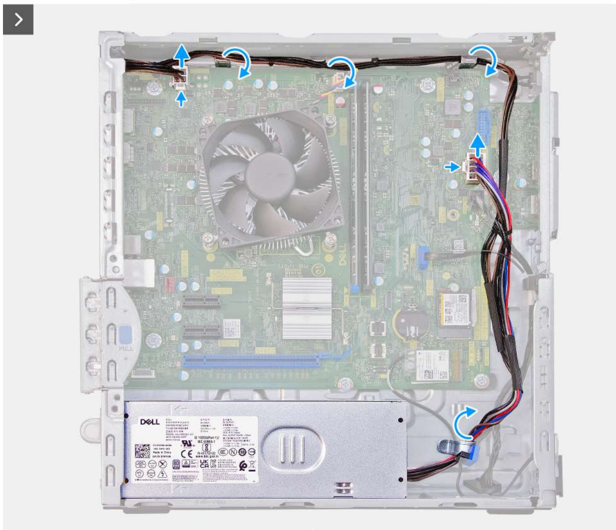
Obrázek 33. Demontáž napájecího zdroje
