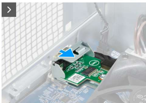
Obrázek 45. Demontáž modulu sériového portu
