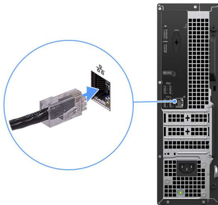
Obrázek 5. Připojení ethernetového kabelu
