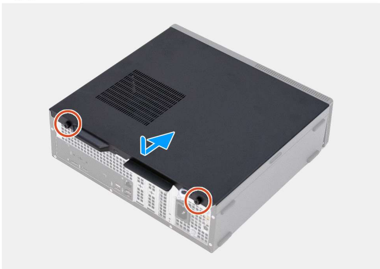
Obrázek 11. Montáž levého bočního krytu
