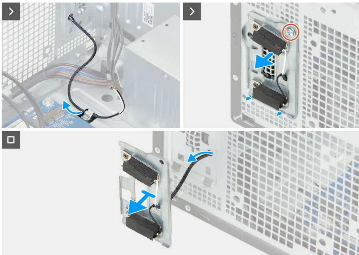
Obrázek 31. Demontáž modulu antény
