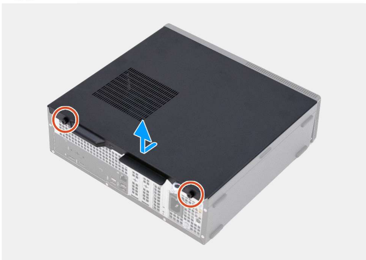
Obrázek 10. Demontáž levého bočního krytu
