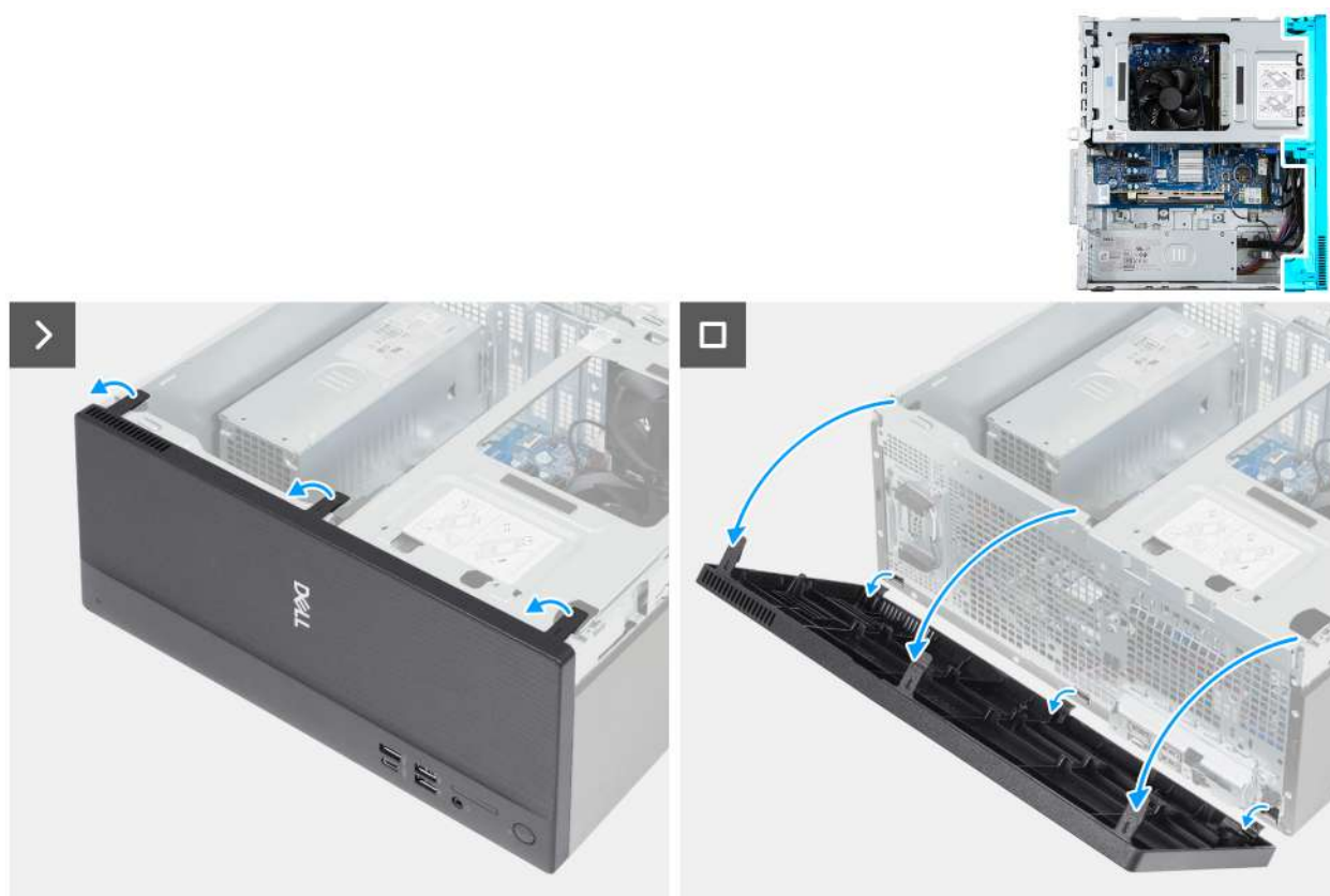
Obrázek 18. Demontáž čelního krytu
