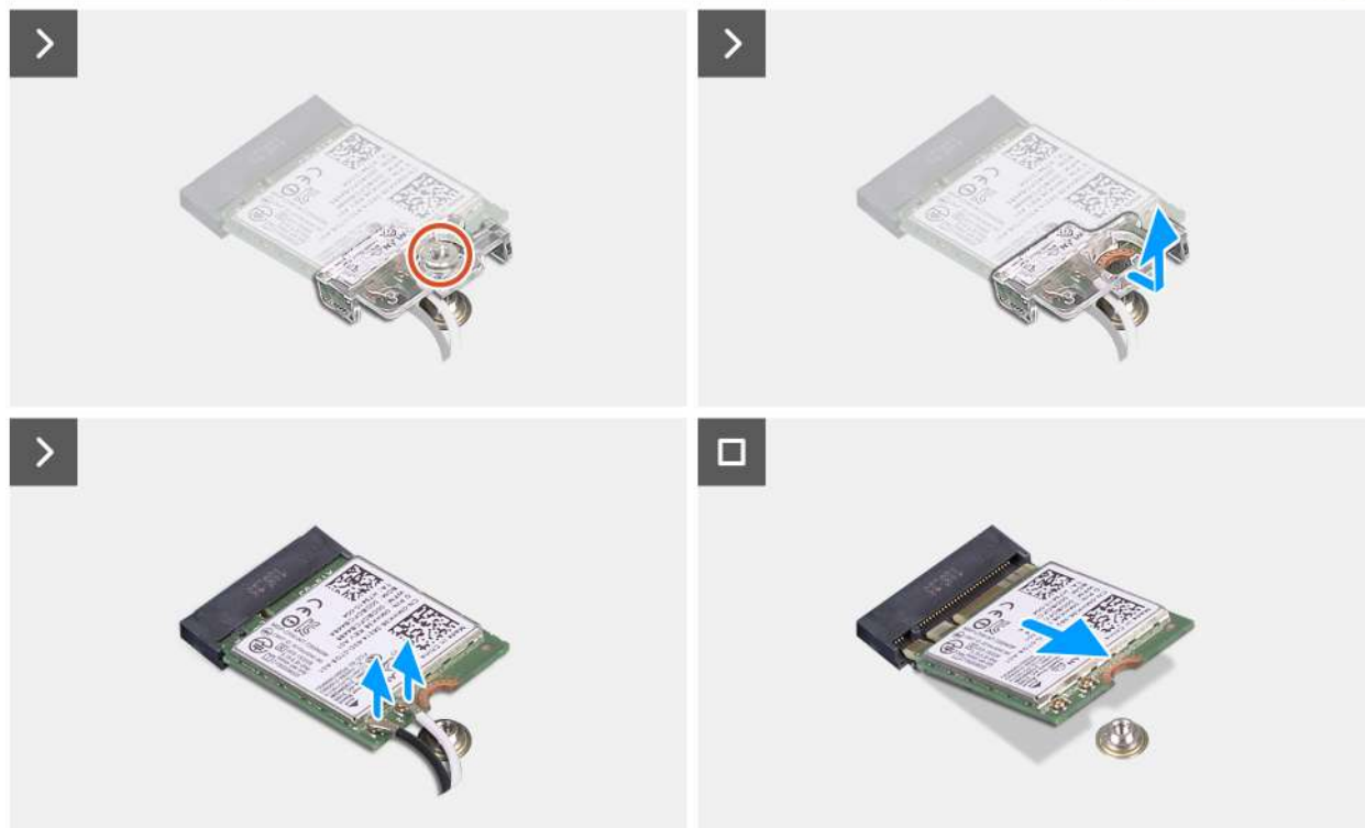
Obrázek 26. Demontáž bezdrátové karty
