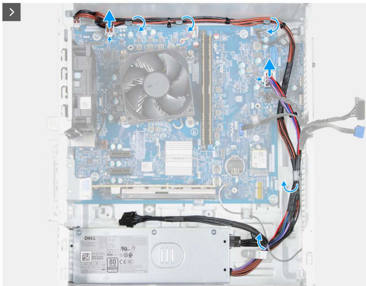
Obrázek 46. Demontáž napájecí jednotky
