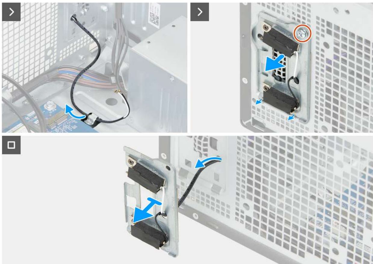
Obrázek 44. Demontáž anténních modulů
