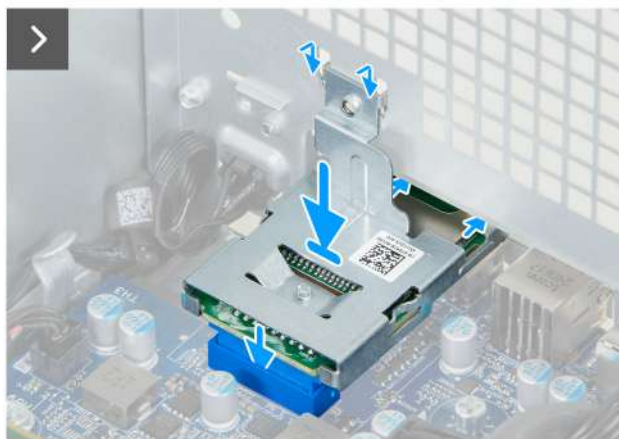
Obrázek 38. Montáž čtečky paměťových karet
