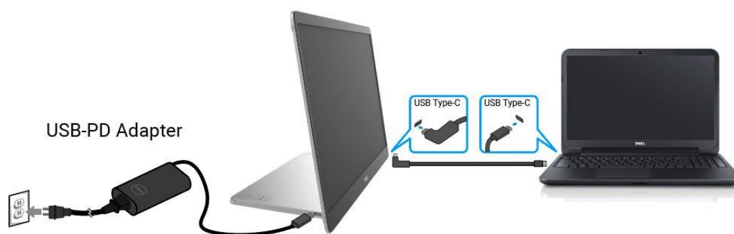
Obrázek 32. Odpojte kabel USB-C síťového adaptéru
