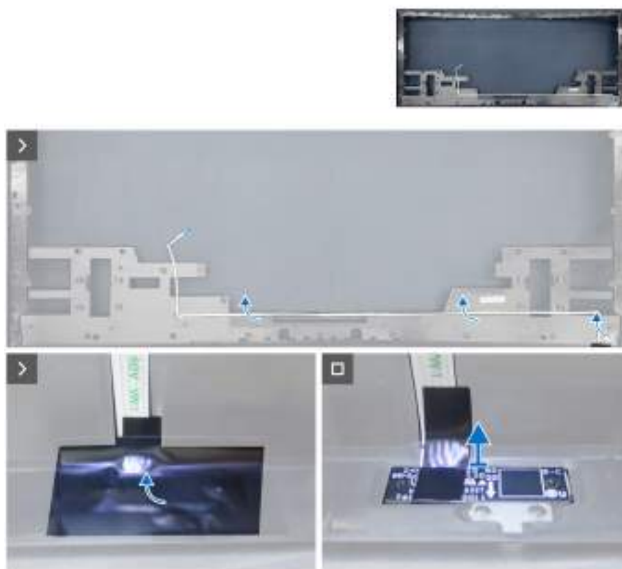
Obrázek 35. Demontáž LED kabelu
