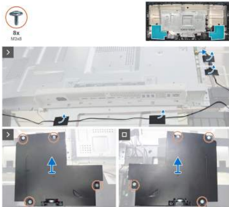
Obrázek 27. Demontáž reproduktorů
