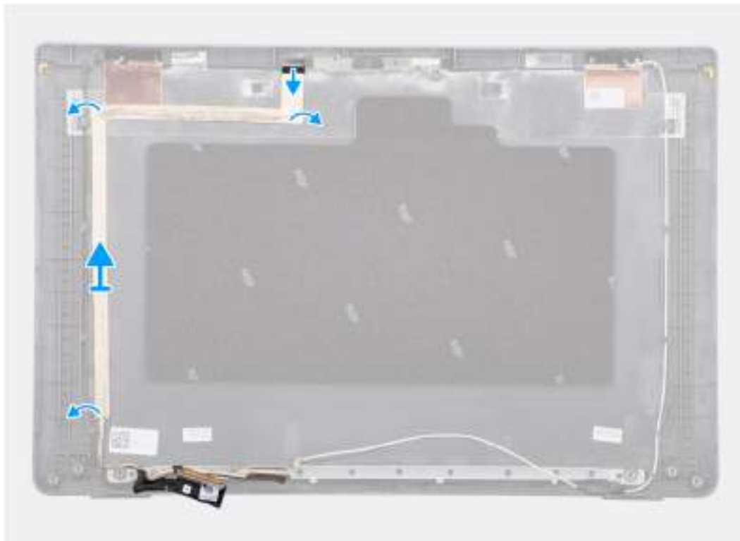
Obrázek 68. Vyjmutí kabelu eDP
