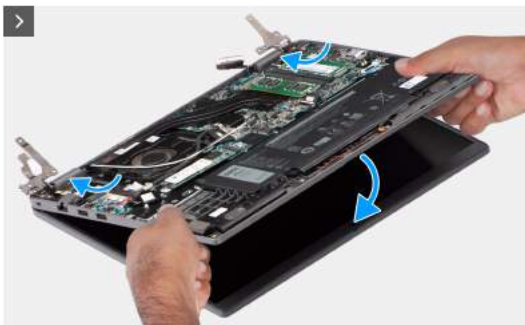
Obrázek 50. Demontáž sestavy displeje
