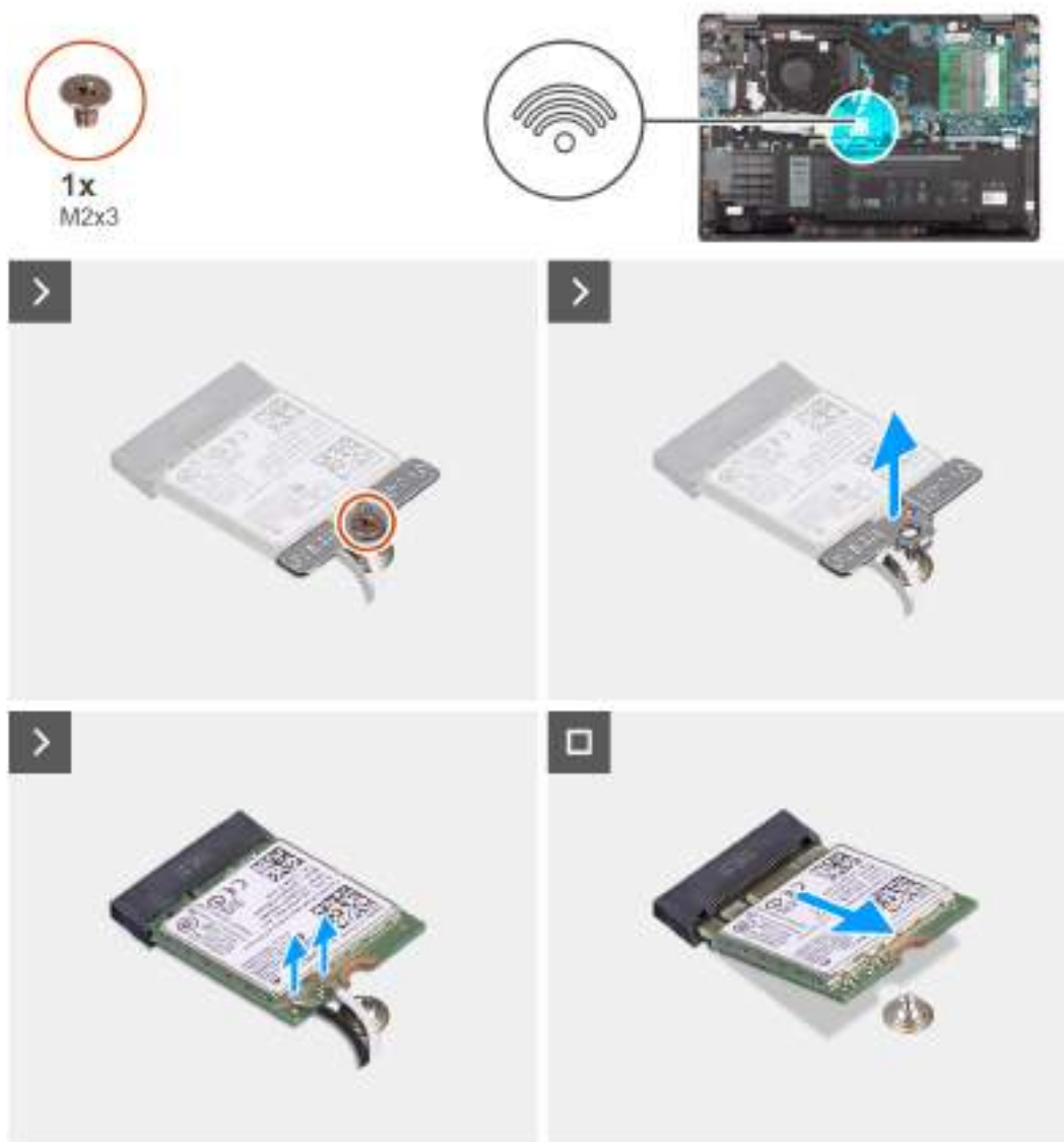
Obrázek 14. Demontáž bezdrátové karty
