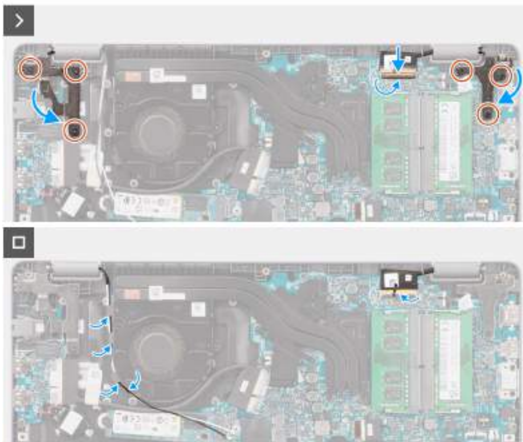
Obrázek 52. Montáž sestavy displeje
