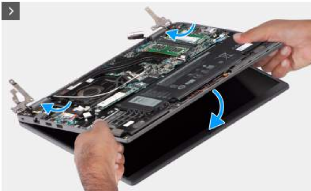
Obrázek 51. Montáž sestavy displeje
