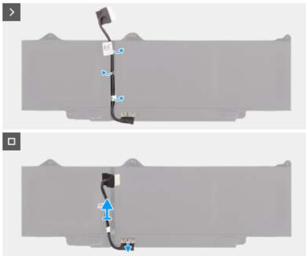
Obrázek 25. Demontáž kabelu baterie
