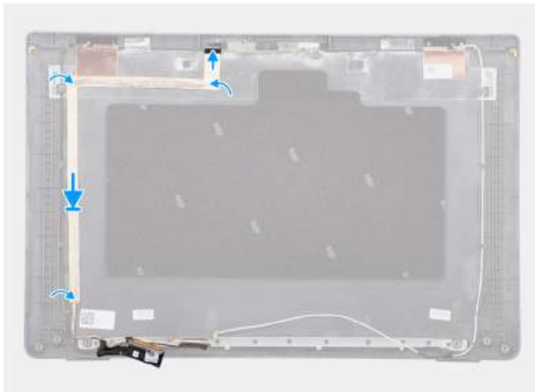
Obrázek 69. Montáž kabelu eDP
