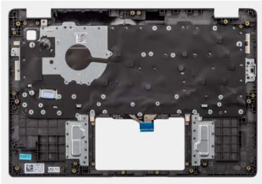
Obrázek 47. Montáž sestavy opěrky pro dlaň a klávesnice
