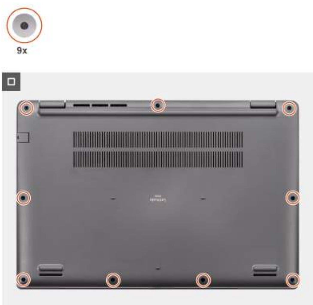
Obrázek 11. Nasazení spodního krytu
