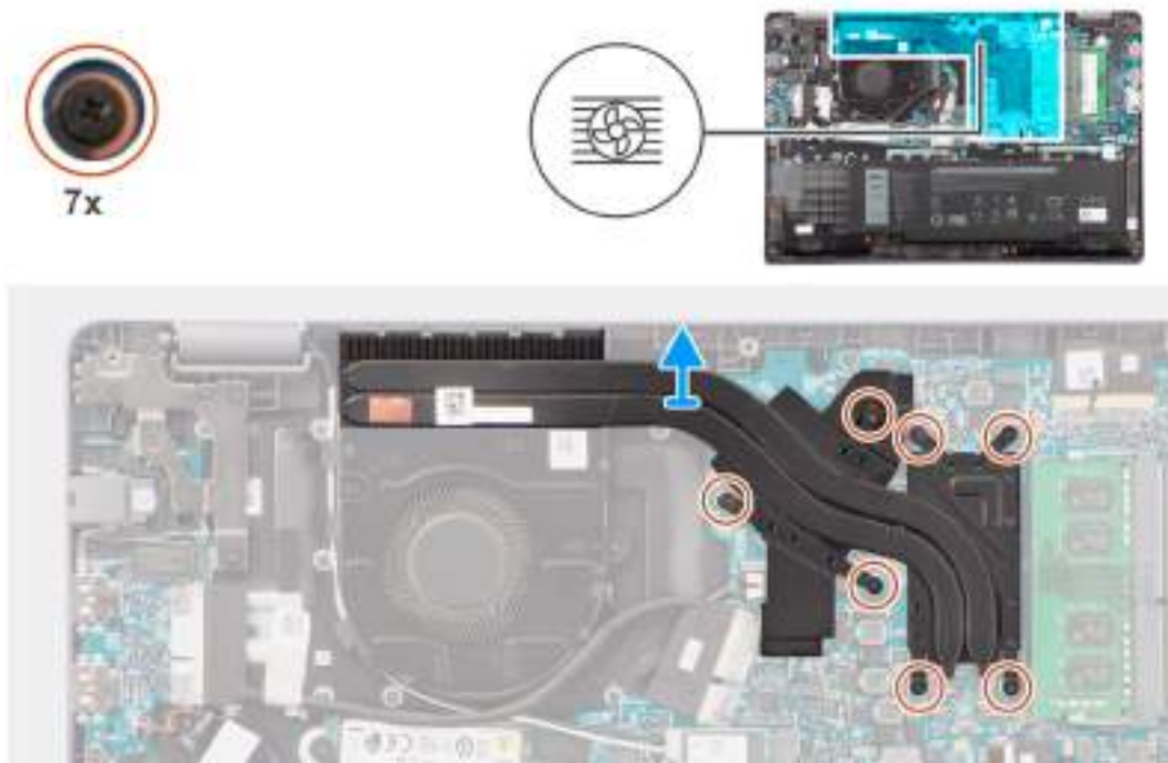
Obrázek 31. Demontáž chladiče pro samostatnou grafickou kartu
