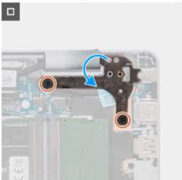
Obrázek 52. Montáž portu napájecího adaptéru (pro počítače dodávané s plastovým šasi)
