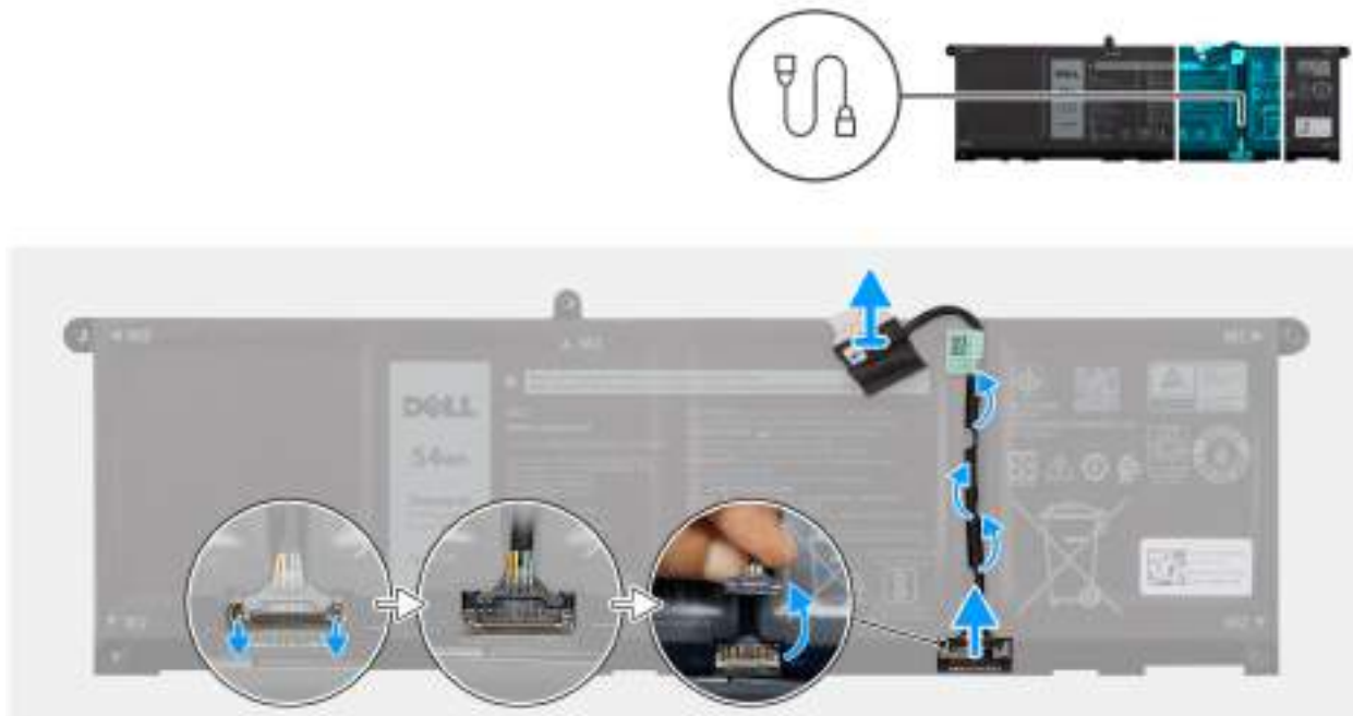
Obrázek 36. Odpojení kabelu baterie
