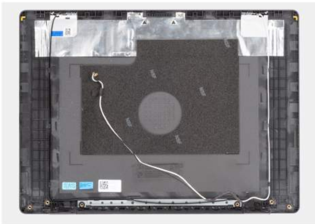
Obrázek 87. Zadní kryt displeje a sestava antény
