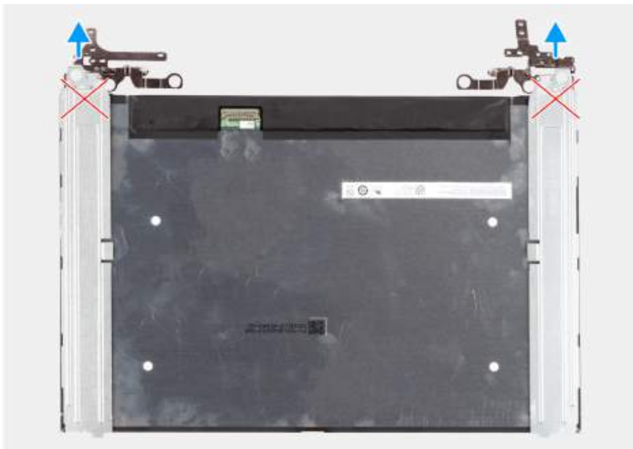
Obrázek 78. Demontáž obrazovky displeje
