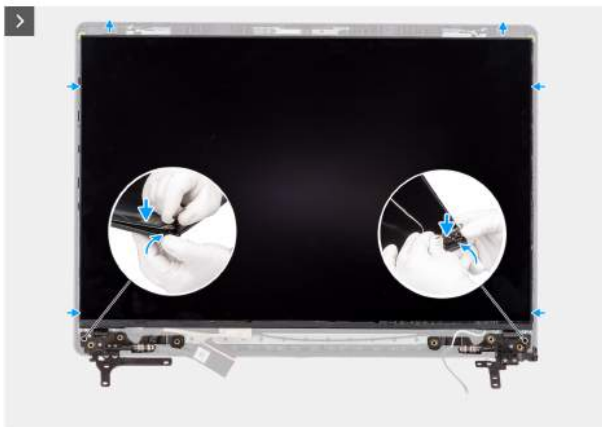
Obrázek 81. Montáž obrazovky displeje
