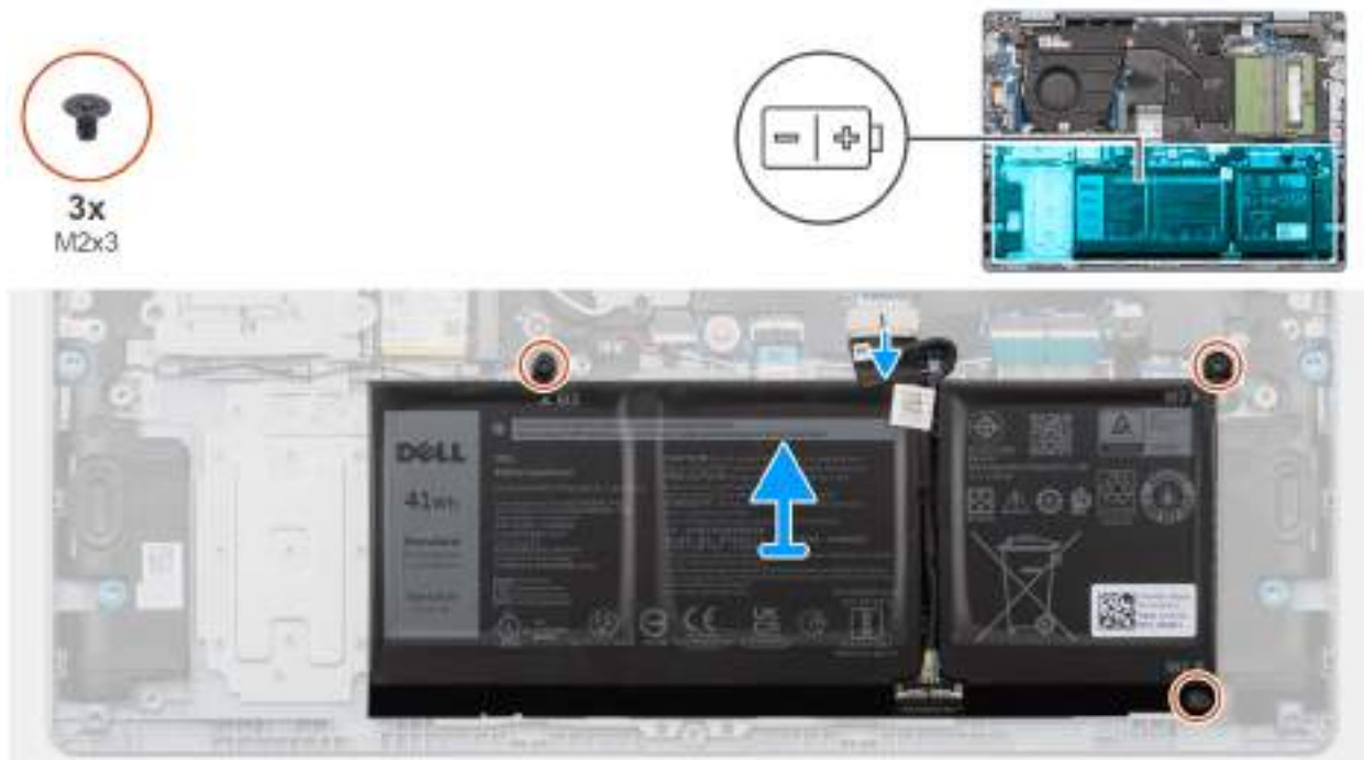
Obrázek 32. Demontáž 3člankové baterie
