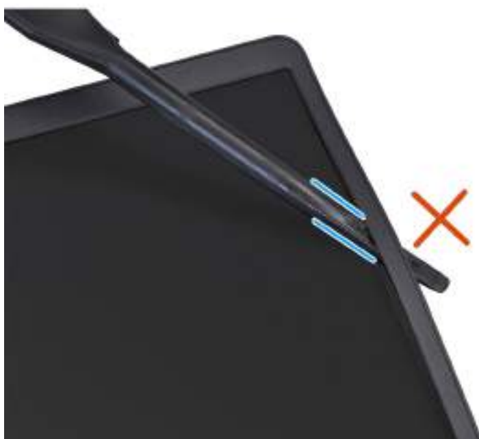
Obrázek 71. Demontáž čelního krytu displeje
