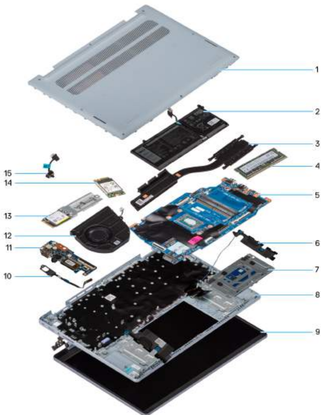
Obrázek 9. Hlavní komponenty počítače Inspiron 14 5445
