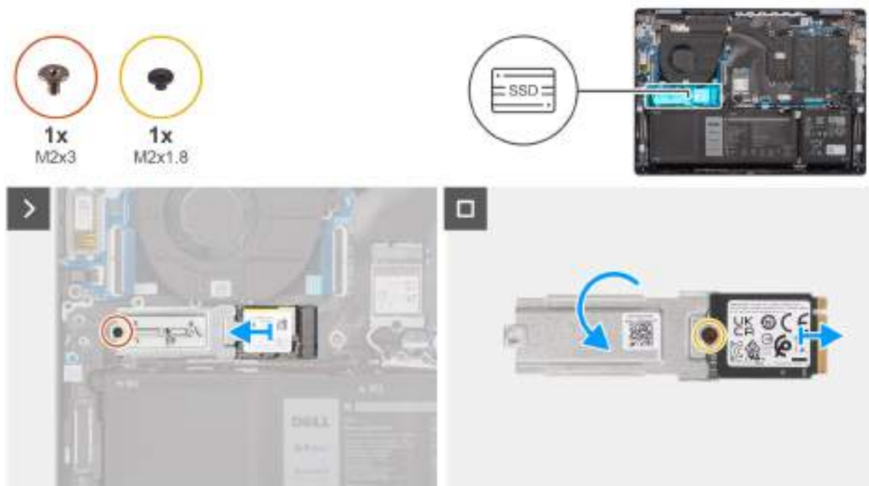
Obrázek 26. Demontáž disku SSD
