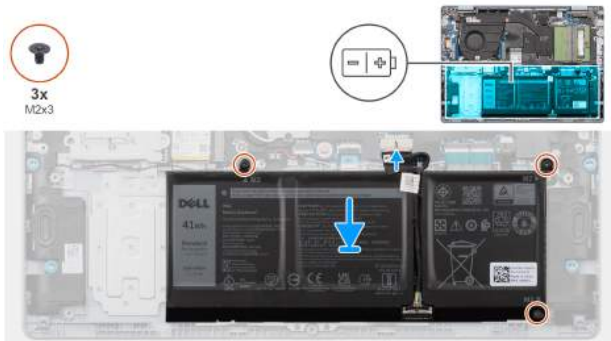
Obrázek 33. Montáž 3článkové baterie
