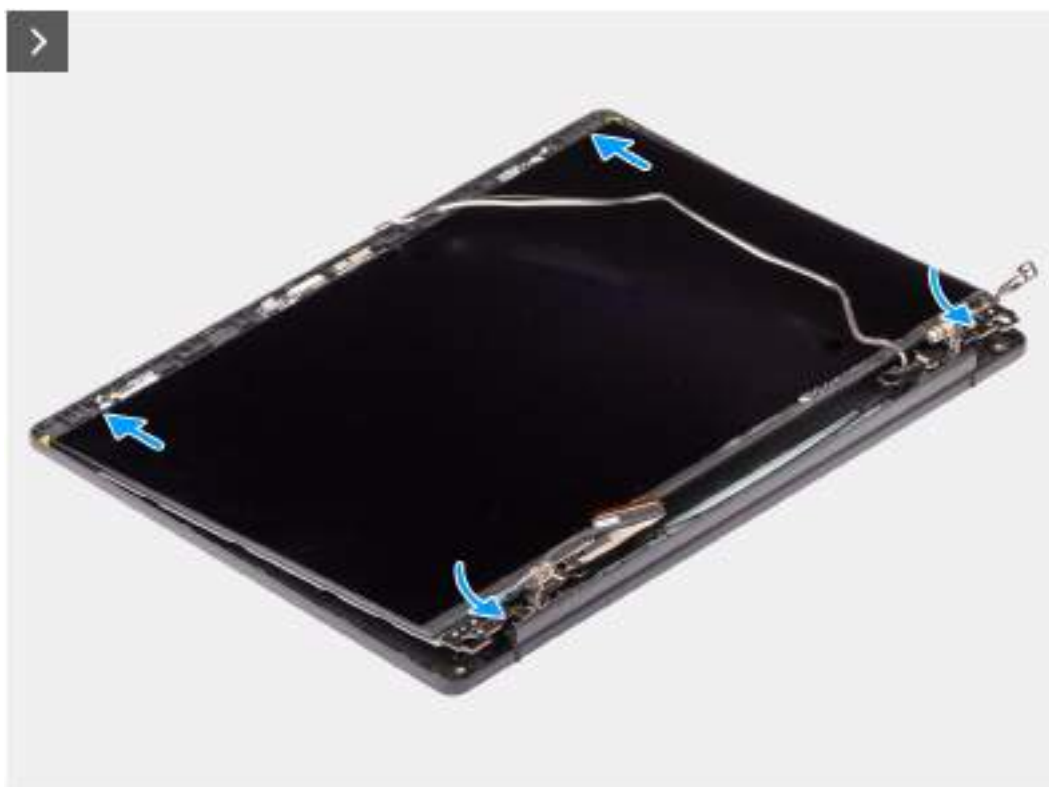
Obrázek 80. Montáž obrazovky displeje
