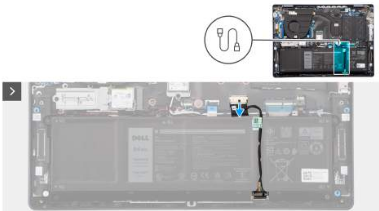
Obrázek 19. Odpojení kabelu baterie
