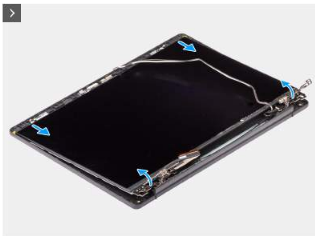
Obrázek 76. Demontáž obrazovky displeje
