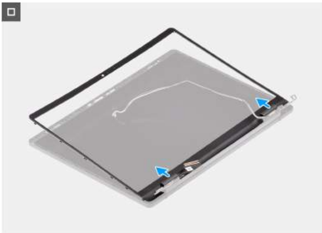
Obrázek 70. Demontáž čelního krytu displeje
