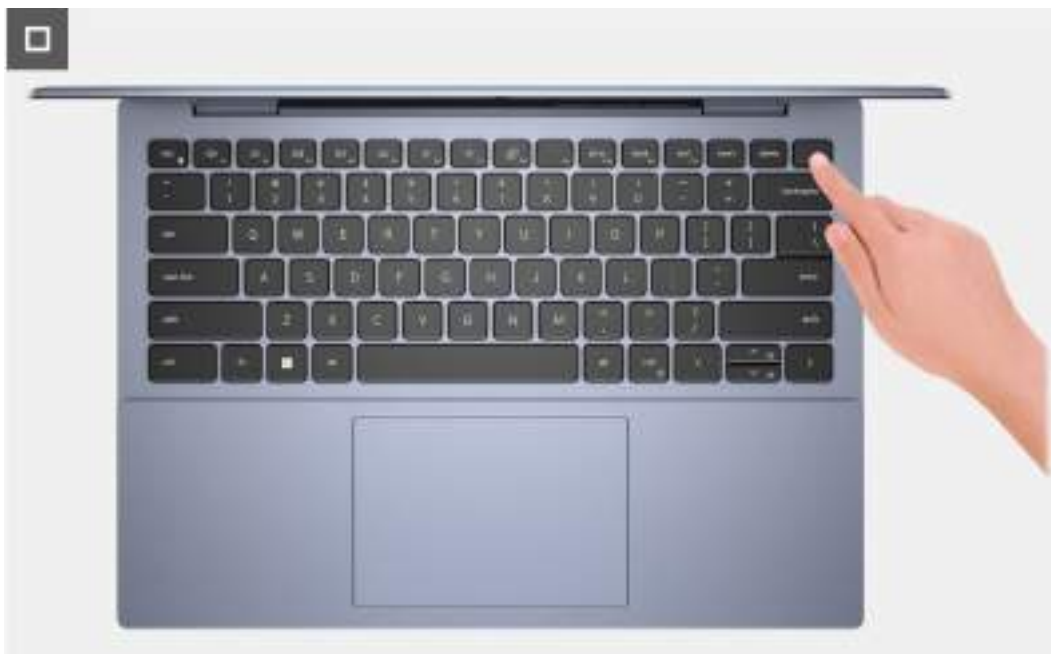
Obrázek 20. Stisknutí vypínače a odstranění statické elektřiny
