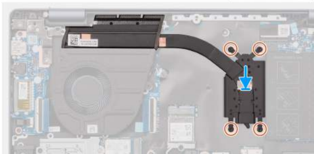
Obrázek 40. Montáž chladiče (pro počítače dodávané s procesorem AMD Ryzen 5 8540U nebo AMD Ryzen 7 8840U)
