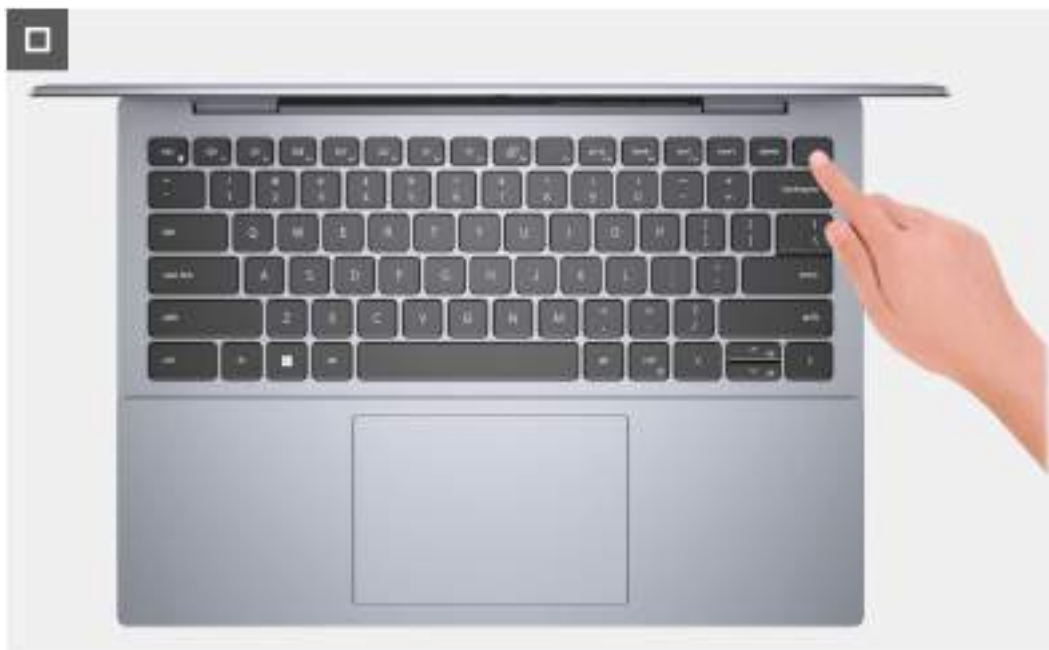
Obrázek 13. Stisknutí vypínače a odstranění statické elektřiny
