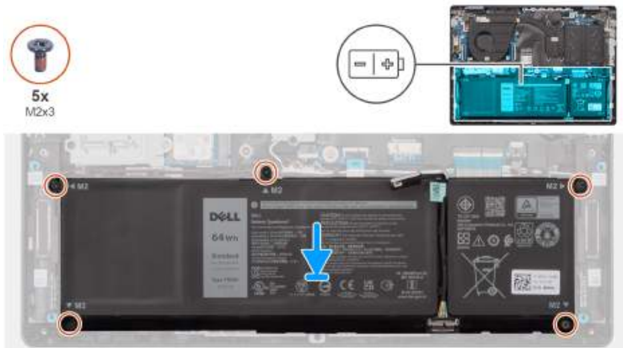
Obrázek 35. Montáž 4čláňkové baterie
