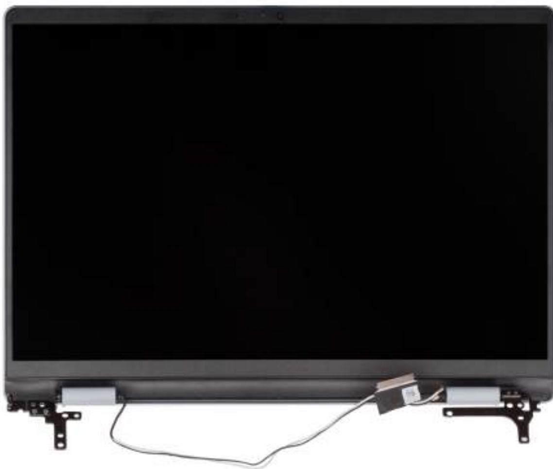
Obrázek 64. Sestava displeje (pro počítače dodávané s plastovým šasi)
