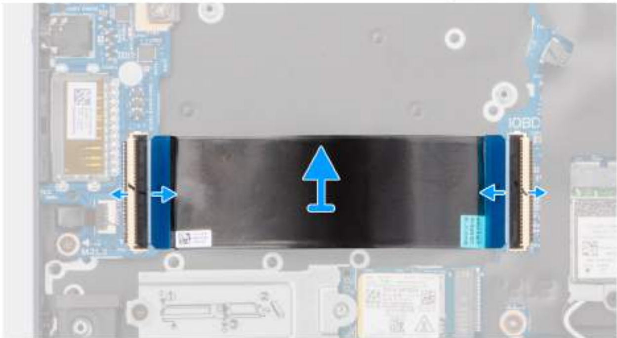
Obrázek 54. Demontáž kabelu desky I/O
