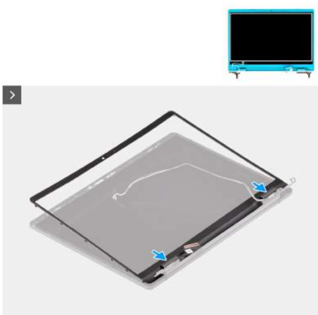
Obrázek 72. Montáž čelního krytu displeje
