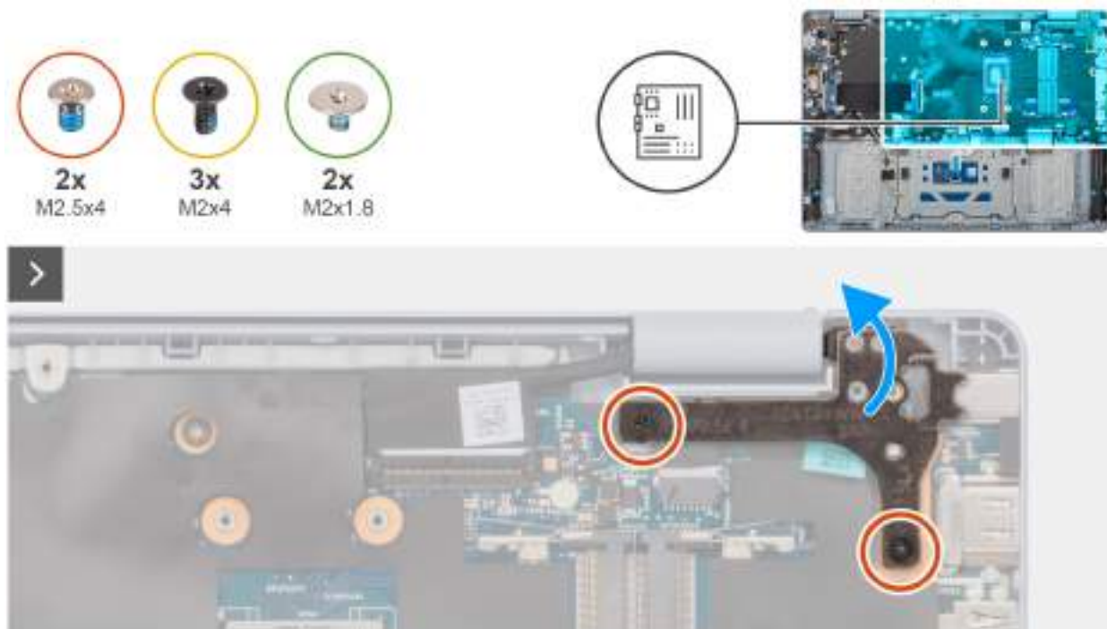
Obrázek 90. Demontáž základní desky
