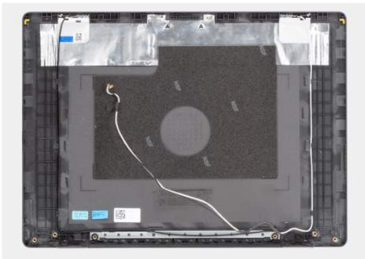
Obrázek 88. Zadní kryt displeje a sestava antény
