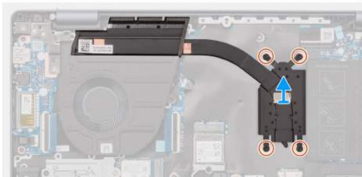
Obrázek 38. Demontáž chladiče (pro počítače dodávané s procesorem AMD Ryzen 5 8540U nebo AMD Ryzen 7 8840U)
