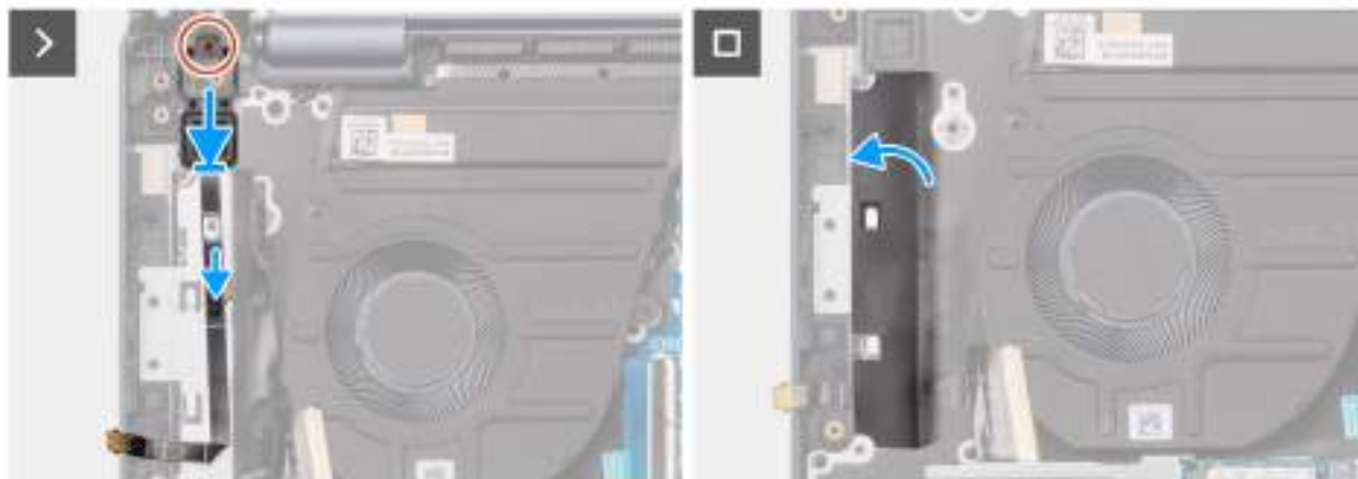
Obrázek 61. Montáž tlačítka napájení s volitelnou čtečkou otisků prstů
