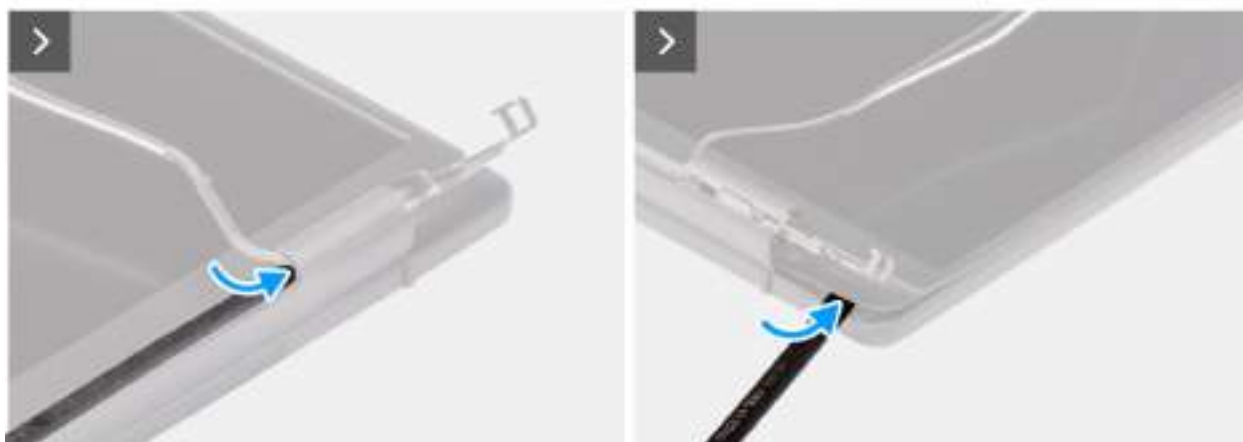
Obrázek 68. Demontáž čelního krytu displeje
