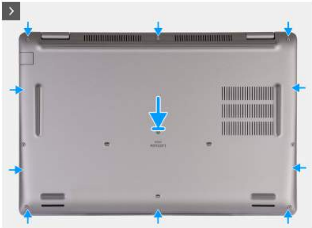
Obrázek 17. Nasazení spodního krytu
