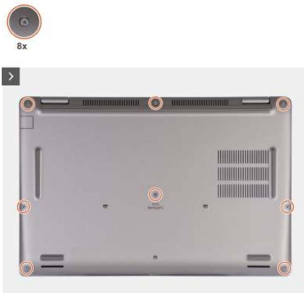
Obrázek 13. Povolení jisticích šroubků
