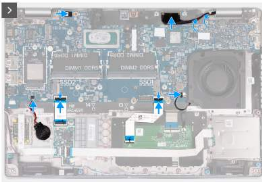
Obrázek 59. Montáž základní desky
