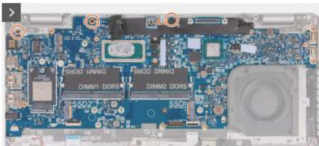
Obrázek 55. Demontáž základní desky
