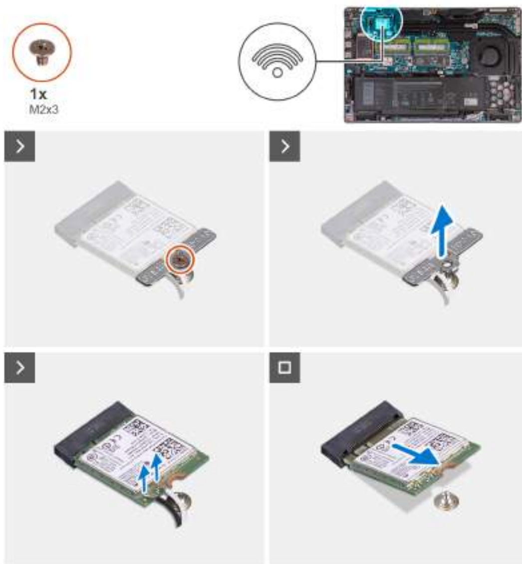
Obrázek 19. Demontáž bezdrátové karty
