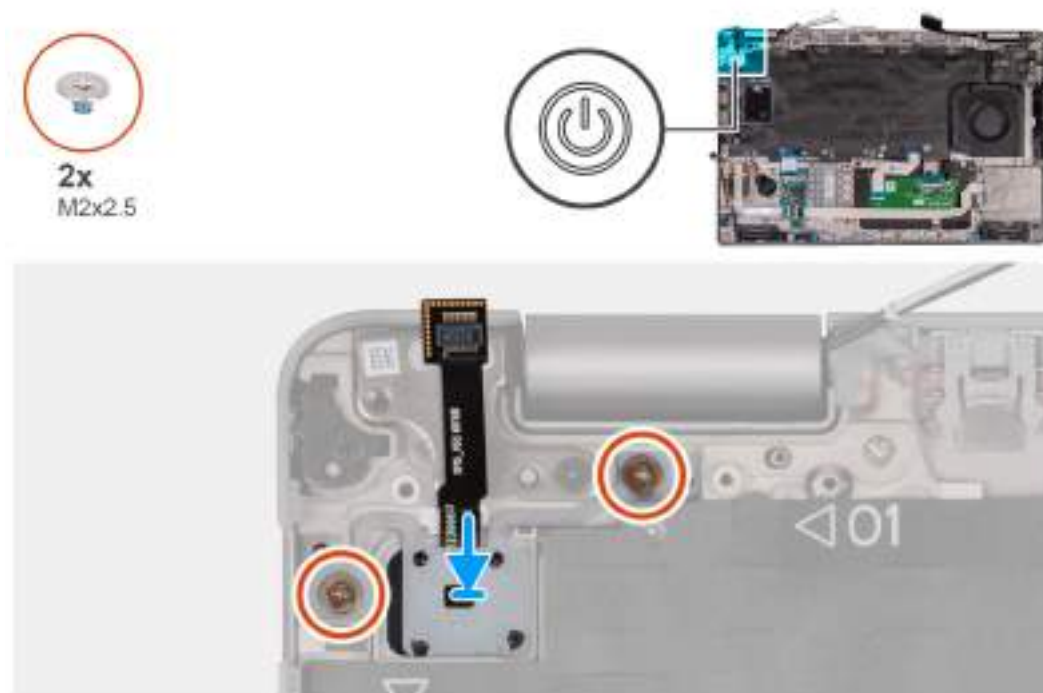
Obrázek 64. Montáž vypínače s volitelnou čtečkou otisků prstů
