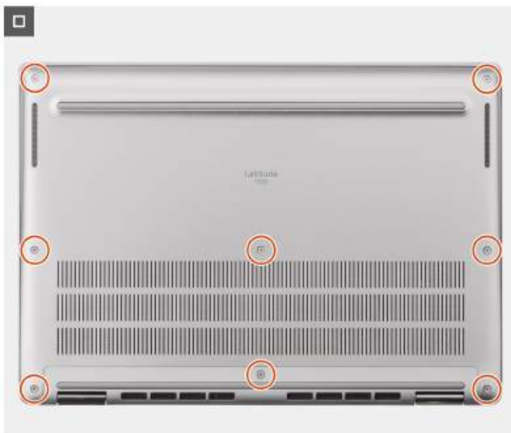
Obrázek 20. Nasazení spodního krytu
