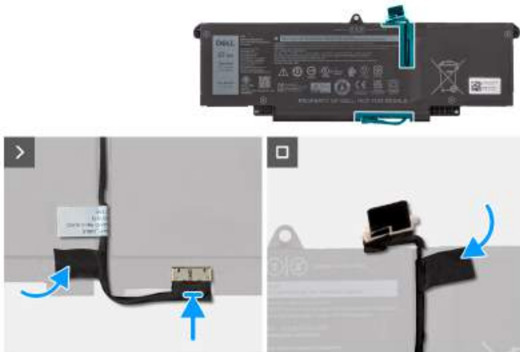
Obrázek 34. Montáž kabelu baterie
