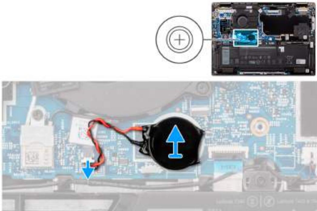
Obrázek 27. Vyjmutí knoflíkové baterie
