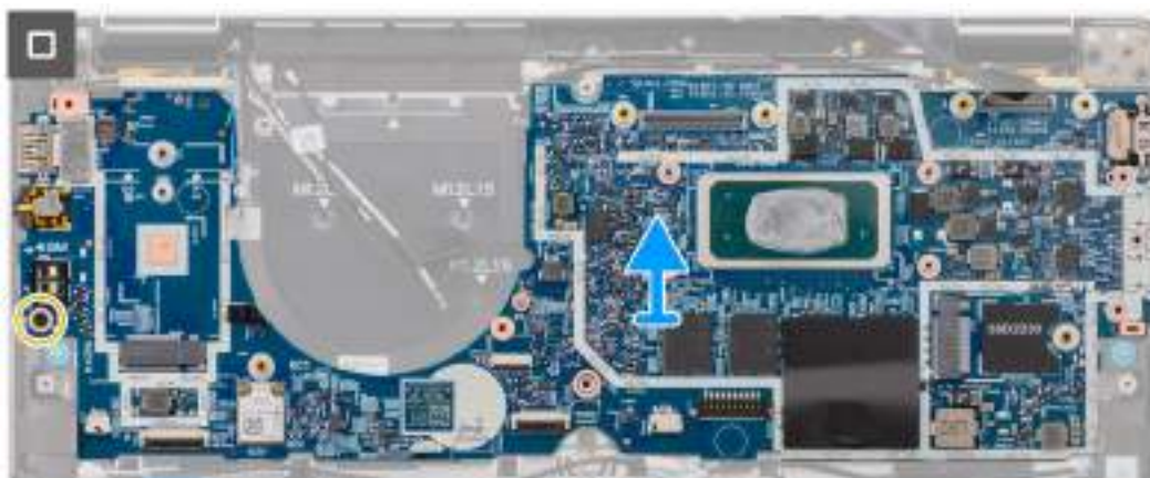
Obrázek 50. Demontáž základní desky
