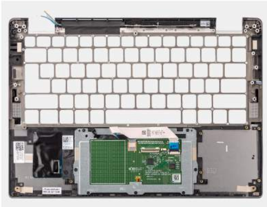
Obrázek 69. Montáž sestavy opěrky pro dlaň
