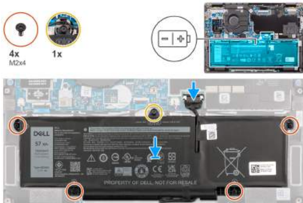
Obrázek 32. Montáž 4čláňkové baterie
