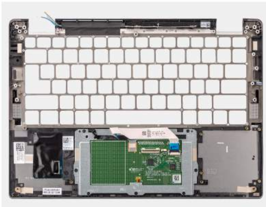
Obrázek 68. Demontáž sestavy opěrky pro dlaň
