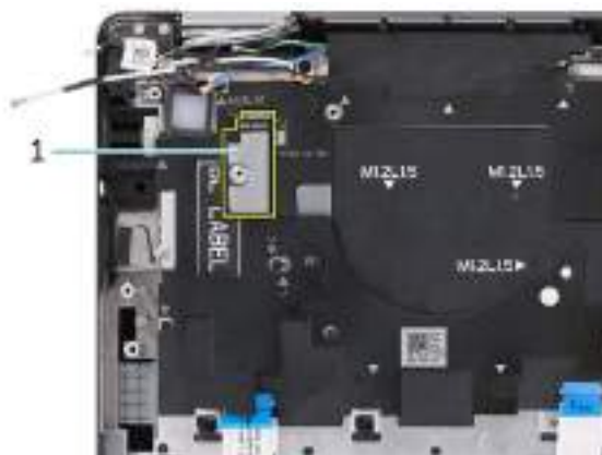
Obrázek 65. Podpůrná deska klávesnice pro 5G WWAN
