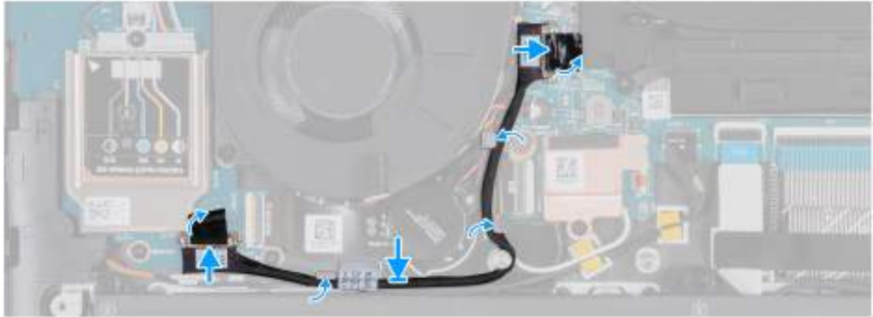
Obrázek 55. Montáž kabelu desky I/O (pro počítače dodávané s podporou sítě WWAN)
