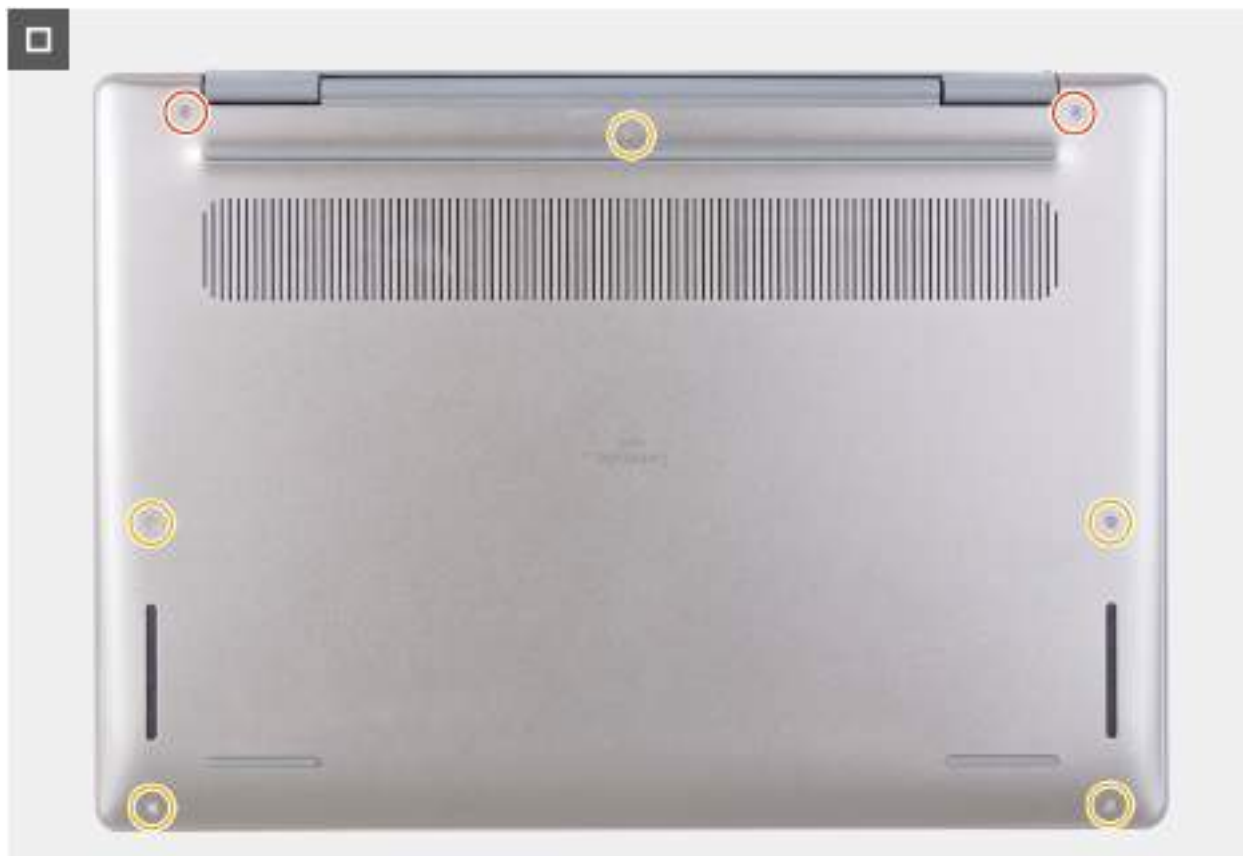
Obrázek 20. Zašroubování a utažení šroubů
