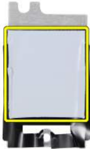
Obrázek 24. Teplovodivá podložka pod tepelným krytem SSD
