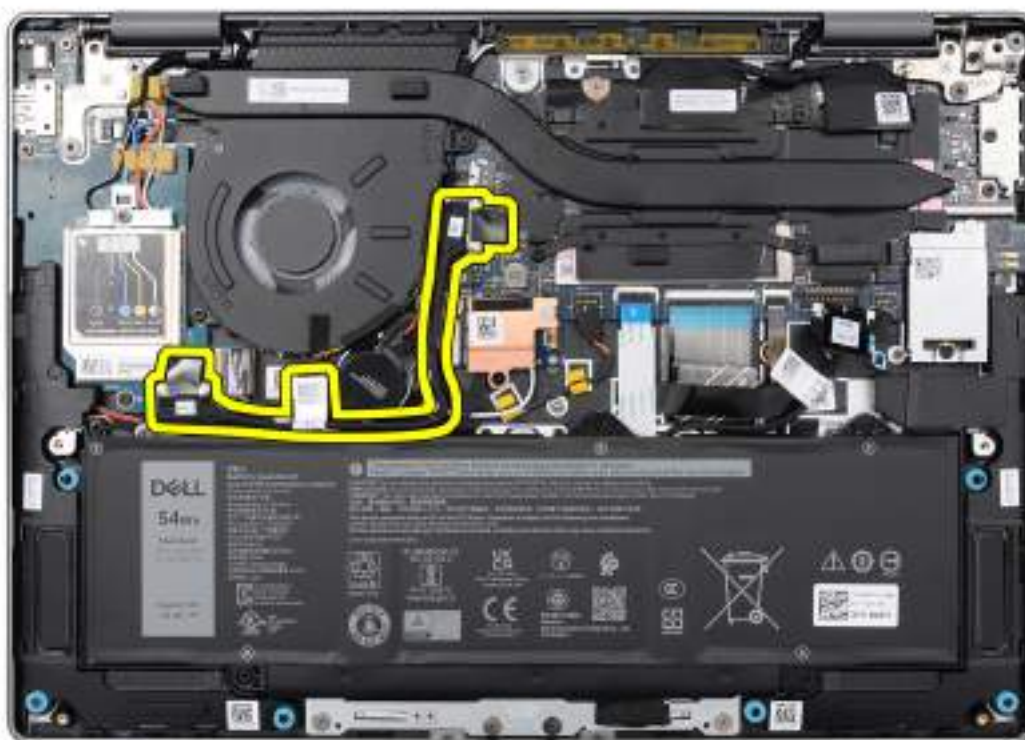
Obrázek 54. Umístění kabelu desky I/O
