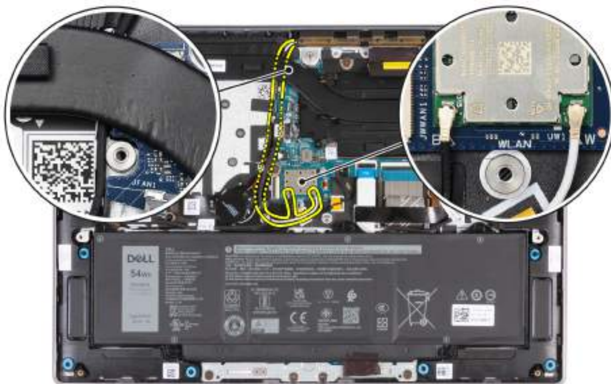
Obrázek 71. Montáž kabelů antény WLAN
