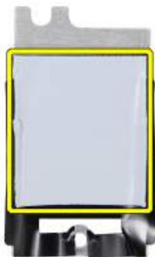
Obrázek 22. Teplovodivá podložka pod tepelným krytem SSD
