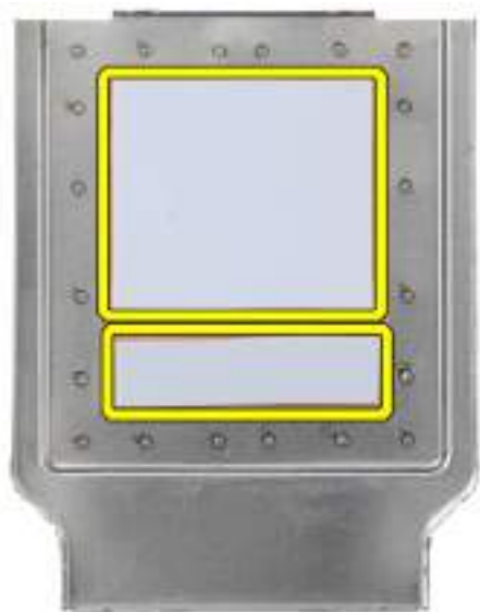
Obrázek 30. Teplovodivé podložky ve spodní části tepelného krytu WWAN
