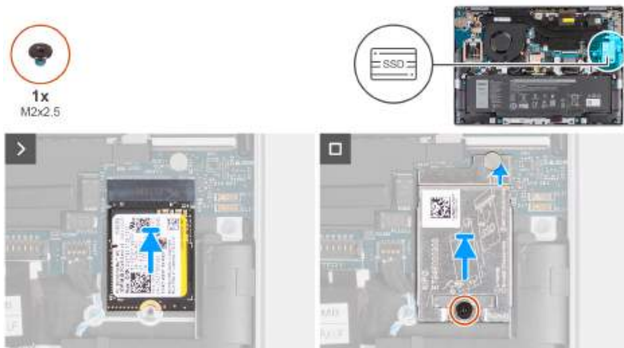
Obrázek 23. Montáž disku SSD
