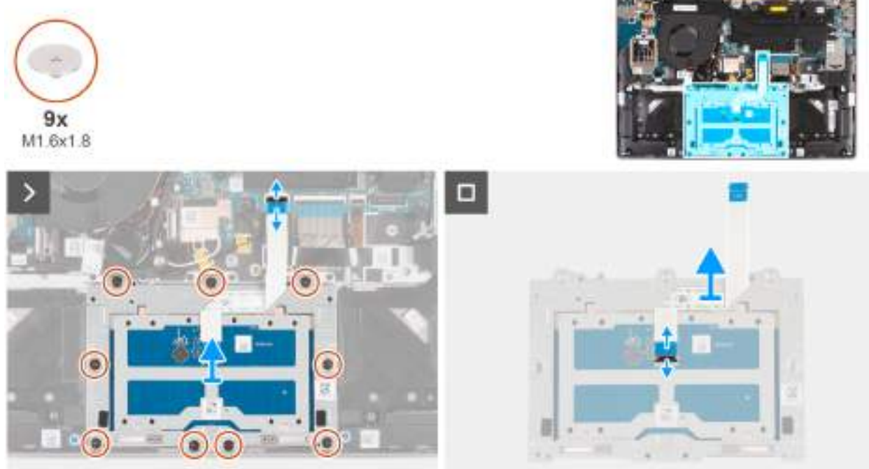
Obrázek 86. Demontáž sestavy dotykové podložky
