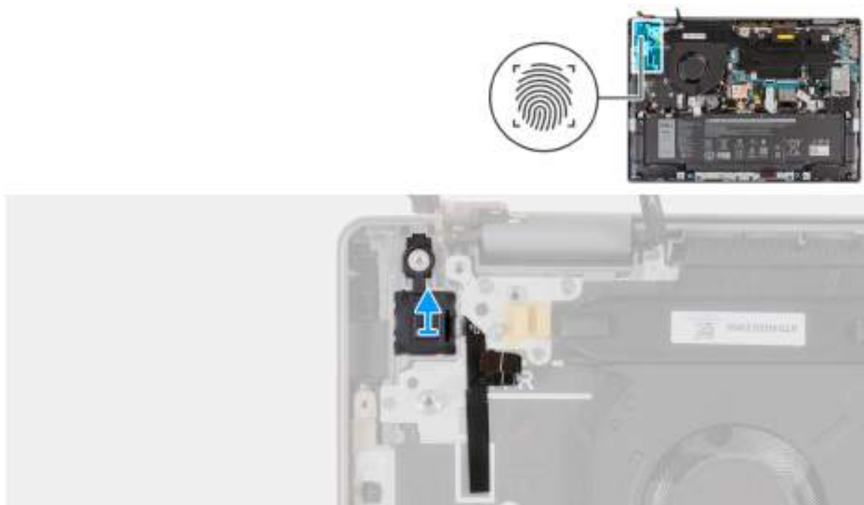
Obrázek 89. Demontáž vypínače se čtečkou otisků prstů
