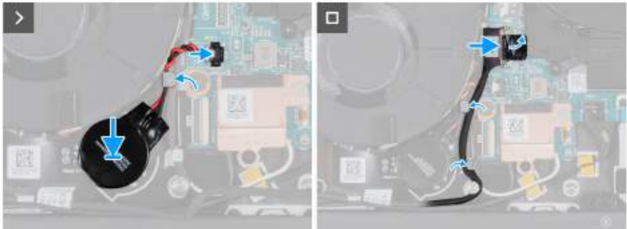
Obrázek 47. Montáž knoflíkové baterie
