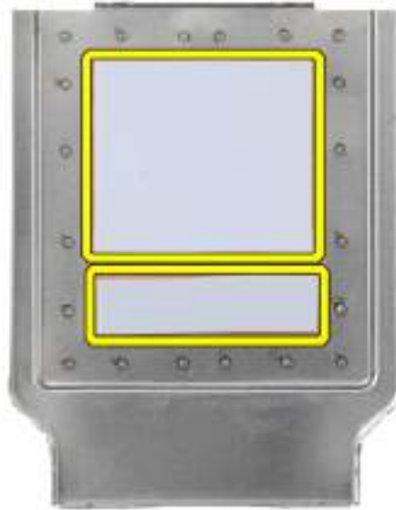
Obrázek 27. Teplovodivé podložky ve spodní části tepelného krytu WWAN
