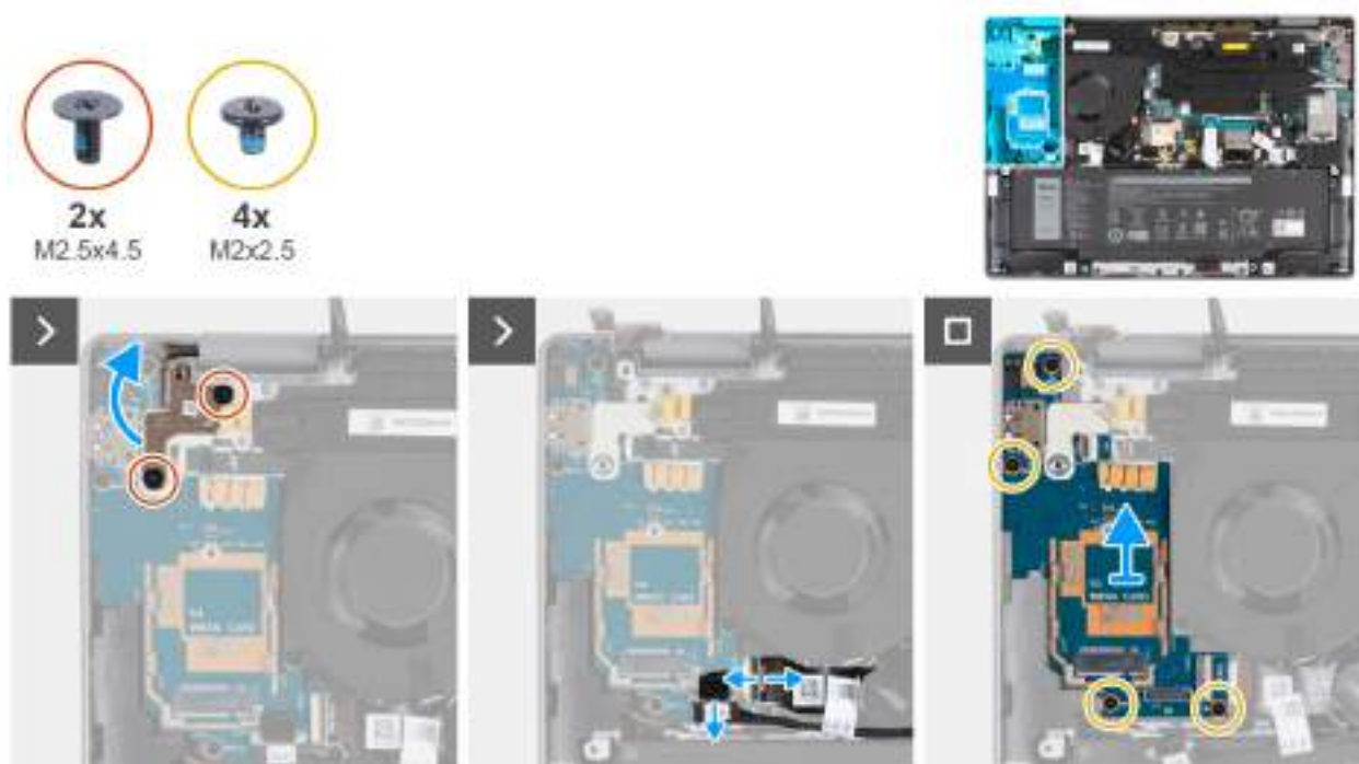
Obrázek 84. Demontáž desky I/O (pro počítače dodávané s podporou sítě WWAN)
