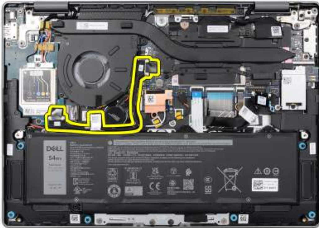
Obrázek 52. Umístění kabelu desky I/O
