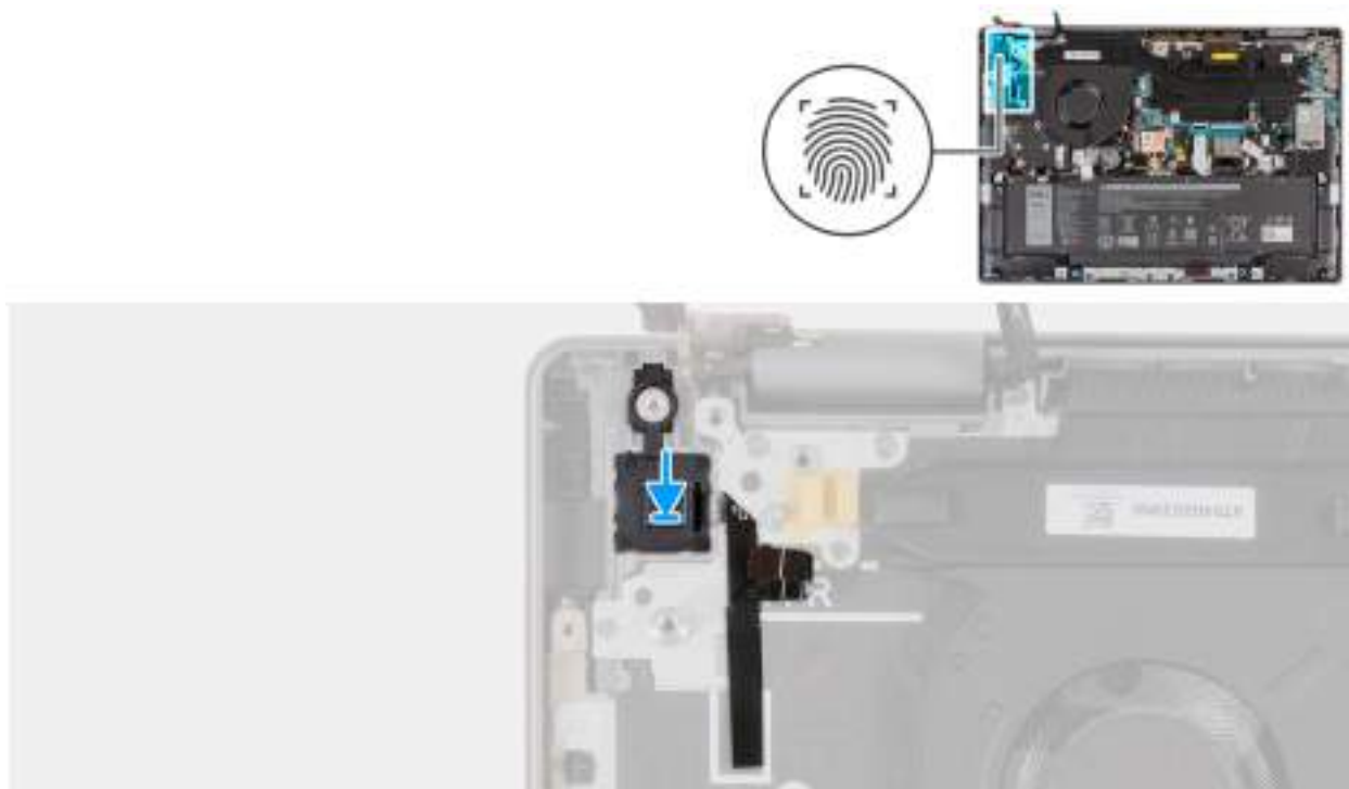
Obrázek 91. Montáž vypínače se čtečkou otisků prstů
