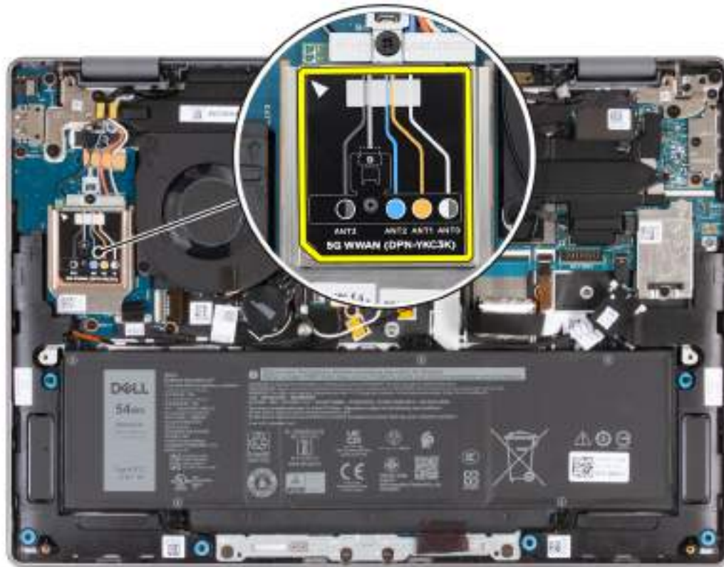
Obrázek 29. Připojení kabelů antény
