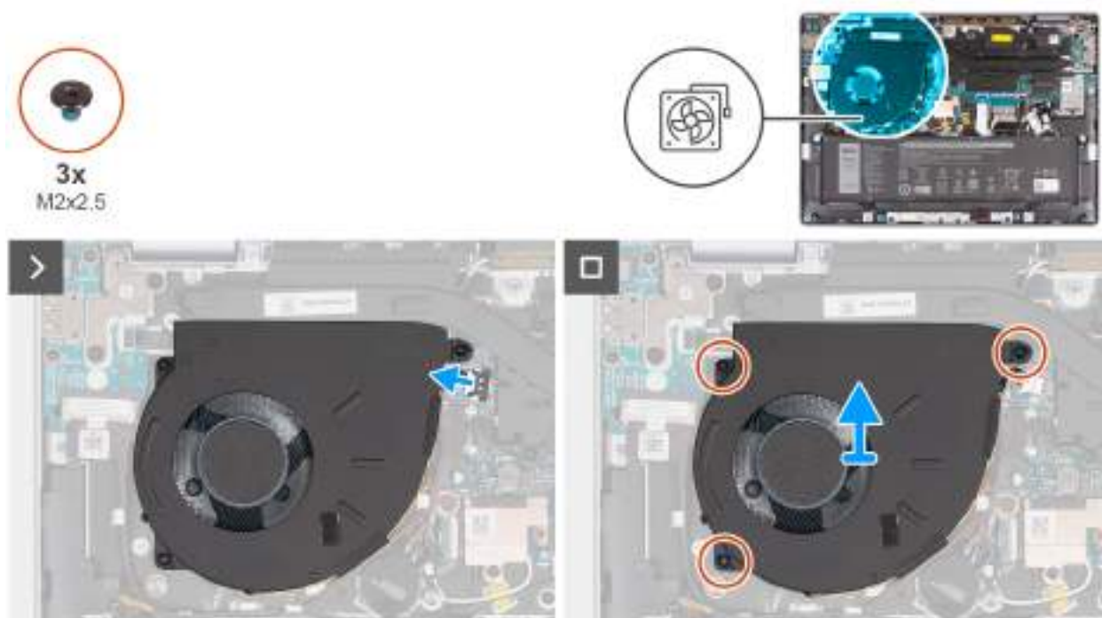
Obrázek 35. Demontáž ventilátoru (pro počítače dodávané pouze s podporou sítě WLAN)
