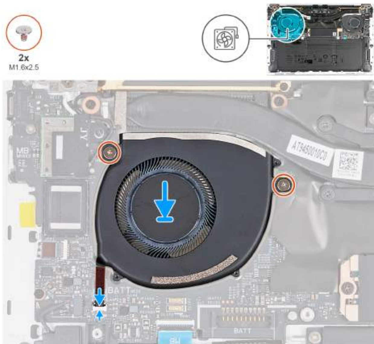
Obrázek 39. Montáž pravého ventilátoru
