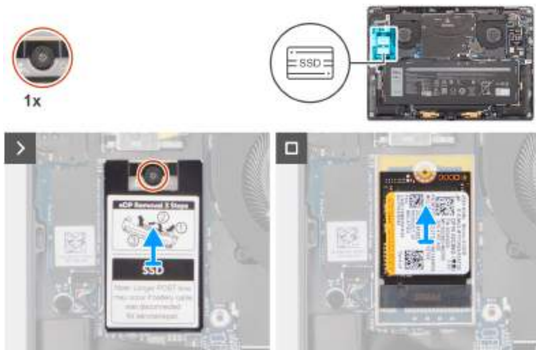
Obrázek 28. Demontáž disku SSD
