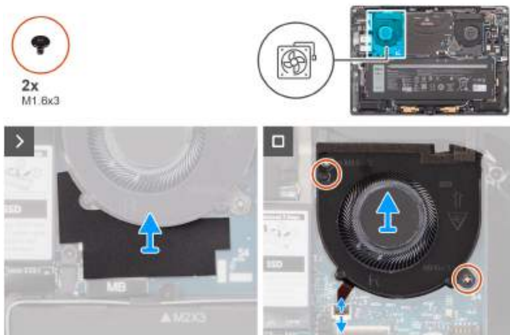
Obrázek 24. Demontáž pravého ventilátoru
