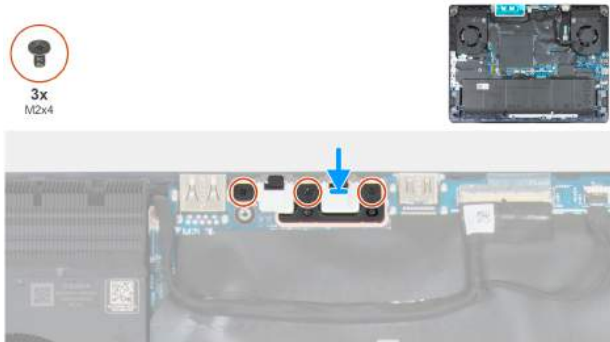
Obrázek 40. Montáž držáku portu USB Type-C
