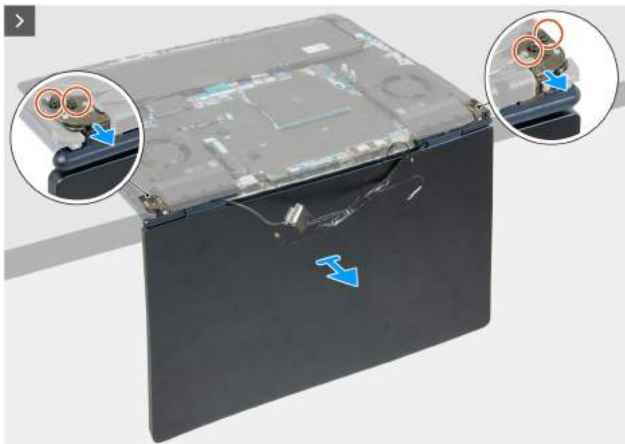
Obrázek 72. Demontáž sestavy displeje
