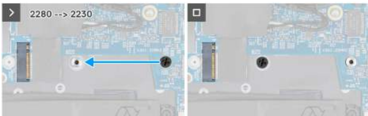
Obrázek 32. Postup přesunutí šroubového držáku pro instalaci M2.2230
