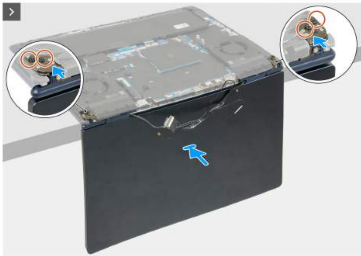
Obrázek 74. Montáž sestavy displeje
