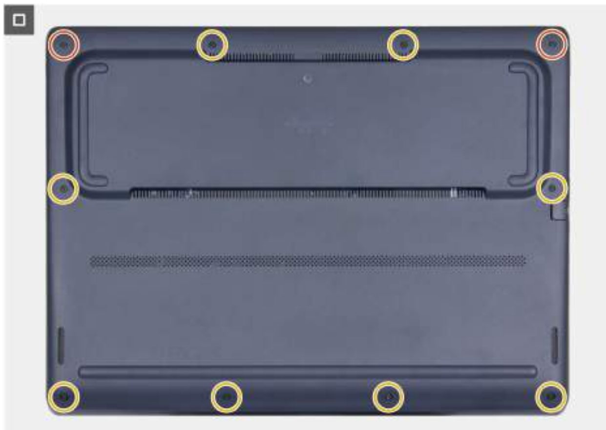
Obrázek 16. Nasazení spodního krytu
