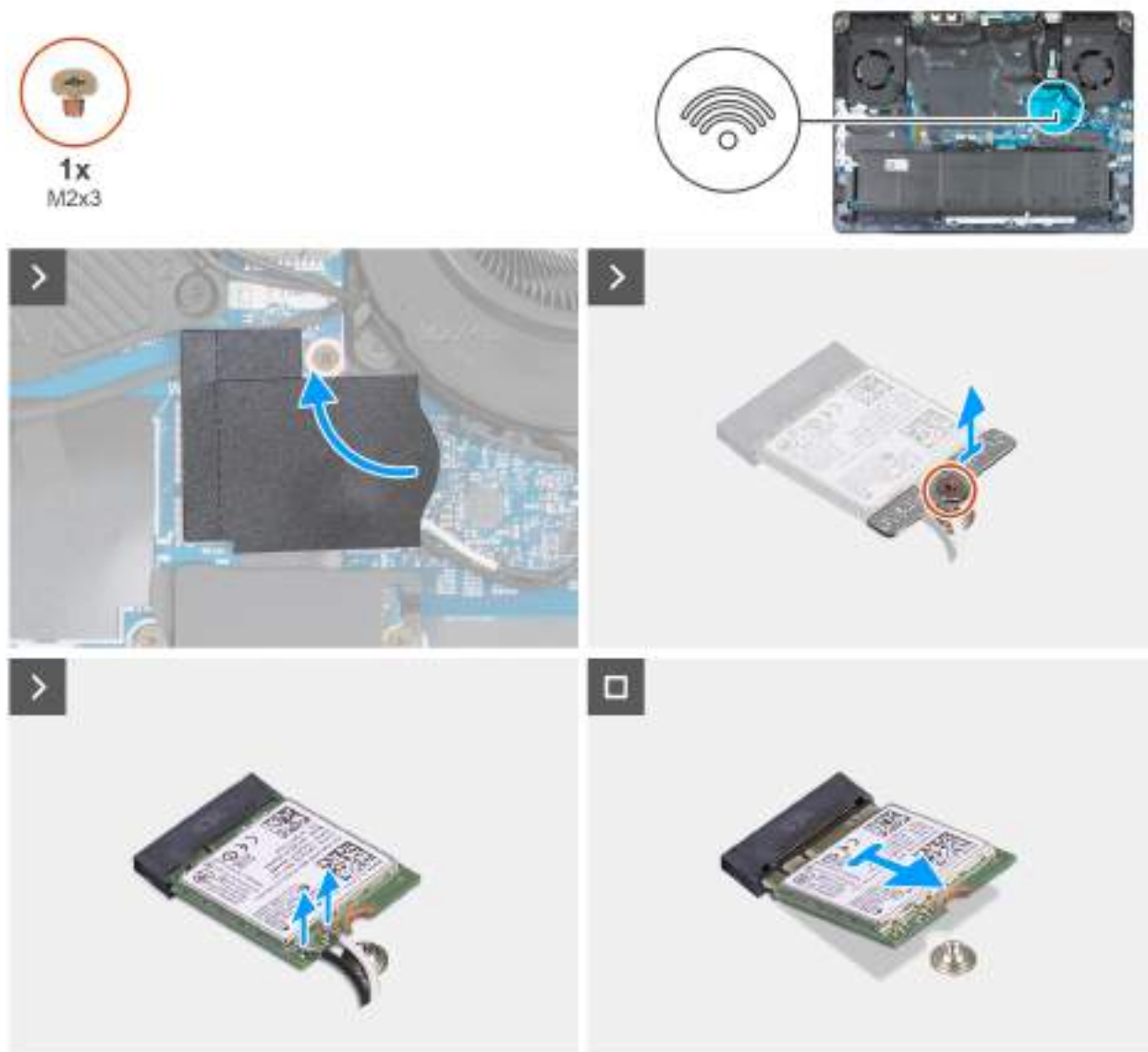
Obrázek 33. Demontáž bezdrátové karty
