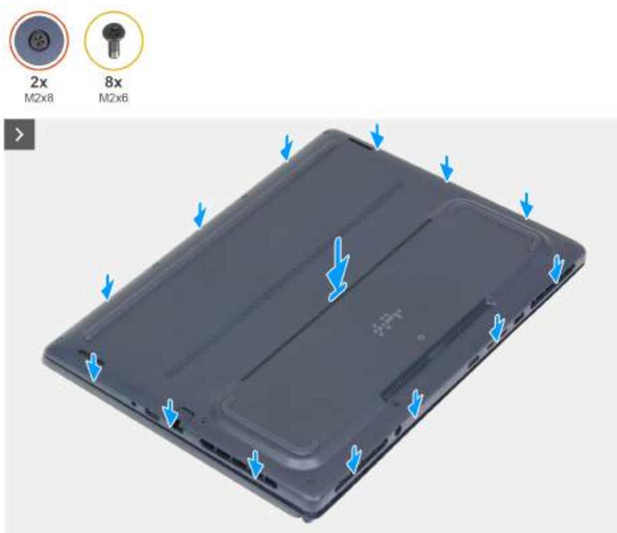
Obrázek 15. Nasazení spodního krytu
