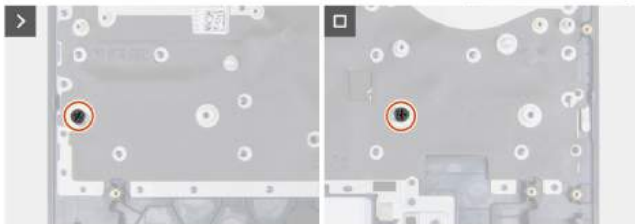
Obrázek 77. Demontáž šroubových držáků disku SSD
