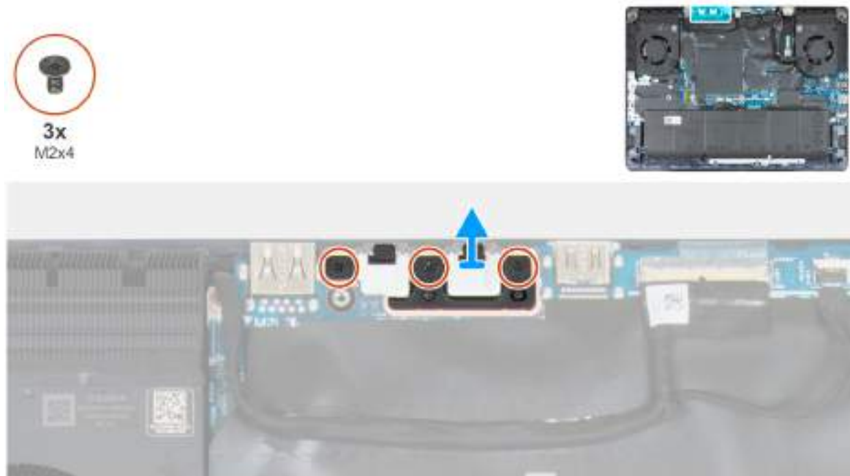
Obrázek 39. Demontáž držáku portu USB Type-C
