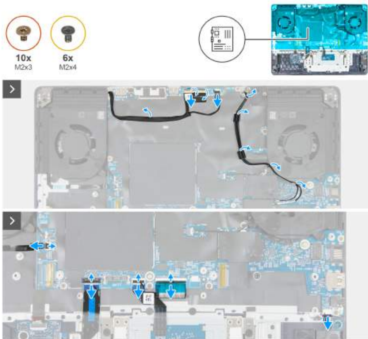
Obrázek 48. Demontáž základní desky
