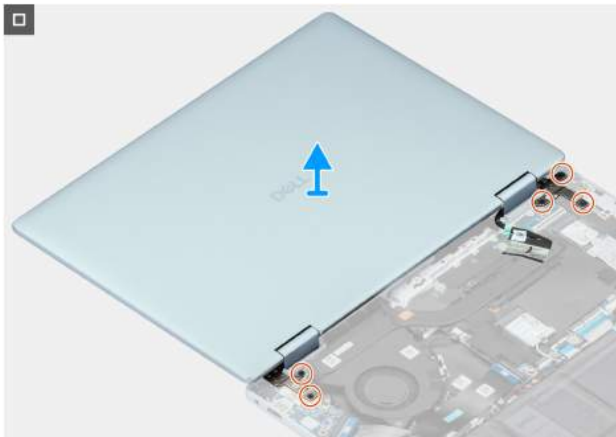
Obrázek 43. Demontáž sestavy displeje
