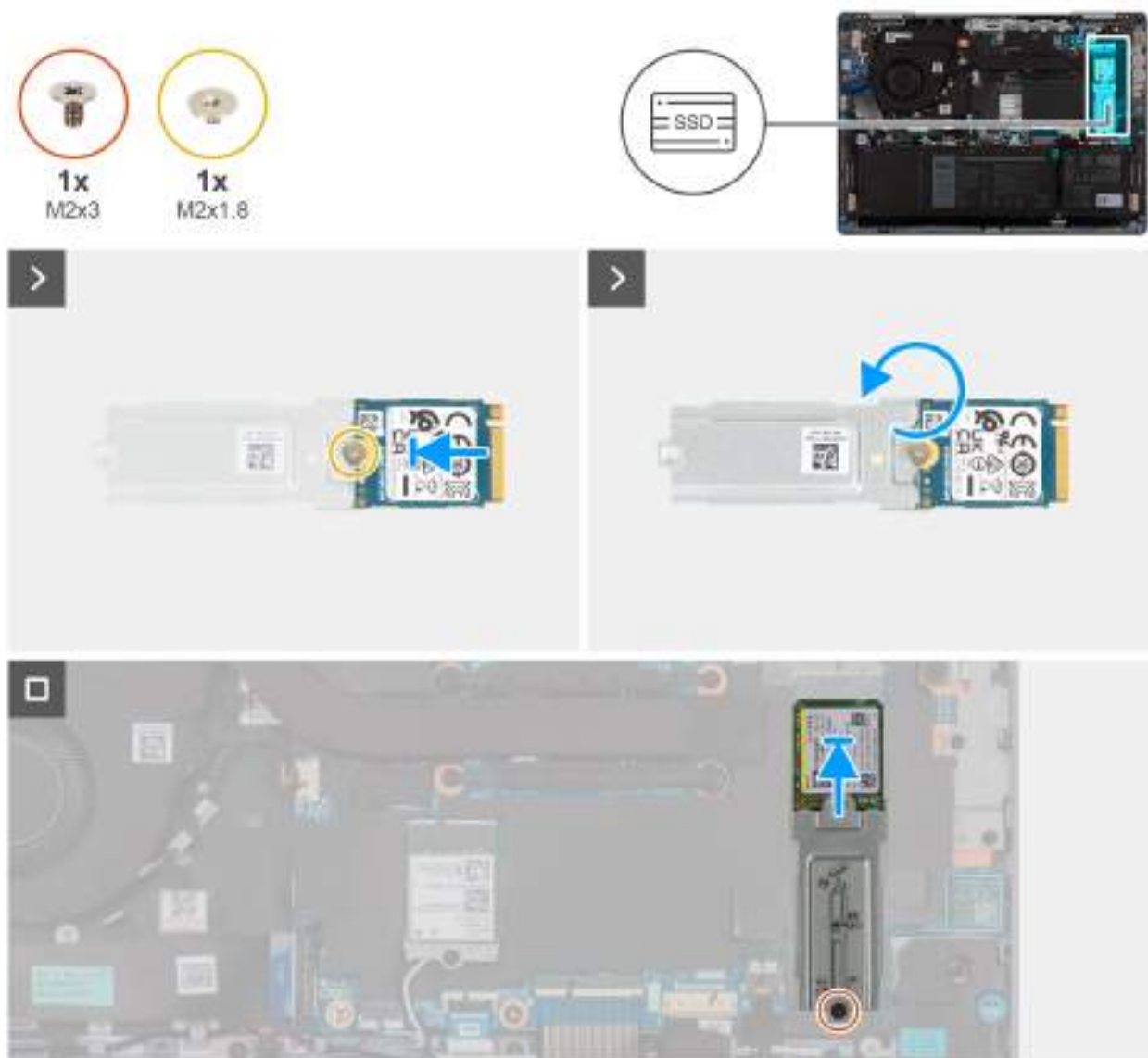
Obrázek 23. Montáž disku SSD
