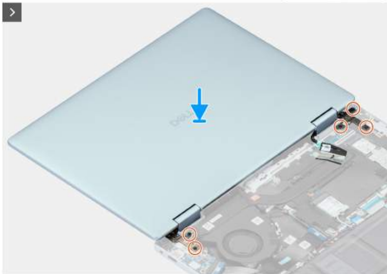
Obrázek 46. Montáž sestavy displeje
