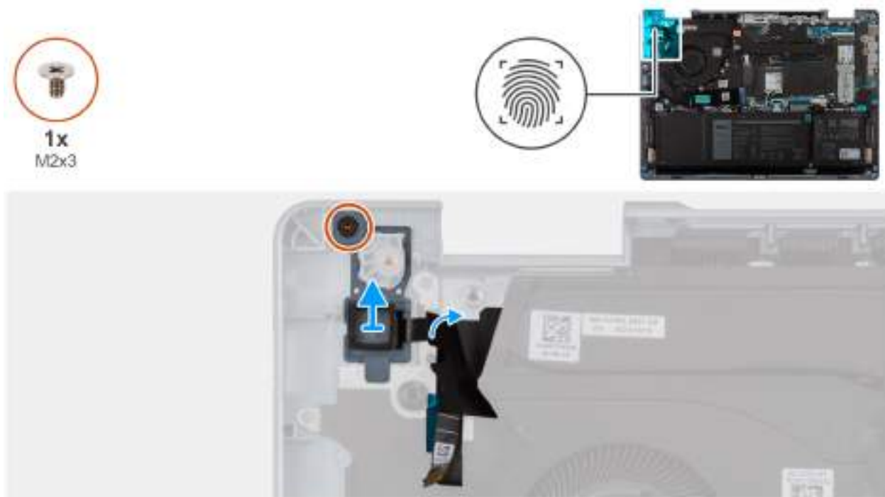
Obrázek 34. Demontáž vypínače se čtečkou otisků prstů
