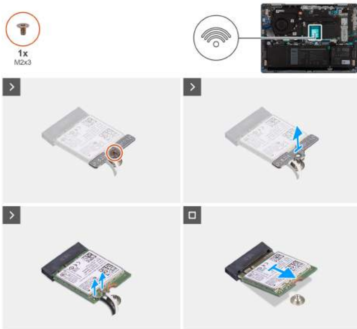
Obrázek 24. Demontáž bezdrátové karty
