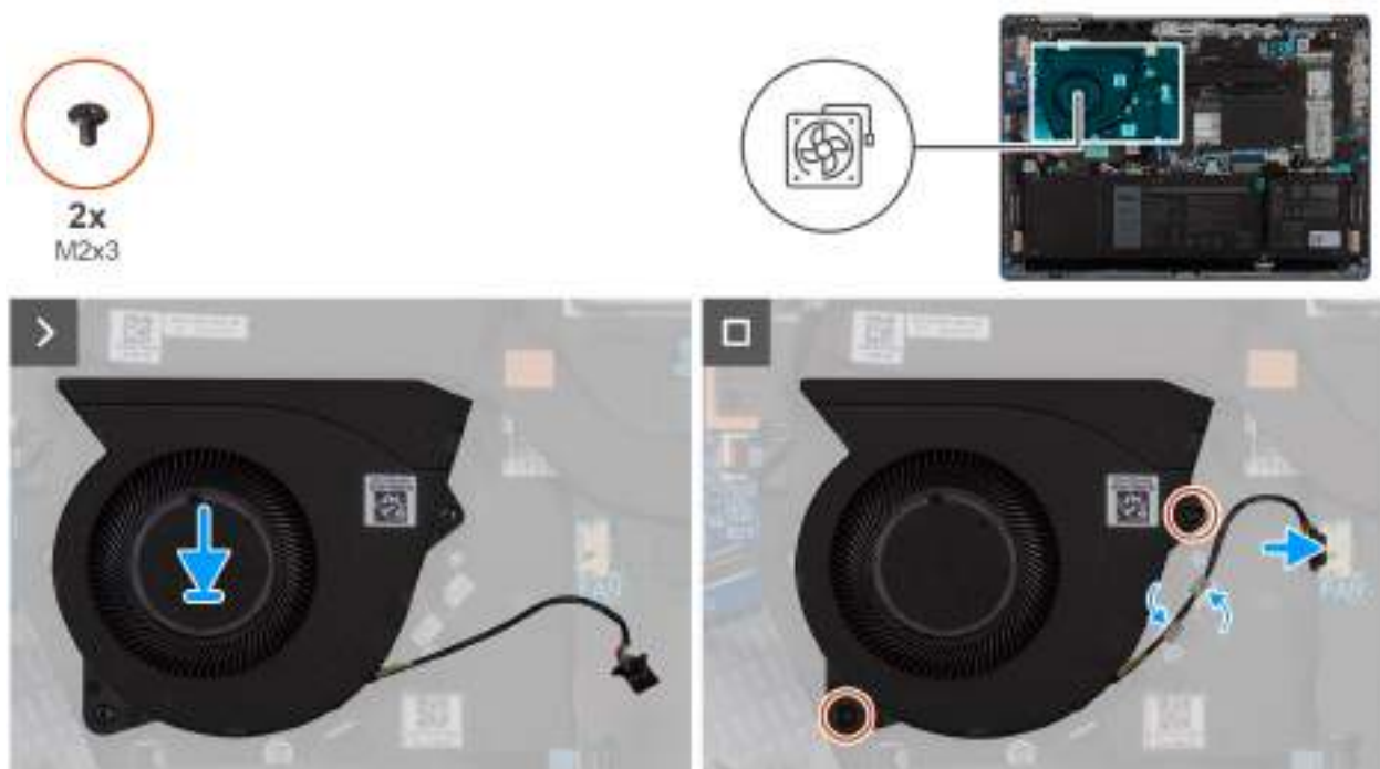
Obrázek 27. Montáž systémového ventilátoru
