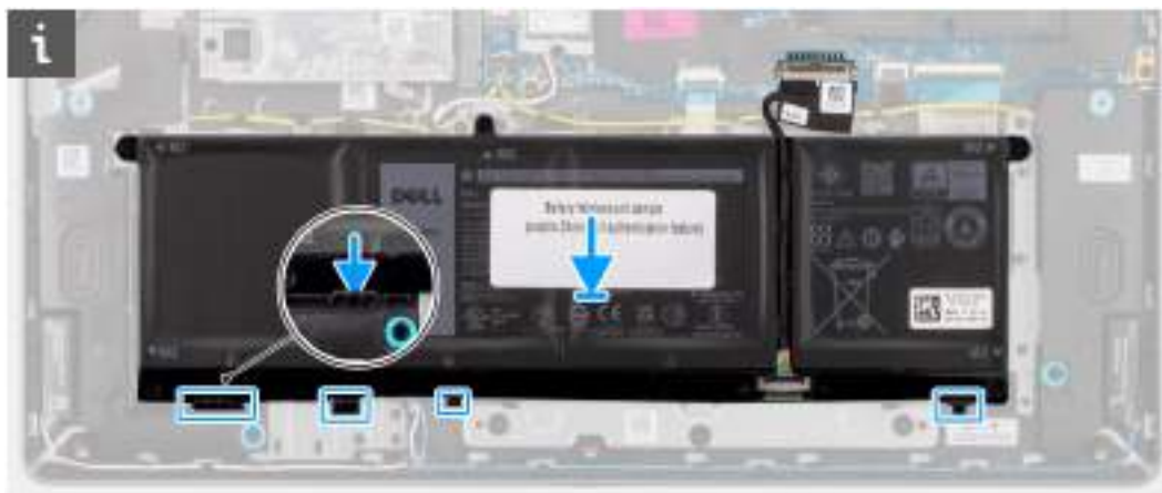
Obrázek 18. Vložení baterie – zasunutí výčnělků do háčků
