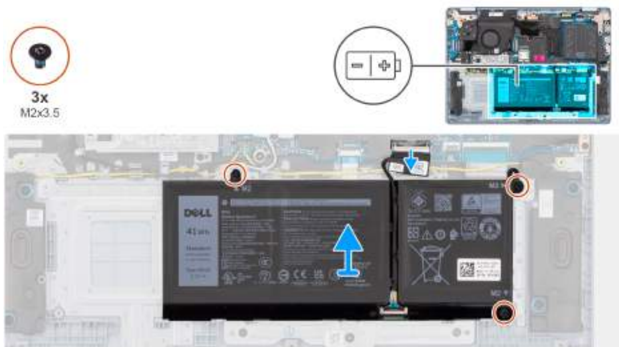
Obrázek 16. Demontáž 3čláňkové baterie
