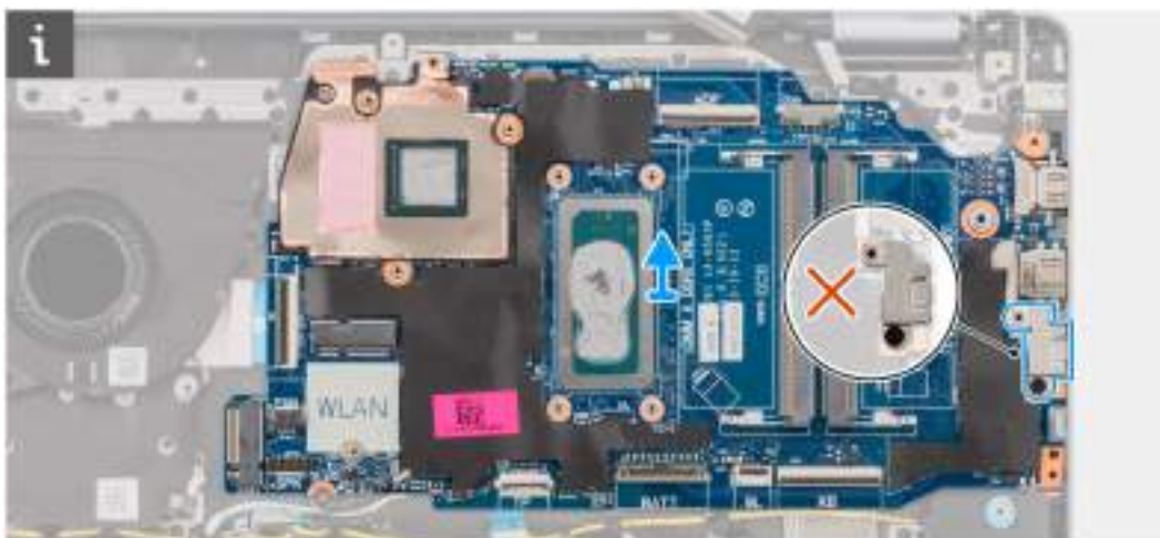
Obrázek 83. System board - USB Type-C bracket
