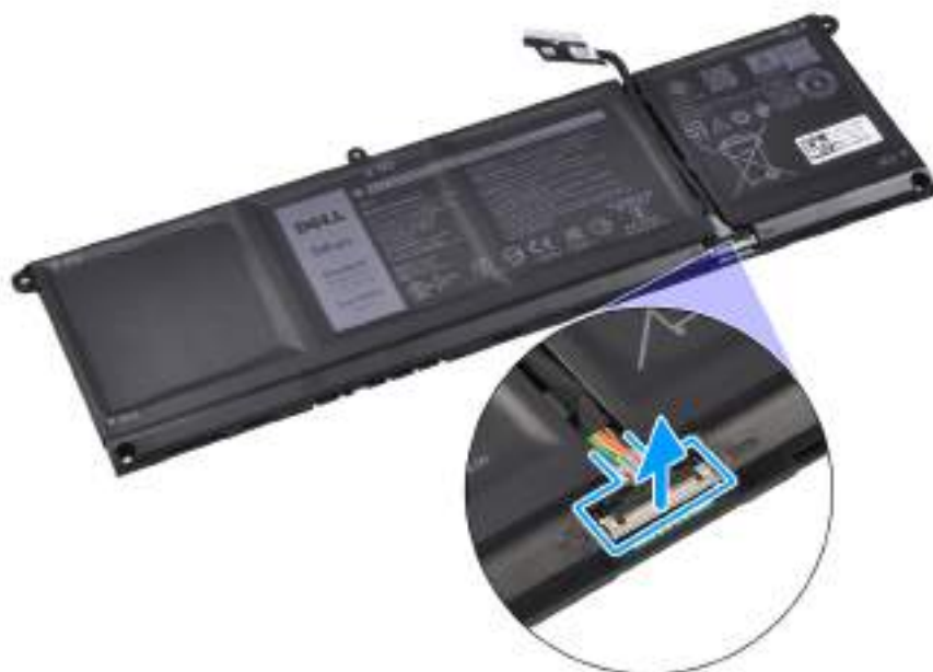
Obrázek 24. Odpojení kabelu baterie
