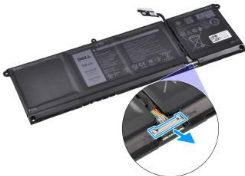
Obrázek 23. Uvolnění konektoru kabelu baterie
