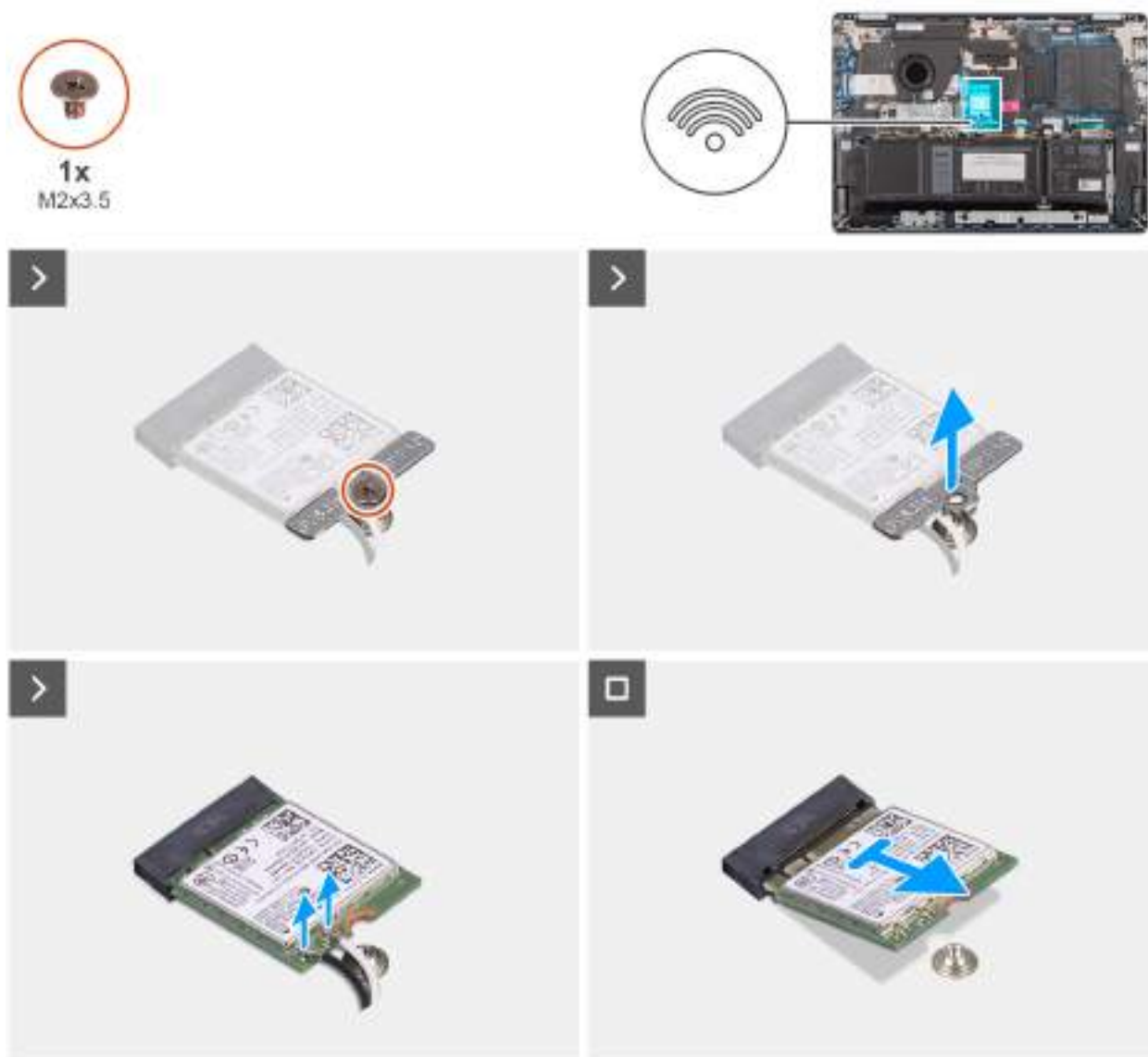
Obrázek 30. Demontáž bezdrátové karty
