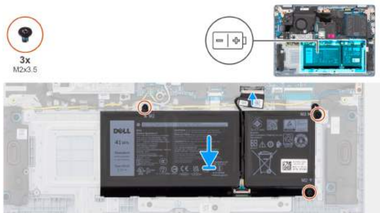
Obrázek 17. Montáž 3člankové baterie
