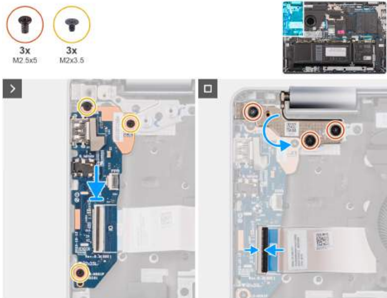
Obrázek 49. Vložení desky I/O
