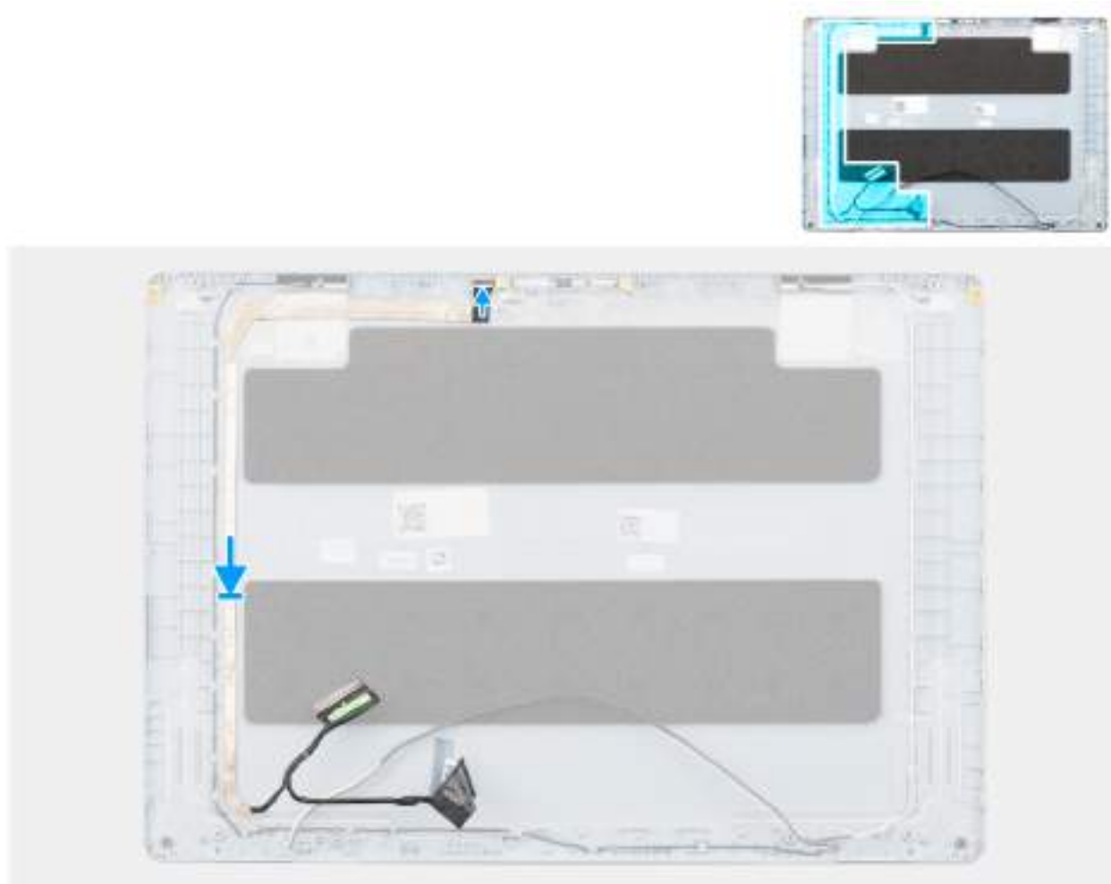
Obrázek 67. Vložení kabelu displeje
