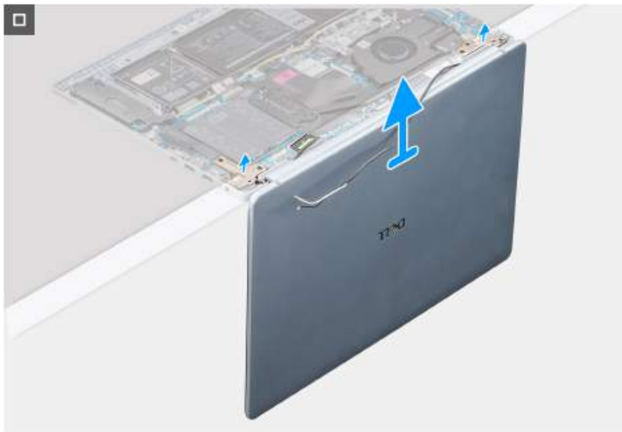
Obrázek 51. Removing the display assembly
