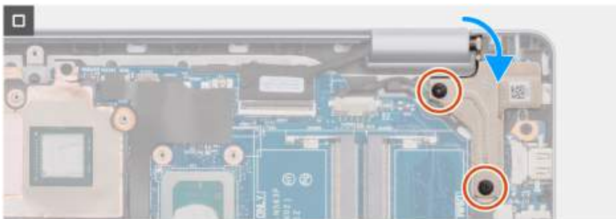
Obrázek 87. Montáž základní desky
