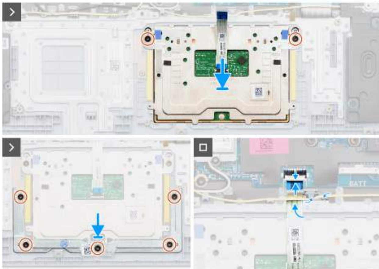
Obrázek 45. Montáž dotykové podložky
