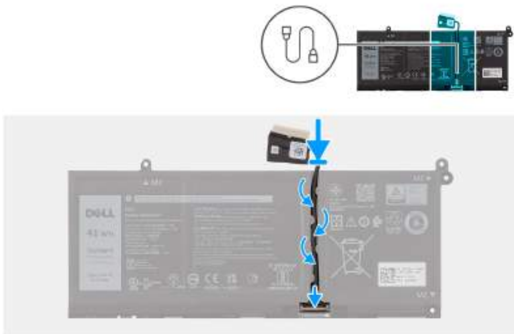
Obrázek 25. Připojení kabelu baterie
