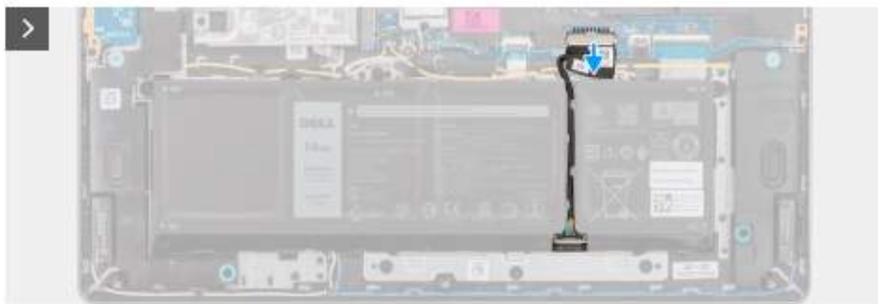
Obrázek 32. Odpojení kabelu baterie
