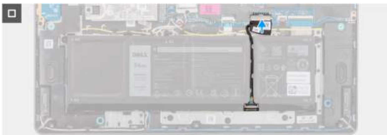
Obrázek 36. Připojení kabelu baterie
