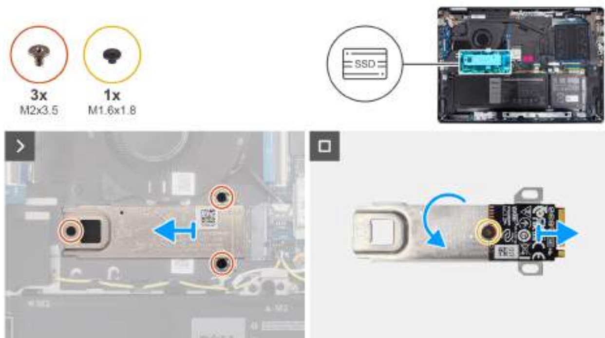
Obrázek 28. Demontáž disku SSD
