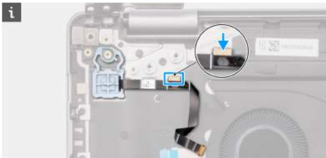
Obrázek 76. Připevnění kabelu čtečky otisků prstů k sestavě opěrky rukou a klávesnice
