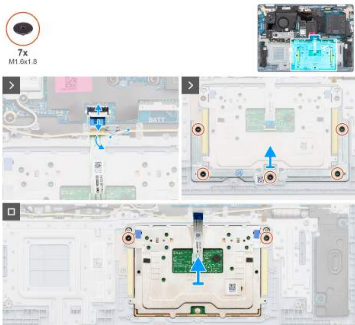
Obrázek 44. Demontáž dotykové podložky
