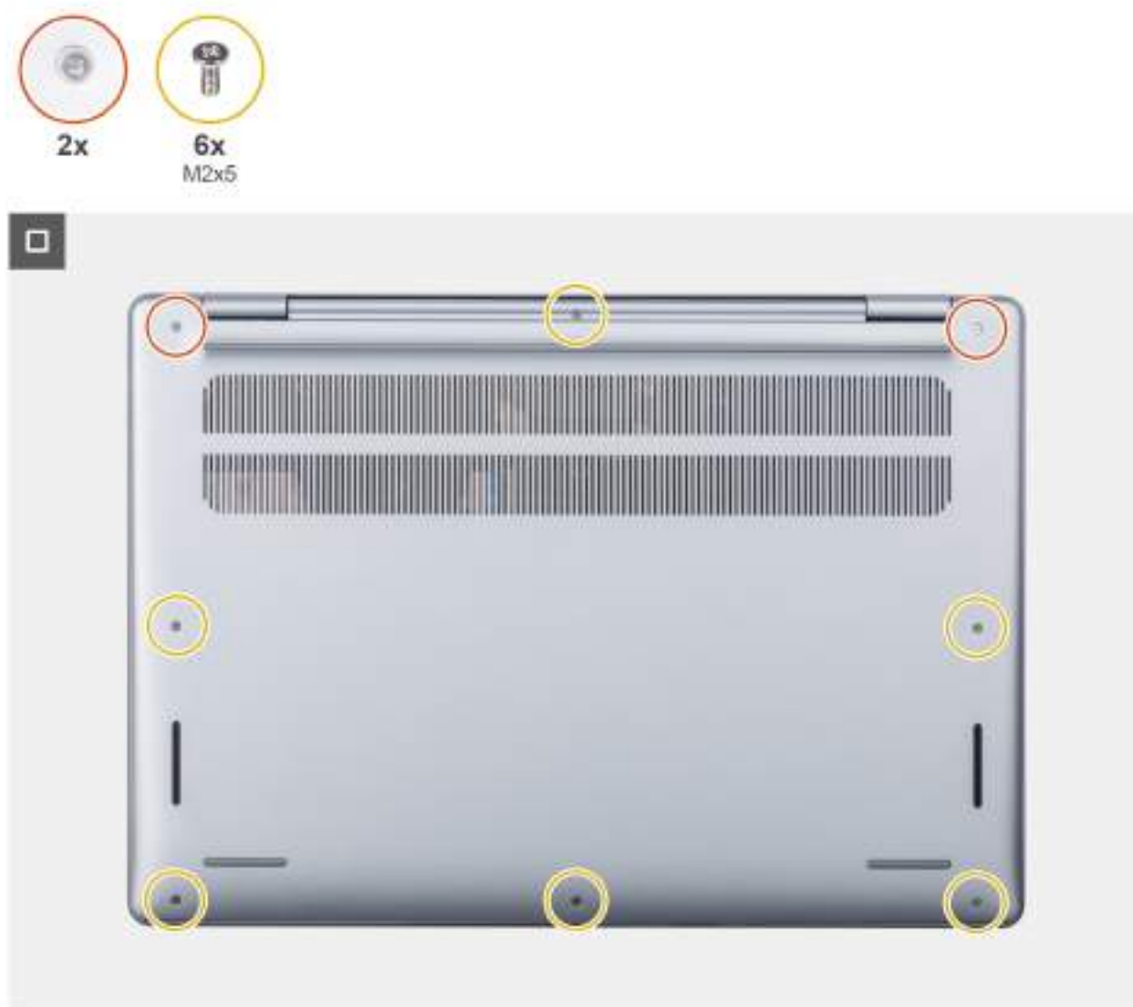
Obrázek 15. Nasazení spodního krytu
