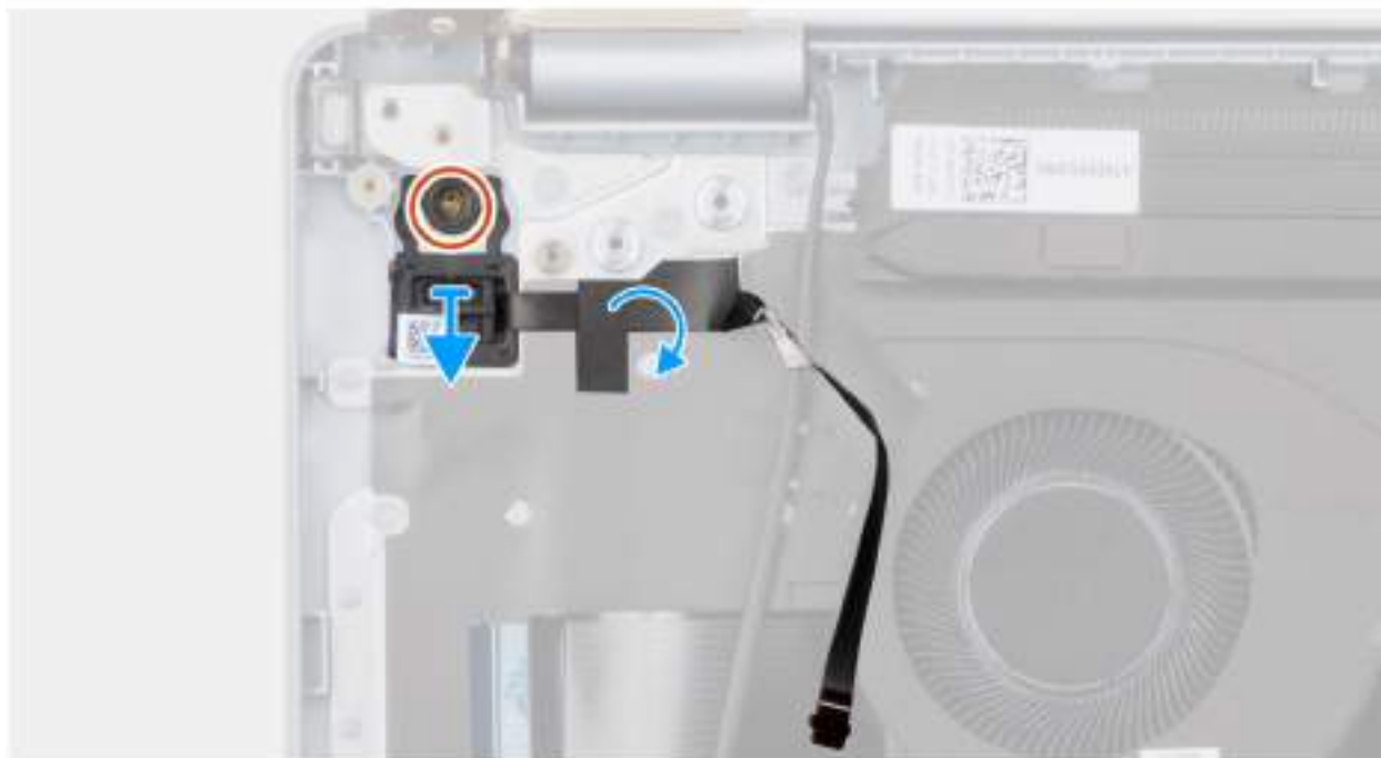
Obrázek 74. Demontáž vypínače se čtečkou otisků prstů
