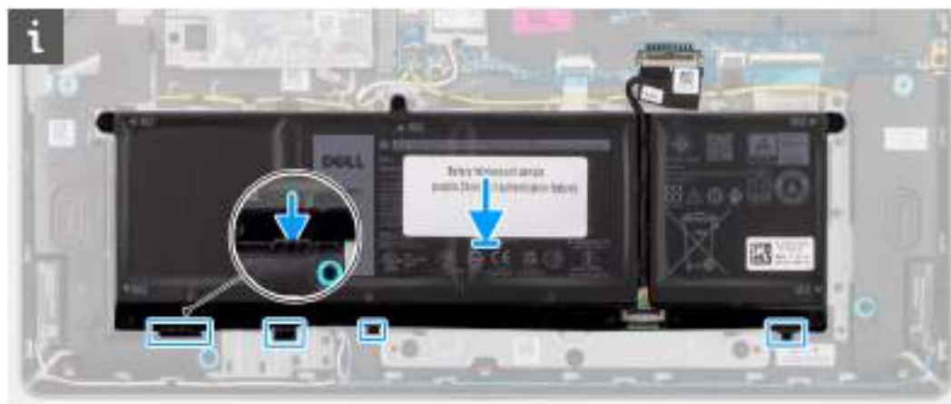
Obrázek 21. Vložení baterie – zasunutí výčnělků do háčků
