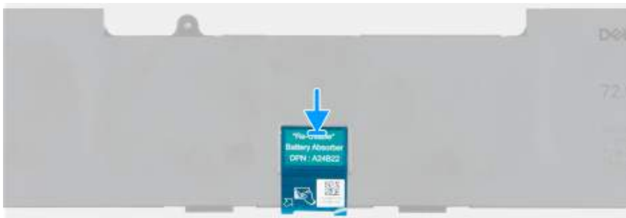
Obrázek 20. Montáž absorbéru baterie
