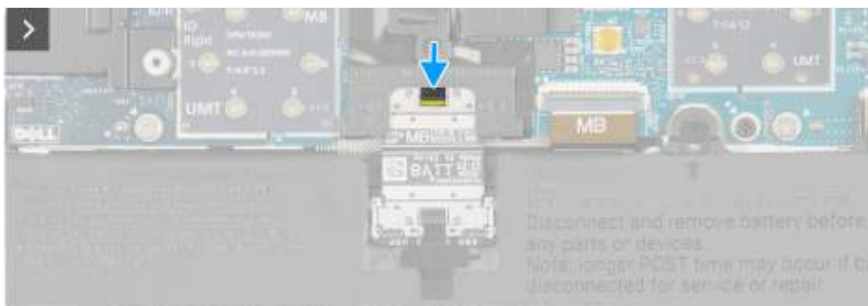
Obrázek 16. Obnovení napájení z baterie
