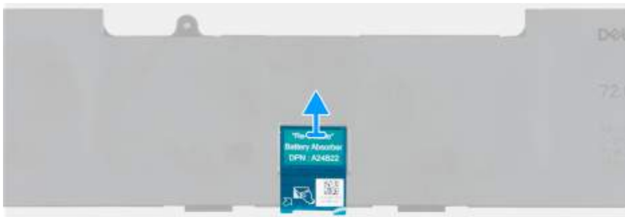
Obrázek 18. Demontáž absorbéru baterie
