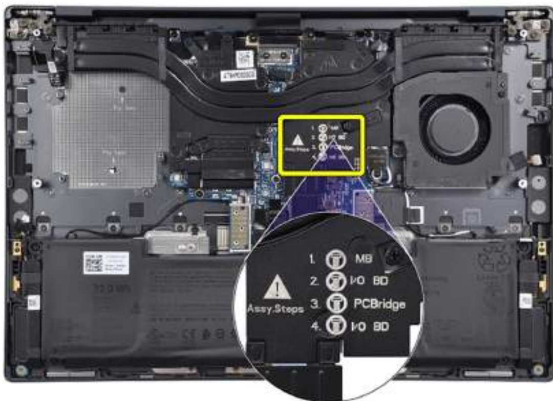
Obrázek 66. Montážní kroky vytištěné na chladiči
