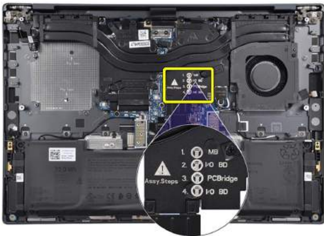
Obrázek 57. Montážní kroky vytištěné na chladiči
