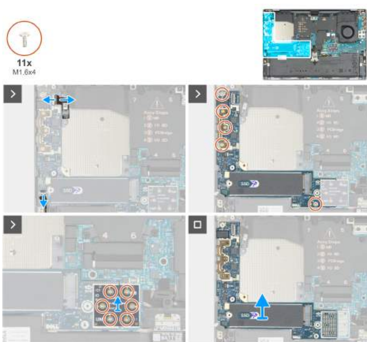
Obrázek 47. Demontáž pravé desky I/O
