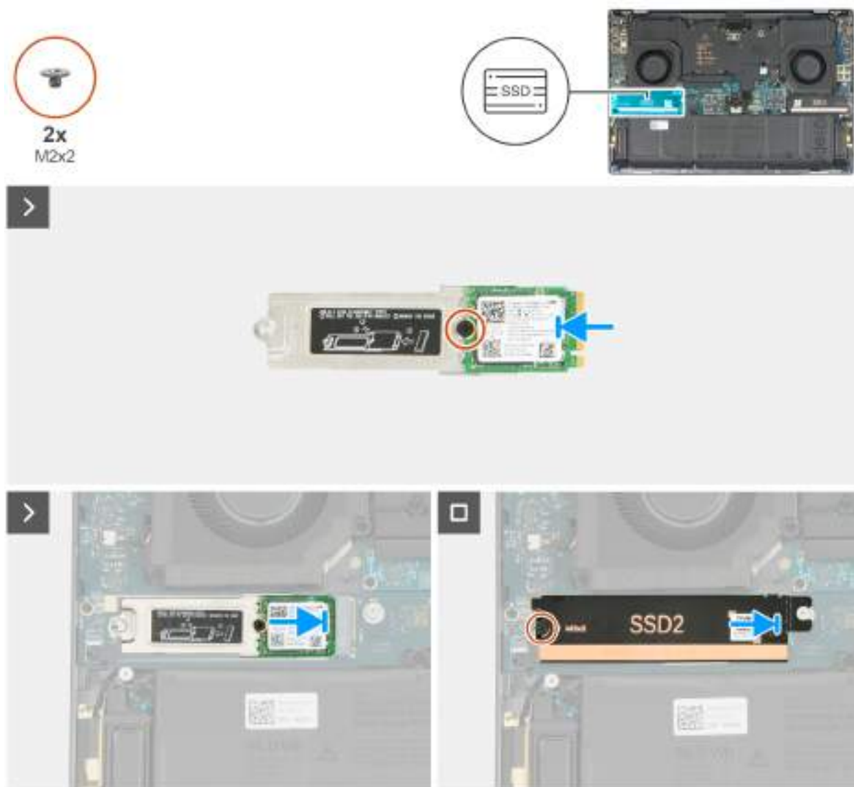
Obrázek 29. Montáž disku SSD M.2 2230 (SSD2)
