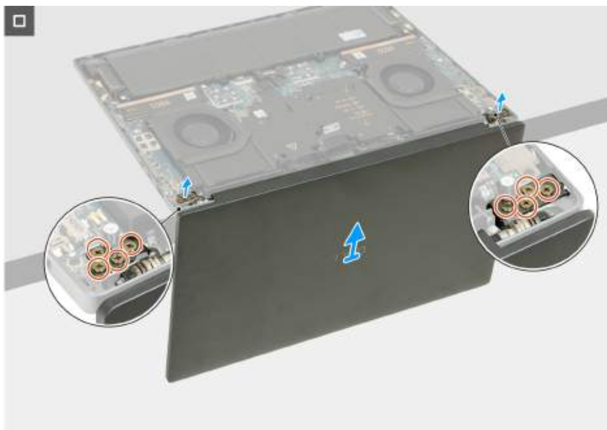
Obrázek 35. Demontáž sestavy displeje
