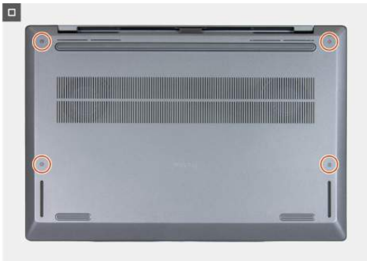
Obrázek 16. Nasazení spodního krytu
