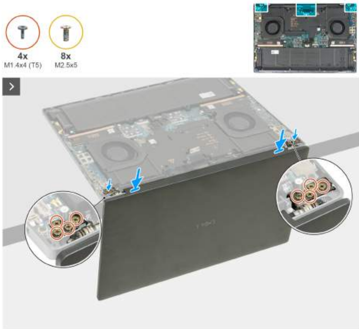
Obrázek 42. Montáž sestavy displeje
