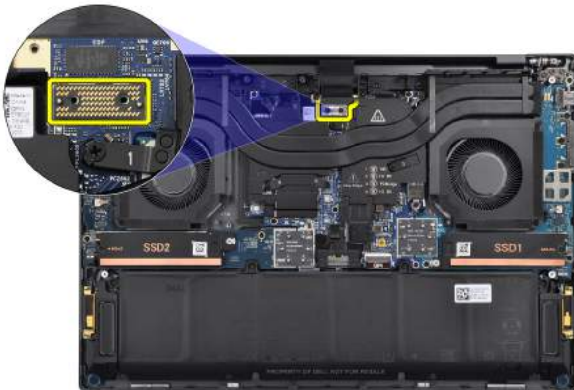
Obrázek 44. Deska mezikusu kabelu sestavy displeje
