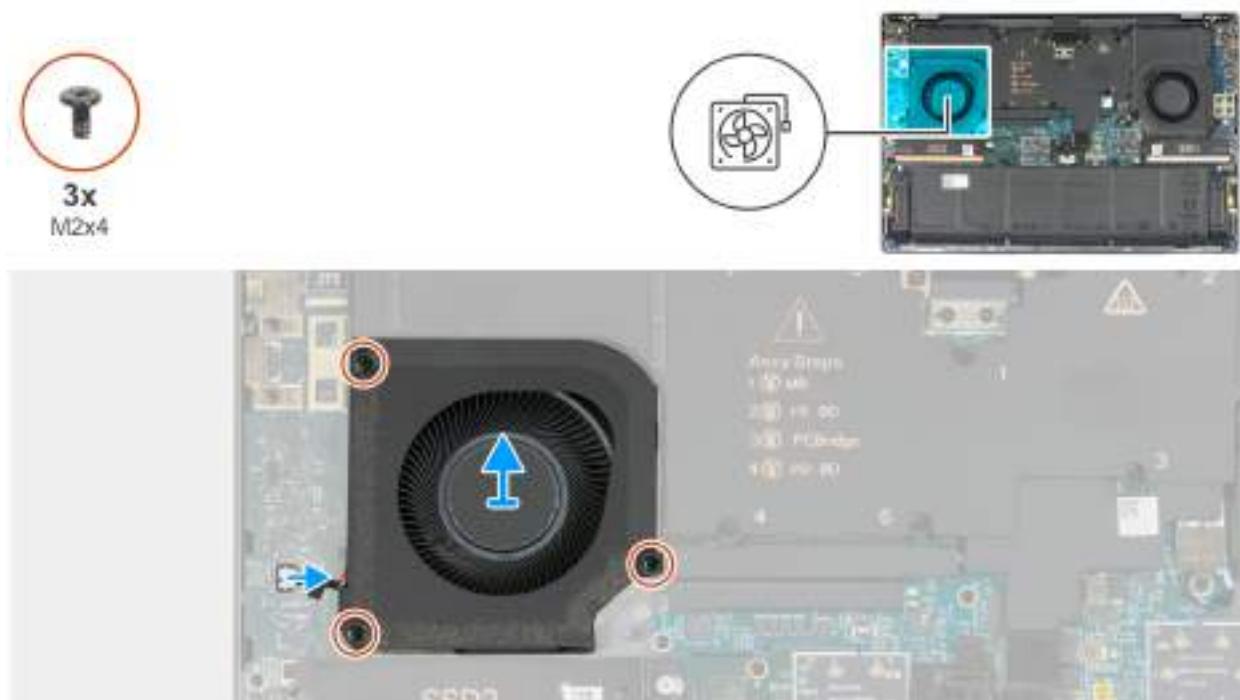
Obrázek 32. Demontáž pravého ventilátoru
