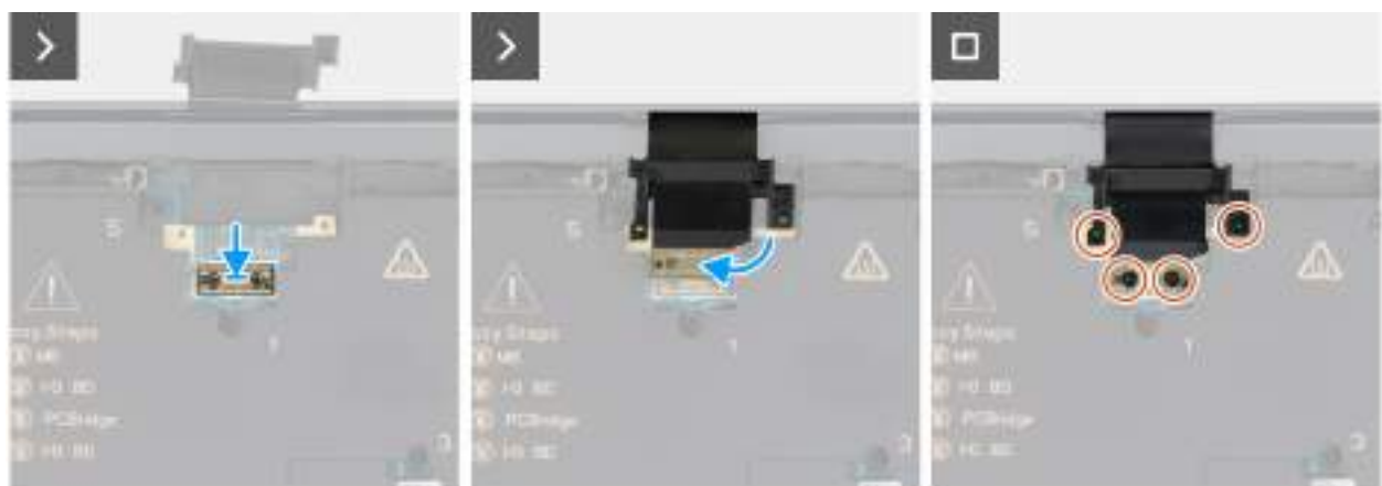
Obrázek 43. Montáž sestavy displeje
