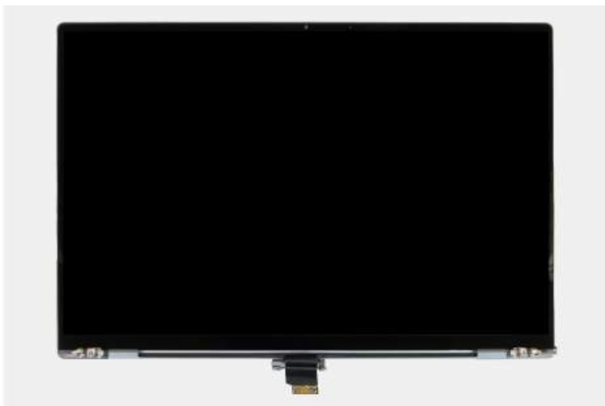
Obrázek 37. Sestava displeje s dotykovou obrazovkou
