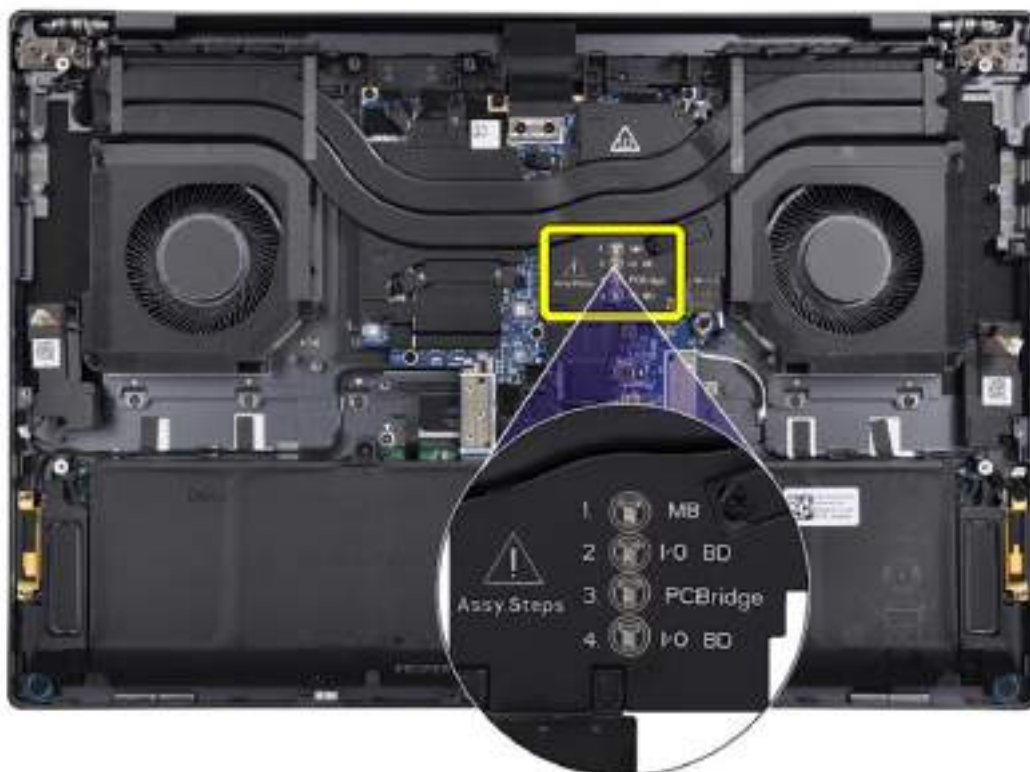
Obrázek 57. Kroky montáže vytištěné na chladiči
