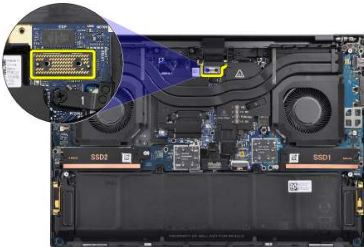
Obrázek 38. Deska mezikusu kabelu sestavy displeje
