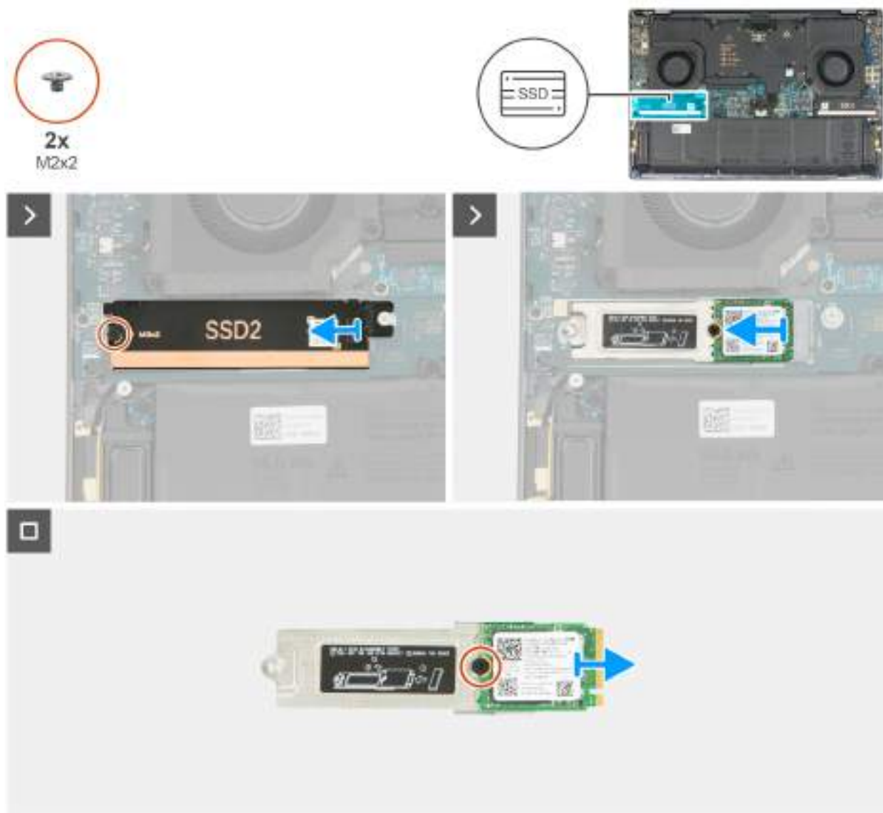
Obrázek 27. Demontáž disku SSD M.2 2230 (SSD2)
