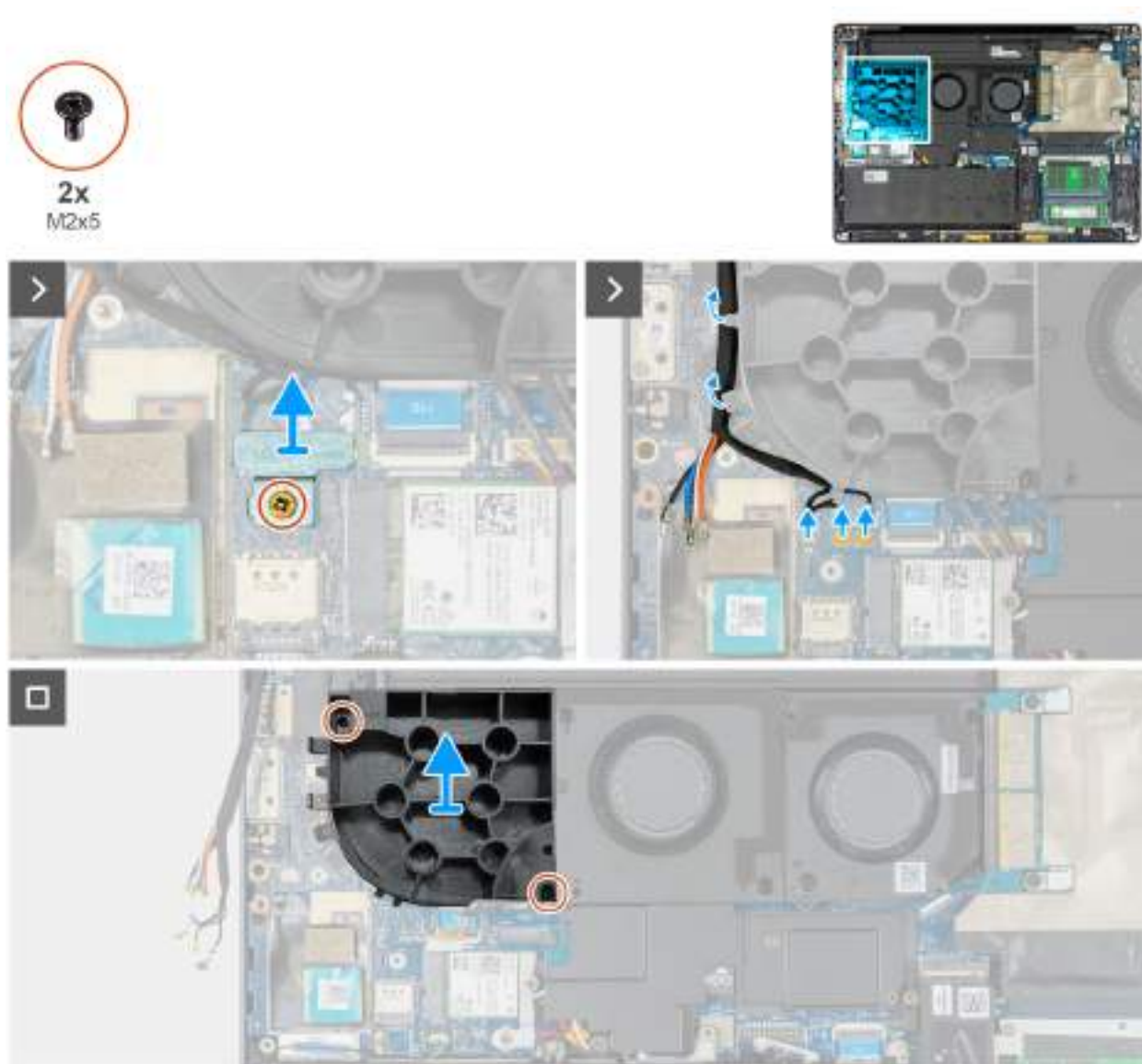
Obrázek 59. Demontáž pomocného ventilátoru
