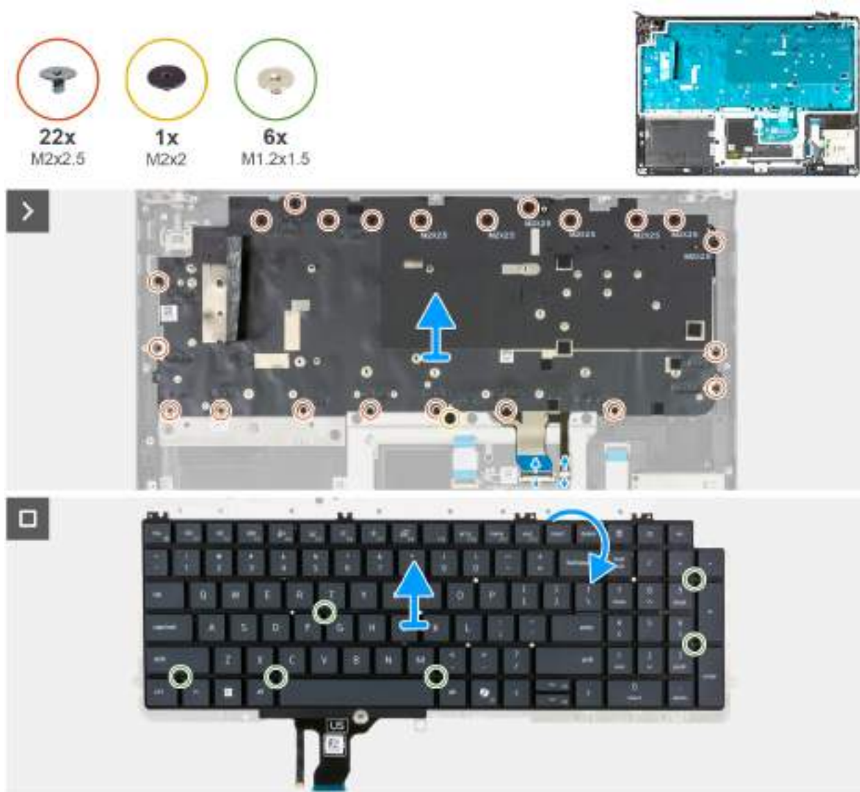
Obrázek 121. Demontáž klávesnice
