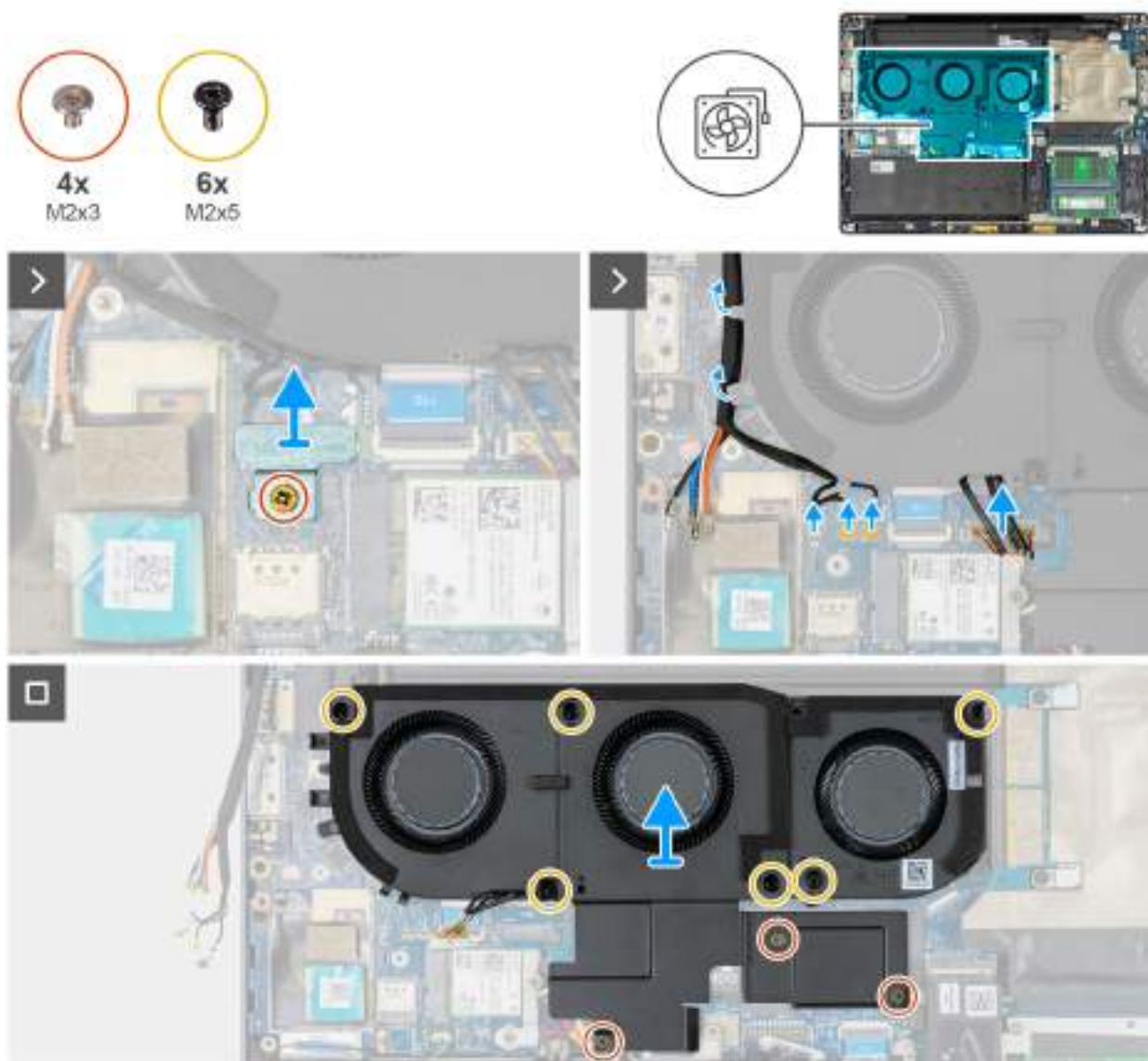
Obrázek 61. Demontáž sestavy ventilátoru
