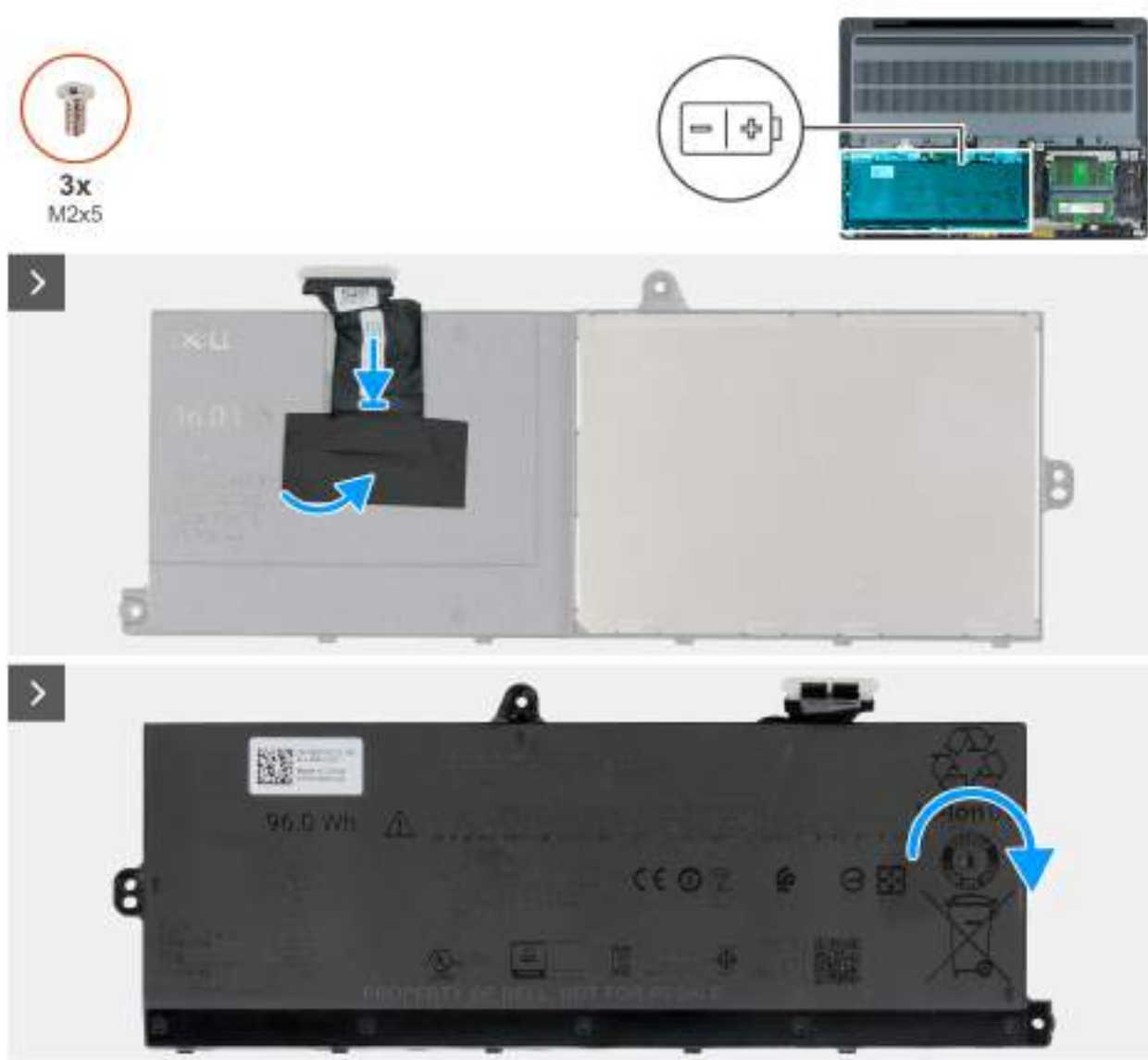
Obrázek 44. Výměna kabelu baterie
