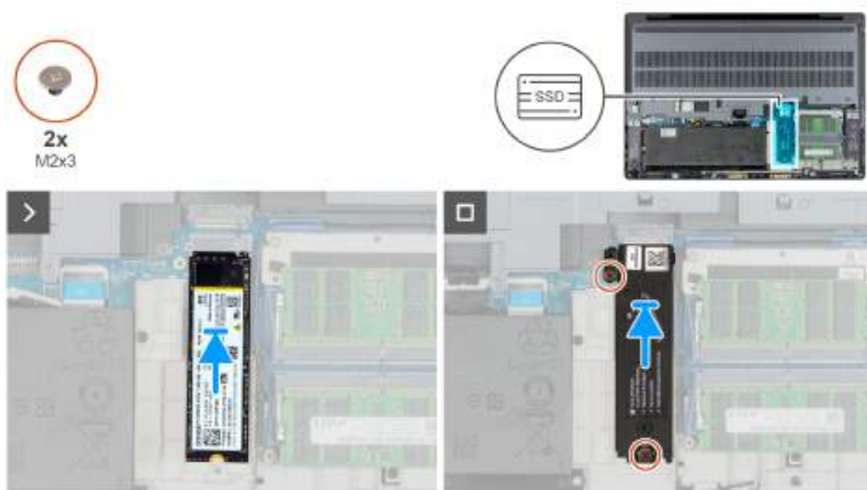
Obrázek 39. Montáž disku SSD M.2 2280 do slotu 2 (SSD2)
