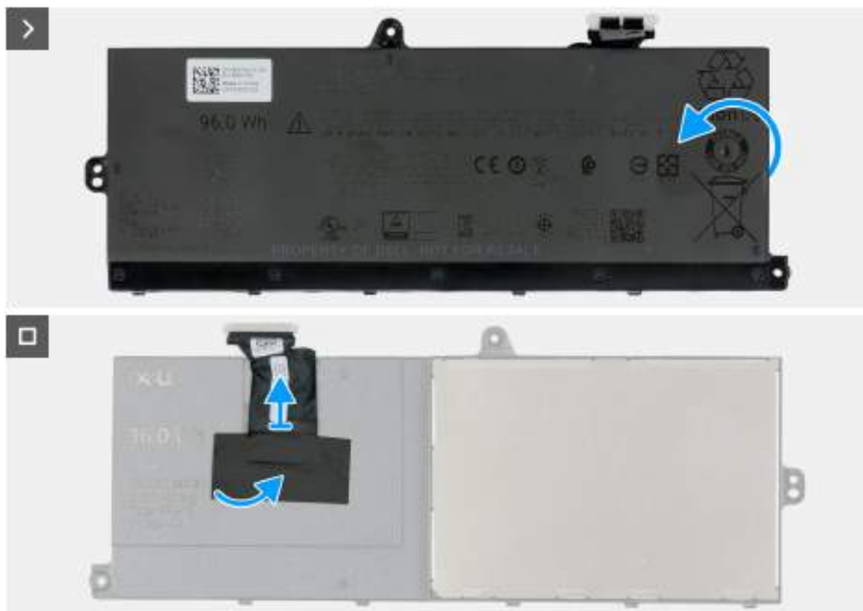
Obrázek 43. Demontáž kabelu baterie z baterie
