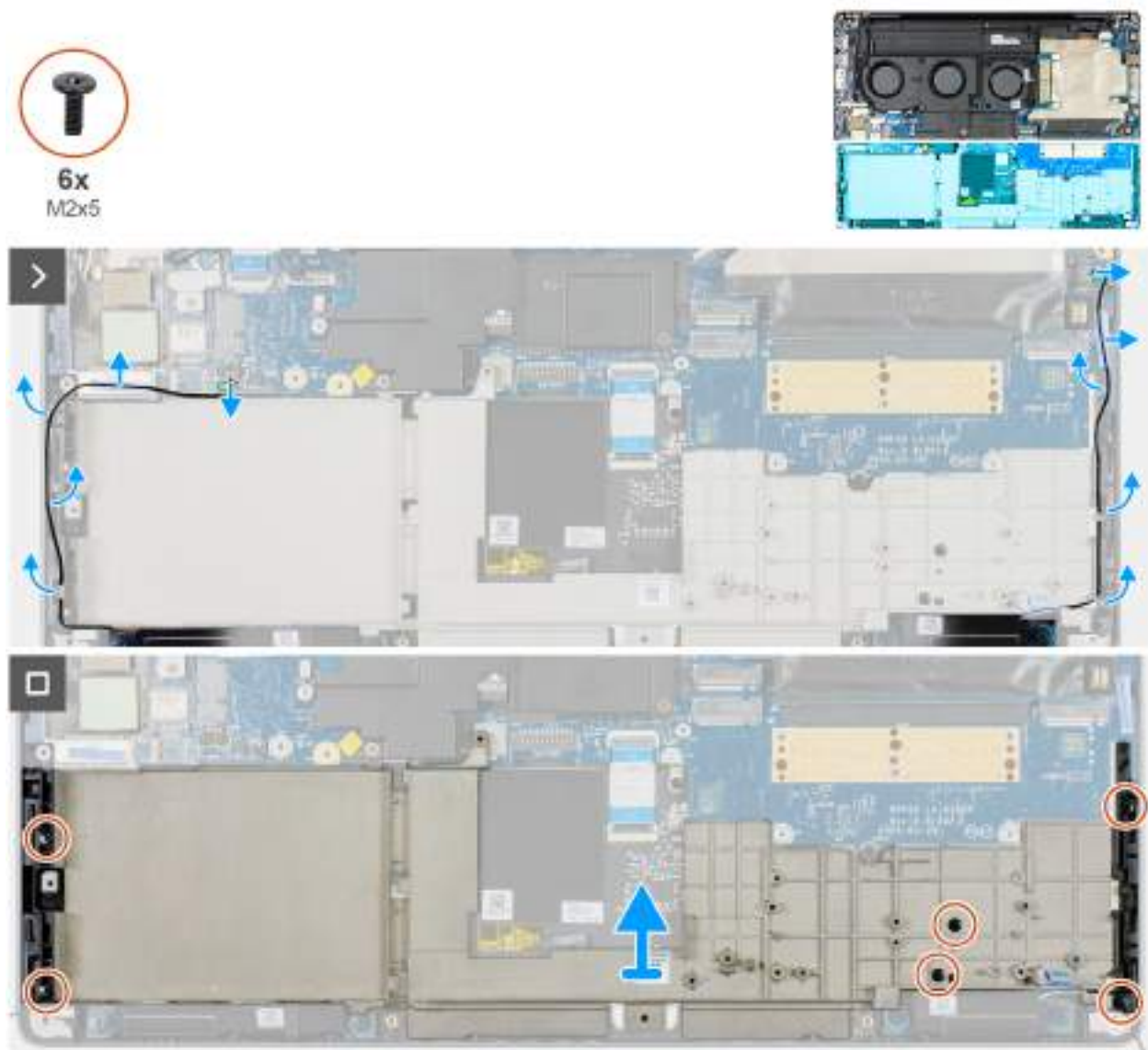
Obrázek 79. Demontáž vnitřního rámu
