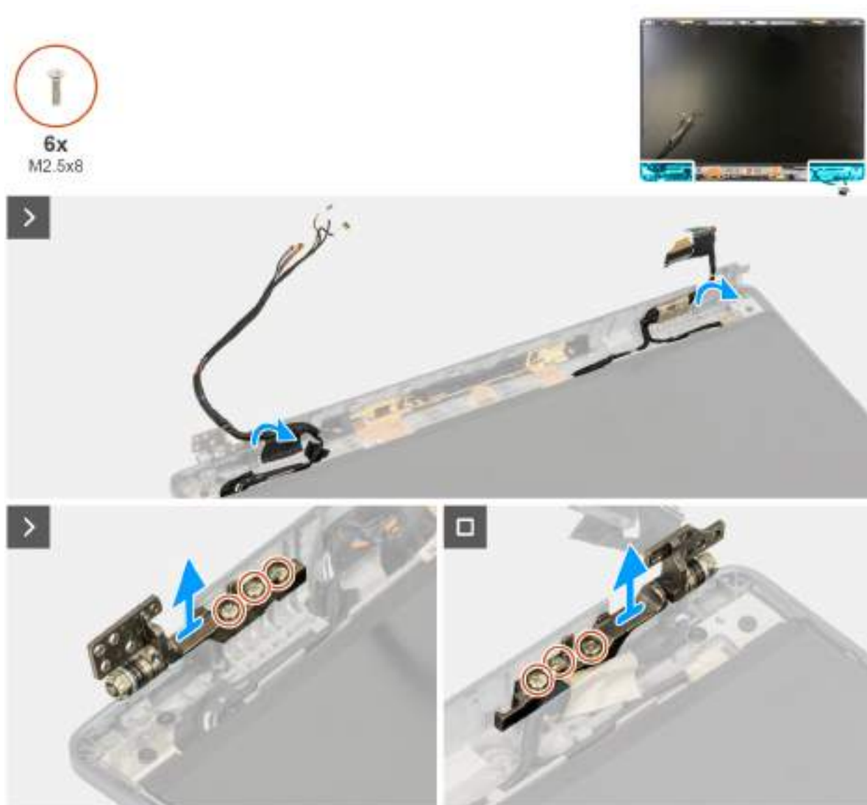
Obrázek 99. Demontáž pantů displeje
