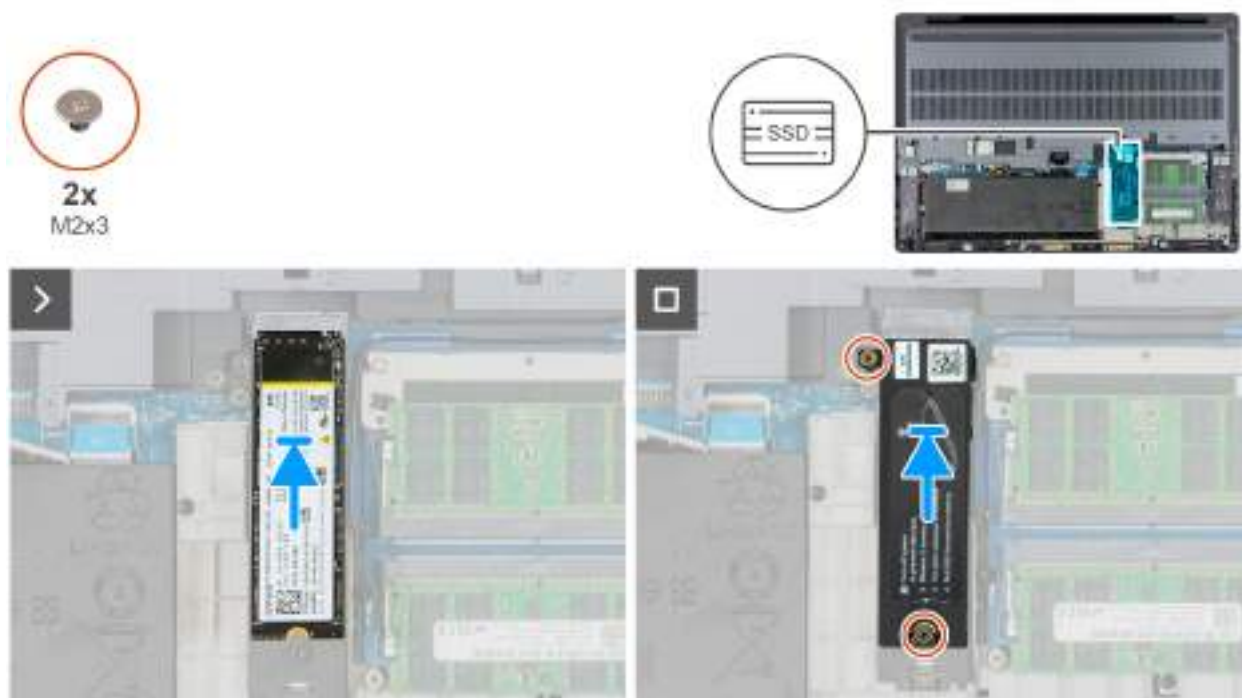
Obrázek 37. Montáž disku SSD M.2 2280 do slotu 3 (SSD3)
