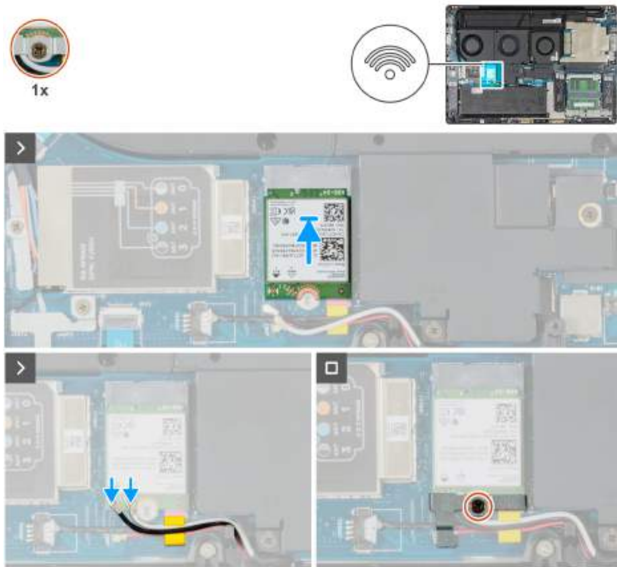
Obrázek 49. Montáž karty sítě WLAN
