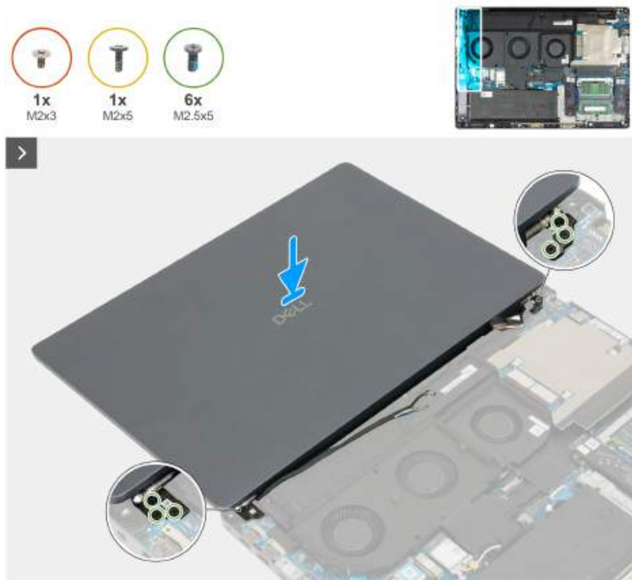
Obrázek 65. Montáž sestavy displeje
