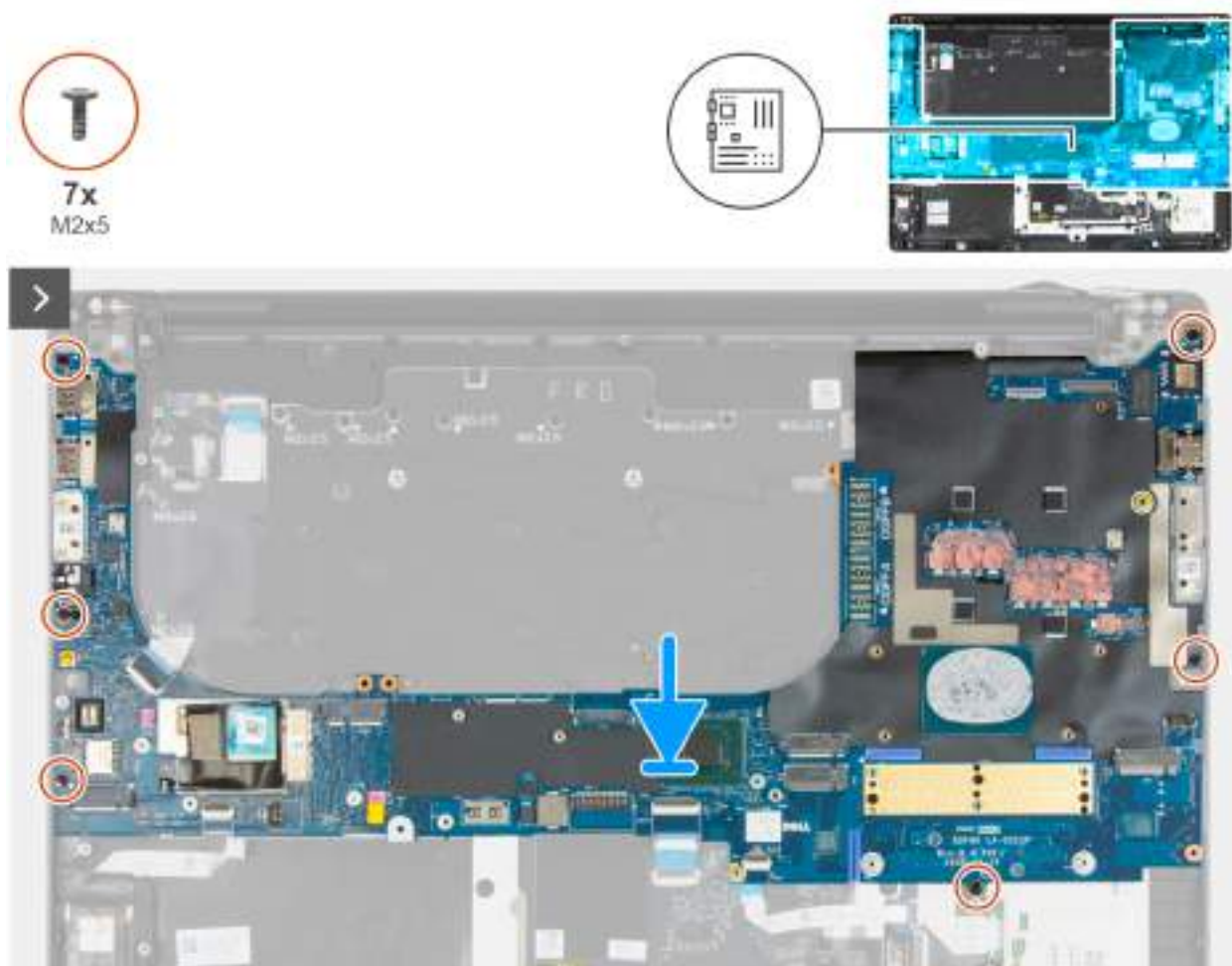
Obrázek 113. Montáž základní desky
