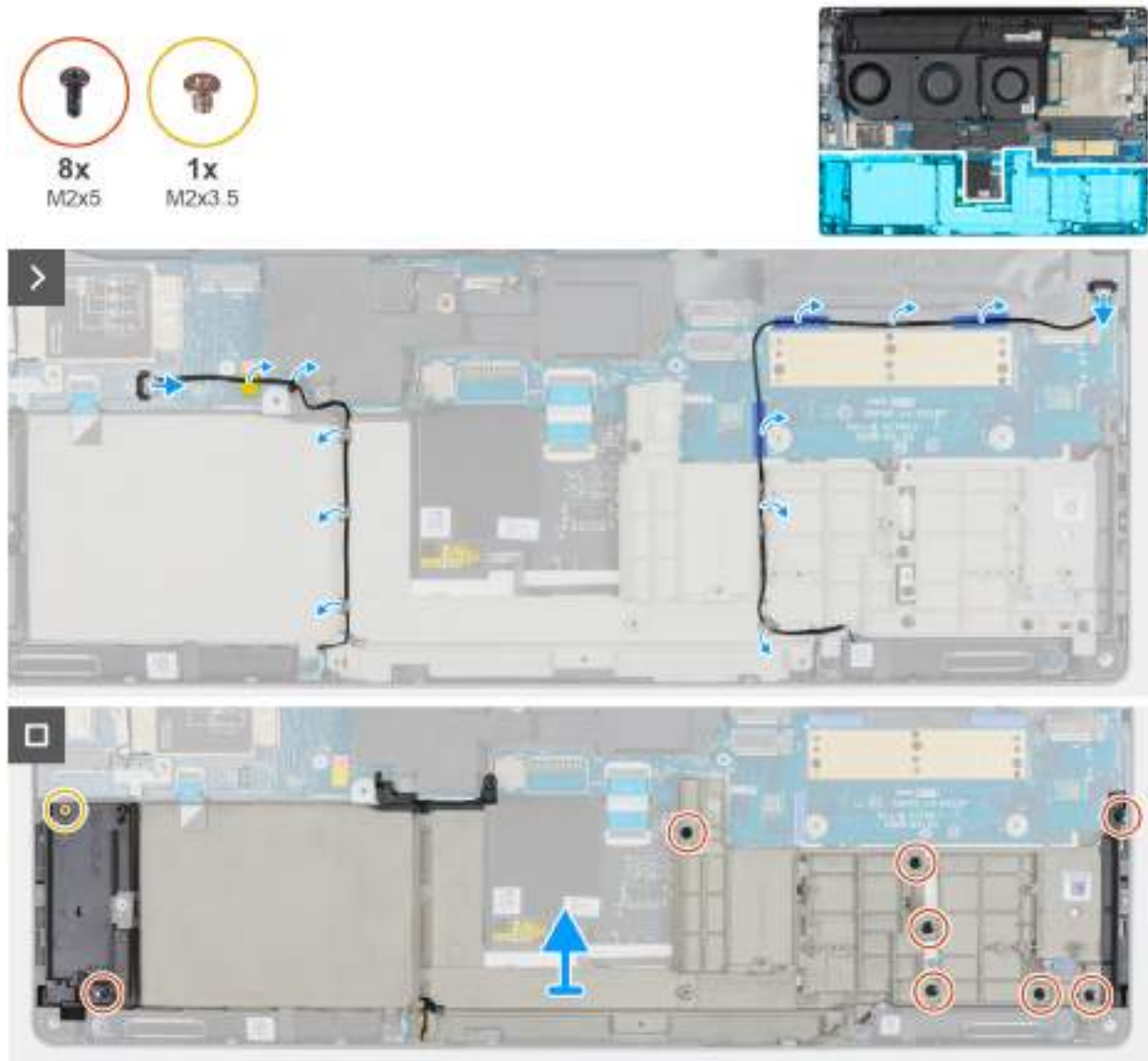
Obrázek 79. Demontáž vnitřního rámu
