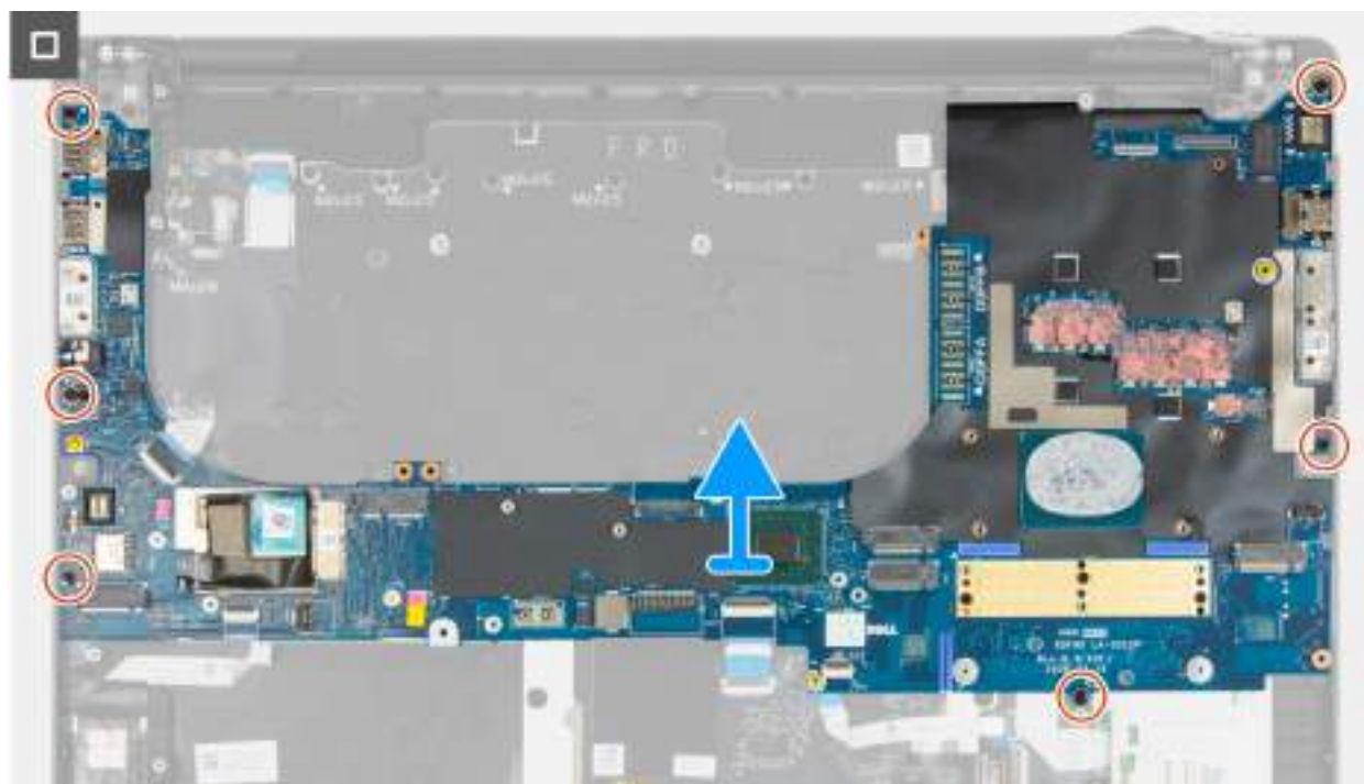
Obrázek 110. Demontáž základní desky
