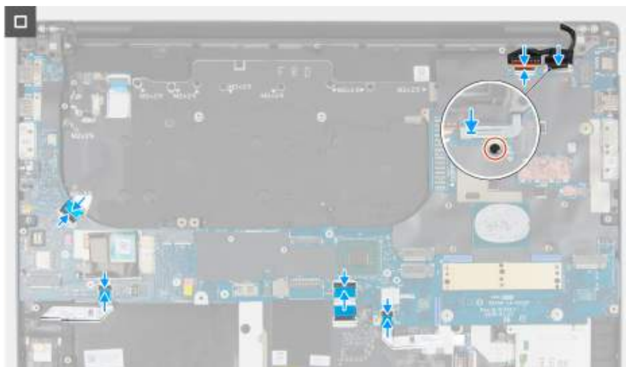
Obrázek 114. Montáž základní desky
