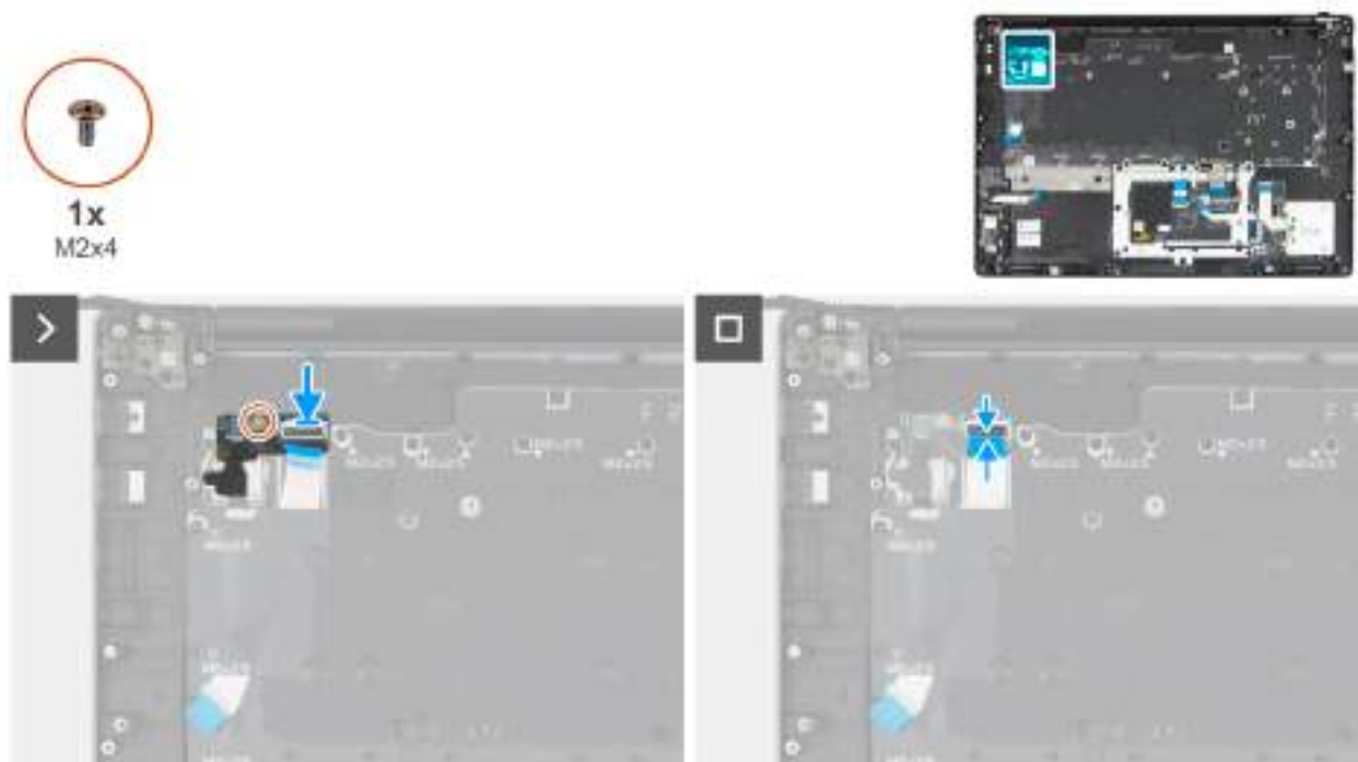
Obrázek 128. Vložení desky vypínače
