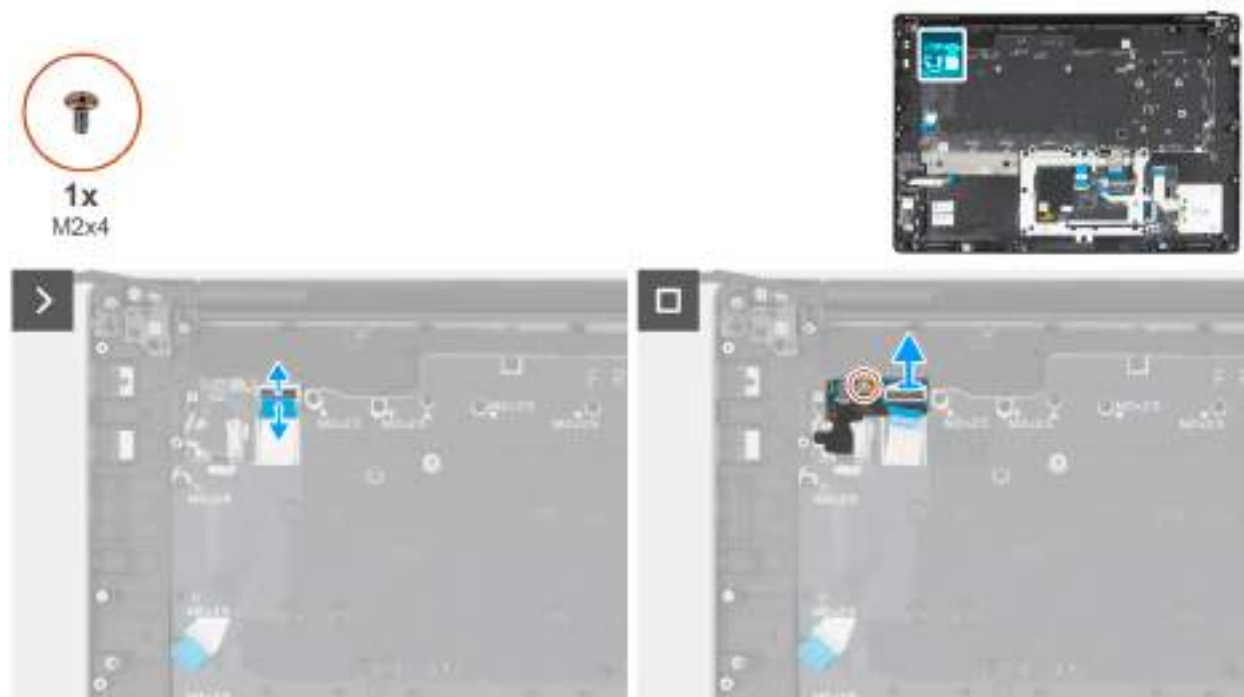
Obrázek 127. Demontáž desky vypínače
