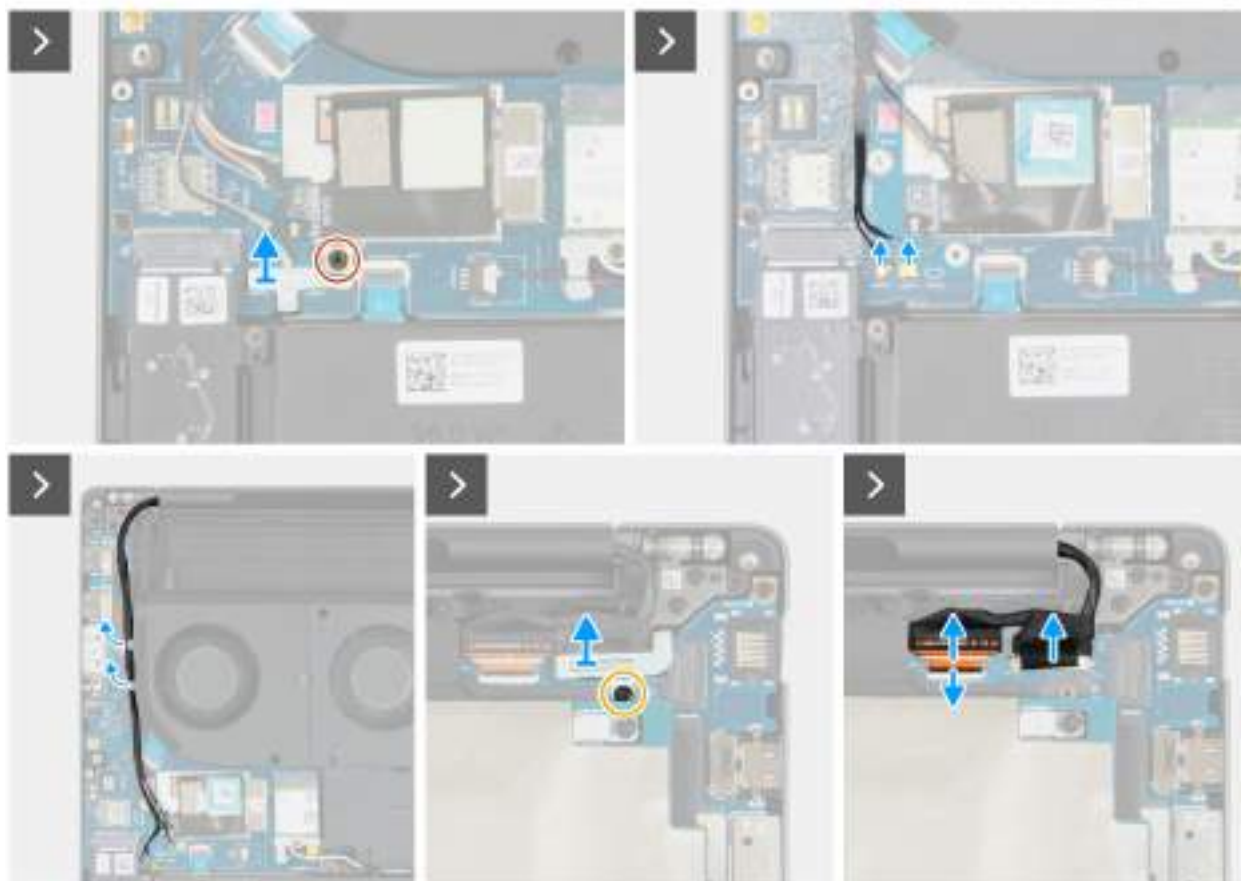
Obrázek 63. Demontáž sestavy displeje
