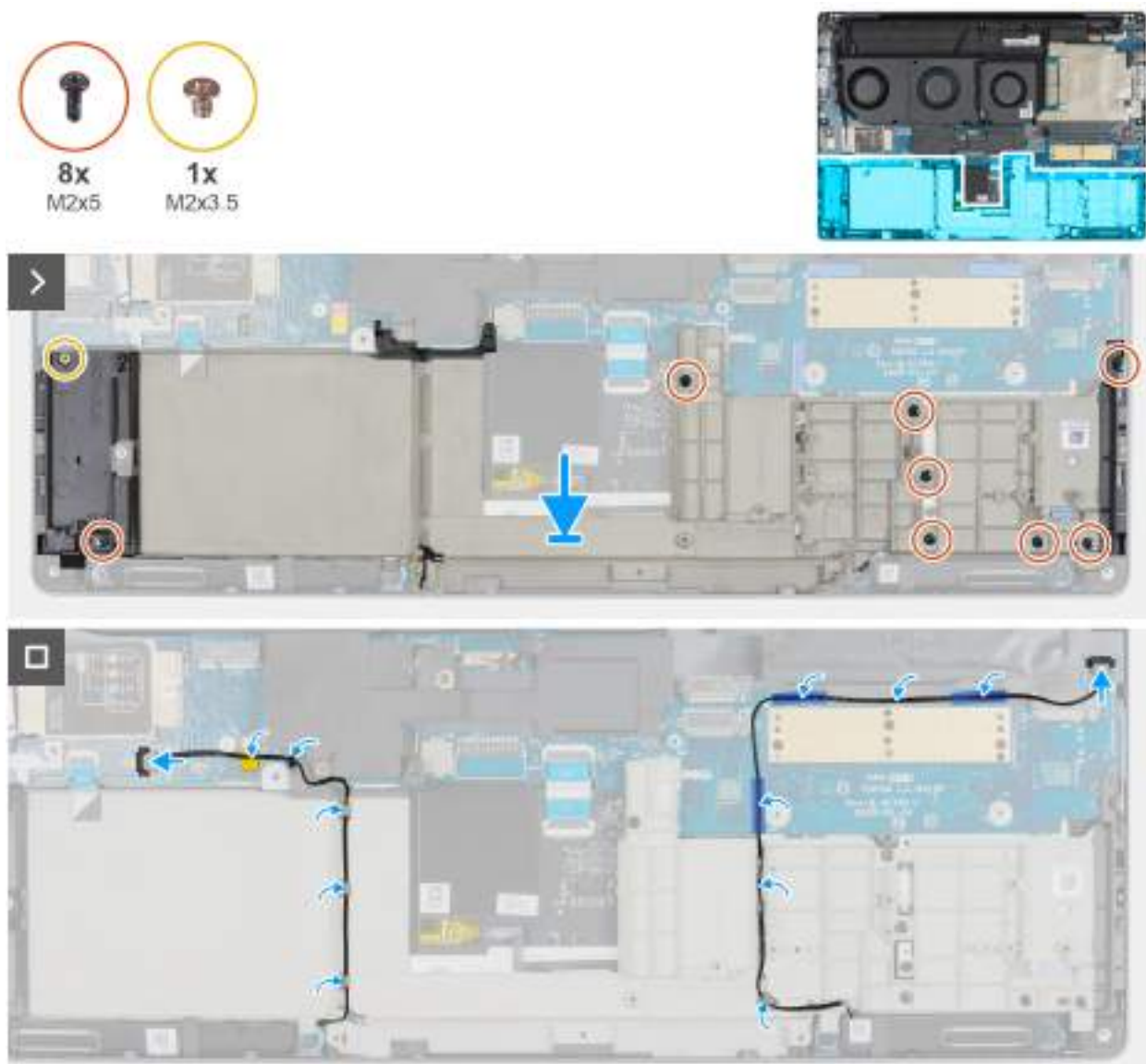
Obrázek 80. Montáž vnitřního rámu
