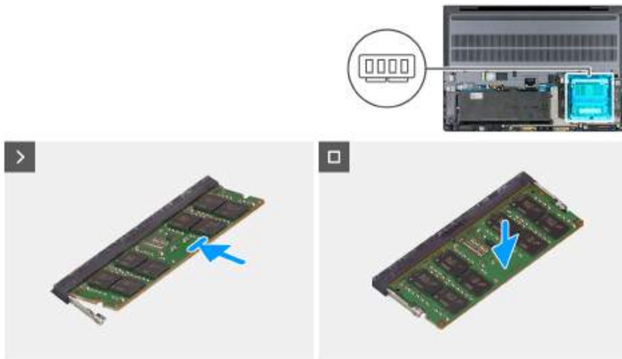
Obrázek 31. Vložení paměťového modulu
