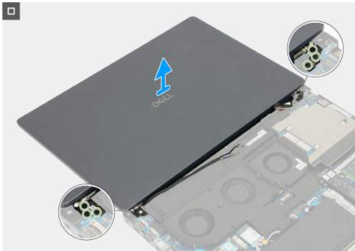
Obrázek 64. Demontáž sestavy displeje
