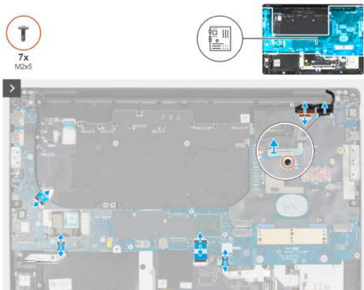
Obrázek 109. Demontáž základní desky
