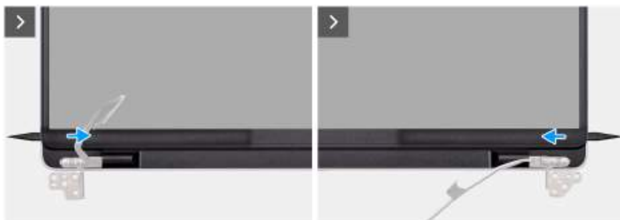
Obrázek 53. Demontáž čelního krytu displeje
