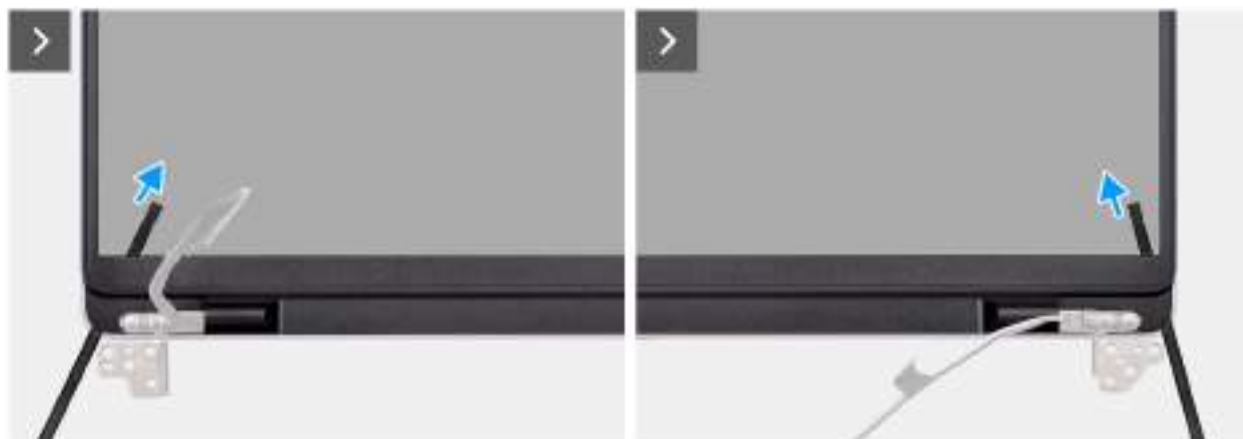
Obrázek 50. Demontáž čelního krytu displeje
