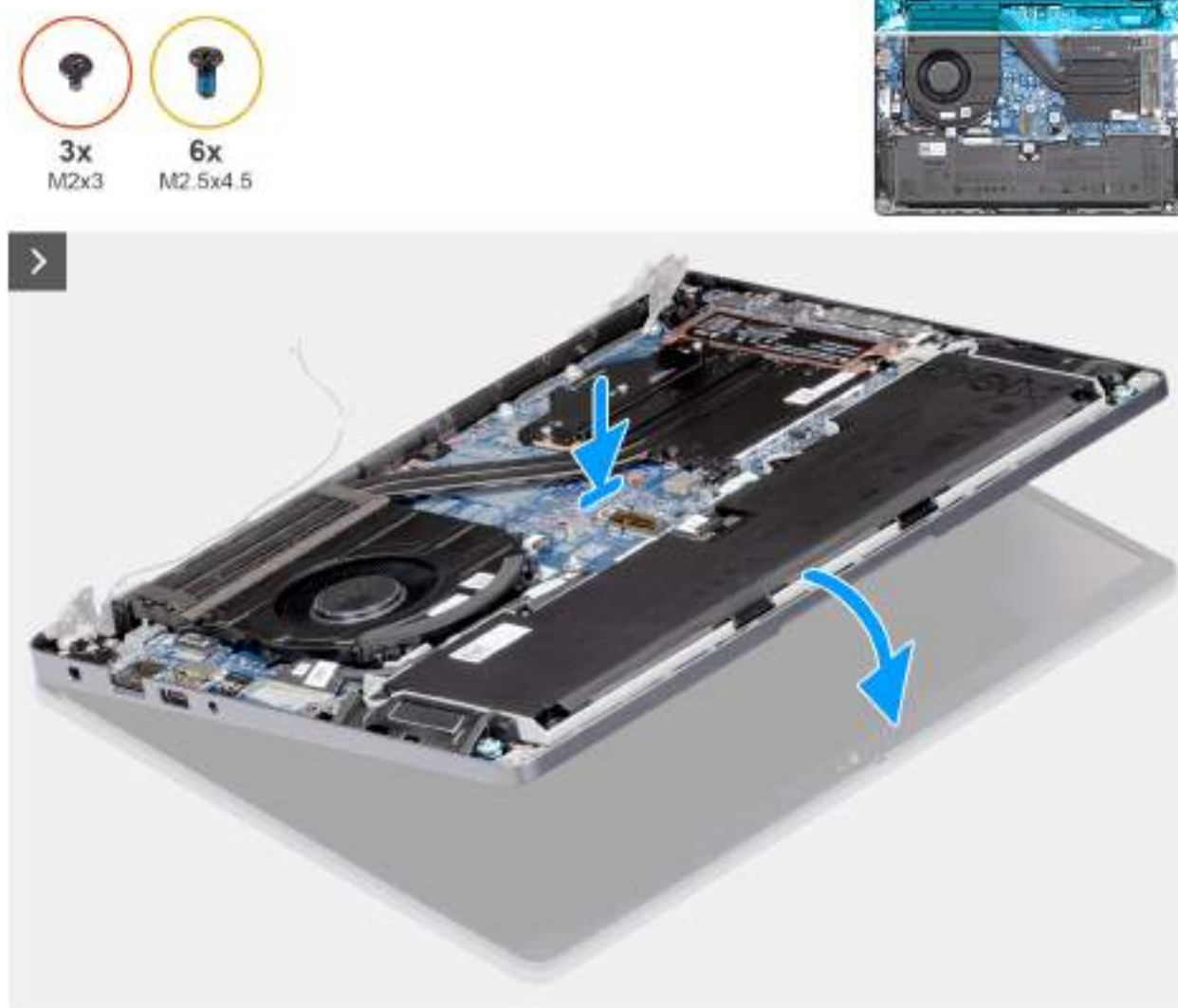
Obrázek 47. Montáž sestavy displeje
