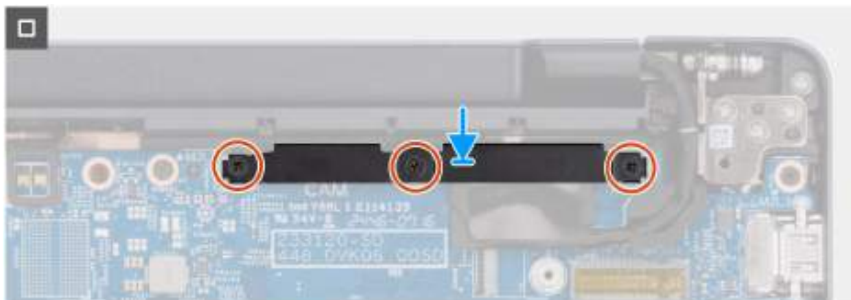
Obrázek 82. Montáž základní desky
