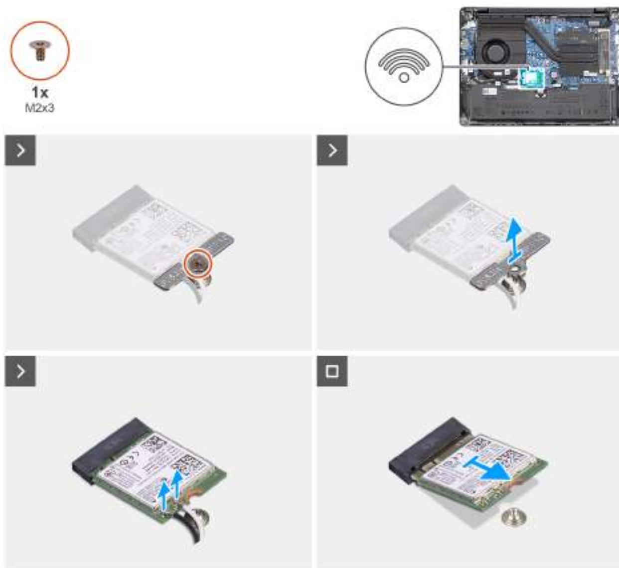
Obrázek 24. Demontáž bezdrátové karty
