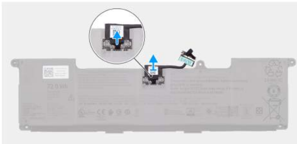
Obrázek 31. Odpojení kabelu baterie
