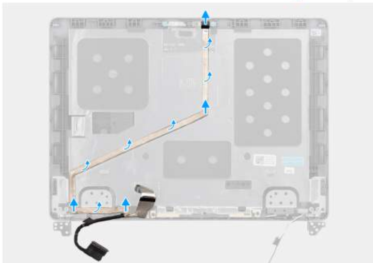
Obrázek 65. Vyjmutí kabelu displeje
