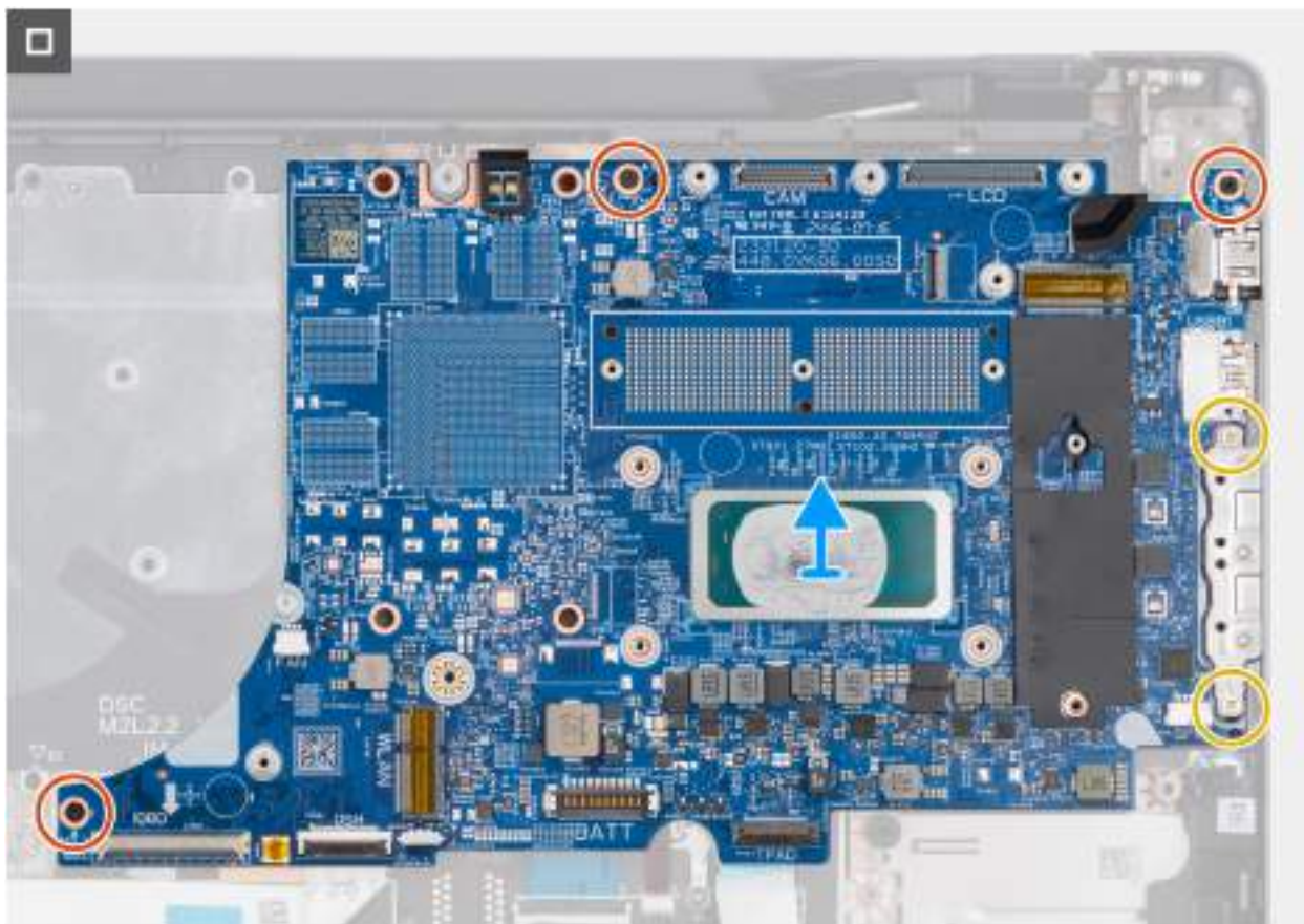
Obrázek 76. Demontáž základní desky
