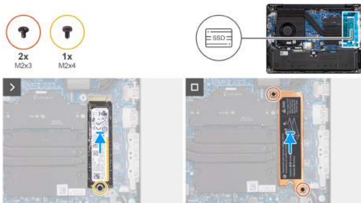
Obrázek 23. Instalace disku SSD M.2 2280
