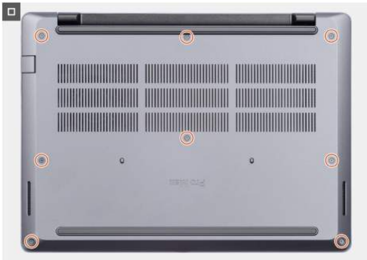
Obrázek 15. Nasazení spodního krytu
