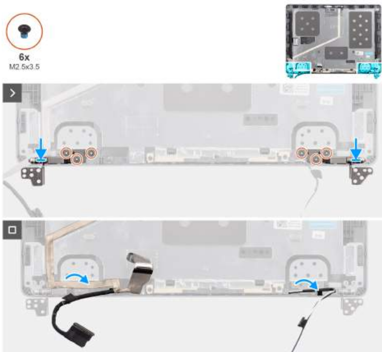
Obrázek 64. Montáž pantů displeje
