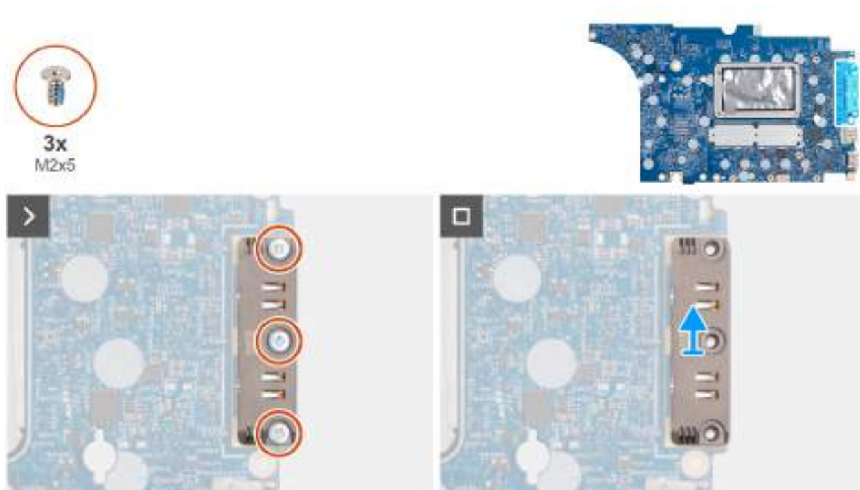
Obrázek 83. Demontáž modulu USB Type-C
