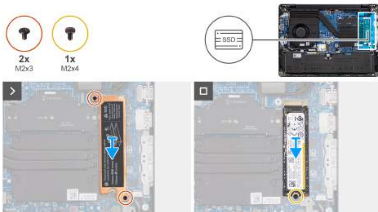
Obrázek 22. Demontáž disku SSD M.2 2280
