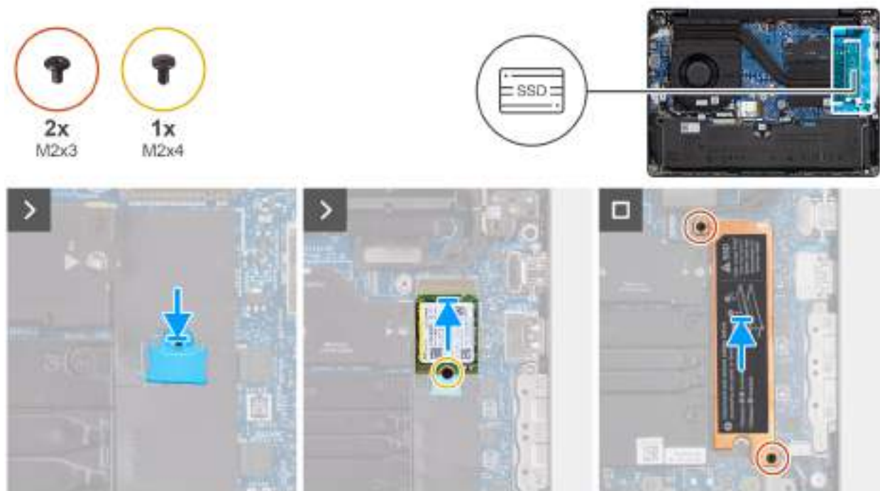
Obrázek 21. Instalace disku SSD M.2 2230
