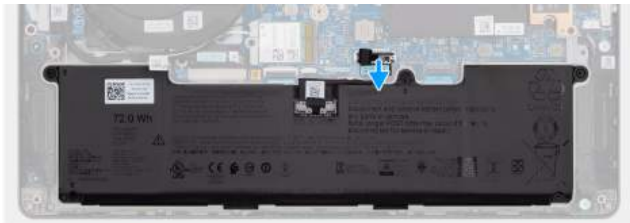
Obrázek 13. Demontáž kabelu baterie
