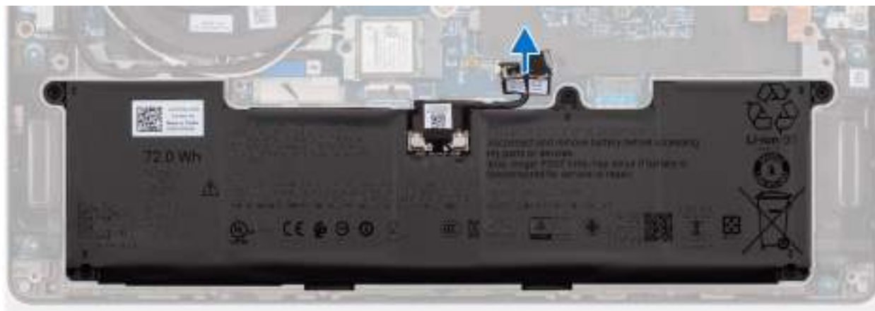
Obrázek 13. Demontáž kabelu baterie
