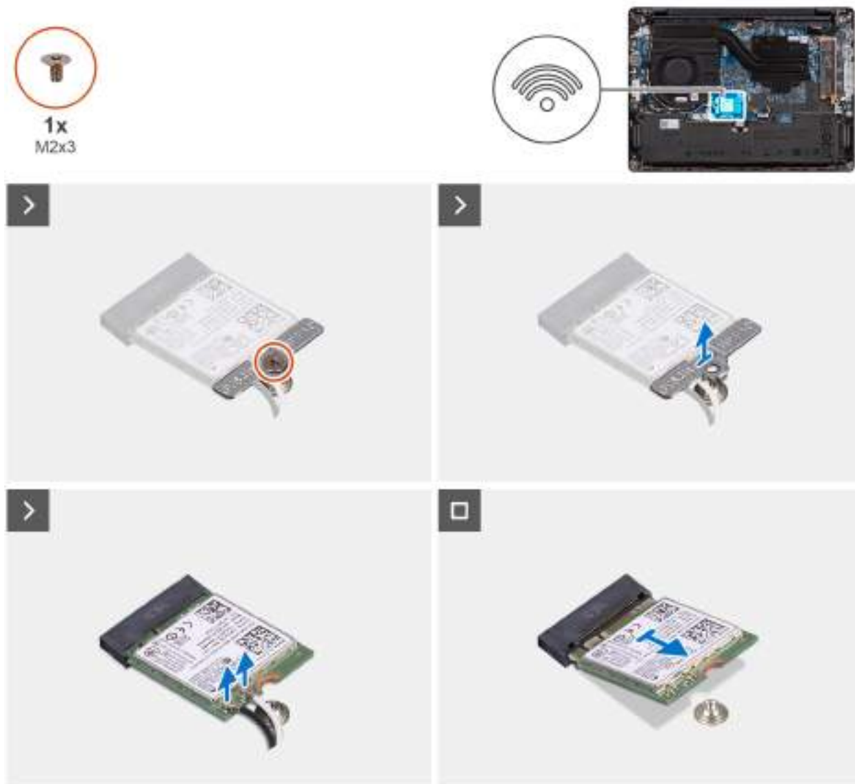
Obrázek 24. Demontáž bezdrátové karty
