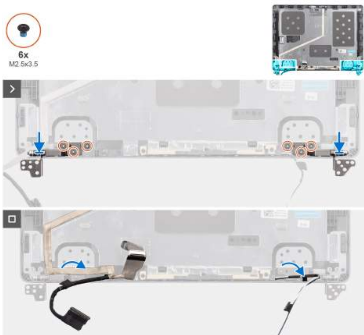
Obrázek 63. Montáž pantů displeje
