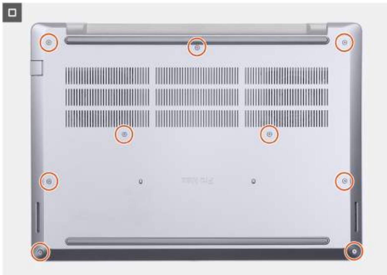
Obrázek 16. Nasazení spodního krytu
