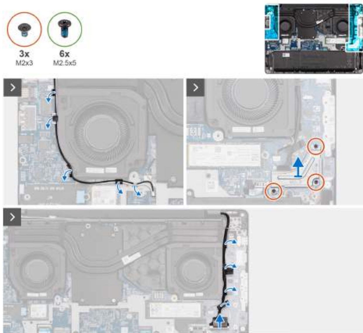
Obrázek 44. Demontáž sestavy displeje
