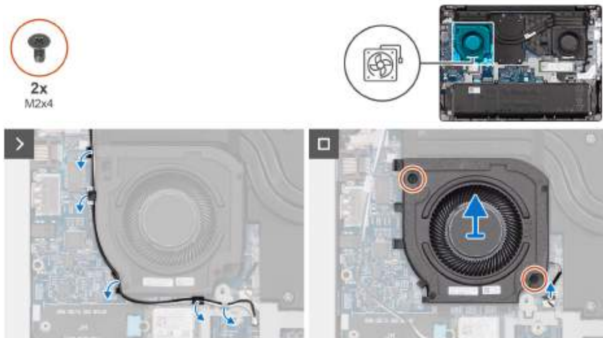
Obrázek 30. Demontáž pravého ventilátoru / ventilátoru procesoru
