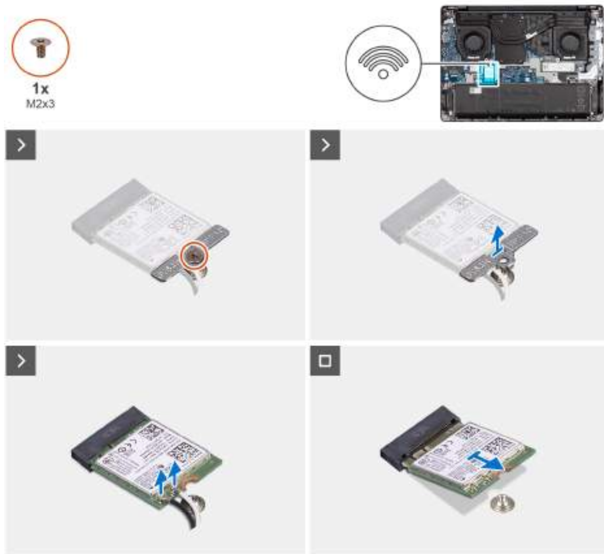
Obrázek 25. Demontáž bezdrátové karty
