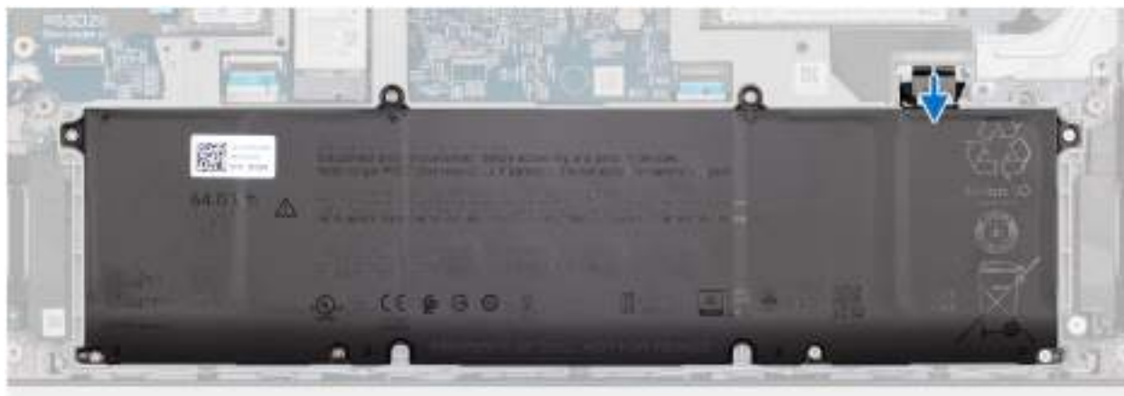
Obrázek 14. Demontáž kabelu baterie
