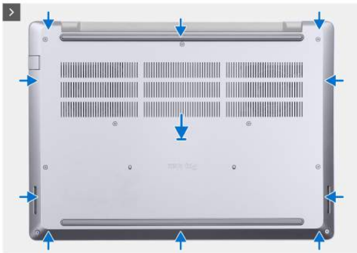
Obrázek 15. Nasazení spodního krytu
