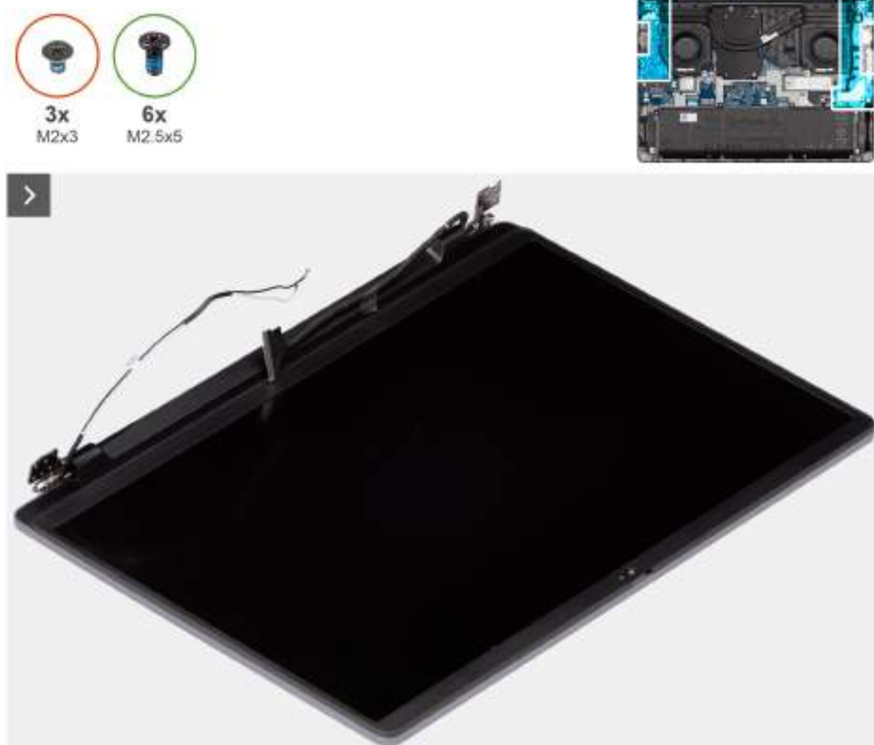
Obrázek 47. Montáž sestavy displeje
