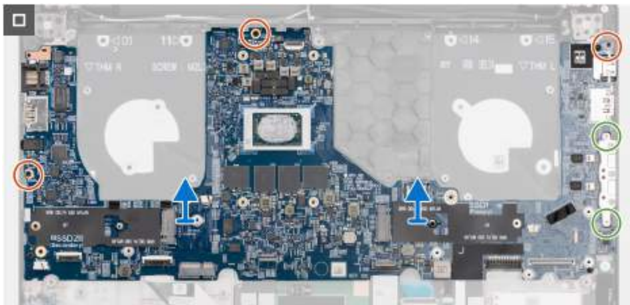
Obrázek 75. Demontáž základní desky
