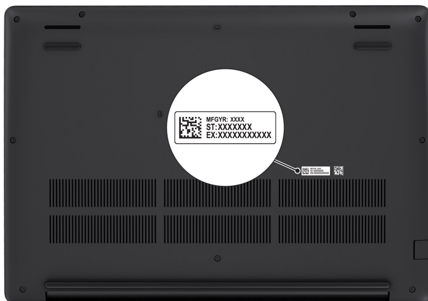
Obrázek 6. Umístění výrobního čísla / kódu Express Service Code
