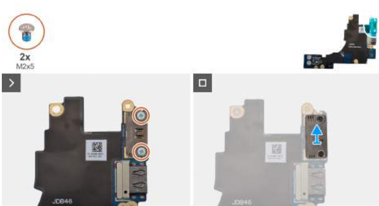
Obrázek 50. Demontáž levého modulu USB Type-C
