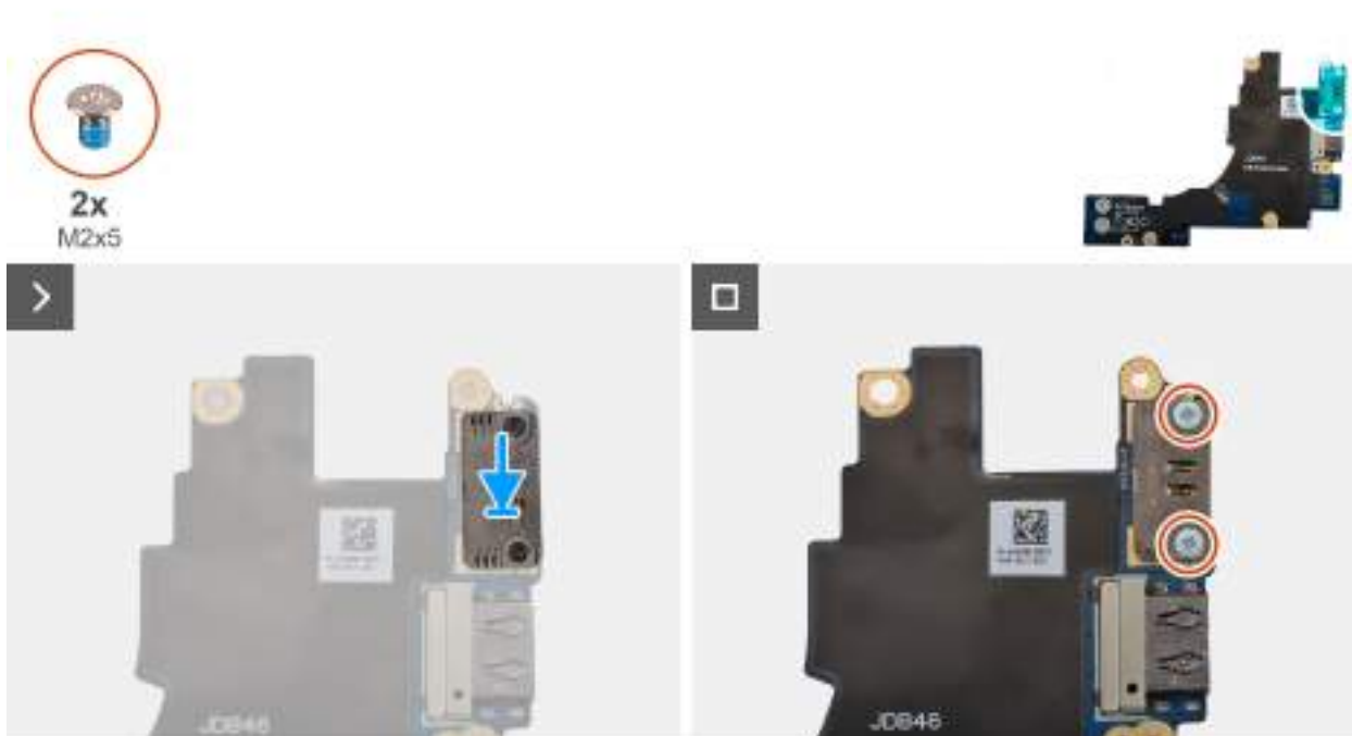
Obrázek 51. Montáž levého modulu USB Type-C
