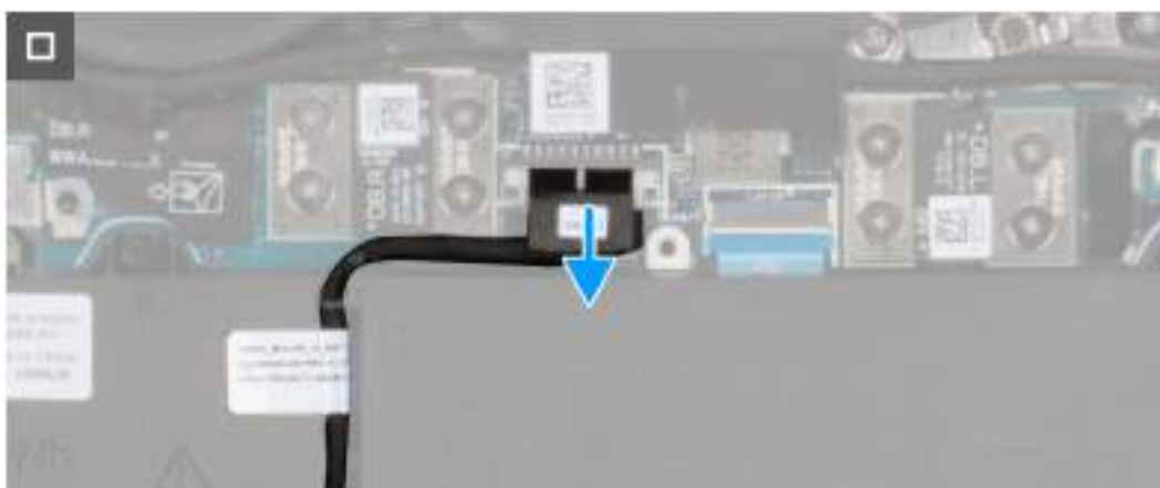
Obrázek 16. Odpojte kabel baterie od základní desky.
