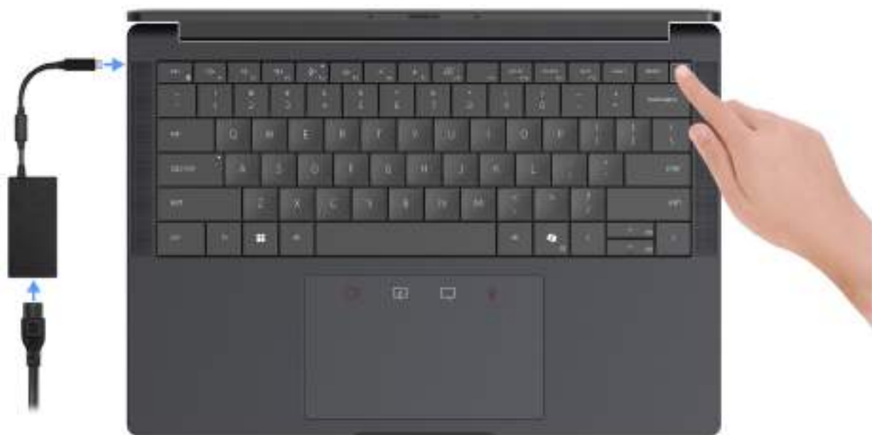
Obrázek 8. Připojte napájecí adaptér a stiskněte vypínač.
