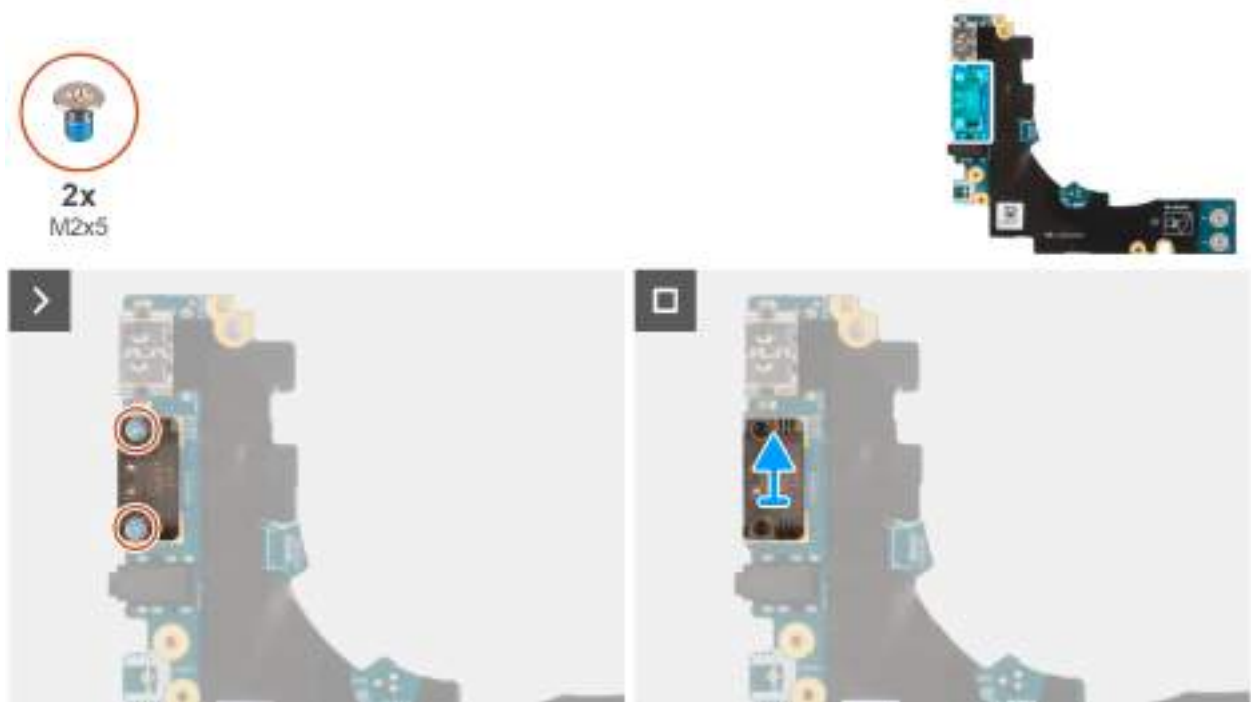
Obrázek 52. Demontáž pravého modulu USB Type-C
