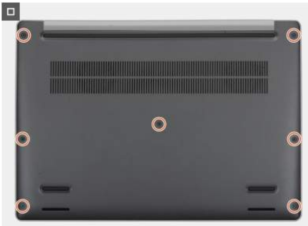
Obrázek 19. Utažení jisticích šroubků
