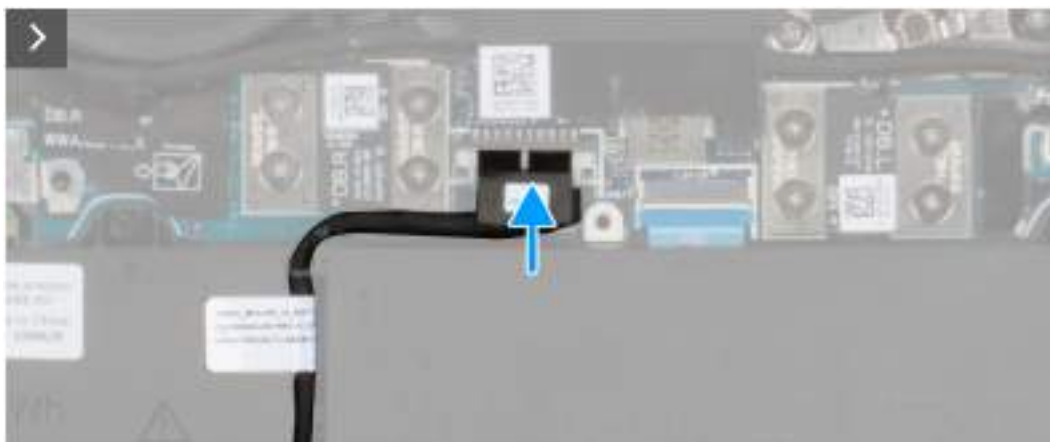
Obrázek 17. Připojení kabelu baterie k základní desce
