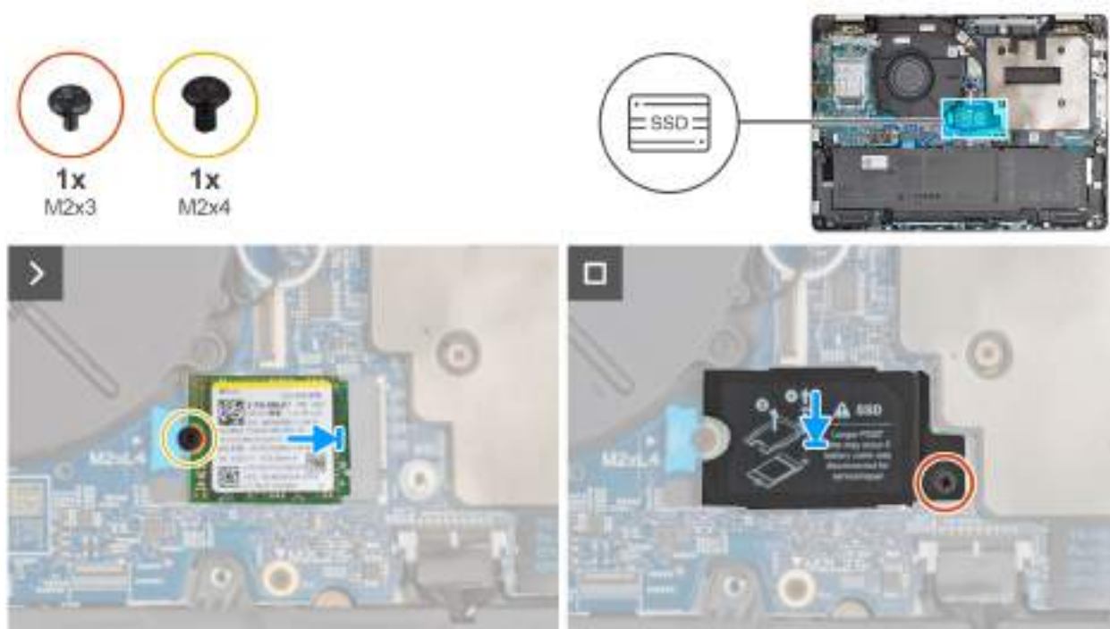
Obrázek 28. Montáž disku SSD M.2 2230
