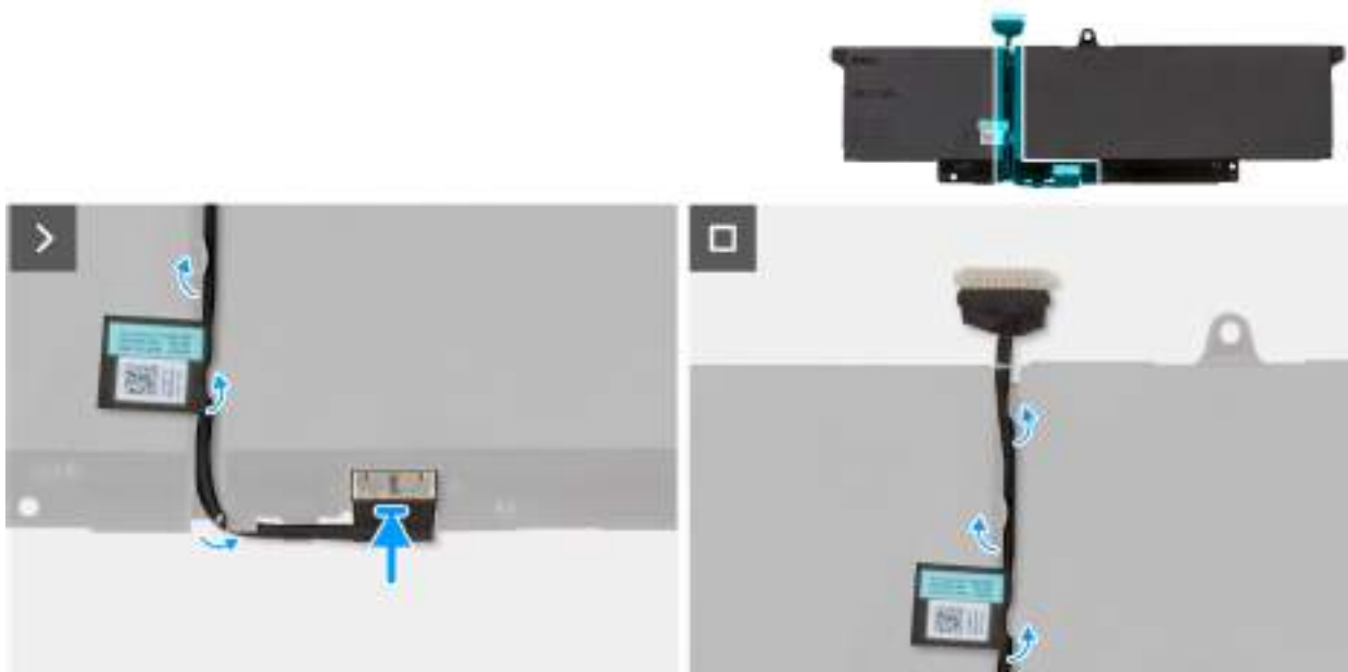
Obrázek 24. Montáž kabelu baterie
