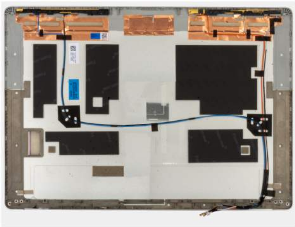
Obrázek 75. Montáž zadního krytu displeje
