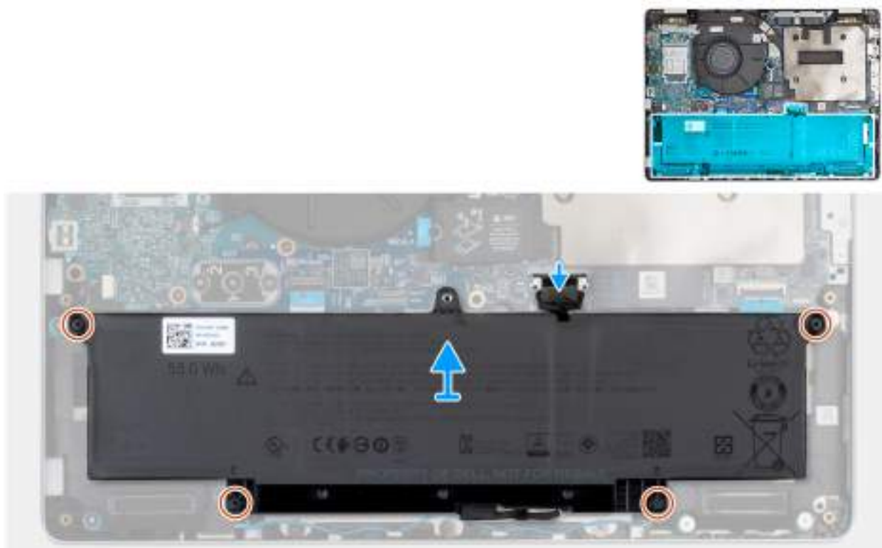
Obrázek 18. Připojení kabelu baterie
