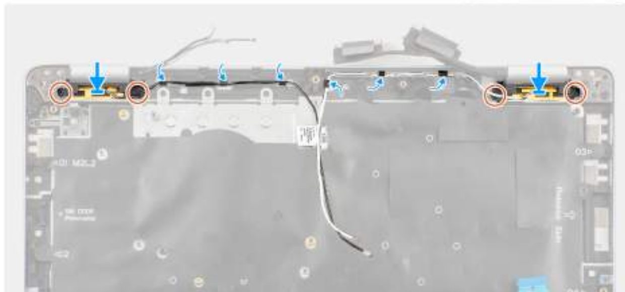
Obrázek 44. Montáž anténního modulu WLAN
