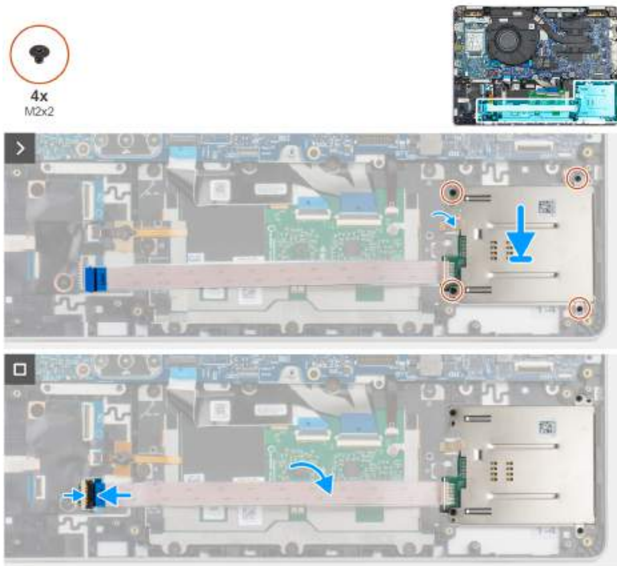
Obrázek 38. Montáž čtečky čipových karet
