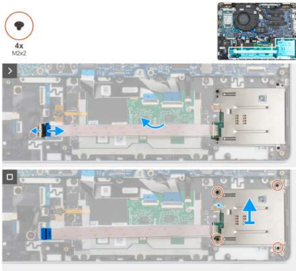
Obrázek 37. Demontáž čtečky čipových karet
