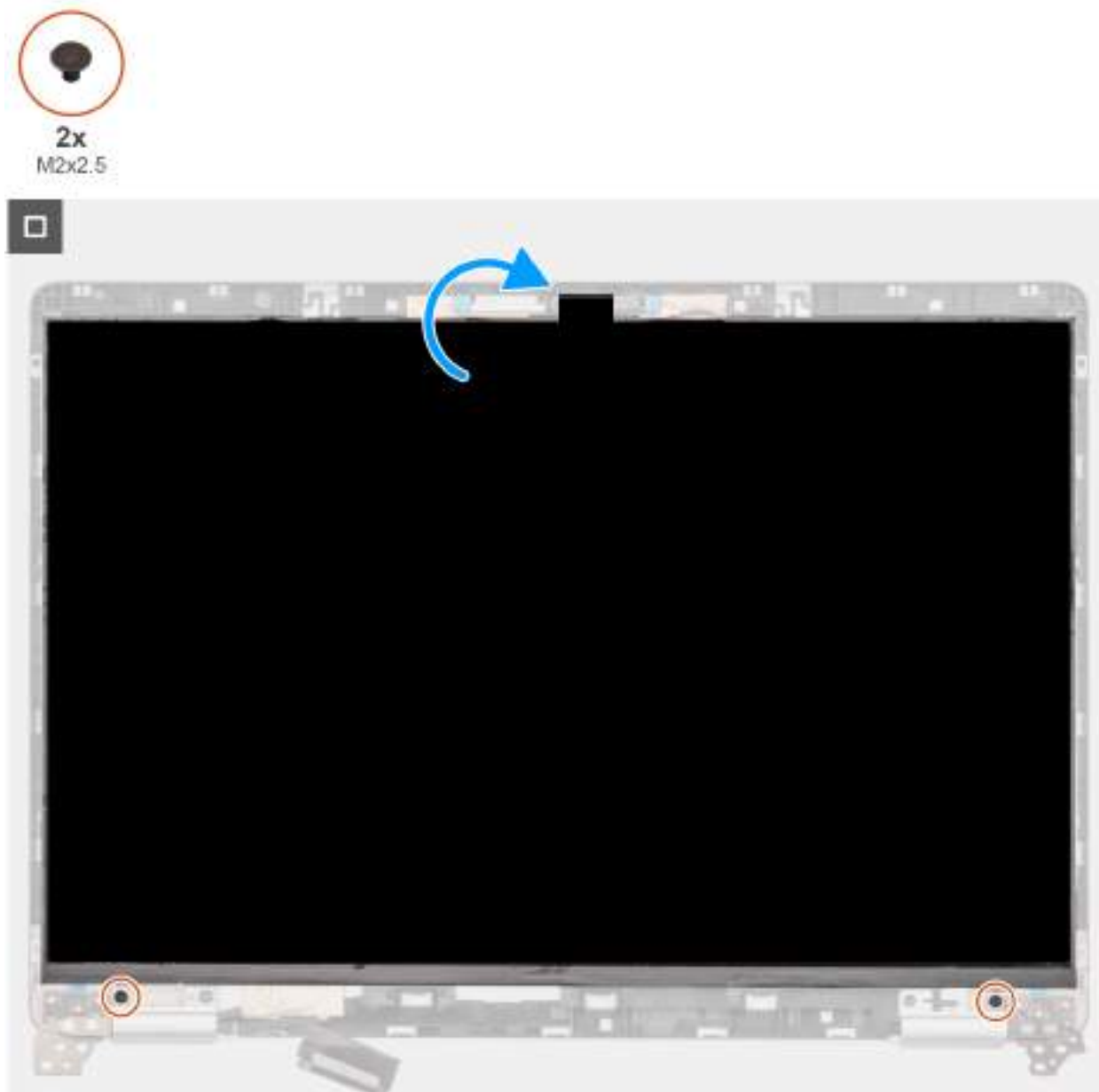
Obrázek 67. Montáž obrazovky displeje
