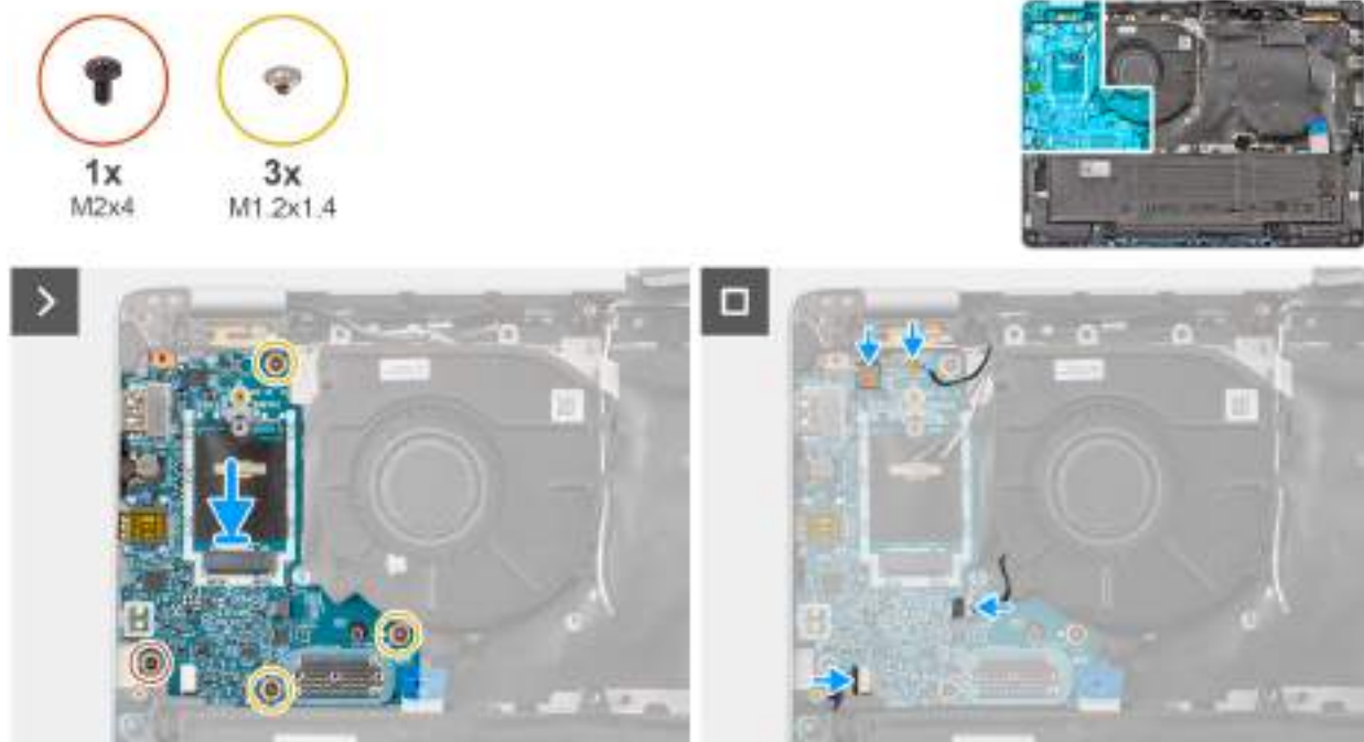
Obrázek 48. Vložení desky I/O
