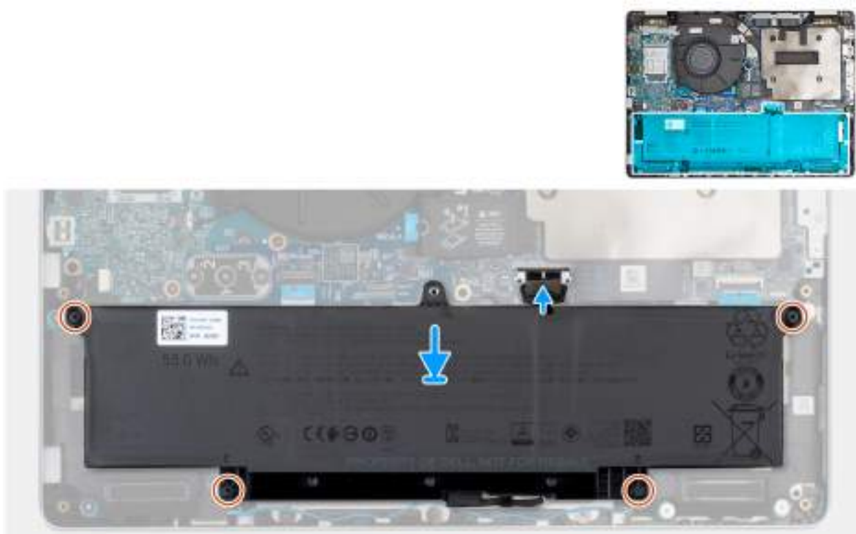
Obrázek 17. Odpojení kabelu baterie
