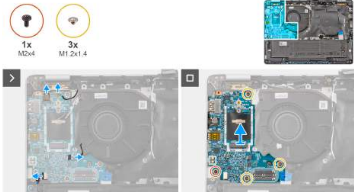
Obrázek 47. Demontáž desky I/O
