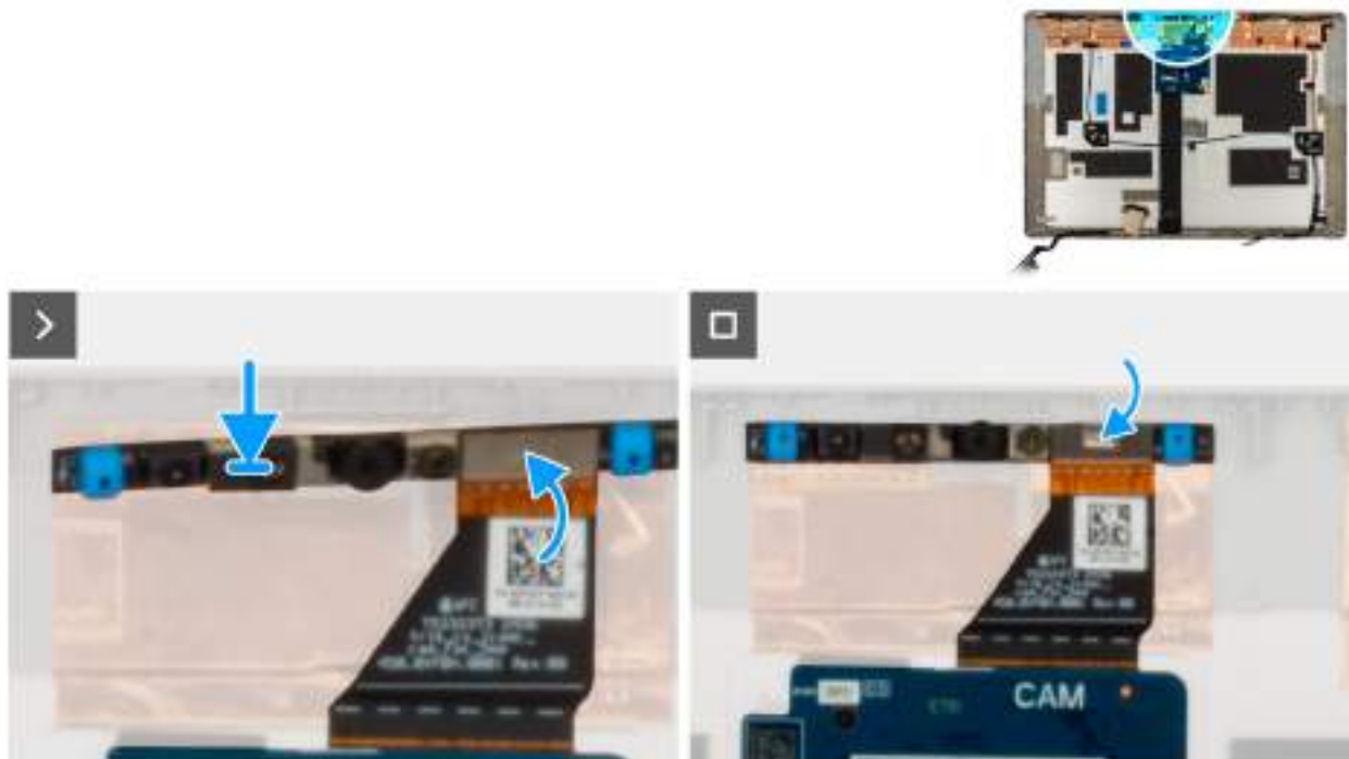
Obrázek 71. Montáž modulu kamery
