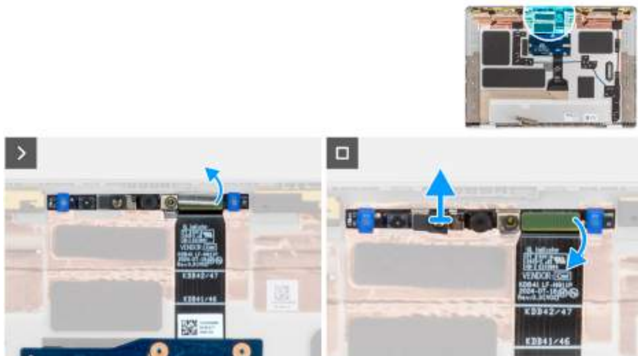
Obrázek 56. Vyjmutí kamery MIPI
