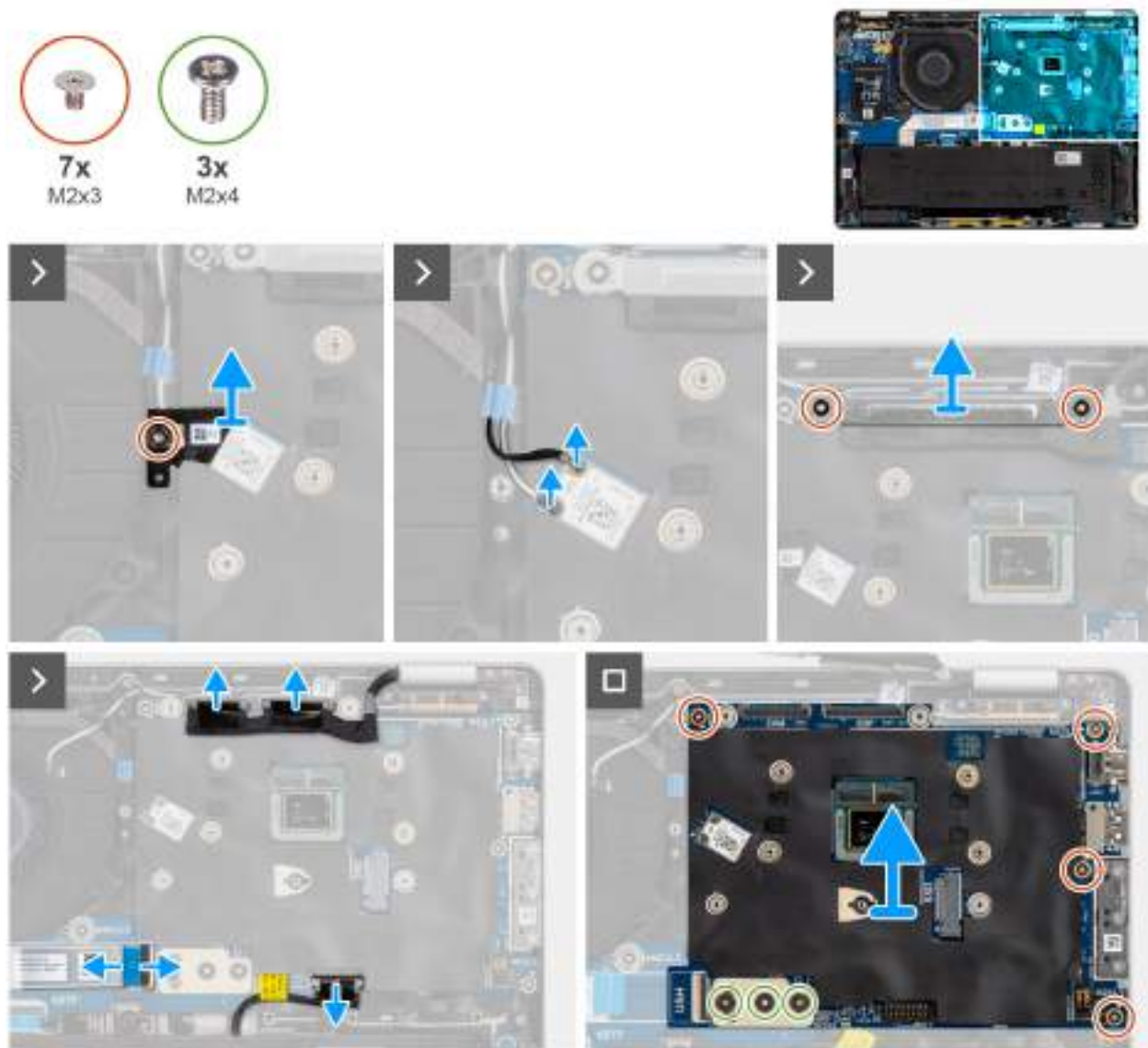
Obrázek 70. Demontáž základní desky
