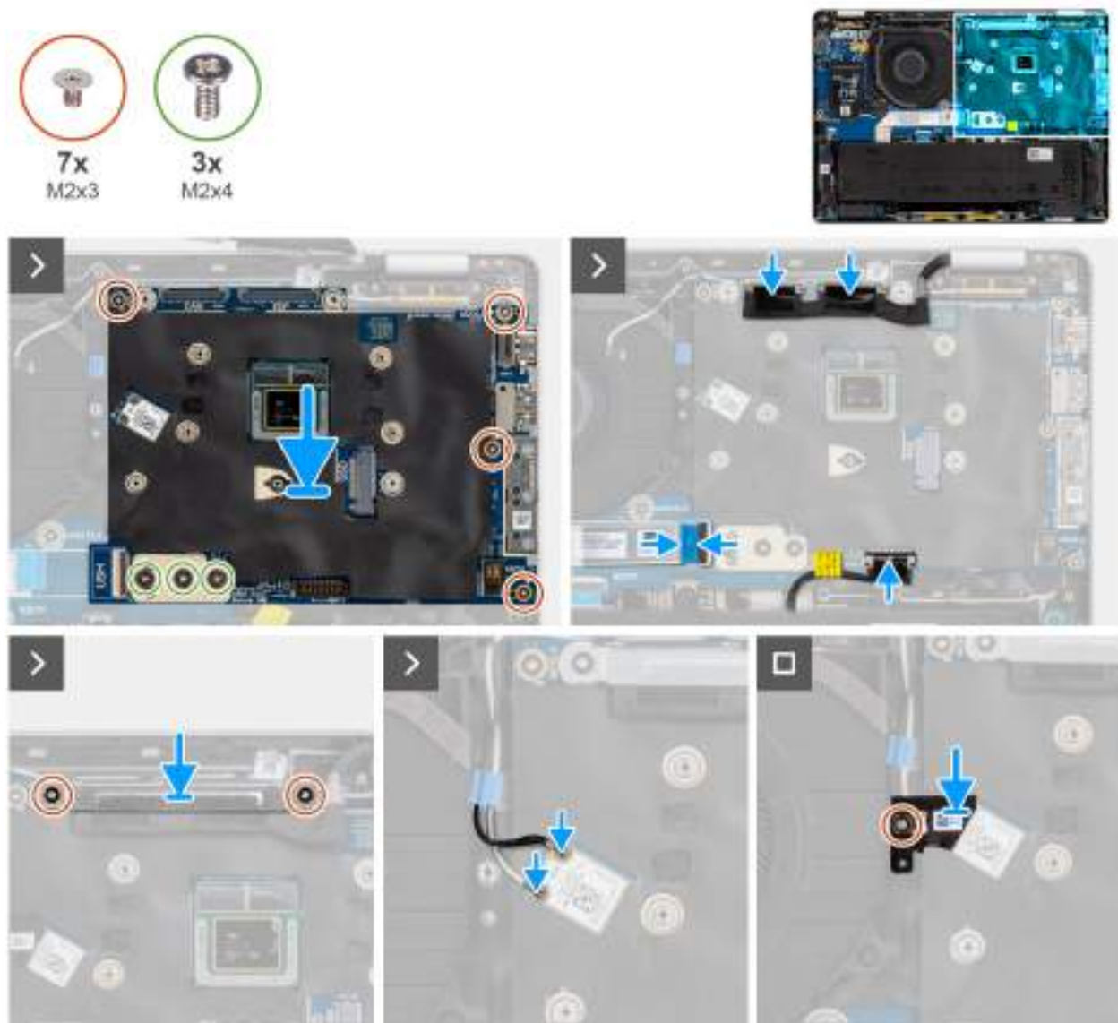
Obrázek 72. Montáž základní desky
