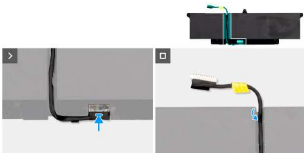
Obrázek 26. Výměna kabelu baterie
