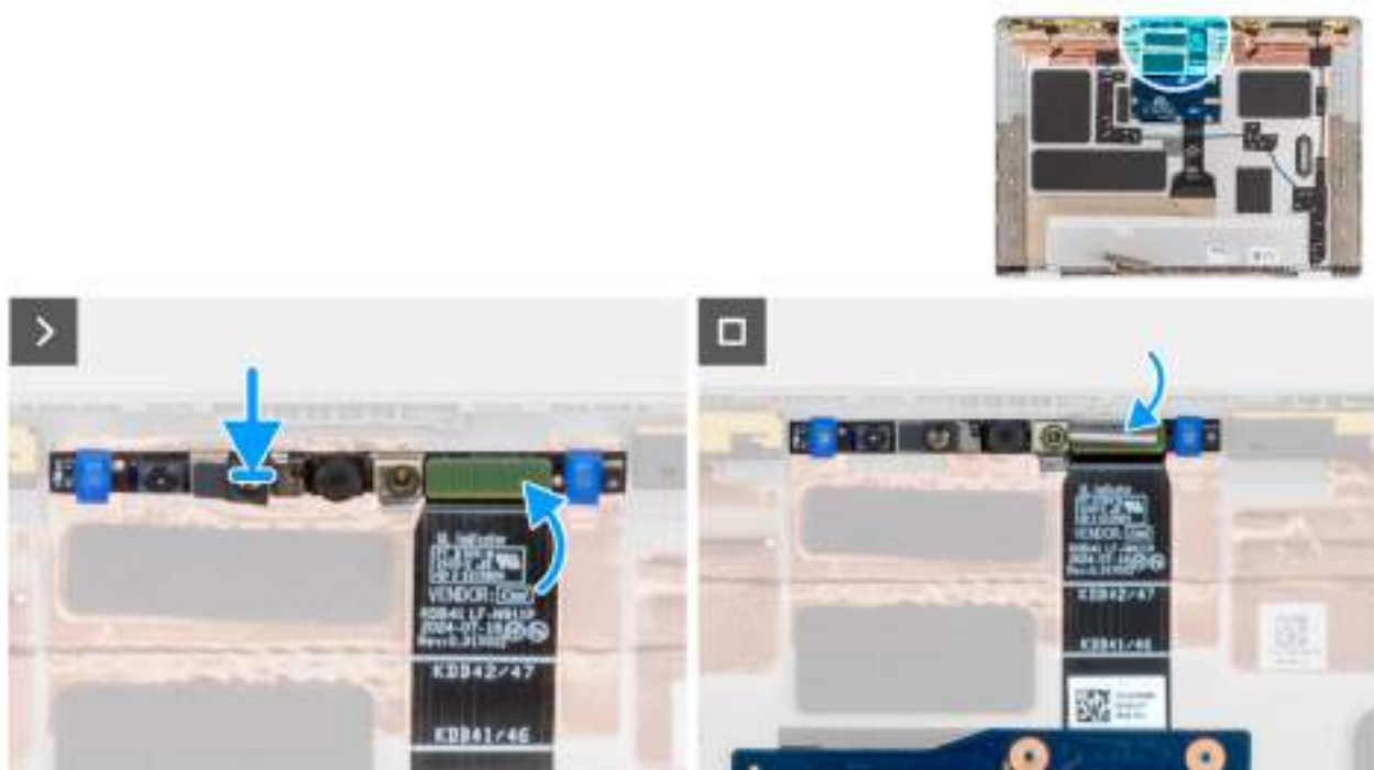
Obrázek 59. Montáž kamery MIPI
