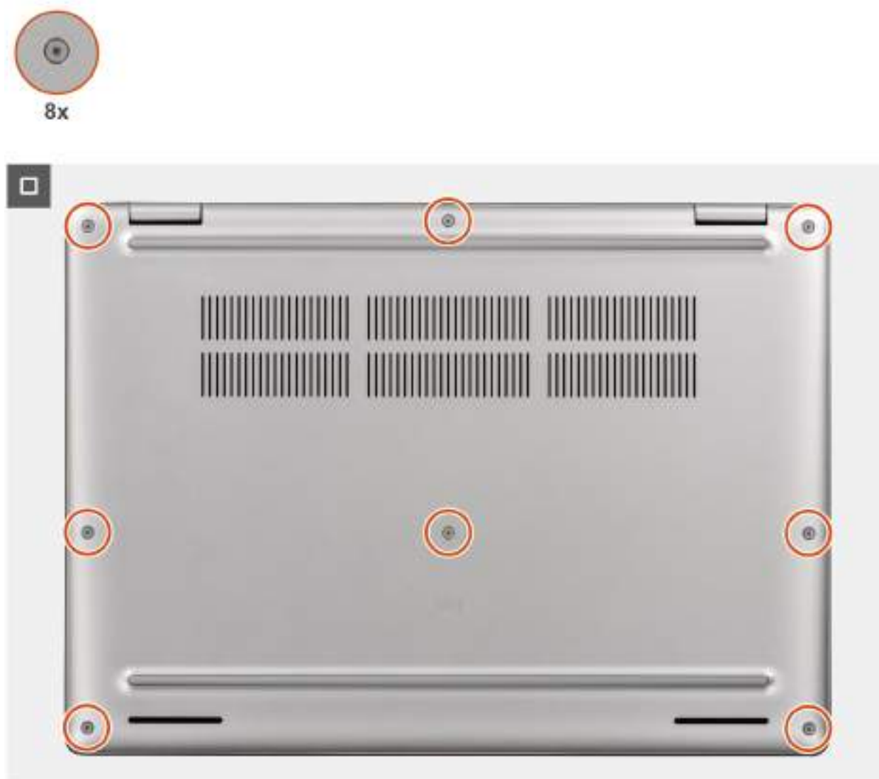
Obrázek 23. Nasazení spodního krytu
