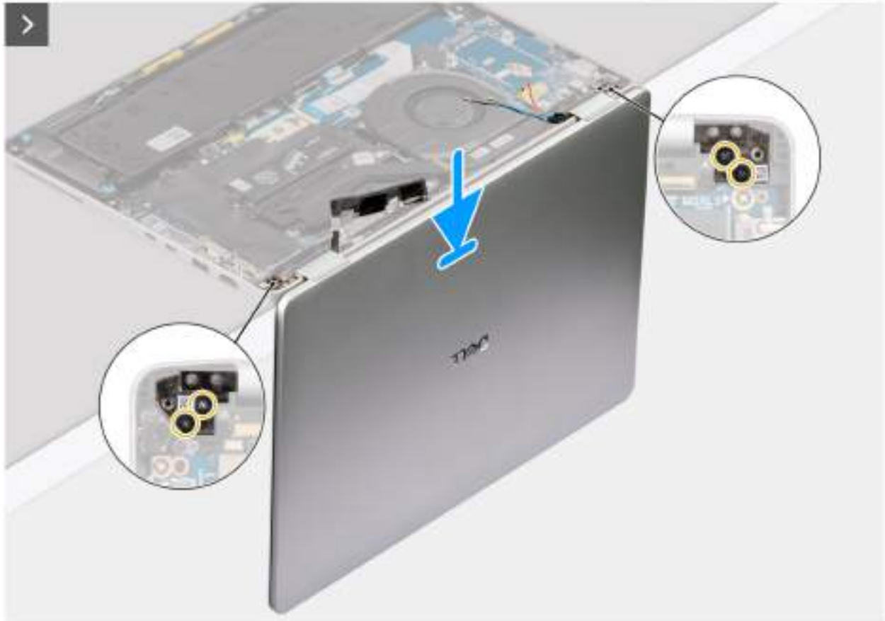
Obrázek 41. Zarovnání sestavy displeje s otvory pro šrouby na sestavě opěrky rukou(2 v 1)
