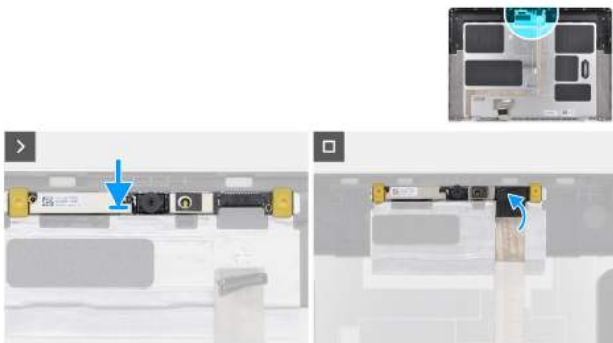
Obrázek 82. Montáž kamery RGB
