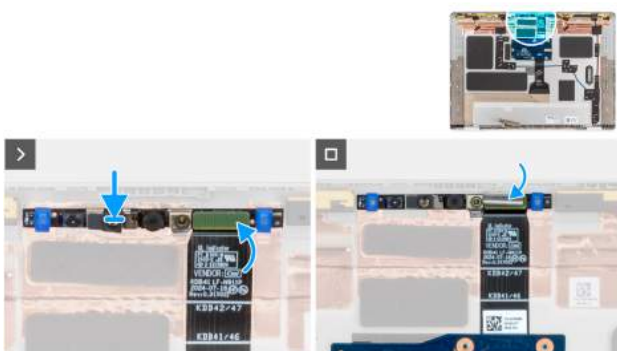
Obrázek 84. Montáž kamery MIPI
