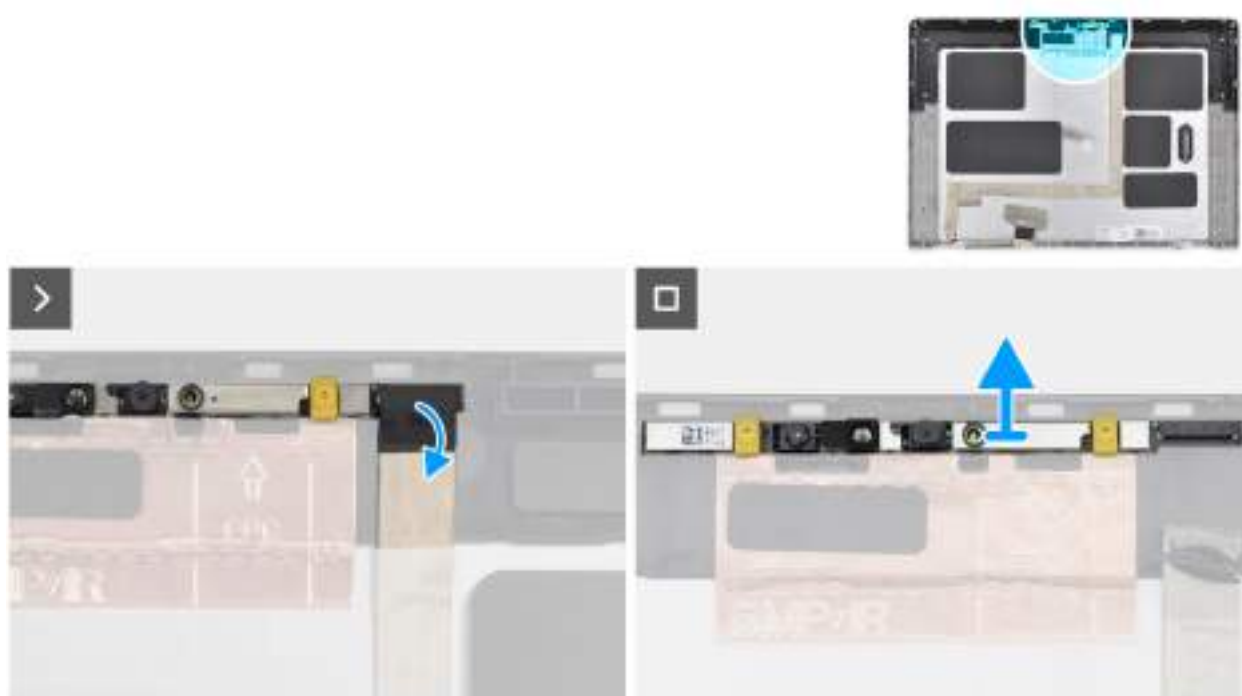
Obrázek 79. Vyjmutí kamery IR
