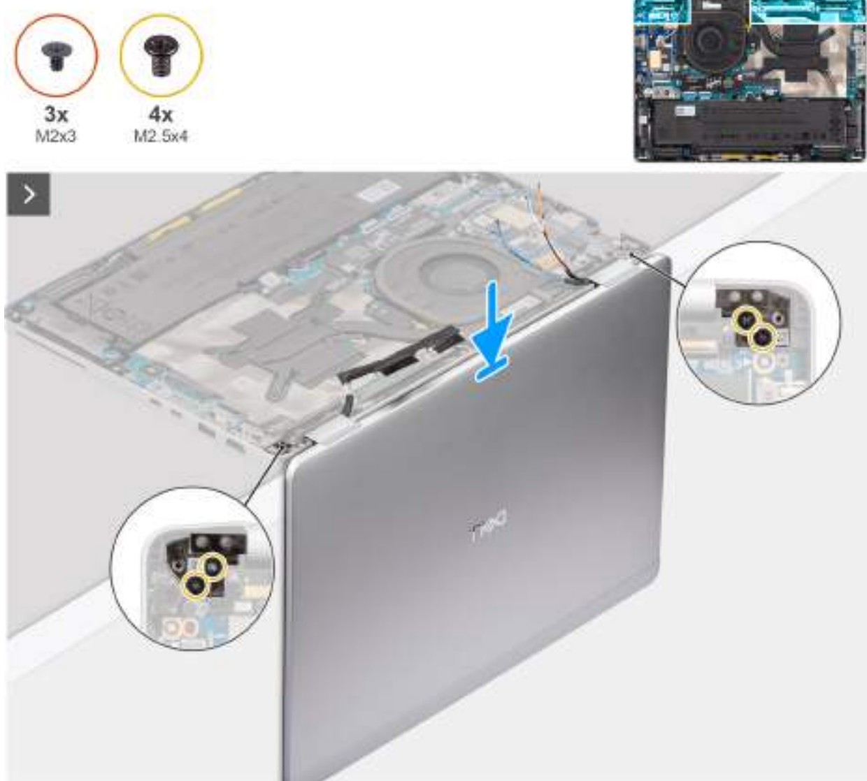
Obrázek 63. Zarovnání sestavy displeje s otvory pro šrouby na sestavě opěrky rukou
