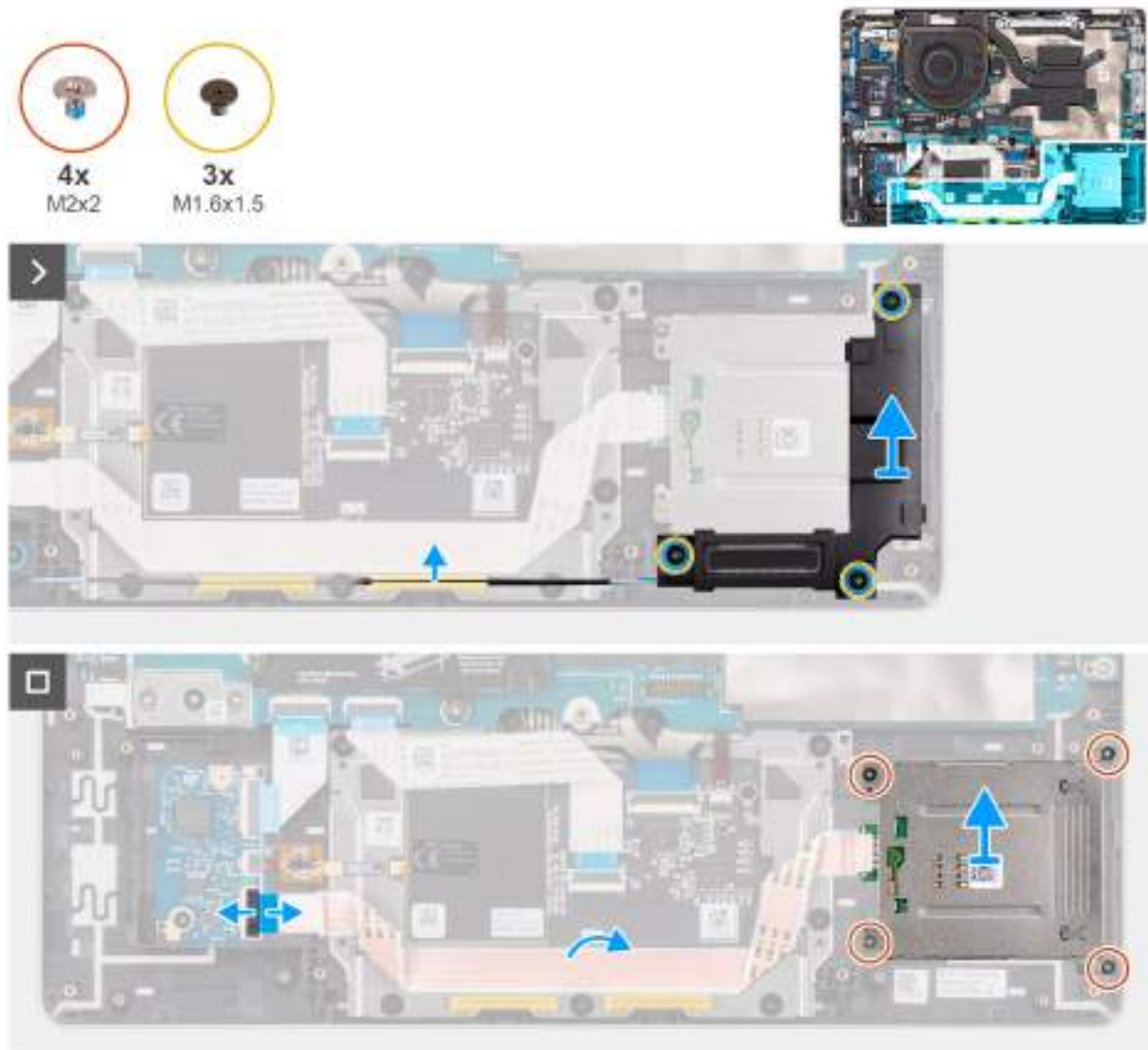
Obrázek 44. Demontáž čtečky čipových karet
