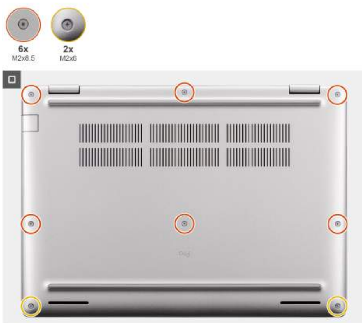
Obrázek 22. Nasazení spodního krytu
