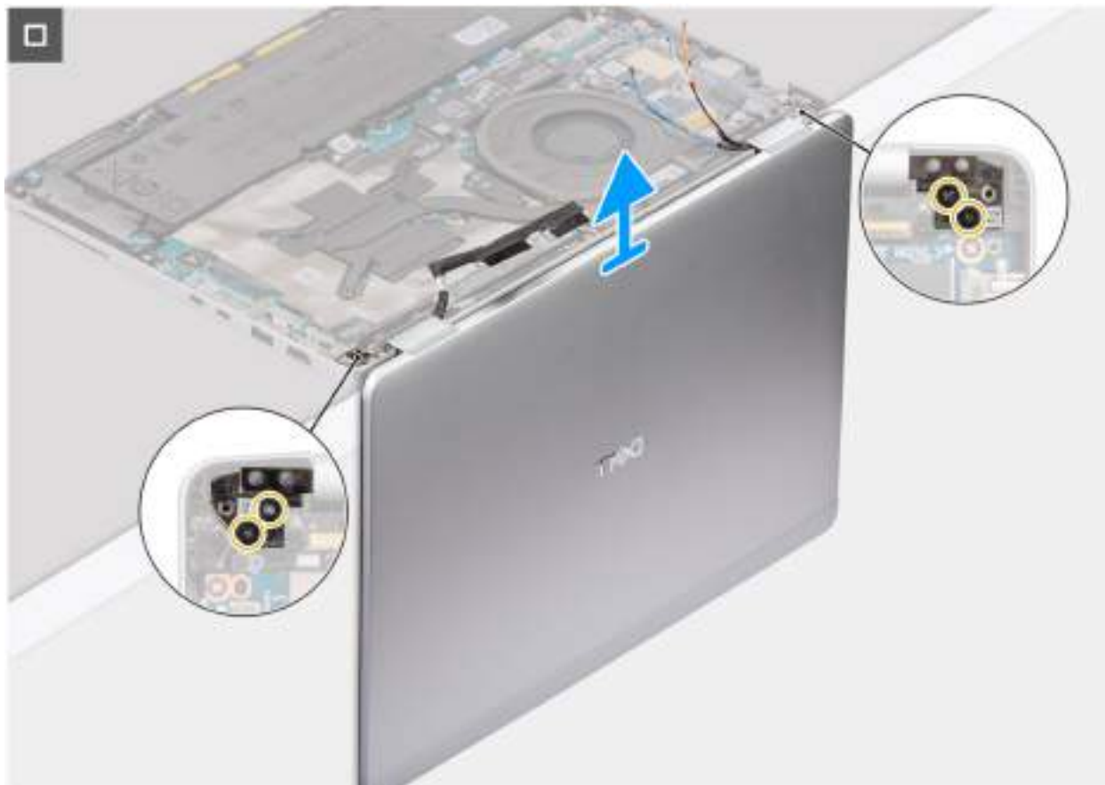
Obrázek 62. Demontáž sestavy displeje
