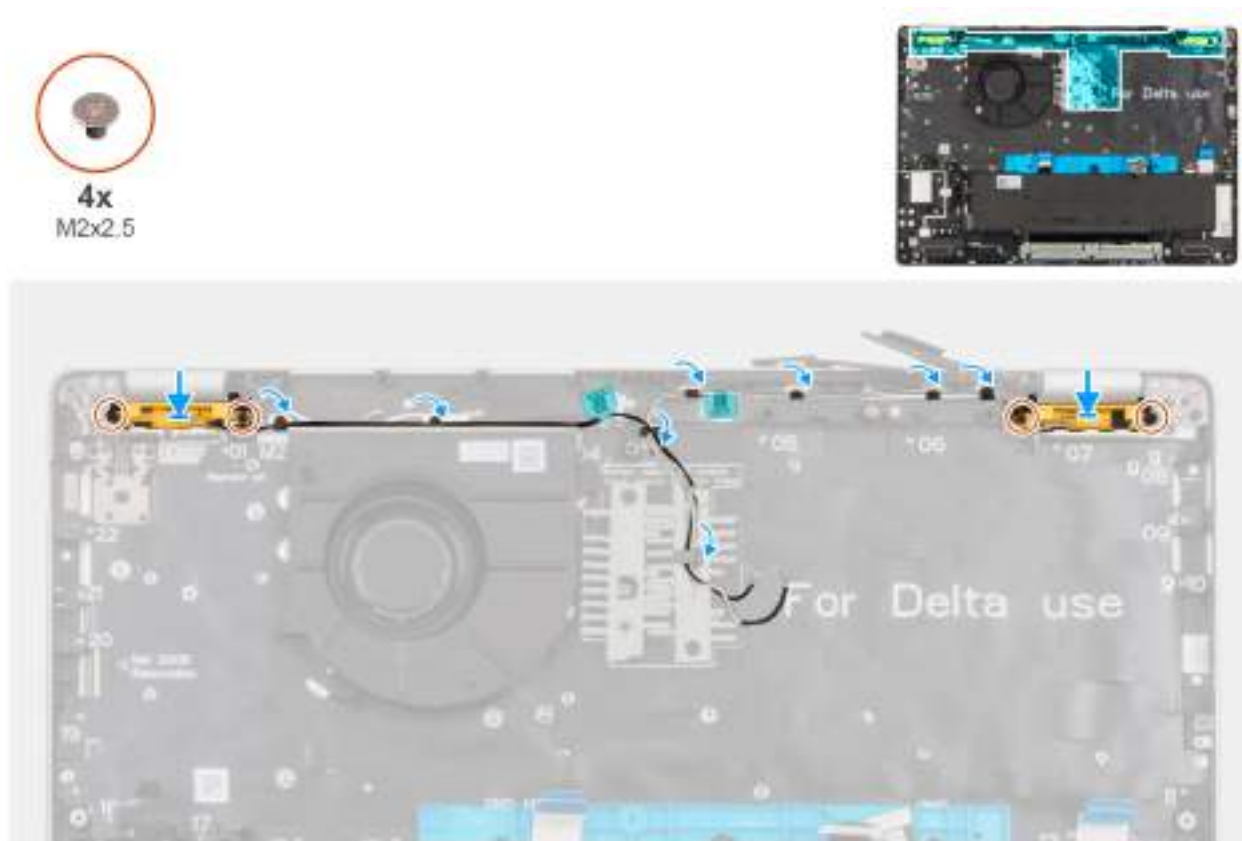
Obrázek 77. Montáž bezdrátové antény
