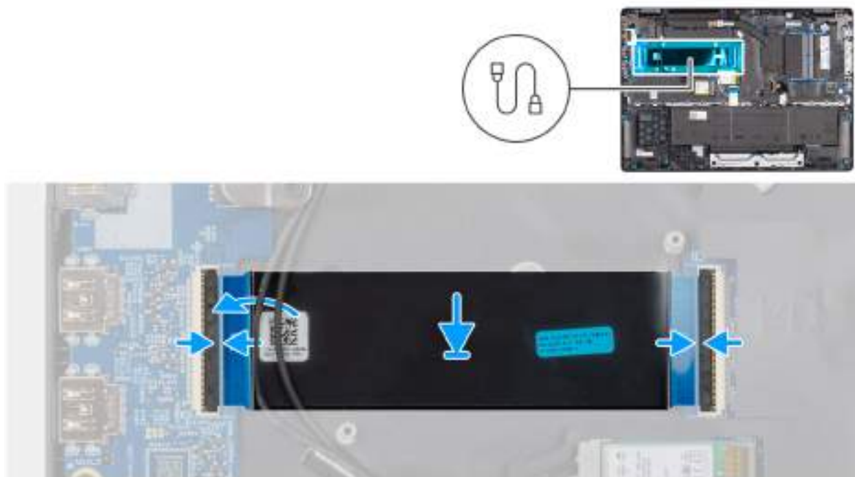
Obrázek 39. Installing the I/O board
