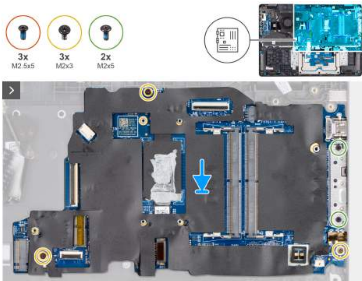
Obrázek 46. Installing the system board
