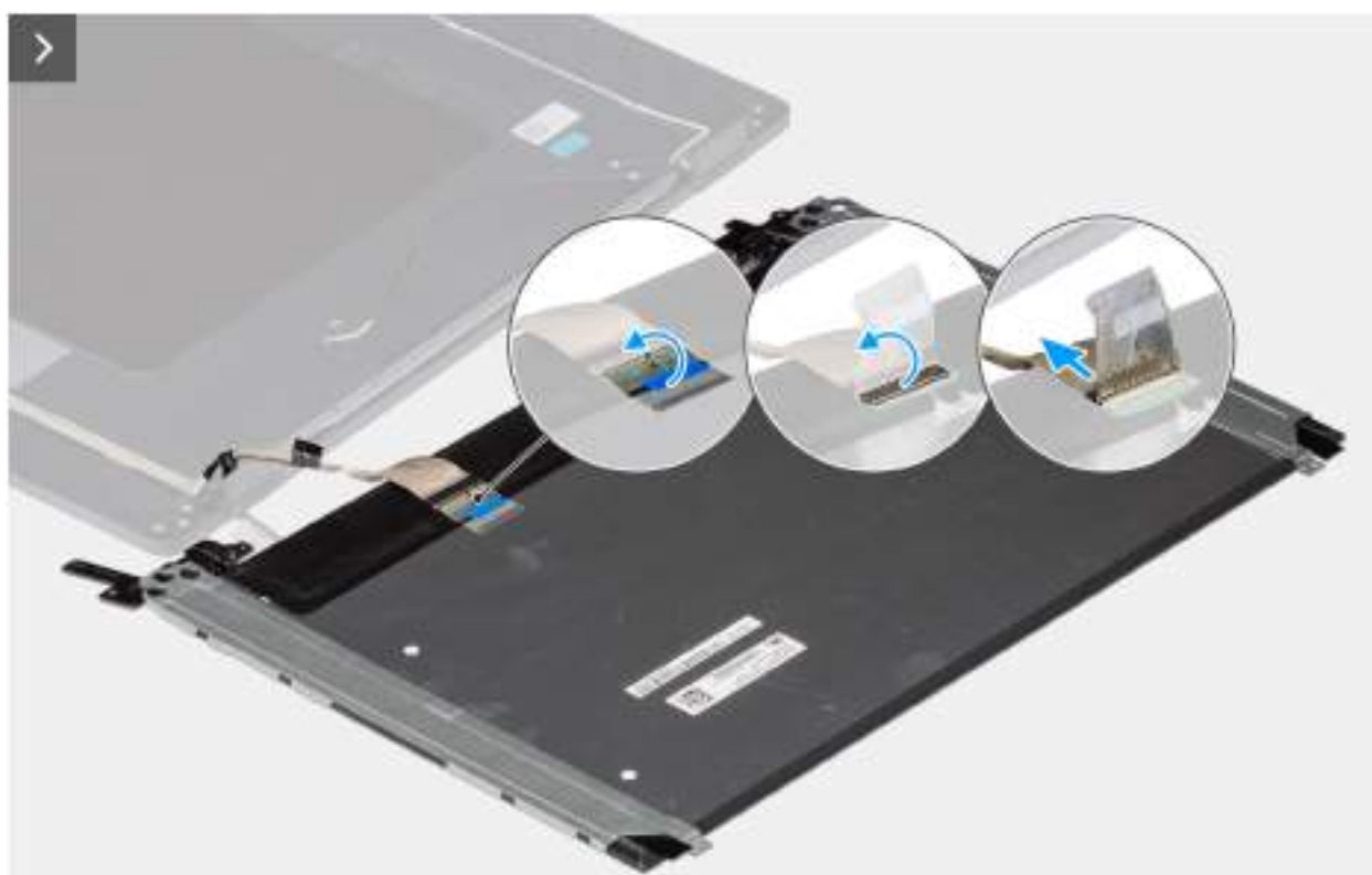
Obrázek 76. Removing the display-panel assembly
