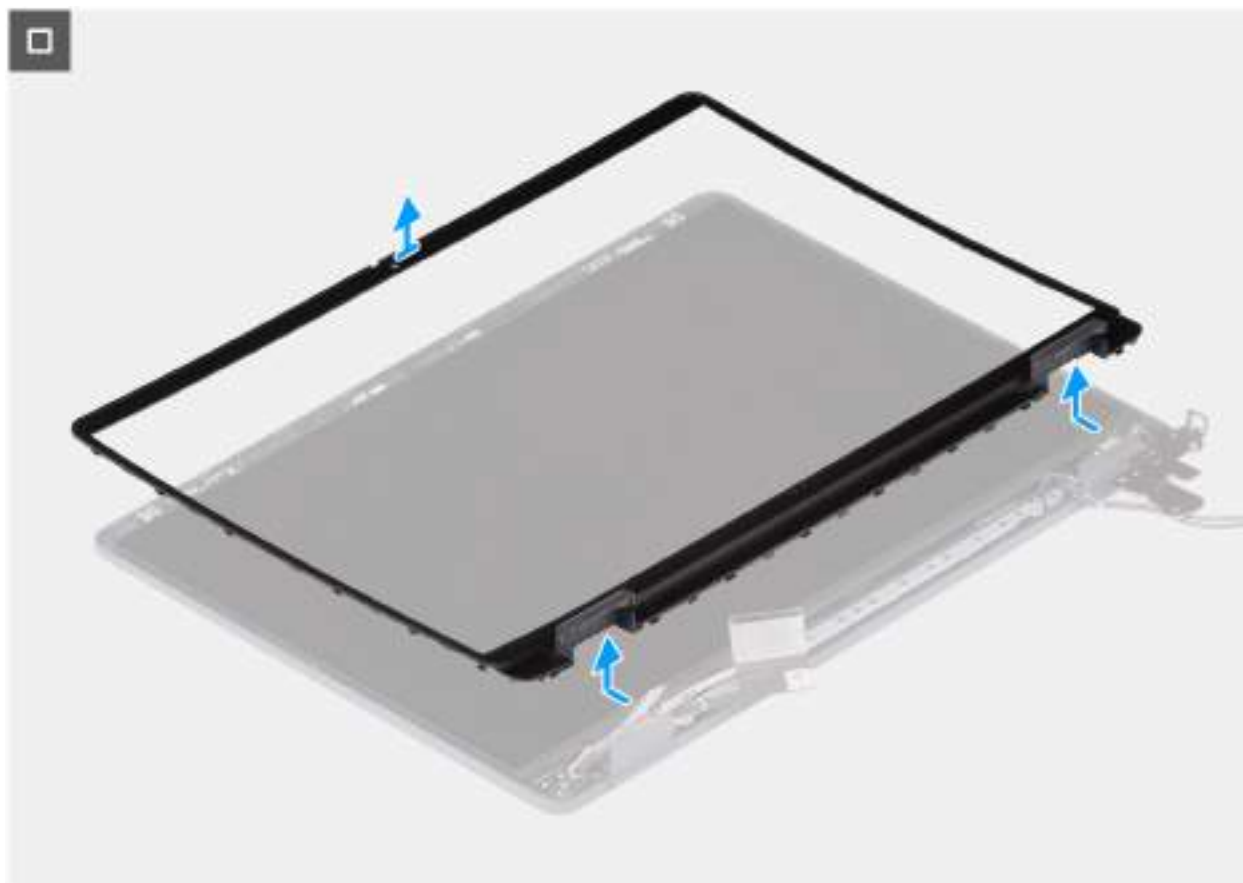
Obrázek 71. Removing the display bezel
