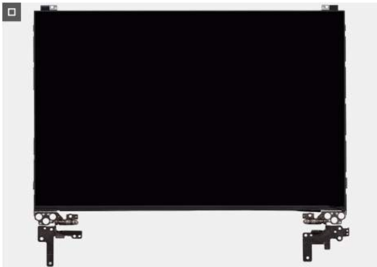
Obrázek 77. Removing the display-panel assembly
