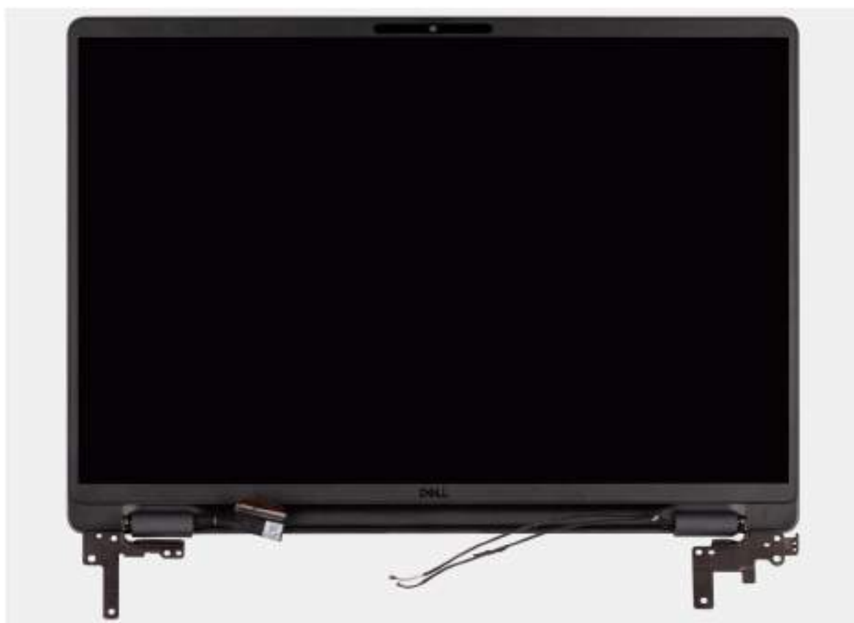
Obrázek 64. Removing the display assembly
