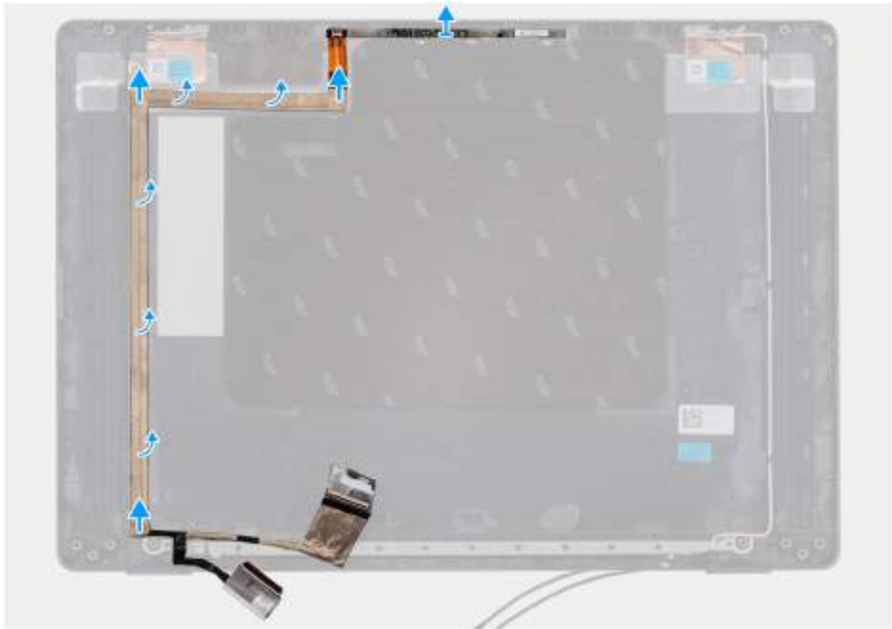
Obrázek 84. Removing the eDP cable
