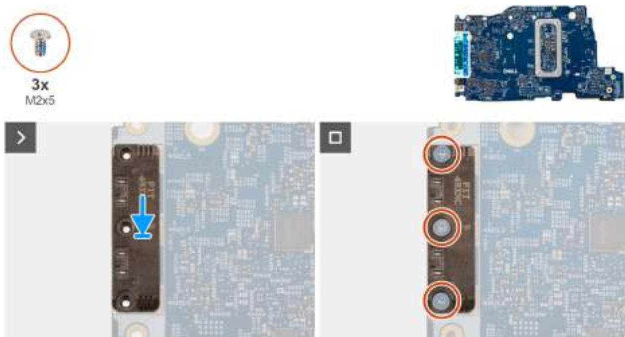
Obrázek 49. Installing the USB Type-C module
