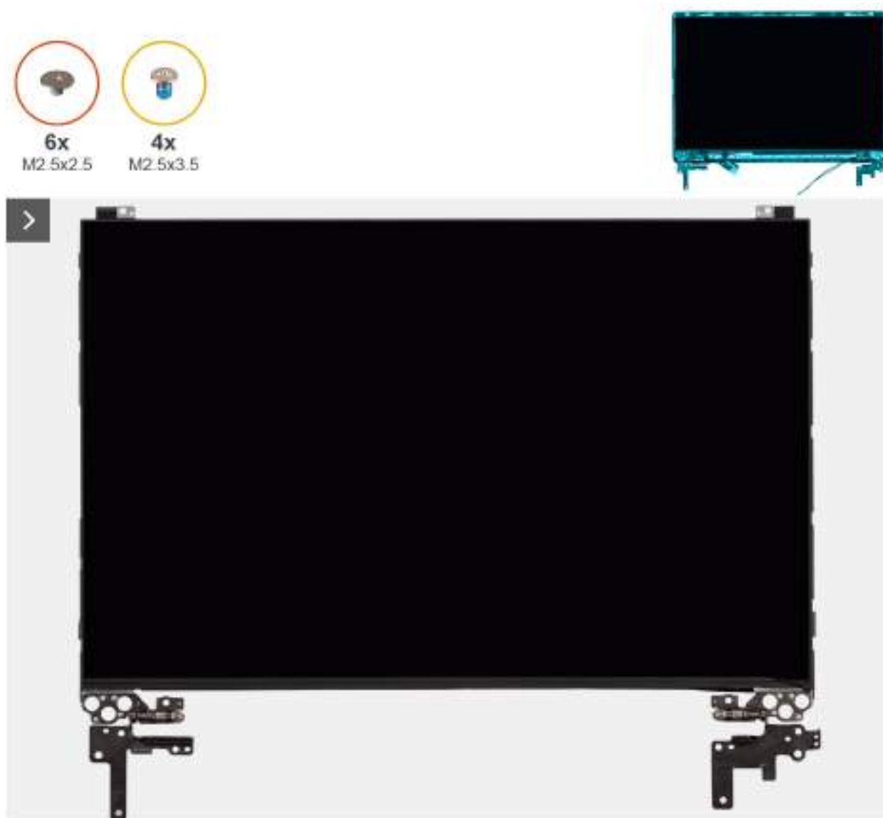
Obrázek 78. Installing the display-panel assembly
