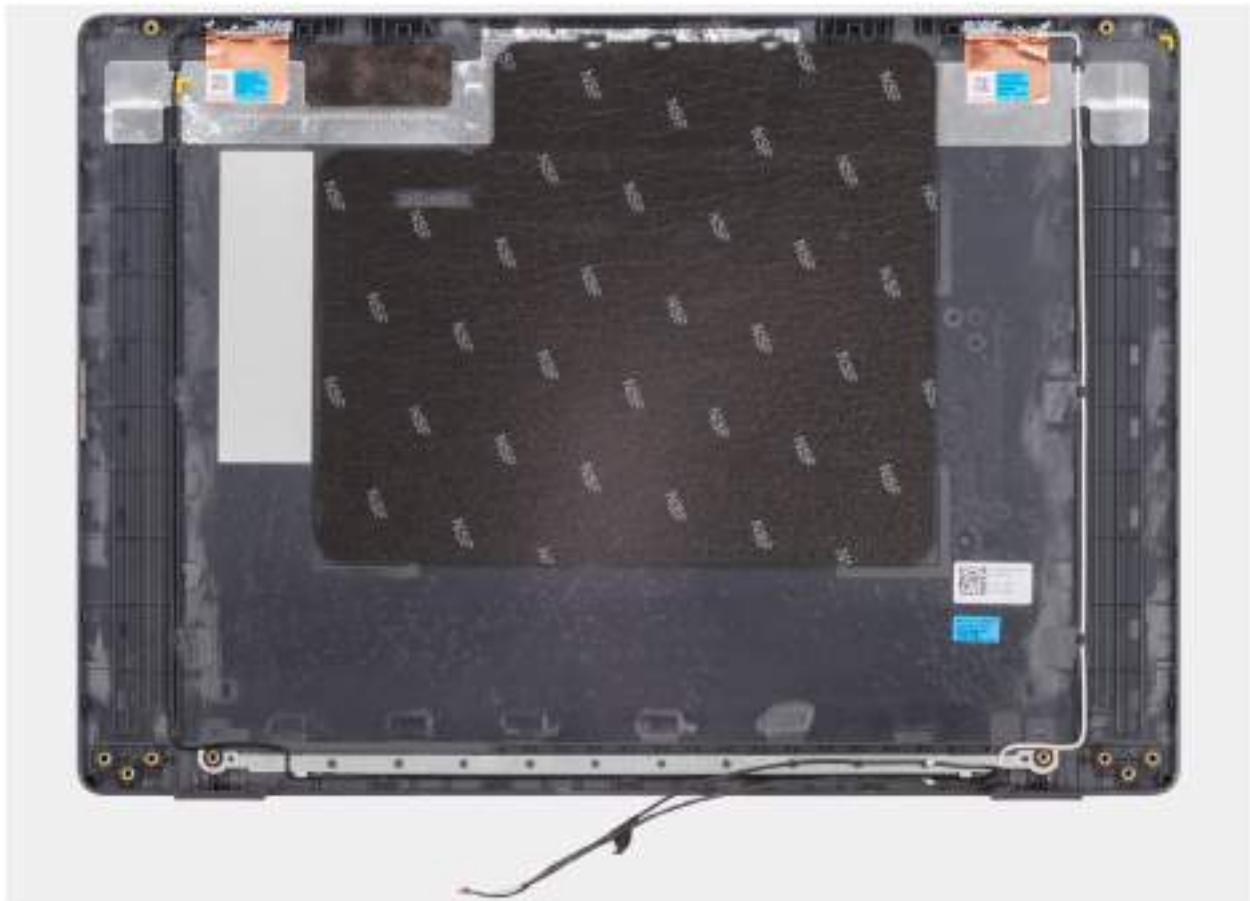
Obrázek 86. Removing the display back-cover assembly
