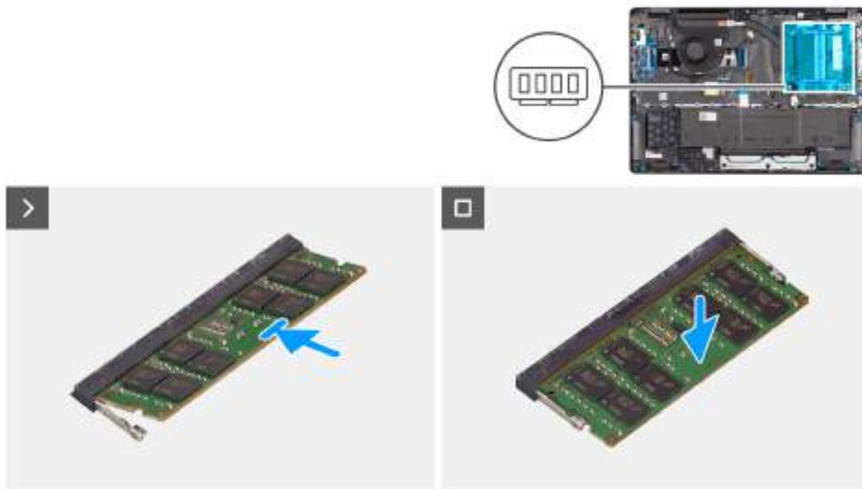
Obrázek 22. Installing the memory module
