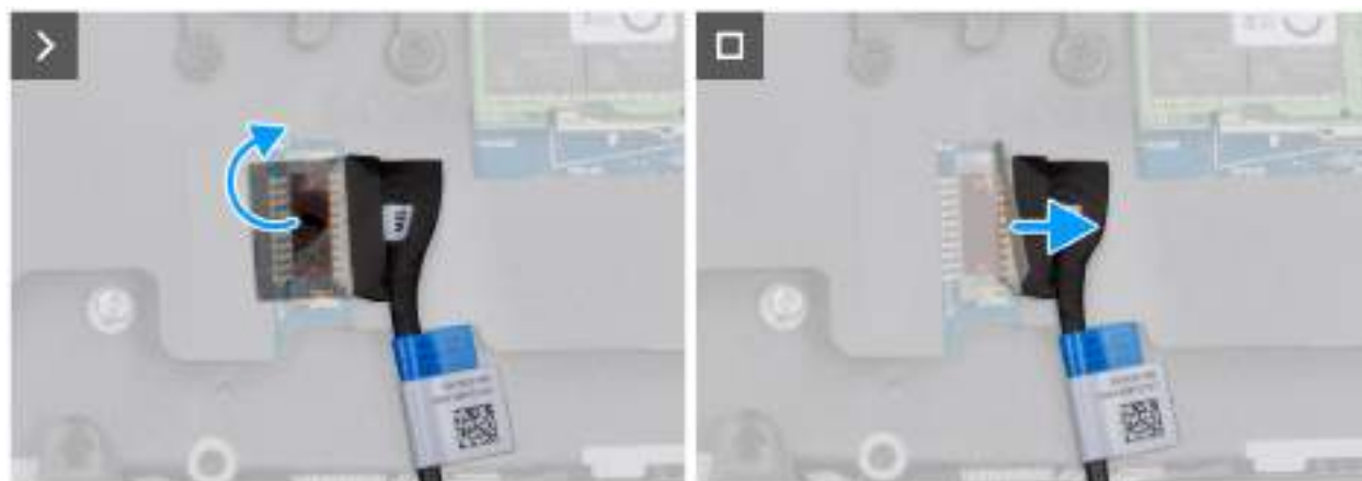
Obrázek 13. Disconnecting the battery cable
