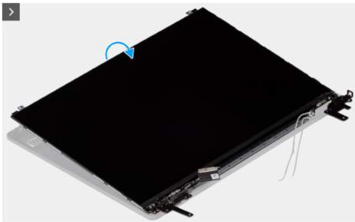
Obrázek 75. Removing the display-panel assembly
