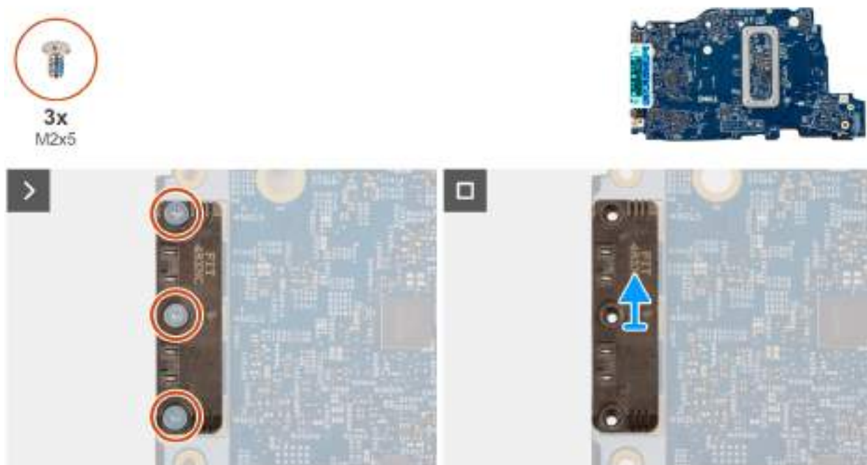
Obrázek 48. Removing the USB Type-C module
