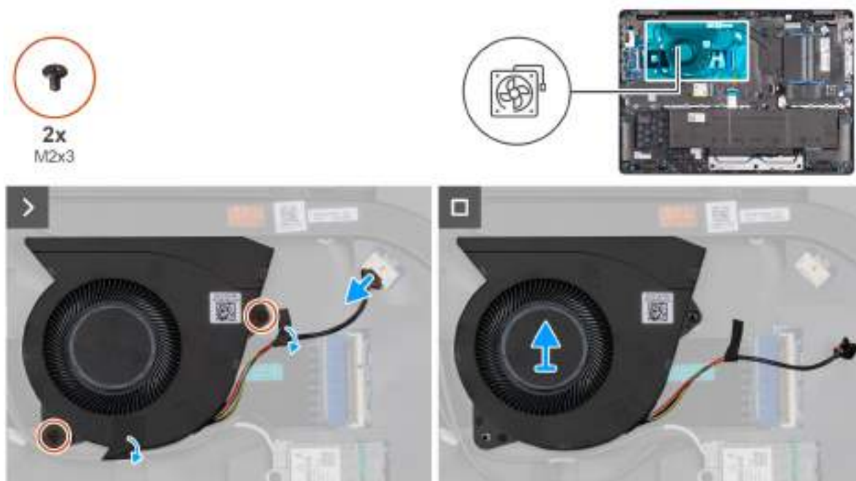
Obrázek 30. Removing the fan
