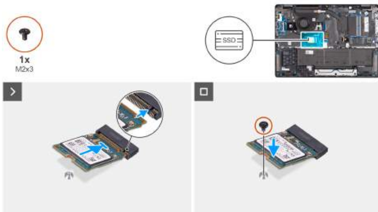
Obrázek 24. Installing the SSD
