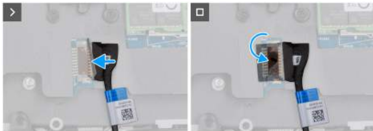
Obrázek 14. Connecting the battery cable
