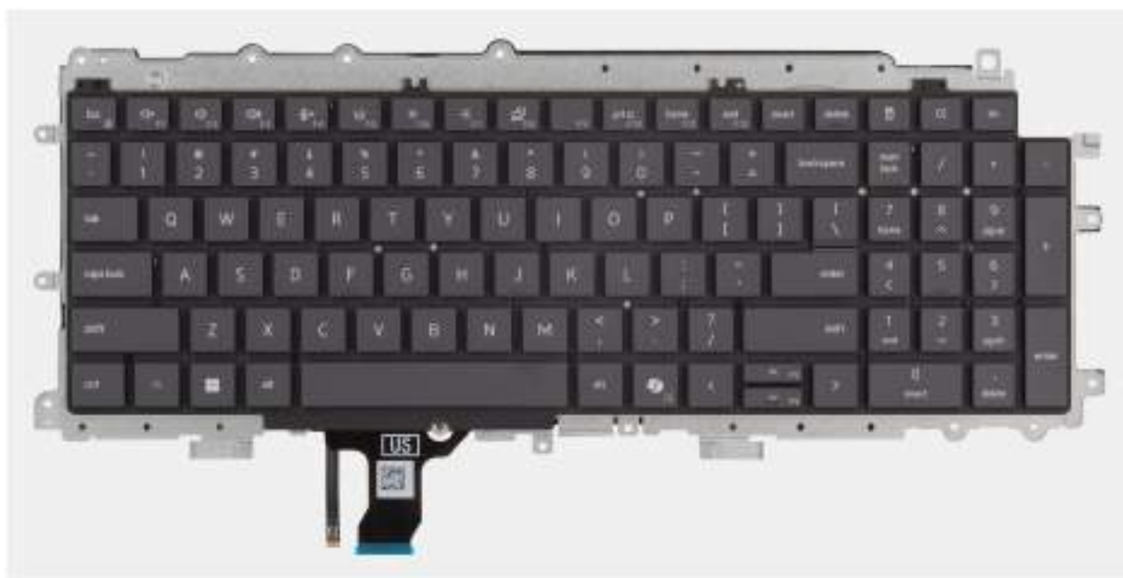
Obrázek 52. Removing the keyboard
