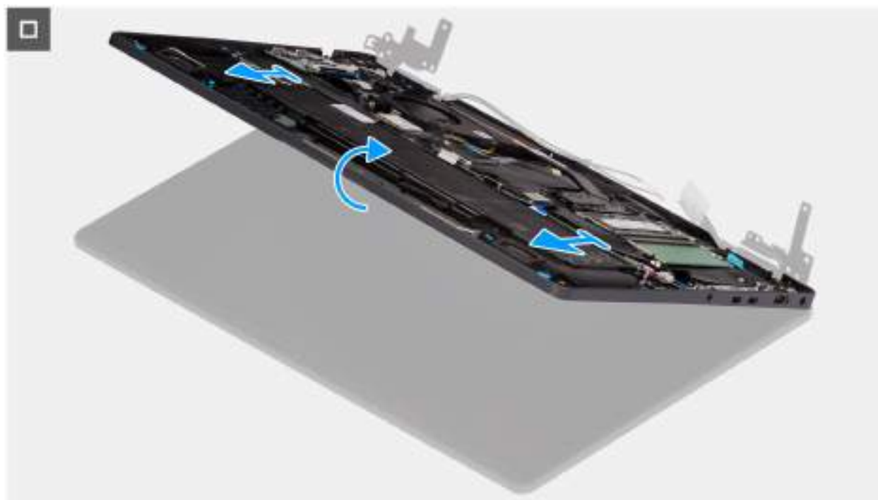
Obrázek 63. Removing the display assembly
