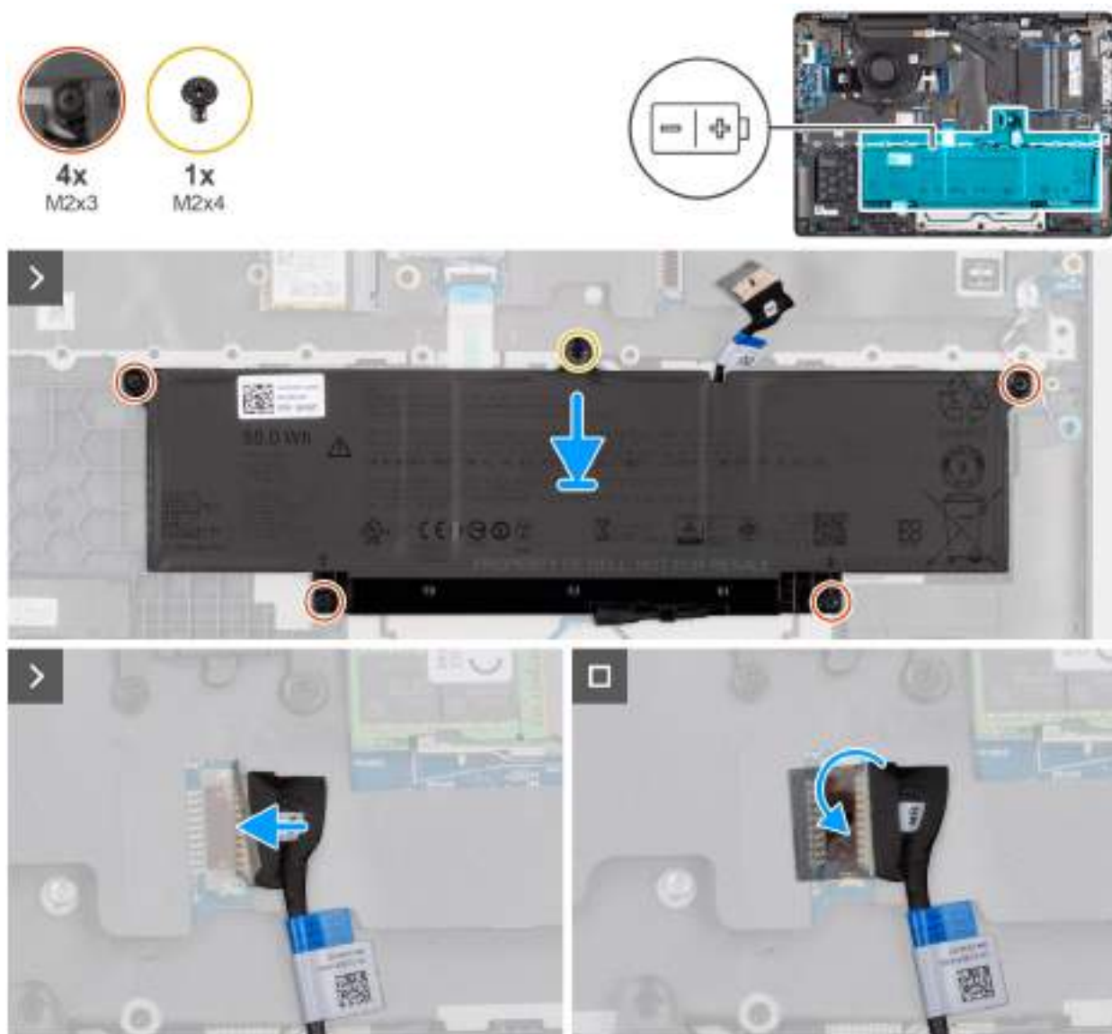
Obrázek 18. Installing the battery
