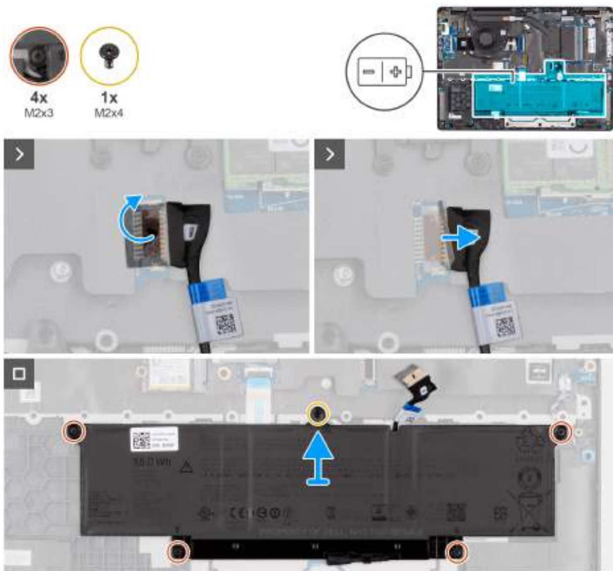
Obrázek 17. Removing the battery
