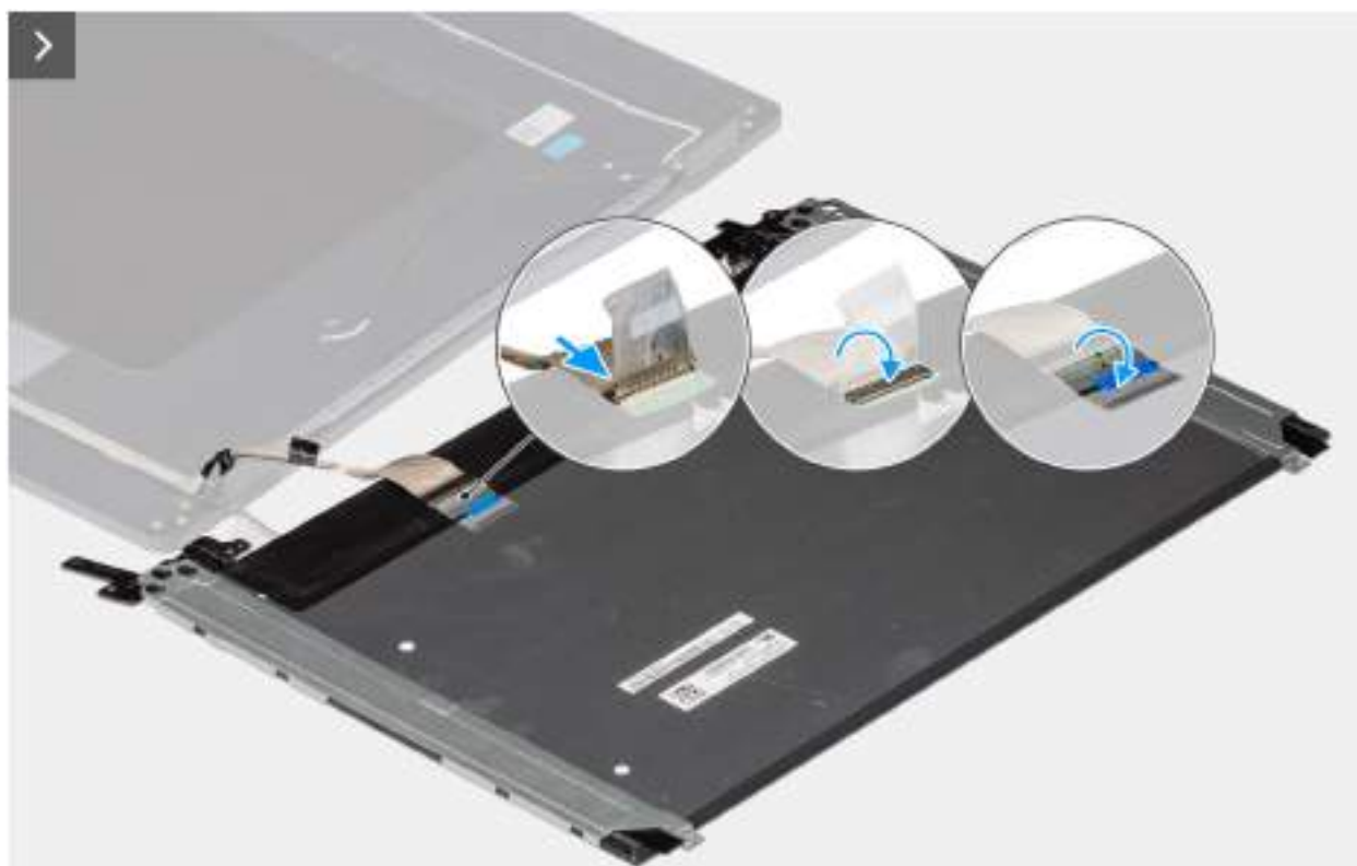
Obrázek 79. Installing the display-panel assembly
