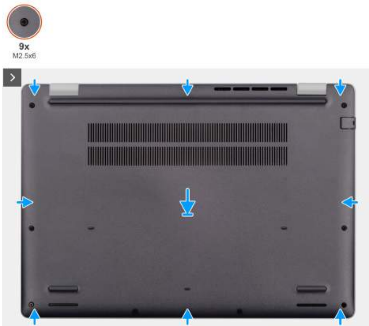
Obrázek 15. Installing the base cover
