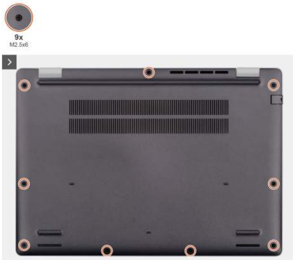
Obrázek 11. Removing the base cover
