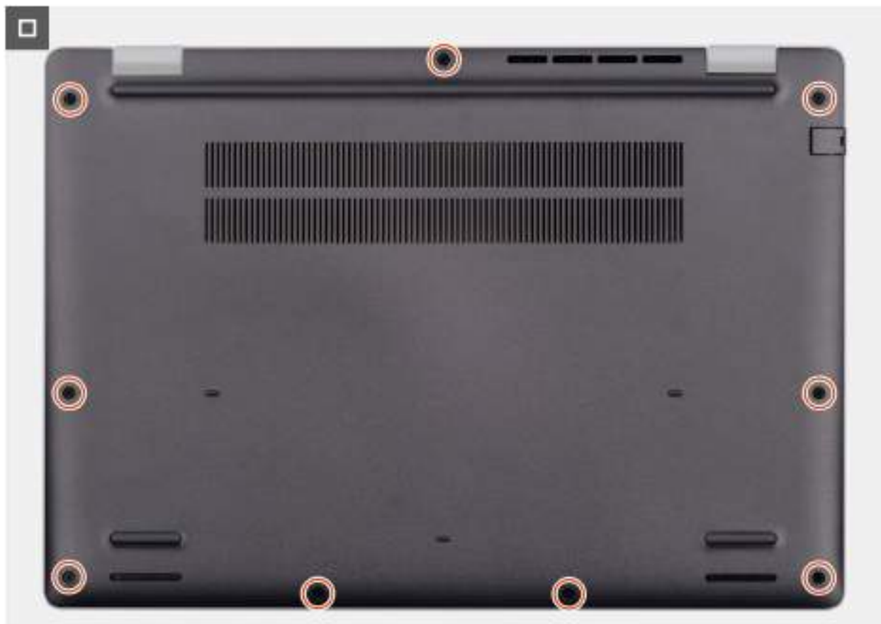
Obrázek 16. Installing the base cover
