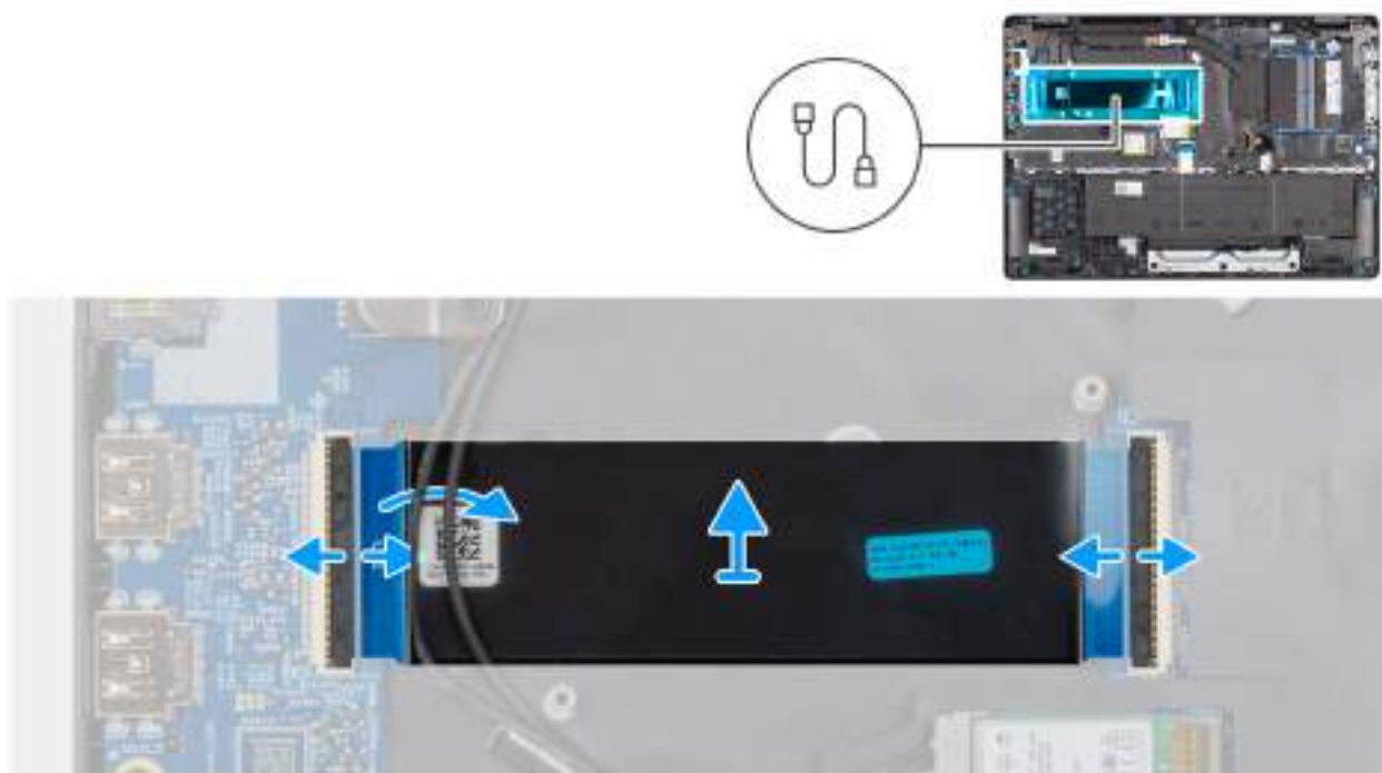
Obrázek 38. Removing the I/O-board FPC cable
