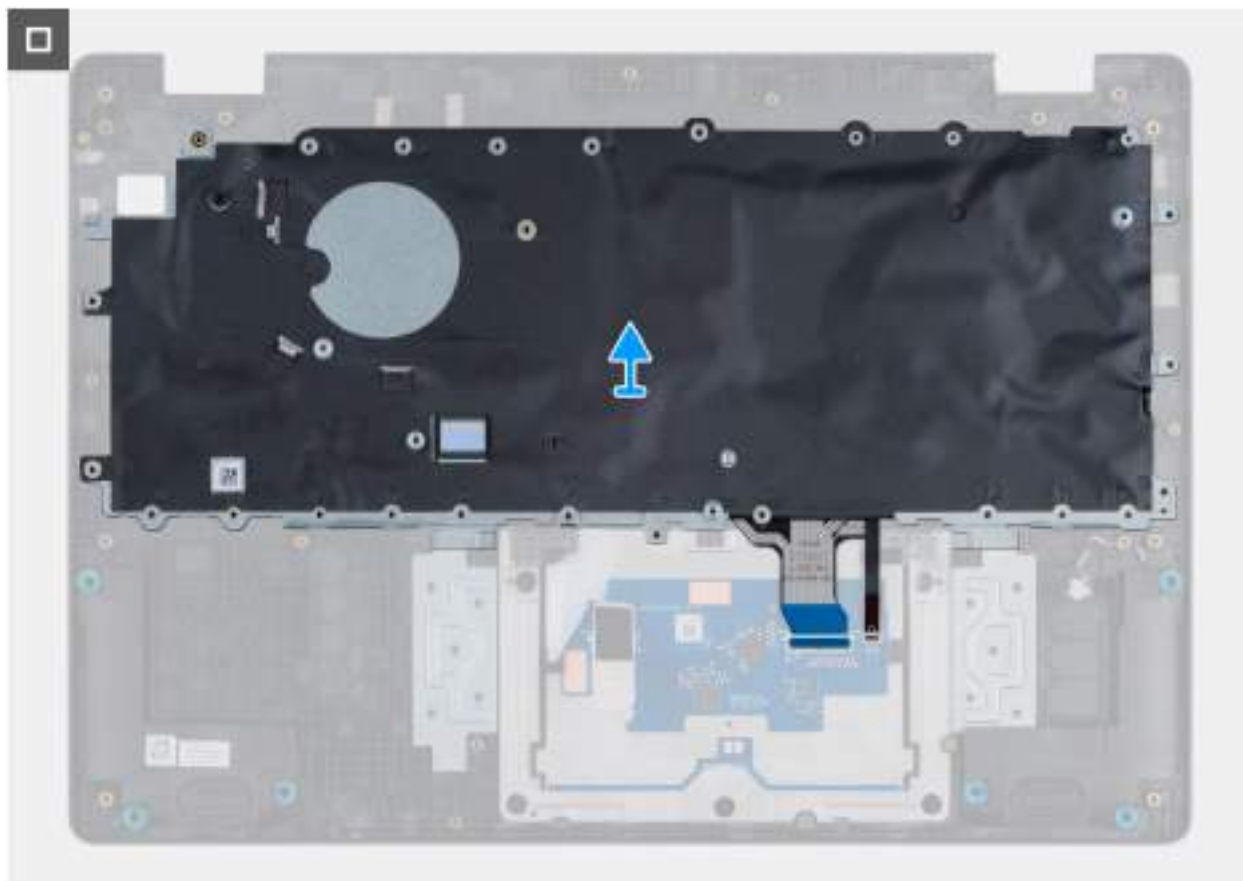
Obrázek 51. Removing the keyboard
