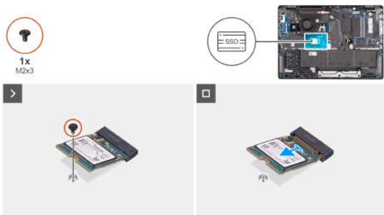
Obrázek 23. Removing the SSD
