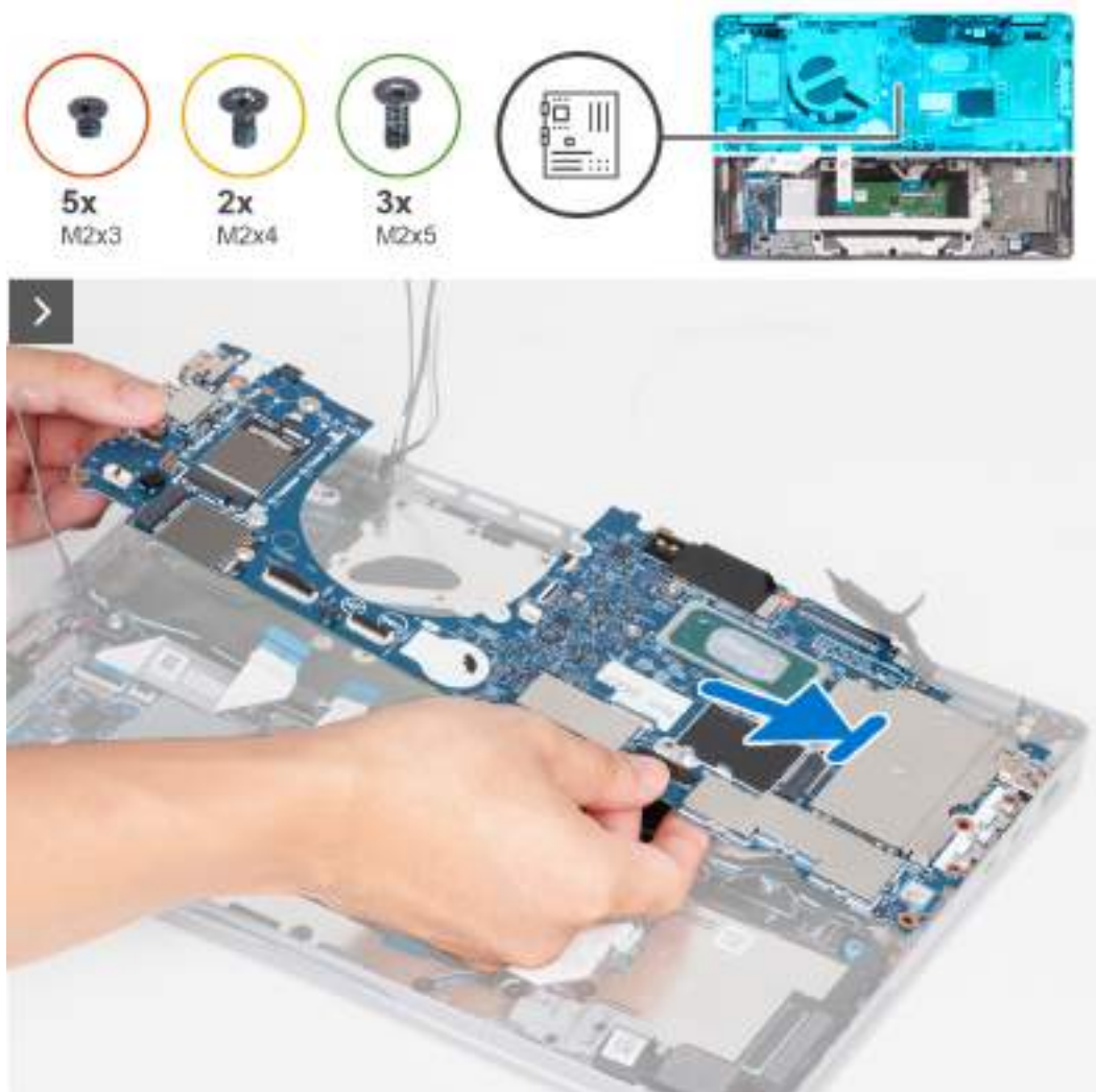
Obrázek 49. Montáž základní desky
