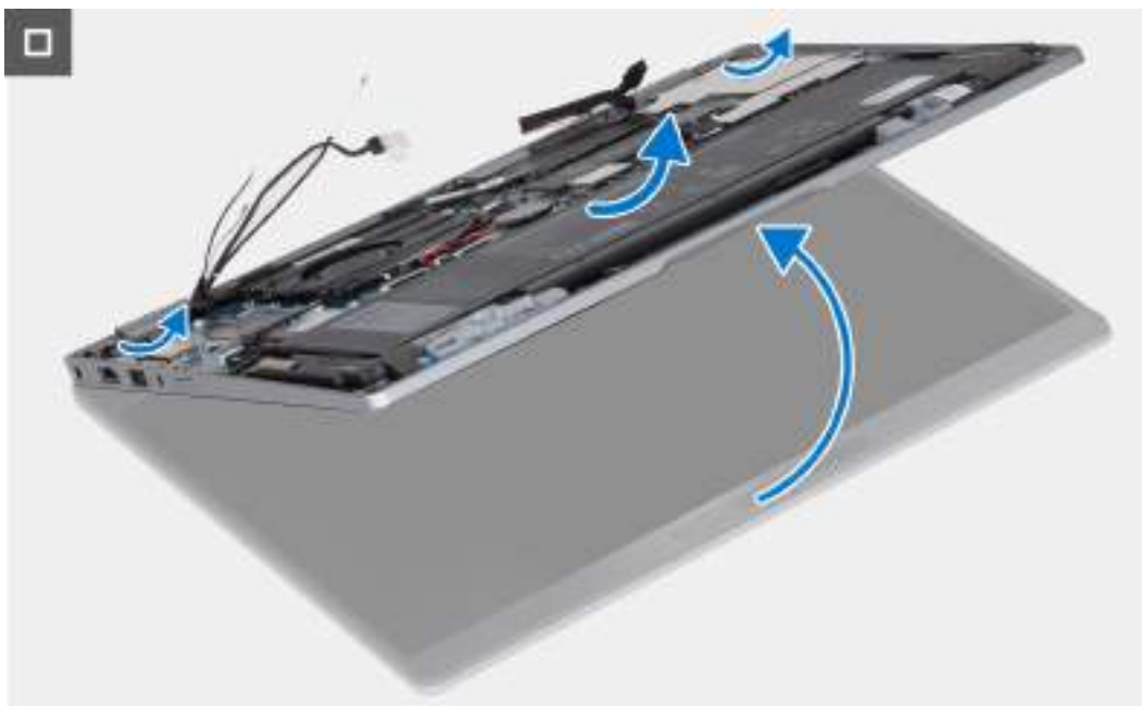
Obrázek 64. Demontáž sestavy displeje
