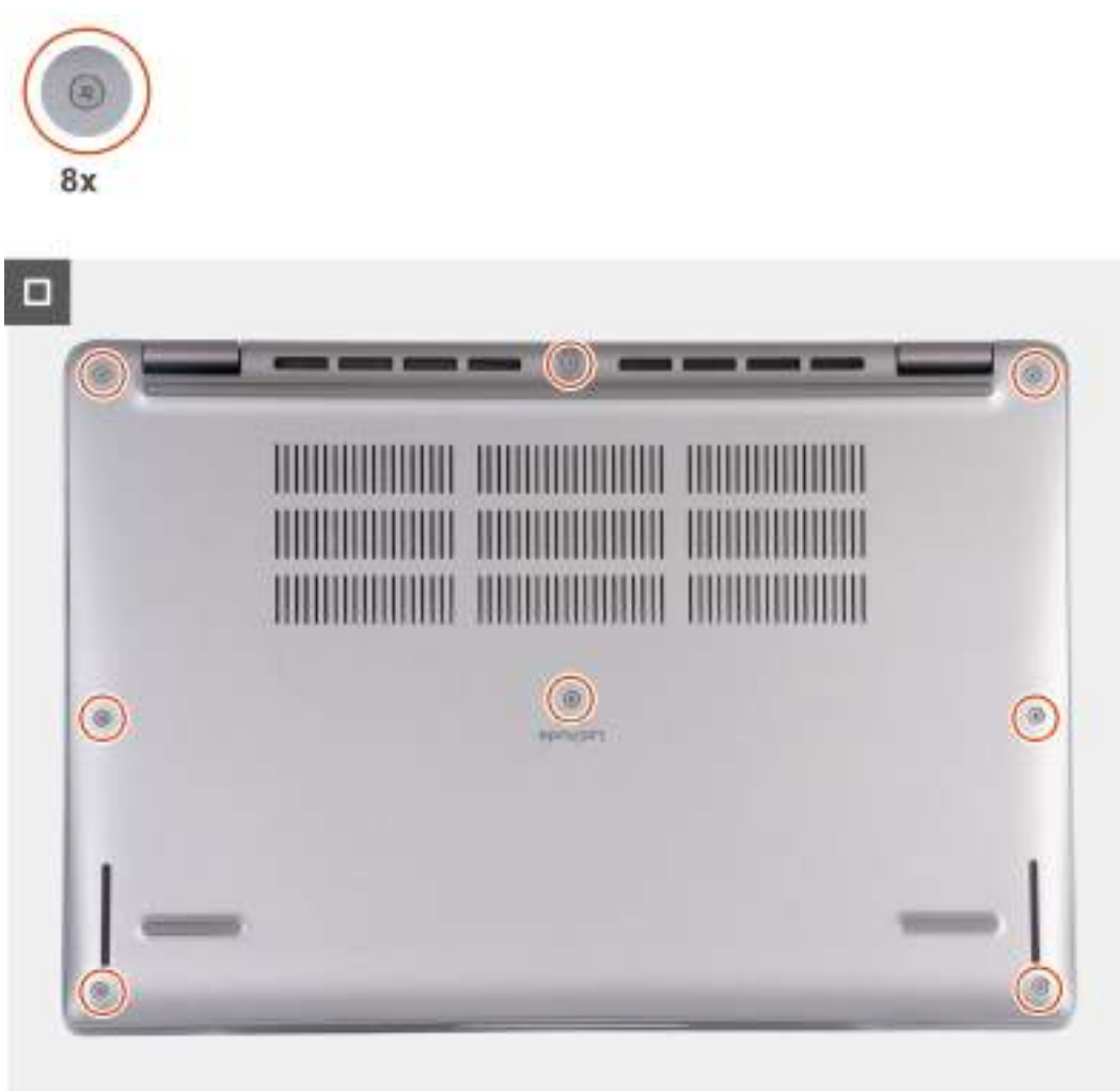
Obrázek 22. Zašroubujte osm jisticích šroubků, které připevňují spodní kryt k sestavě opěrky pro dlaň.
