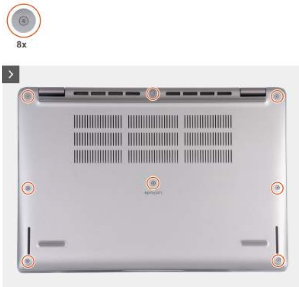
Obrázek 17. Uvolněte osm jisticích šroubků, které připevňují spodní kryt k sestavě opěrky pro dlaň.
