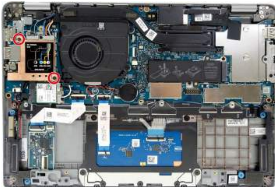
Obrázek 33. Kovový kryt pro desku WWAN
