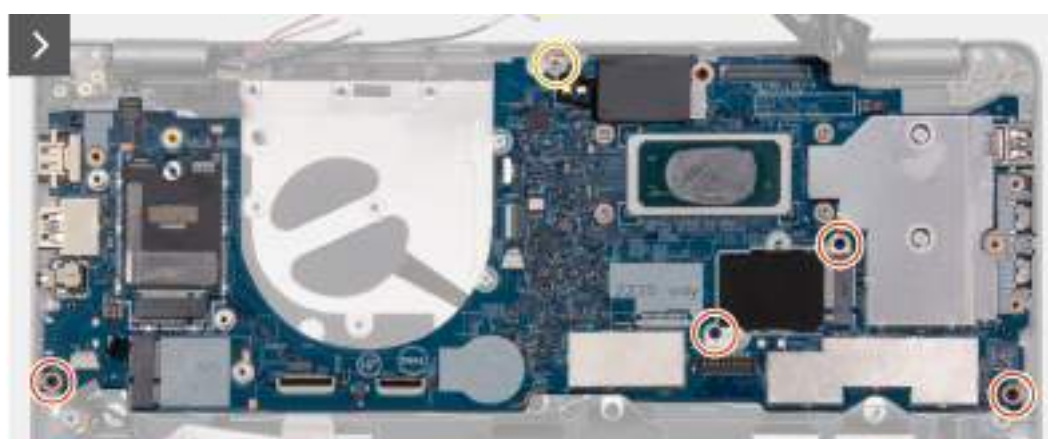
Obrázek 46. Demontáž základní desky
