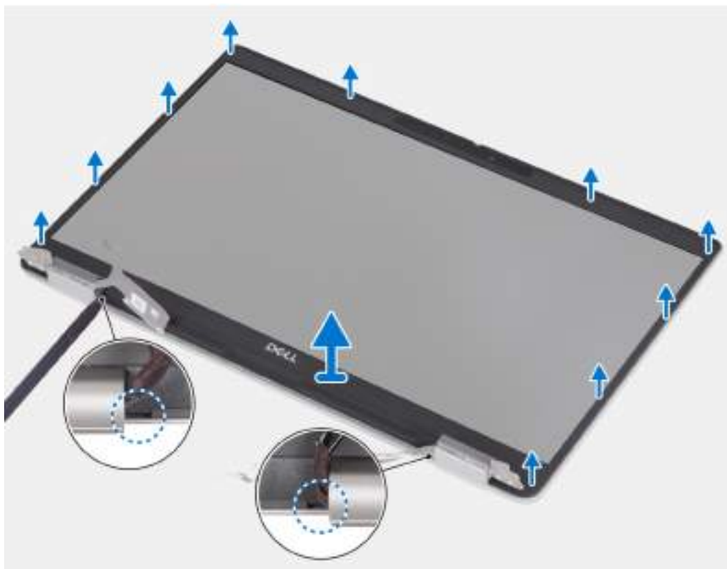
Obrázek 67. Demontáž čelního krytu displeje (notebook)
