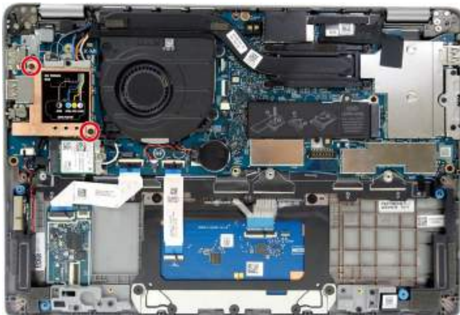
Obrázek 31. Kovový kryt pro desku WWAN
