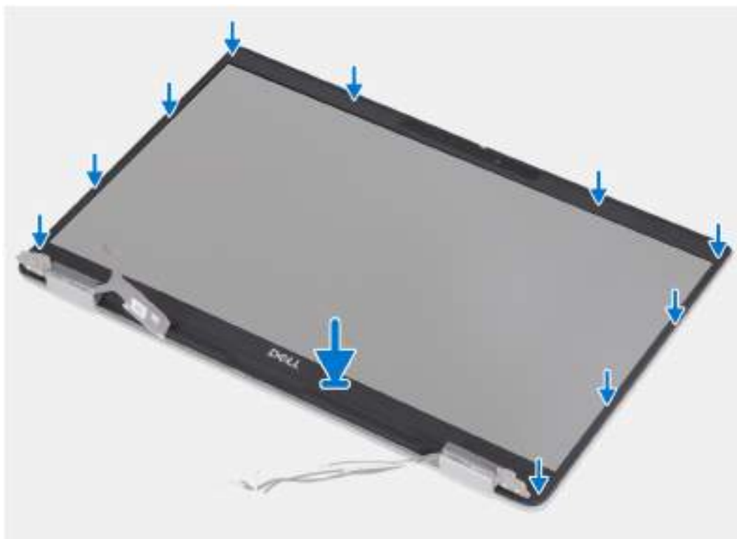
Obrázek 69. Montáž čelního krytu displeje (notebook)
