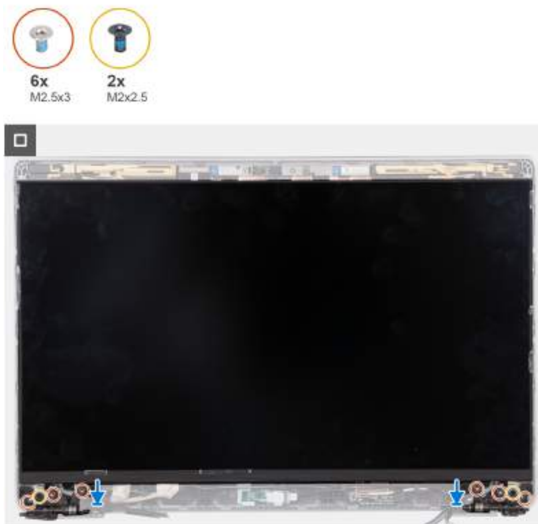
Obrázek 79. Vložení výčnělků v obrazovce displeje do slotů v krytu displeje
