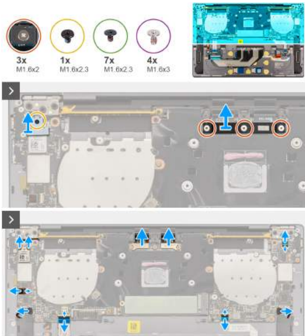
Obrázek 36. Demontáž základní desky
