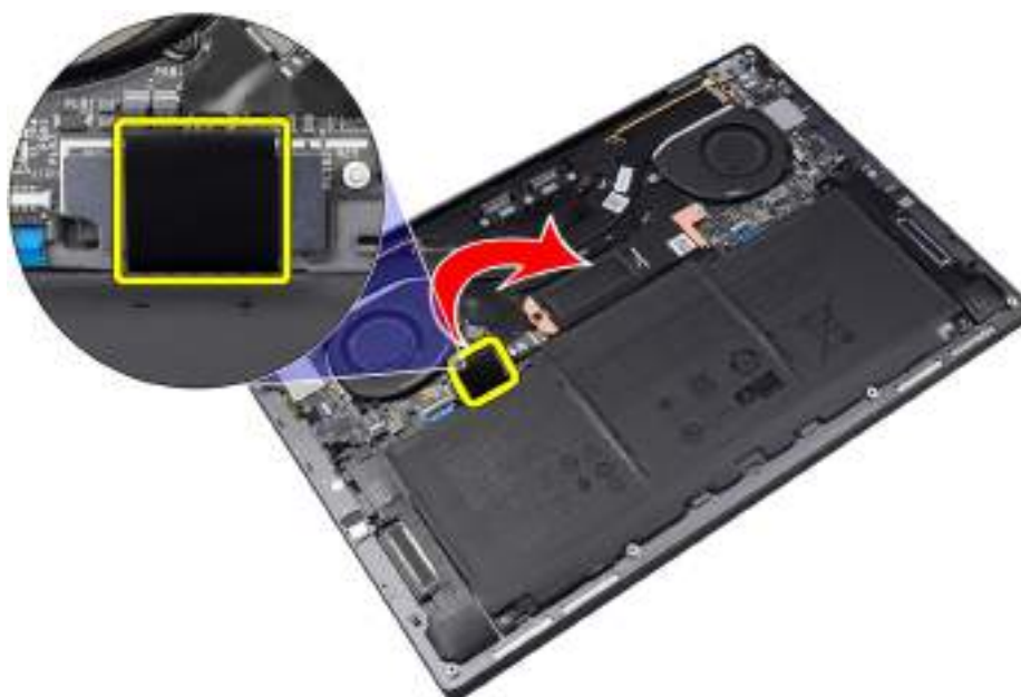
Obrázek 16. Demontáž držáku konektoru baterie
