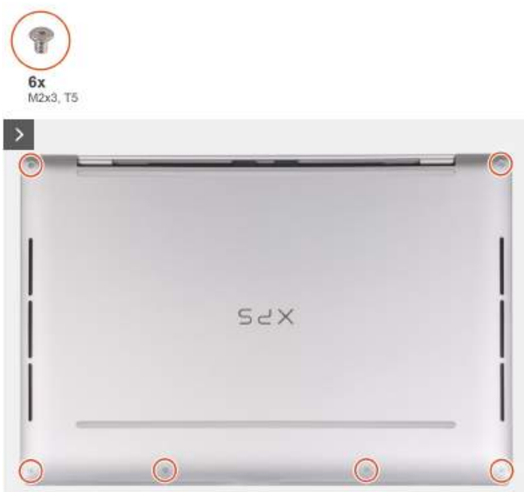
Obrázek 9. Sejmutí spodního krytu
