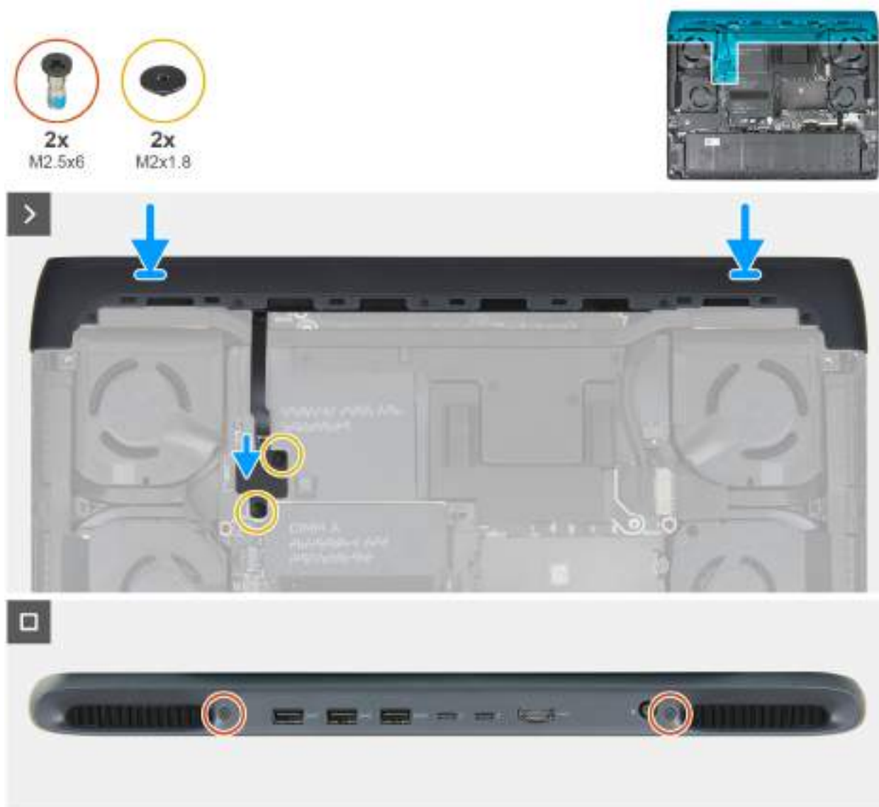
Obrázek 31. Montáž krytu I/O
