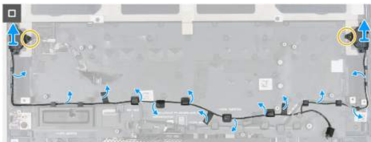
Obrázek 80. Demontáž výškových reproduktorů
