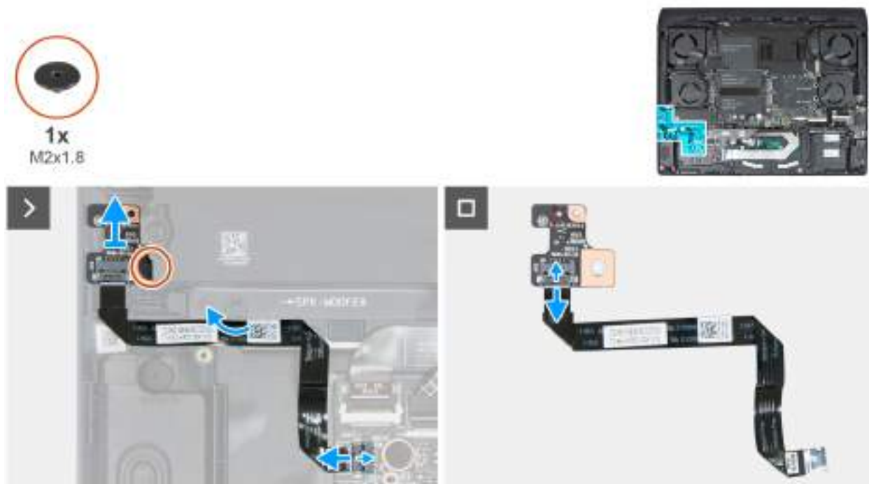
Obrázek 44. Demontáž desky Hallovy sondy
