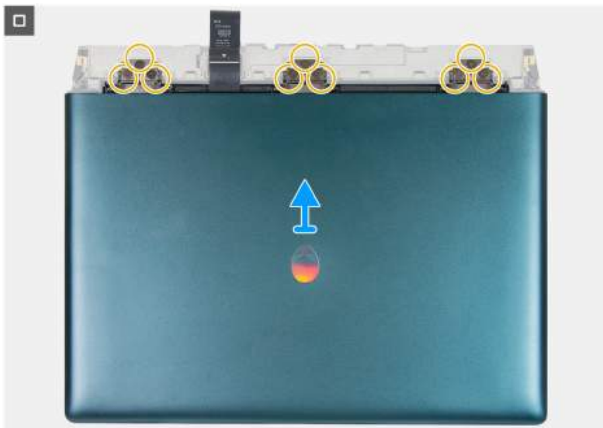
Obrázek 52. Demontáž sestavy displeje
