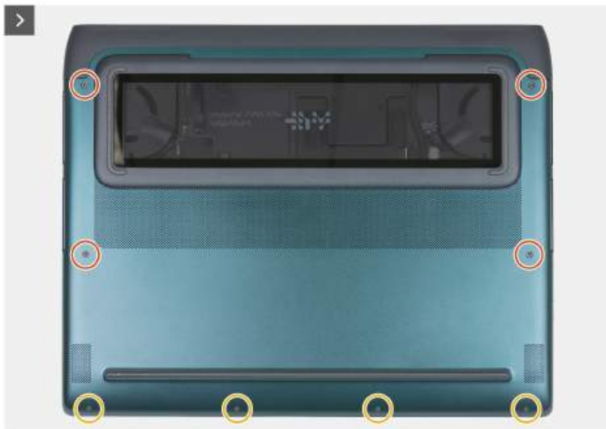
Obrázek 10. Vyšroubování šroubů spodního krytu
