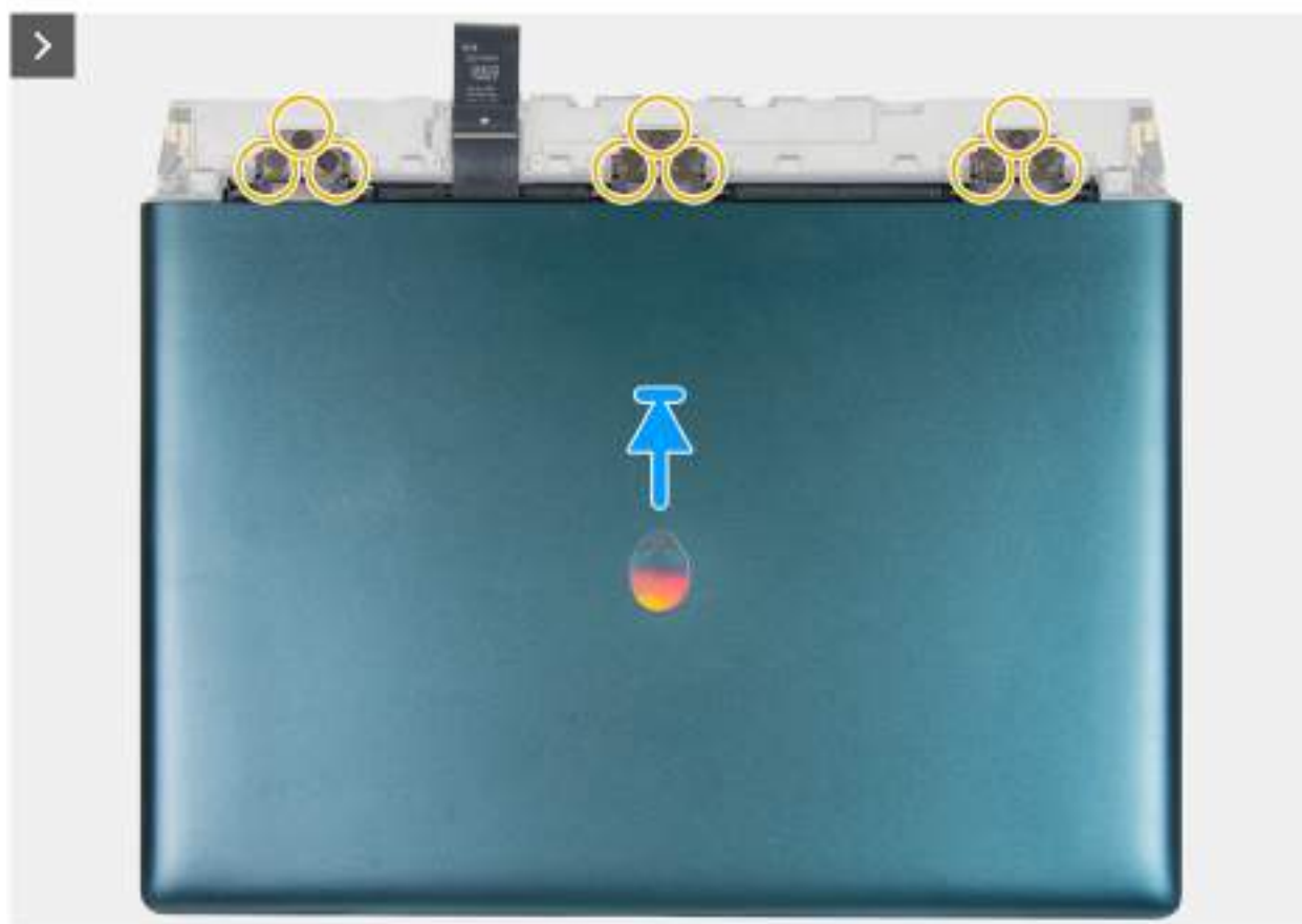
Obrázek 53. Montáž sestavy displeje
