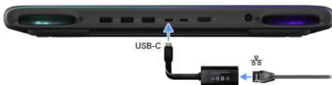
Obrázek 7. Připojte ethernetový adaptér USB Type-C
