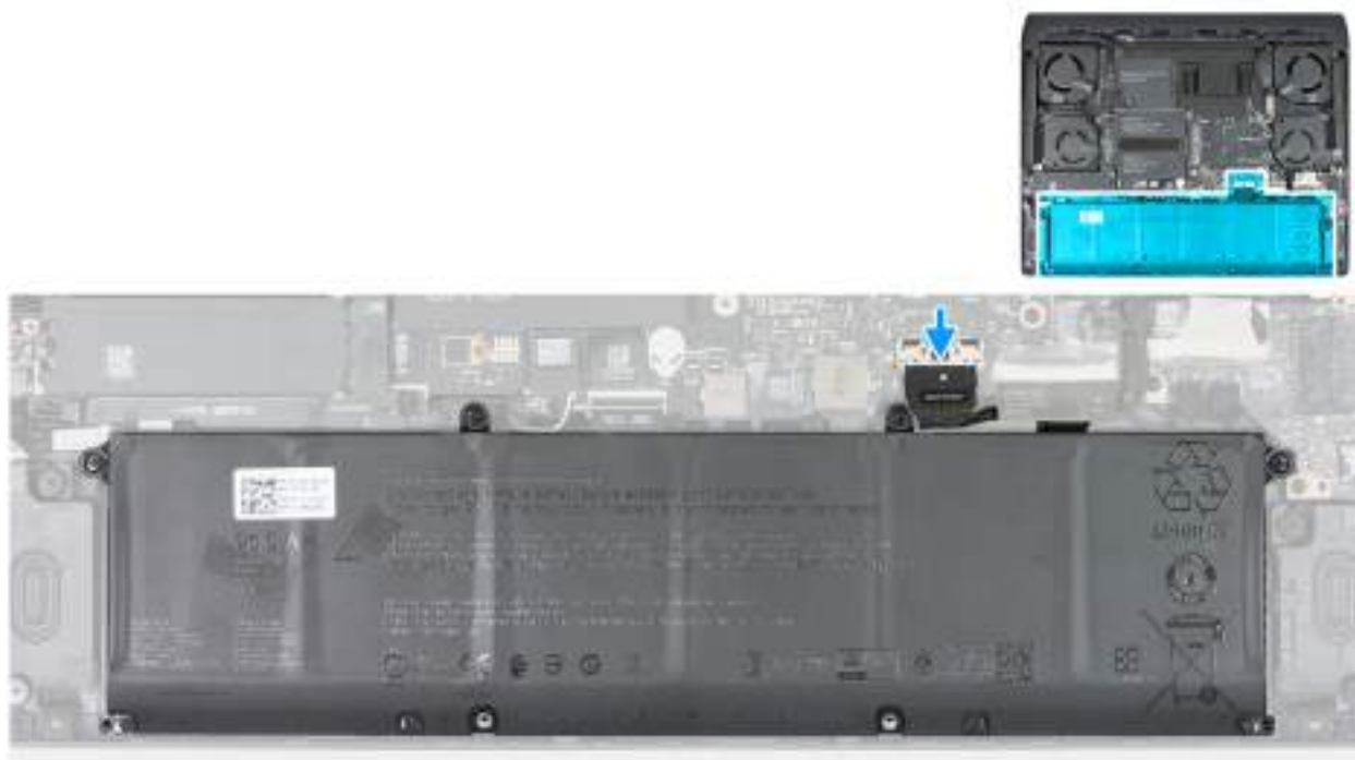
Obrázek 13. Připojení kabelu baterie
