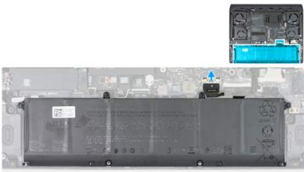
Obrázek 12. Odpojení kabelu baterie
