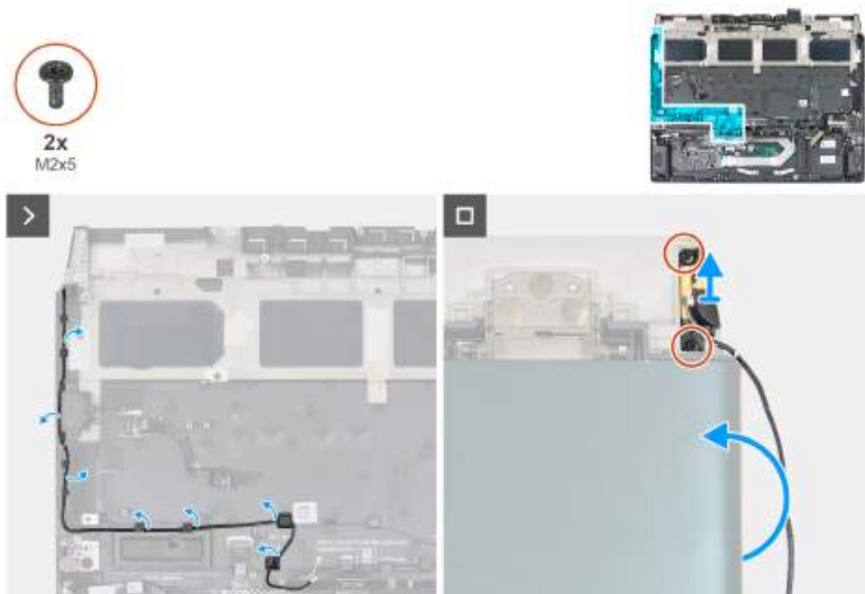
Obrázek 77. Demontáž pomocné antény WLAN
