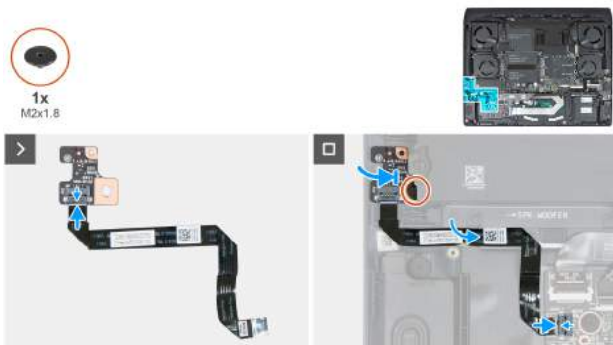
Obrázek 45. Montáž desky Hallovy sondy
