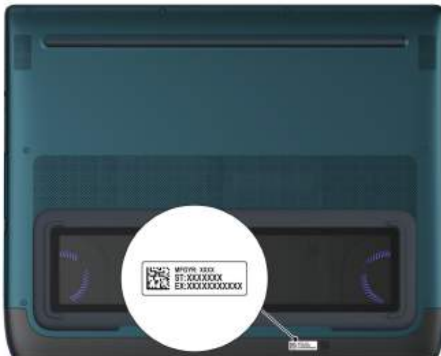
Obrázek 5. Umístění výrobního čísla / kódu Express Service Code
