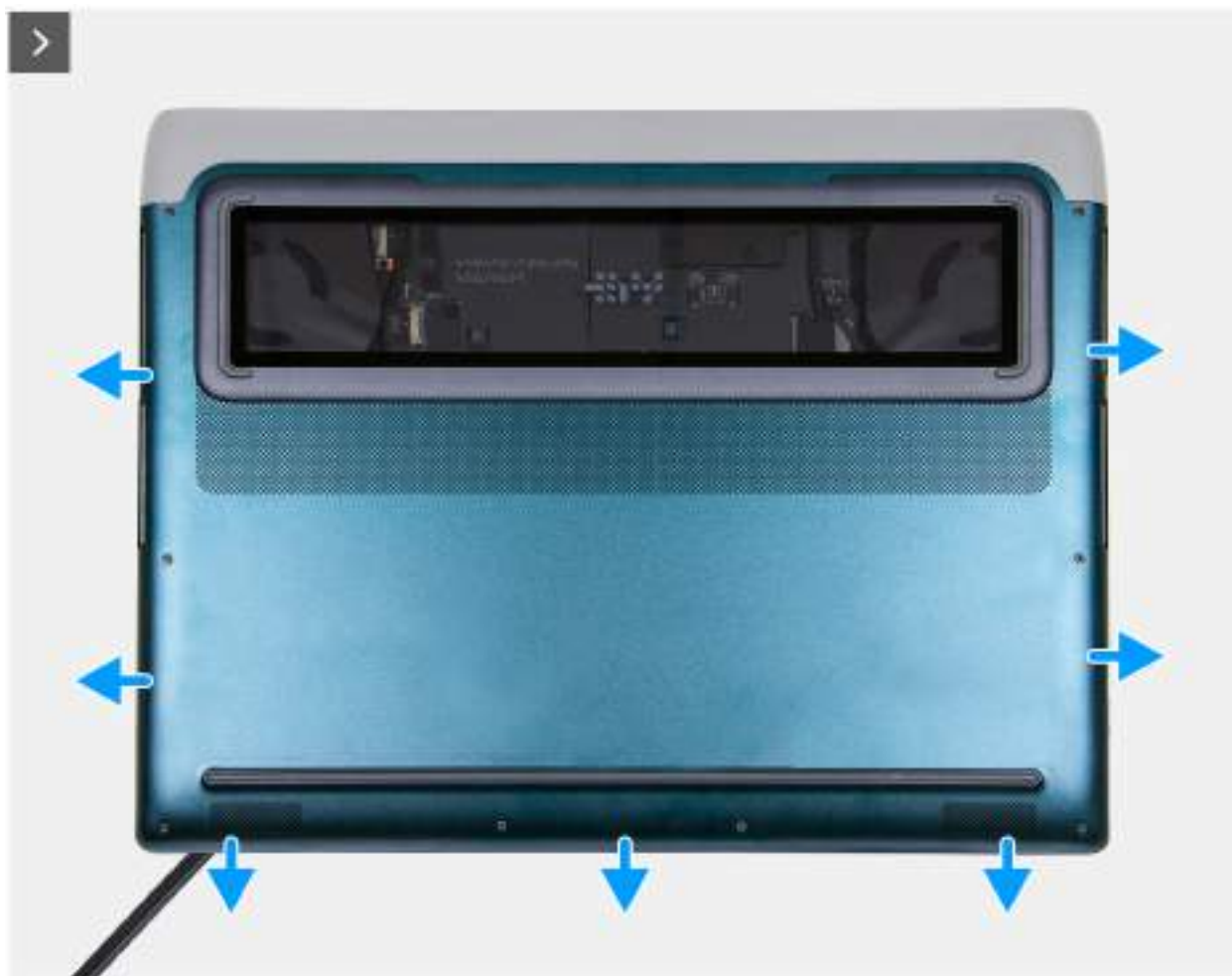
Obrázek 10. Vypáčení spodního krytu
