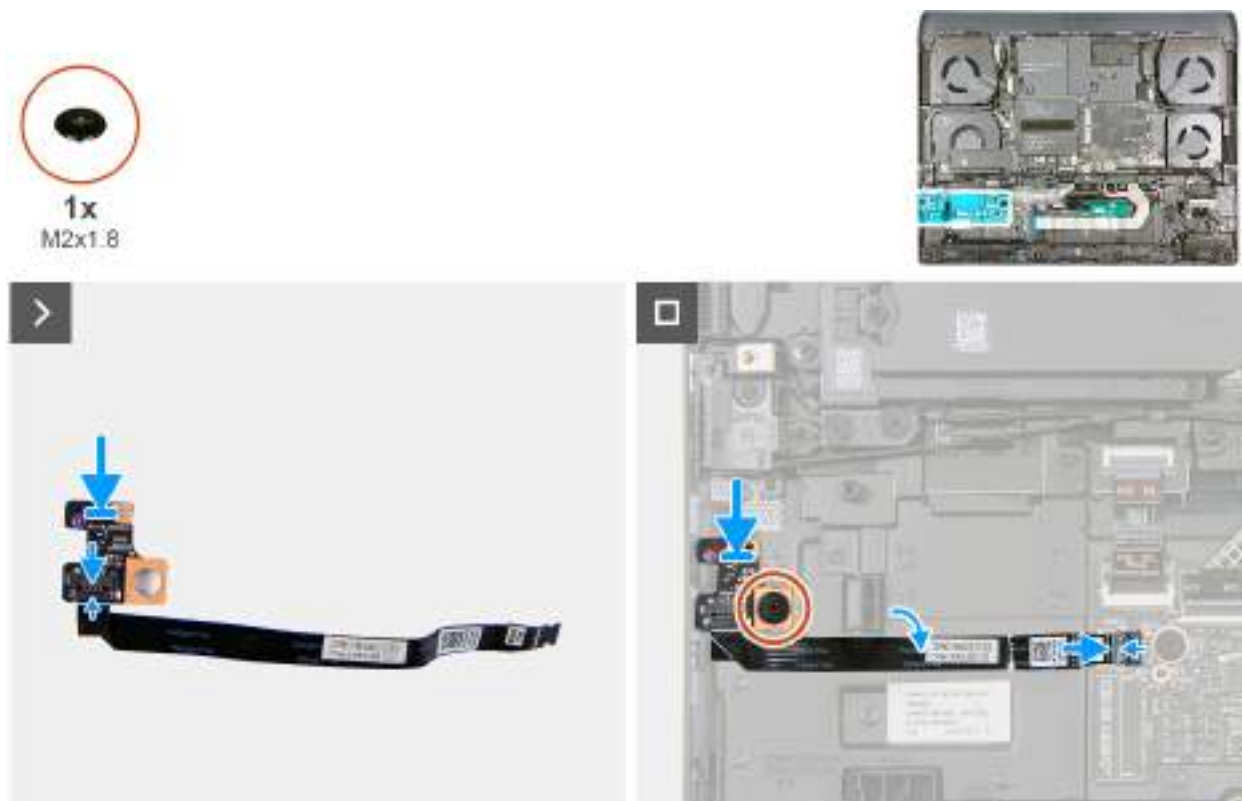
Obrázek 46. Montáž desky Hallovy sondy
