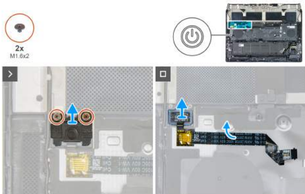
Obrázek 73. Montáž vypínače
