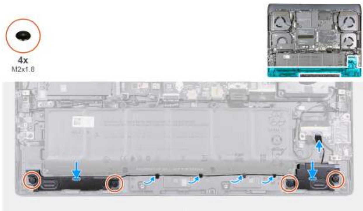
Obrázek 40. Montáž basových reproduktorů
