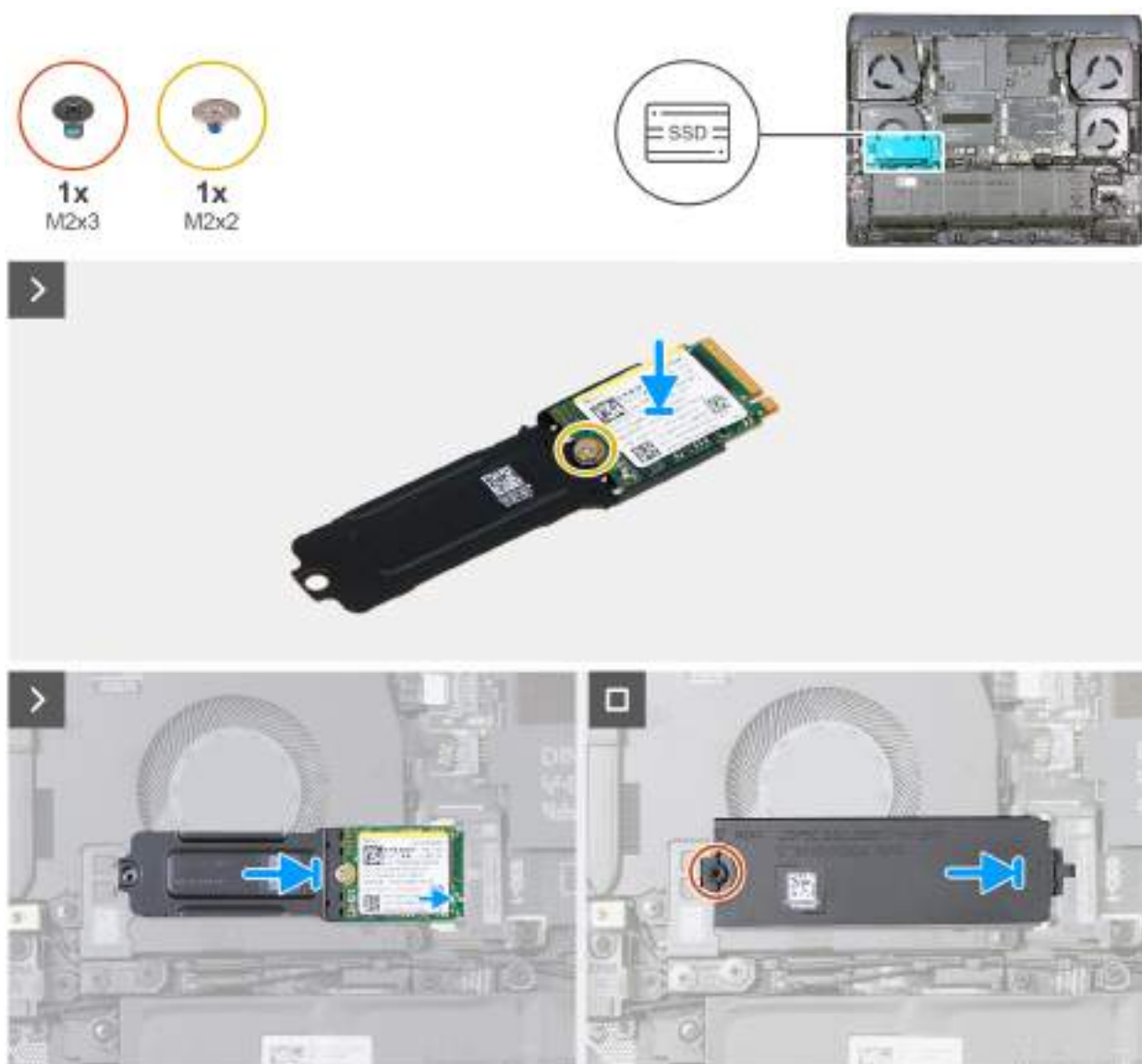
Obrázek 24. Montáž disku SSD M.2 2230 do slotu č. 1
