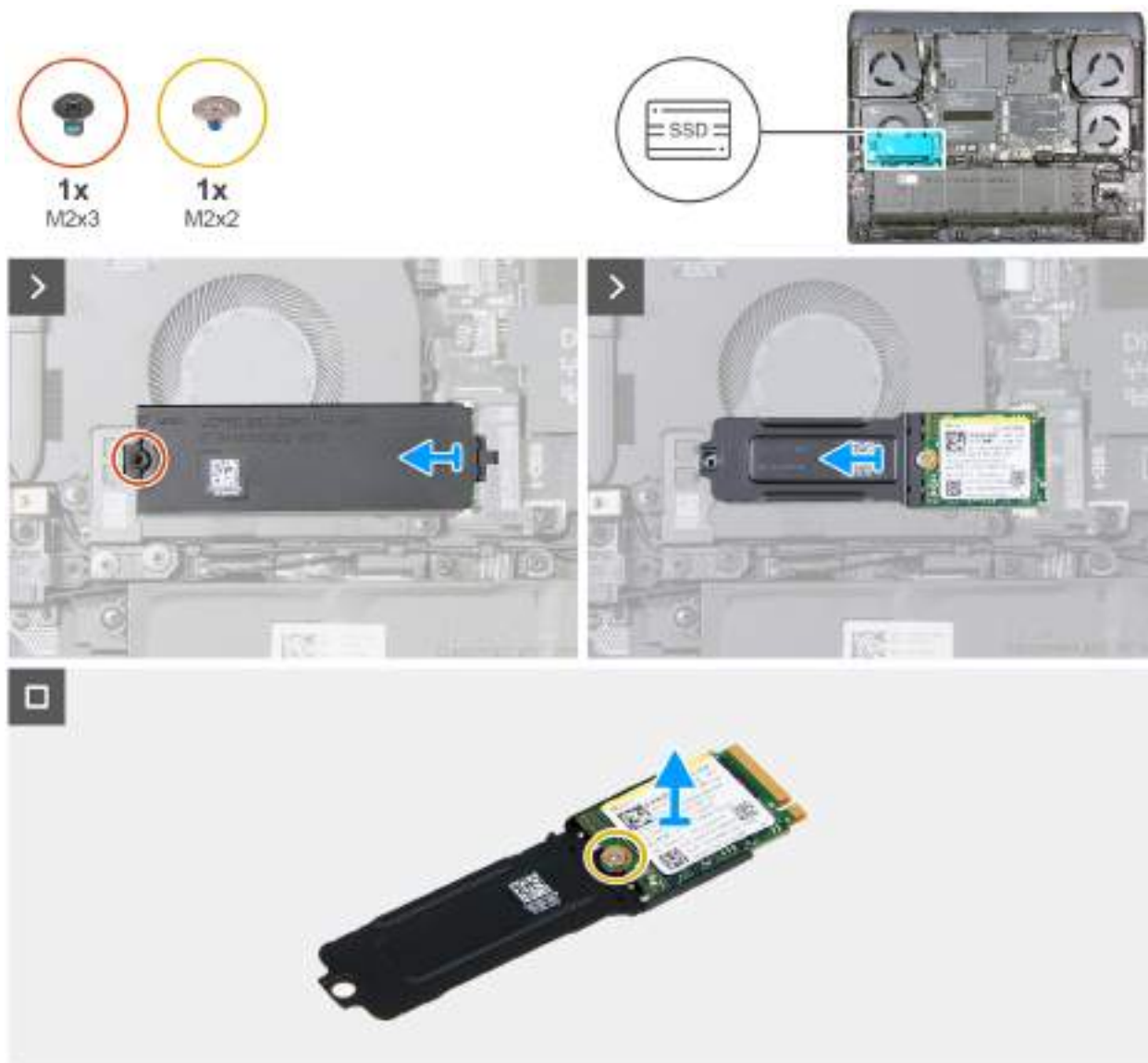
Obrázek 23. Montáž disku SSD M.2 2230 do slotu 1
