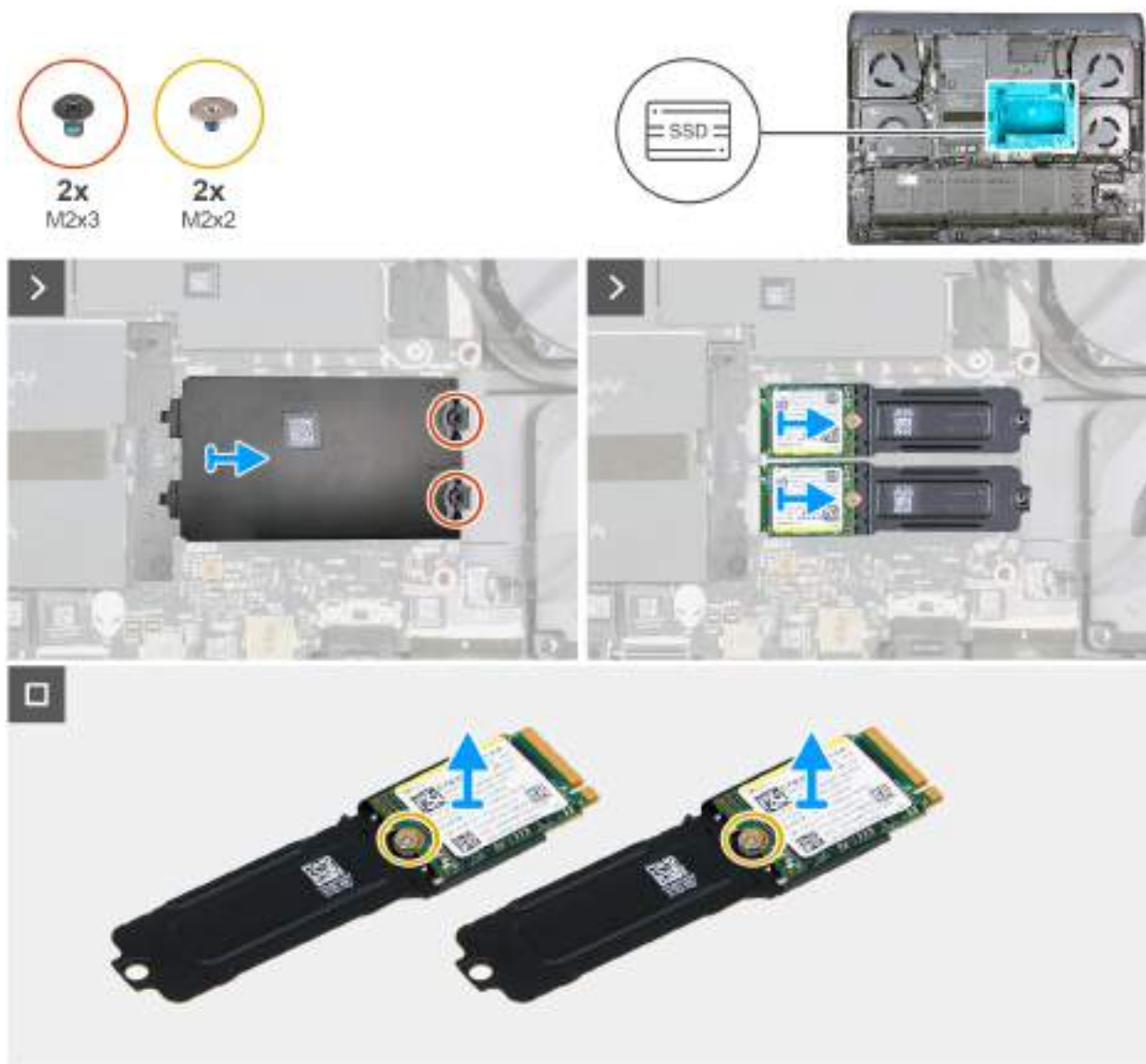
Obrázek 28. Vyjmutí disku SSD M.2 2230 ze slotu 2 a slotu 3
