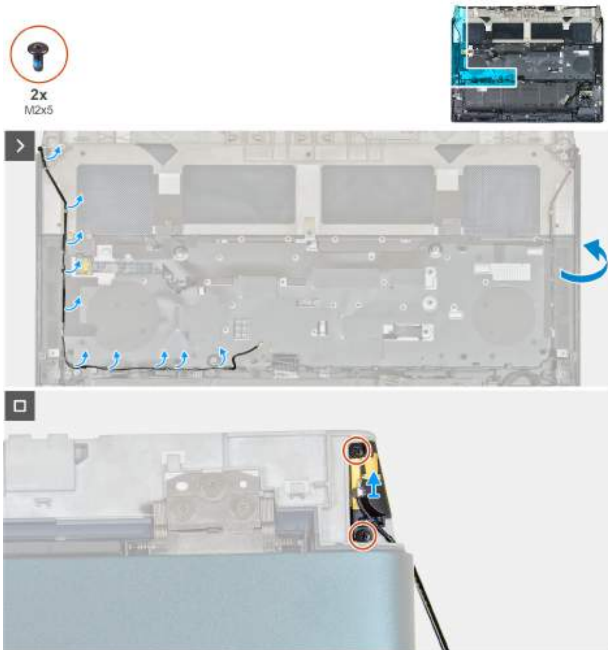
Obrázek 77. Demontáž pomocné antény WLAN
