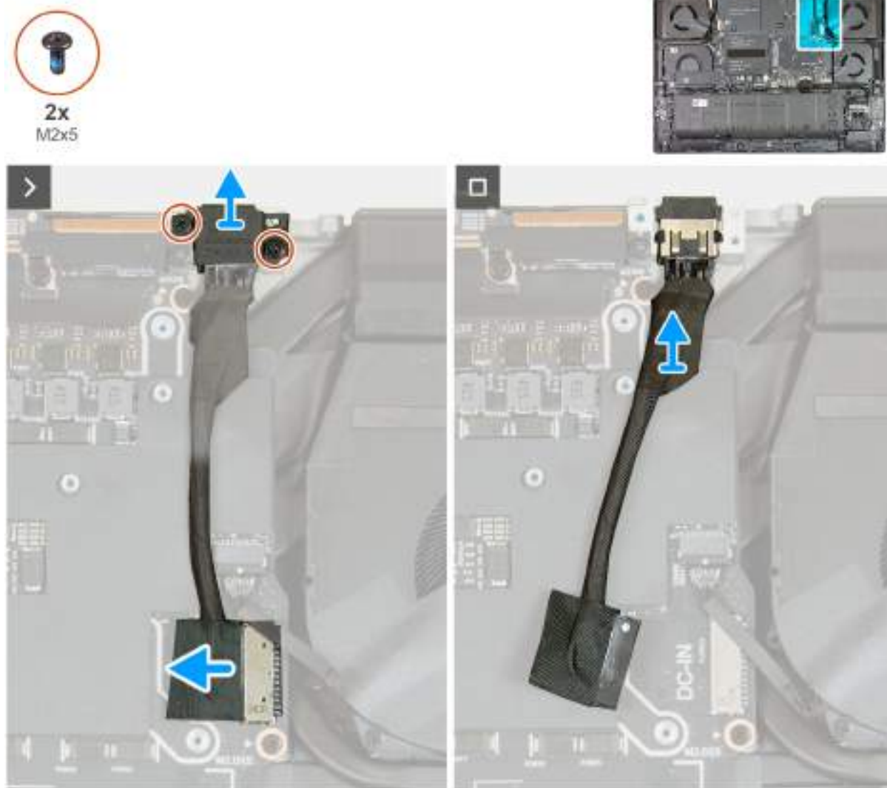
Obrázek 61. Demontáž portu napájecího adaptéru
