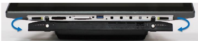
Po jednoduchém otevření dolního krytu jsou dostupné 2 sloty pro M.2 SSD disky a port USB 3.0
